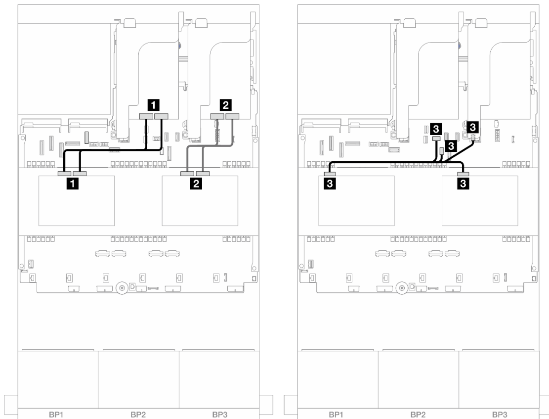
Figure 476. Cheminement des câbles du fond de panier central
