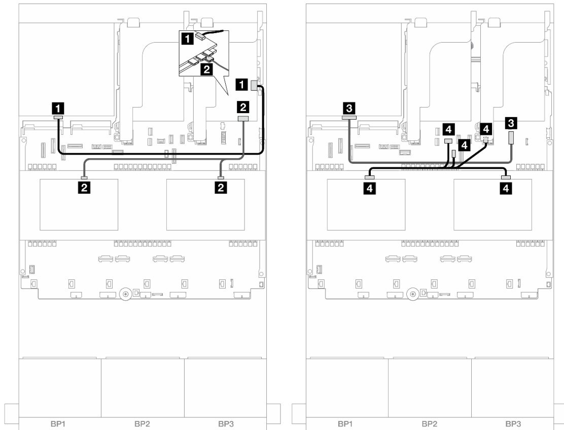
Figure 460. Cheminement des câbles du fond de panier central/arrière
