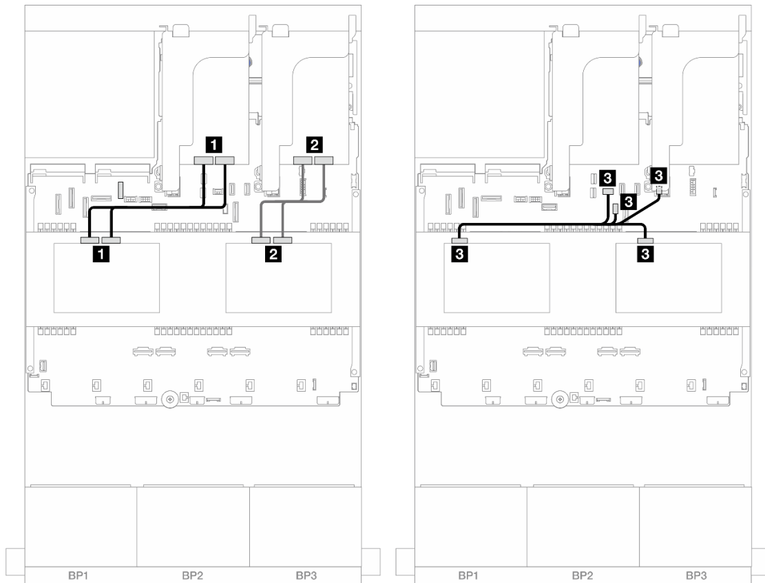
Figure 494. Cheminement des câbles du fond de panier central
