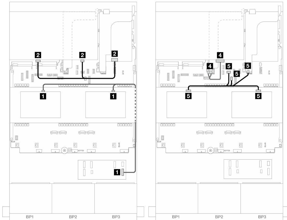
Figure 485. Cheminement des câbles du fond de panier central/arrière
