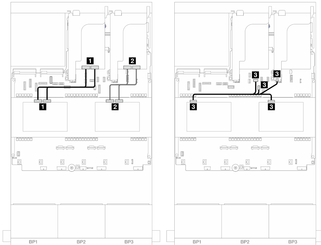
Figura 494. Instradamento dei cavi del backplane centrale
