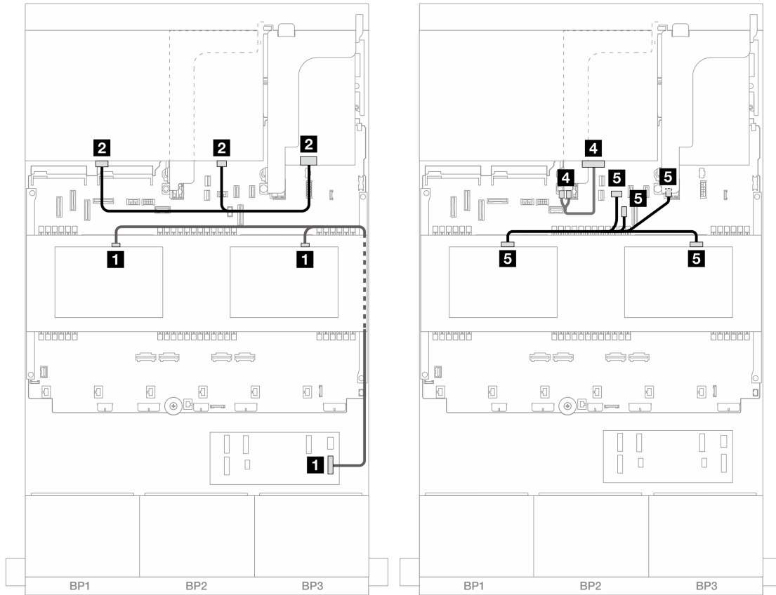
図 467. 中央/背面バックプレーンのケーブル配線
