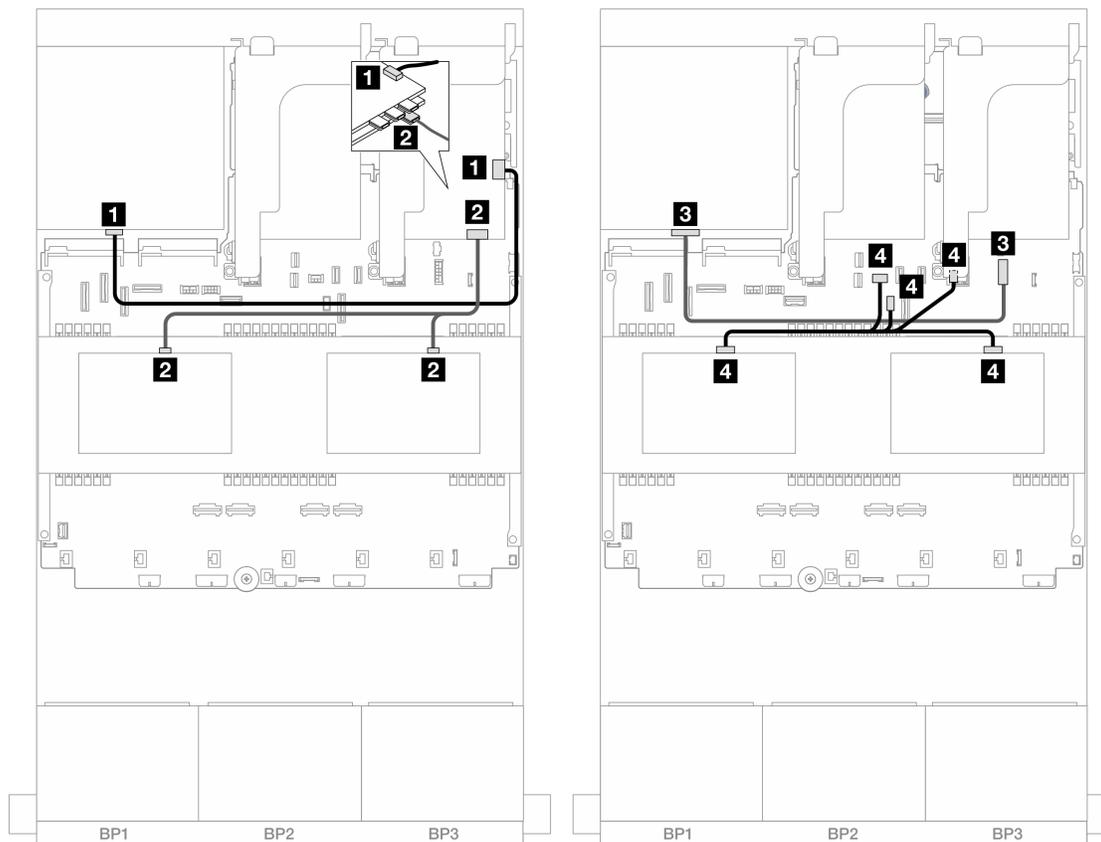
図 482. 中央/背面バックプレーンのケーブル配線
