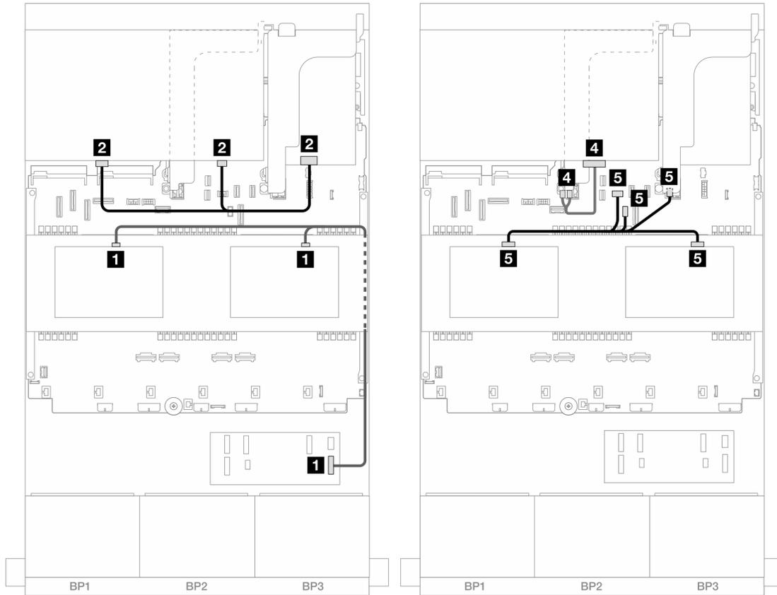
図 489. 中央/背面バックプレーンのケーブル配線
