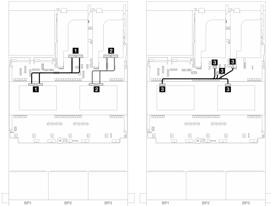
図 494. 中央バックプレーン・ケーブル配線
