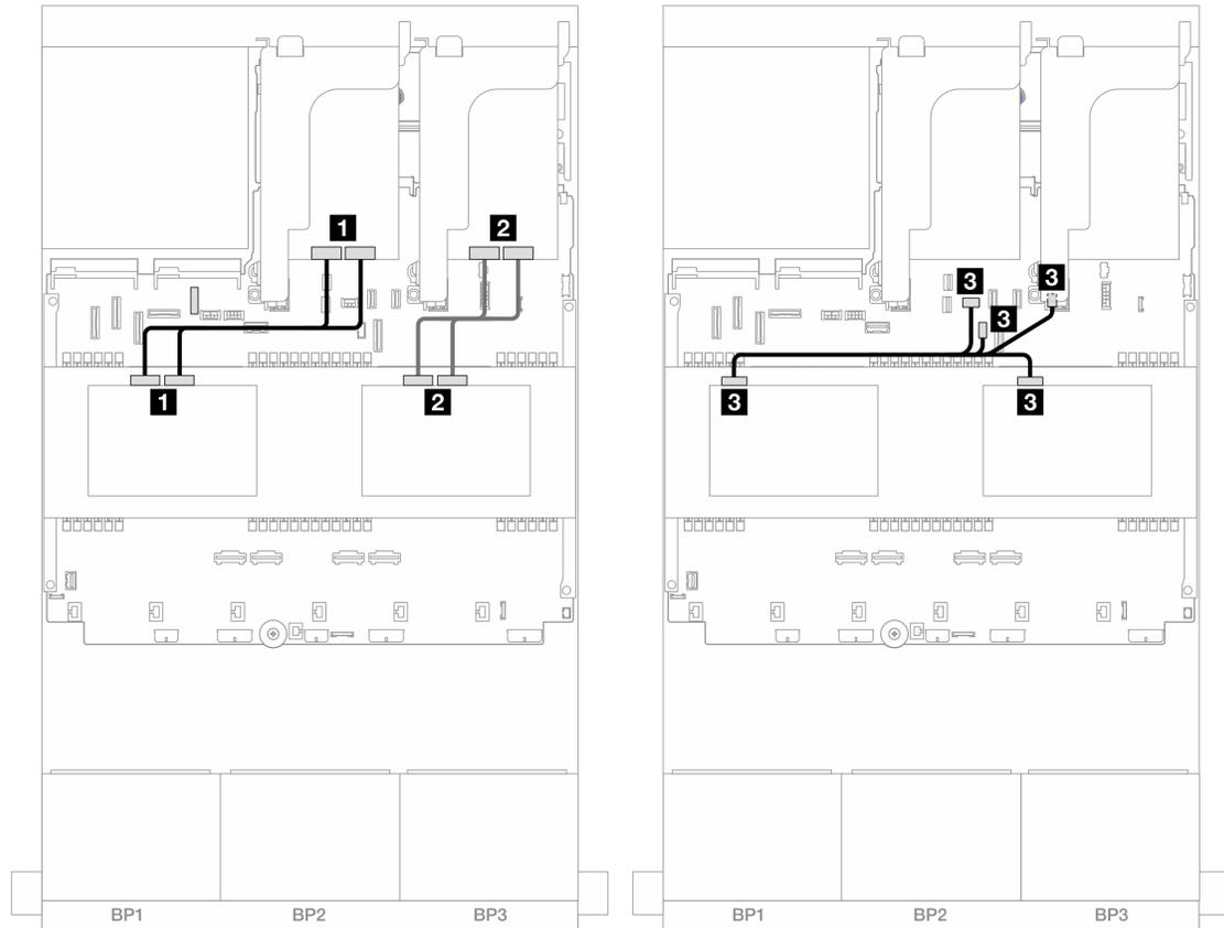
図 498. 中央バックプレーン・ケーブル配線
