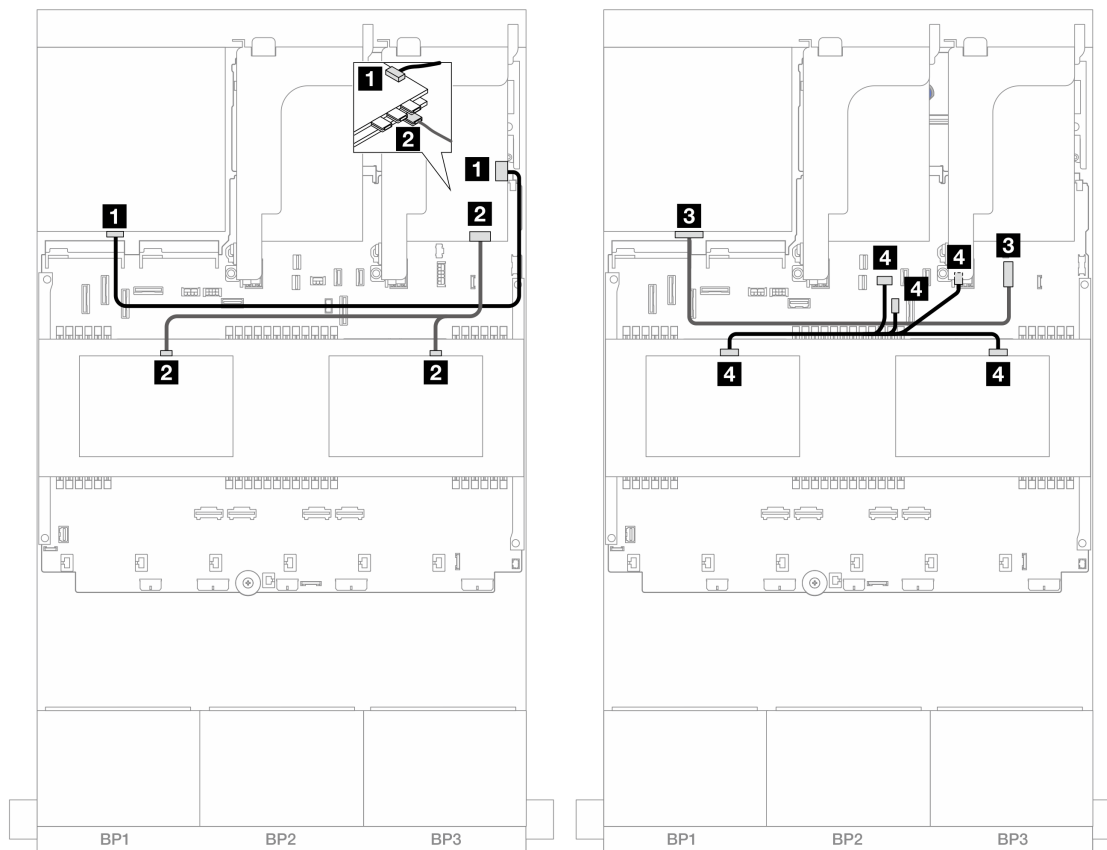
図 478. 中央/背面バックプレーンのケーブル配線
