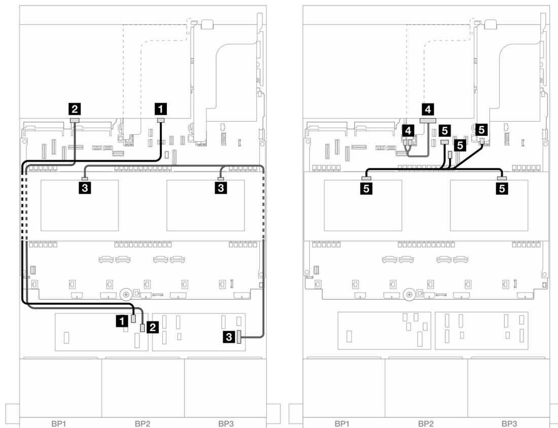
図 492. 中央/背面バックプレーンのケーブル配線
