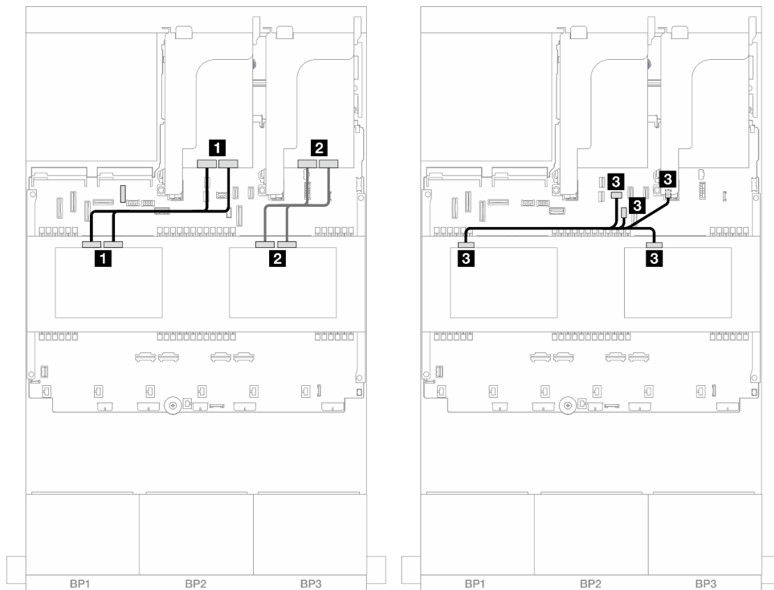
Figura 476. Roteamento de cabos do backplane intermediário
