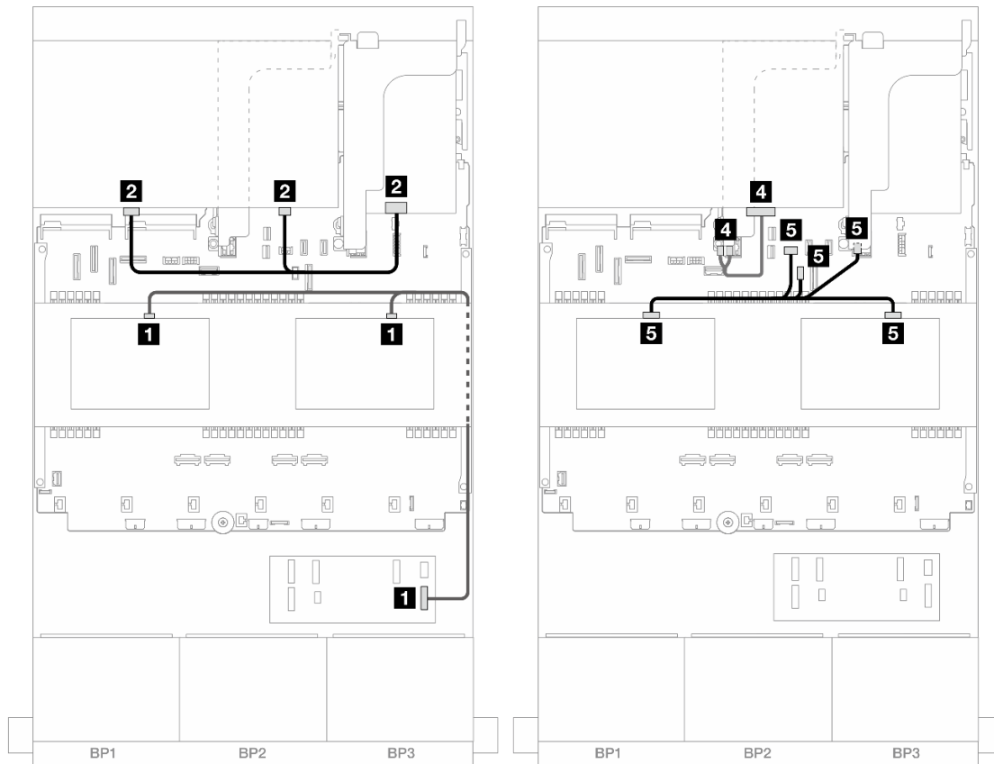
Figura 485. Roteamento de cabos do backplane intermediário/traseiro
