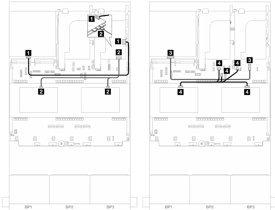
Рис. 460. Прокладка кабелей средней/задней объединительной панели
