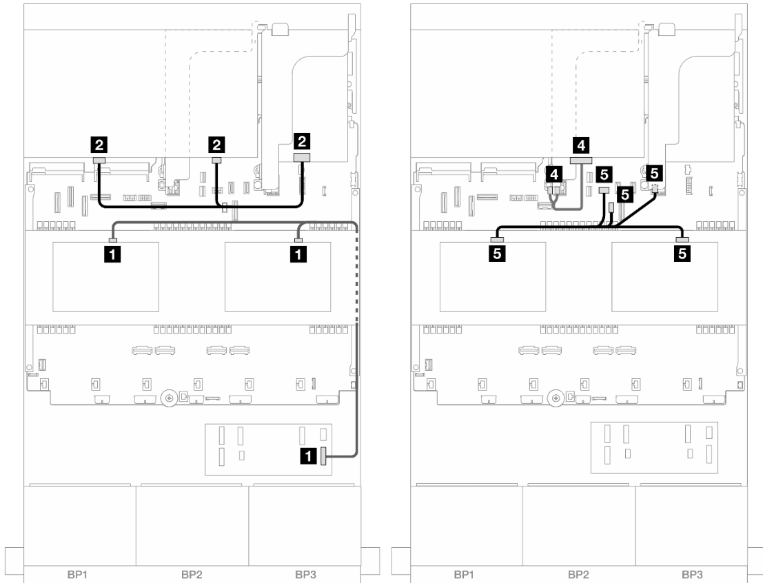
Рис. 467. Прокладка кабелей средней/задней объединительной панели
