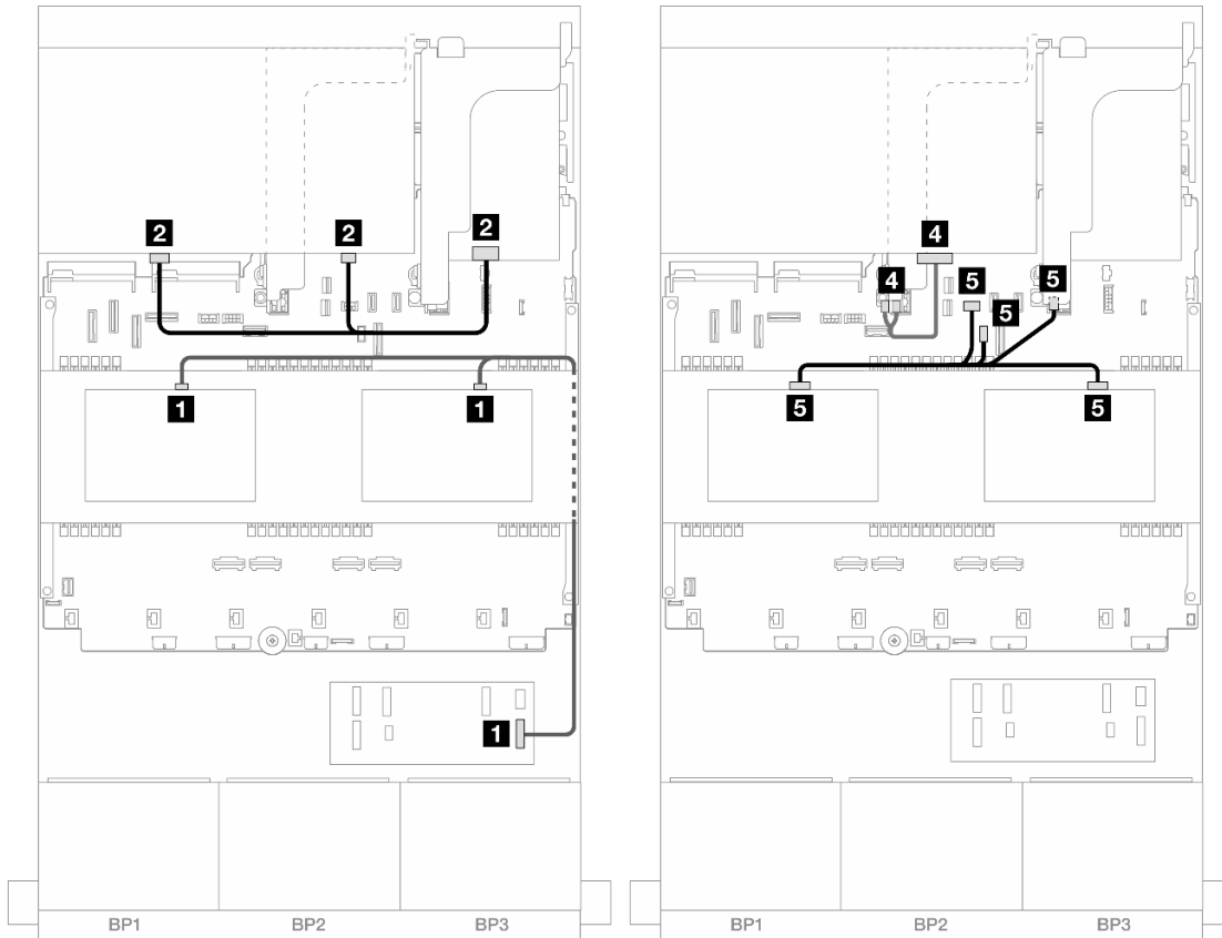
Рис. 485. Прокладка кабелей средней/задней объединительной панели
