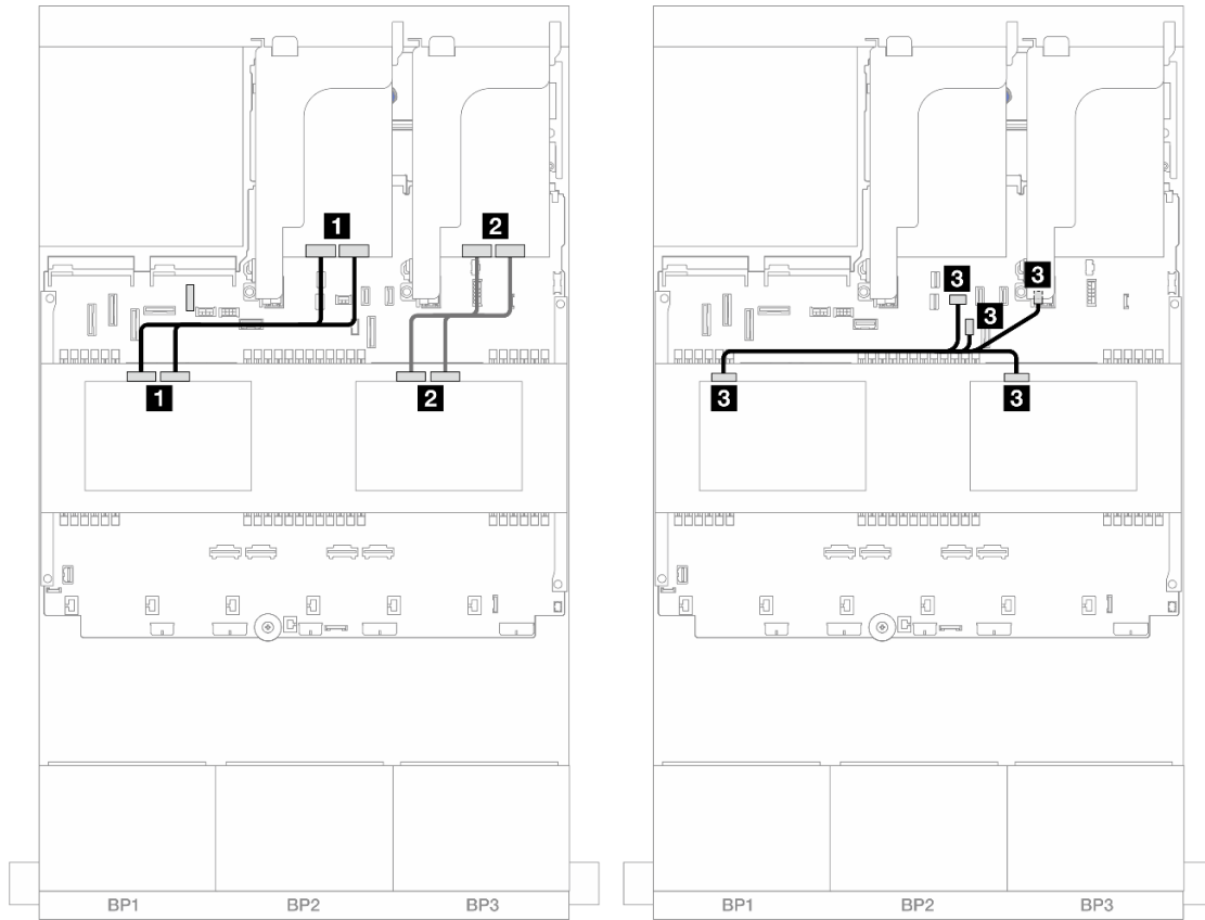
Рис. 494. Прокладка кабелей средней объединительной панели
