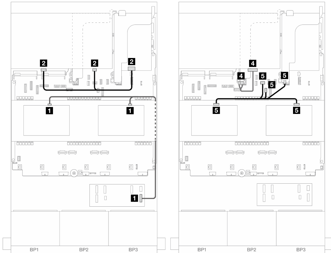
รูปภาพ 485. การเดินสายแบ็คเพลนกลาง/ด้านหลัง
