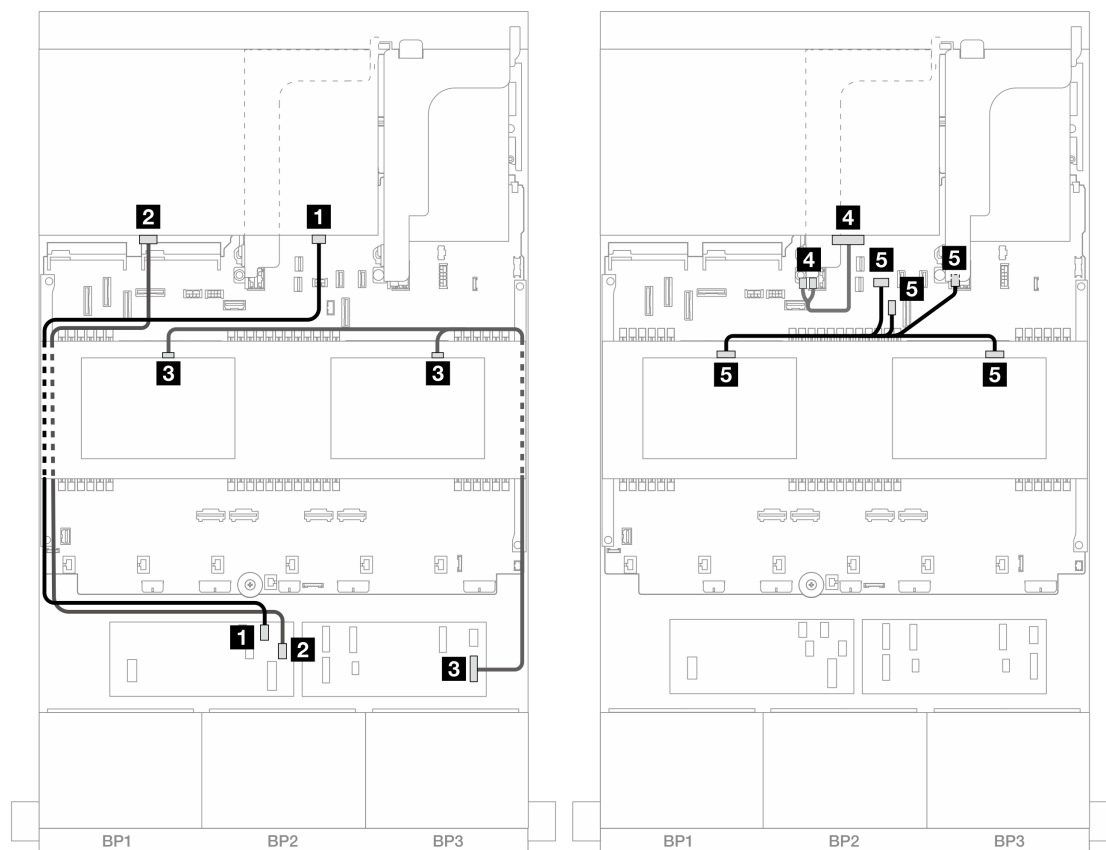
圖例 470. 中間/後方背板纜線佈線
