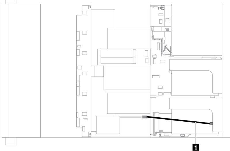
**Anmerkung:** Ein Verlängerungskabel wird für jedes RAID-Superkondensatormodul zum Anschluss bereitgestellt. Schließen Sie das Superkondensatorkabel wie dargestellt an den Superkondensatoranschluss des entsprechenden RAID-Adapters an.
