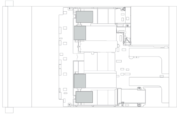
Рис. 162. В среднем отсеке для 2,5-дюймовых дисков
