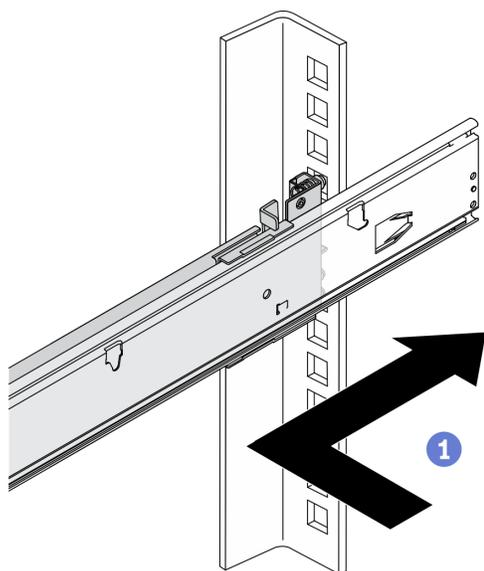
① Desde el interior del armario del bastidor, alinee las patillas de montaje del riel con los orificios de la brida del bastidor. Deslice el riel de deslizamiento para que las patillas y el gancho entren en los orificios de las bridas.
