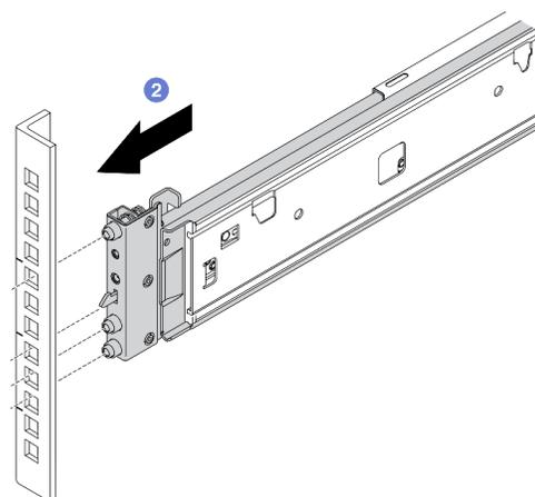
② Alinee las patillas de montaje del riel con los orificios de la brida del bastidor; a continuación, deslice el riel hacia delante e inserte las patillas y el gancho en los orificios de la brida del bastidor.
