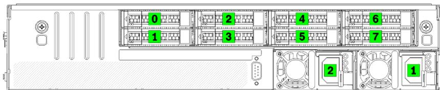
Abbildung 9. Nummerierung der Festplattenlaufwerke und Netzteile
