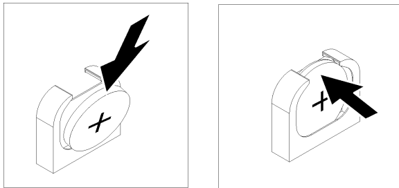
Figura 96. Installazione della batteria di sistema
