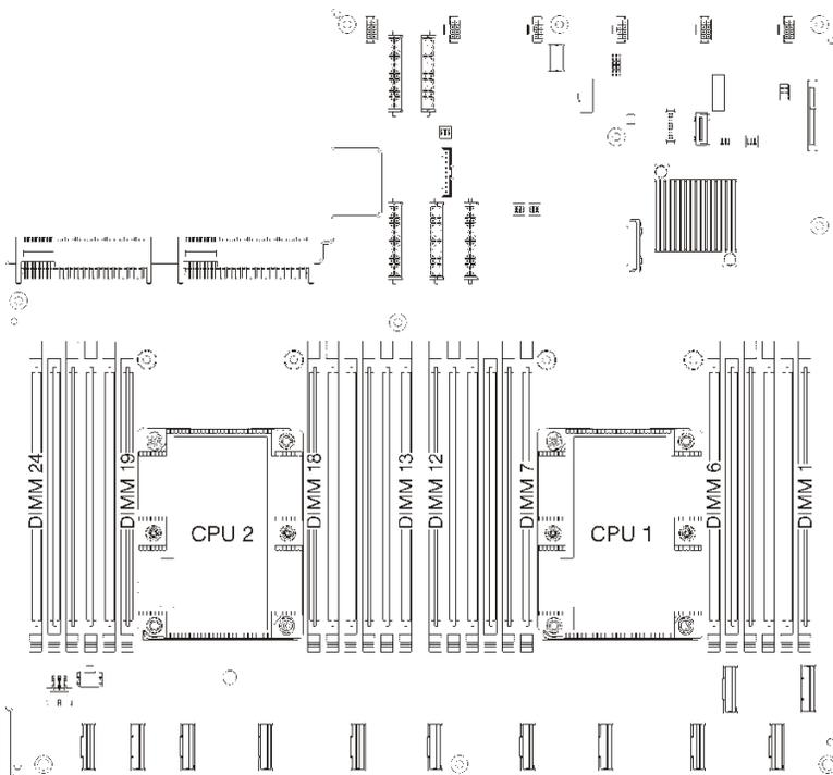
그림 24. 시스템 보드에서 DIMM 커넥터의 위치
