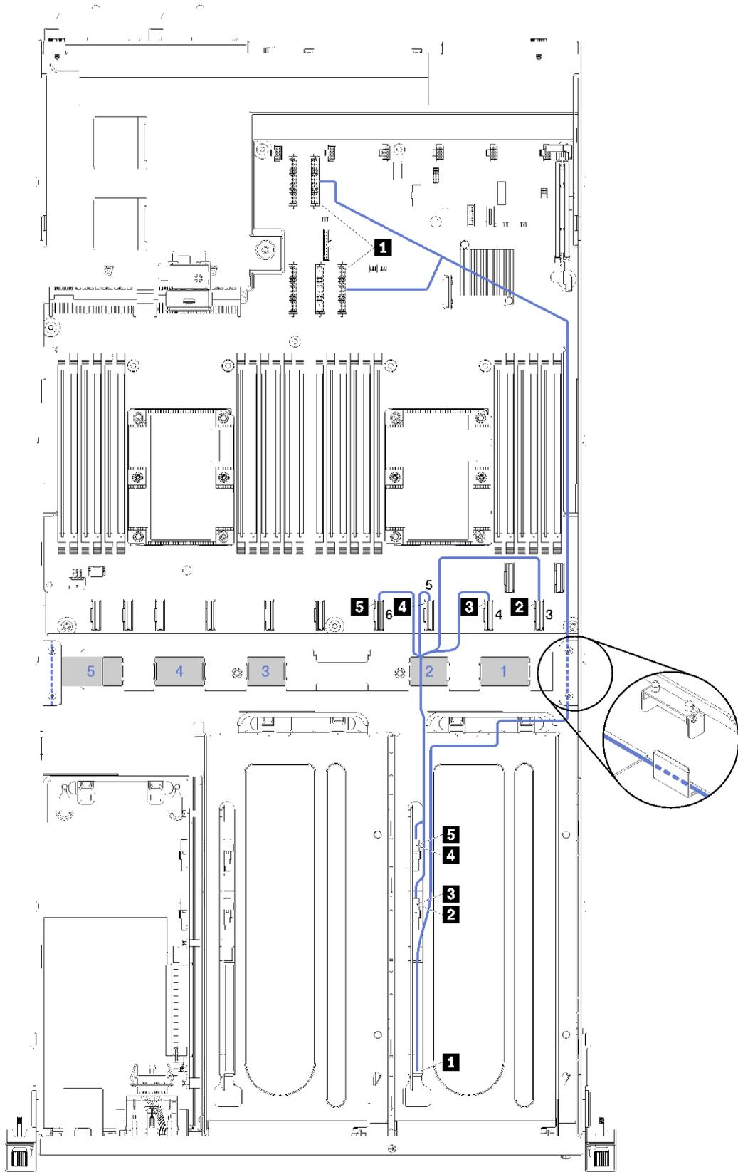
그림 15. 3 슬롯 PCIe 확장 케이스 1의 케이블 배선
