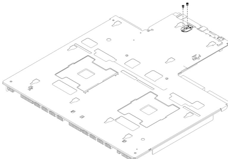
Figura 102. Rimozione delle viti
