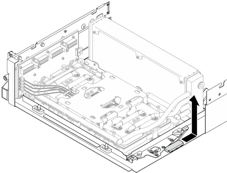
*Figura 228. Rimozione della staffa di blocco dell'Assieme della scheda GPU SXM5*
