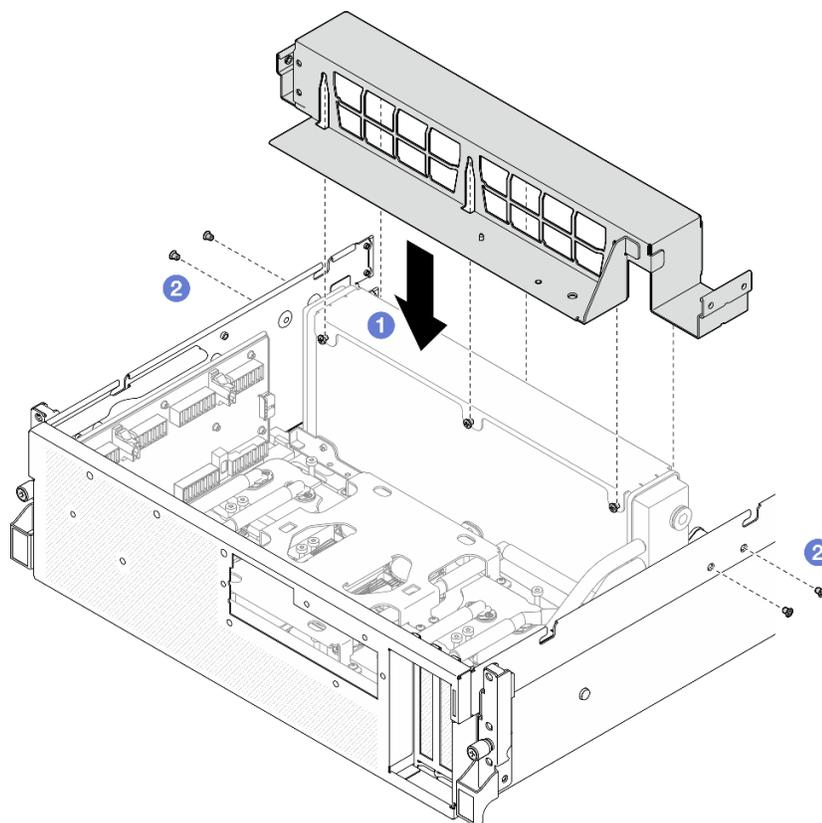
Figura 224. Installazione della staffa del radiatore
