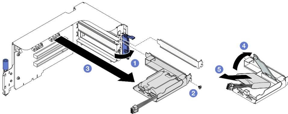
Figura 23. Rimozione del modulo di alimentazione flash
