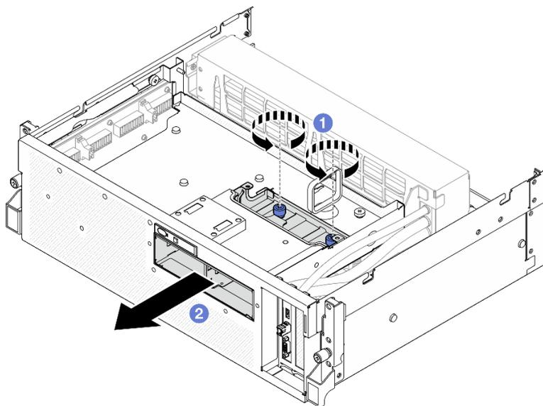
Figura 178. Rimozione del telaio unità da 2,5"
