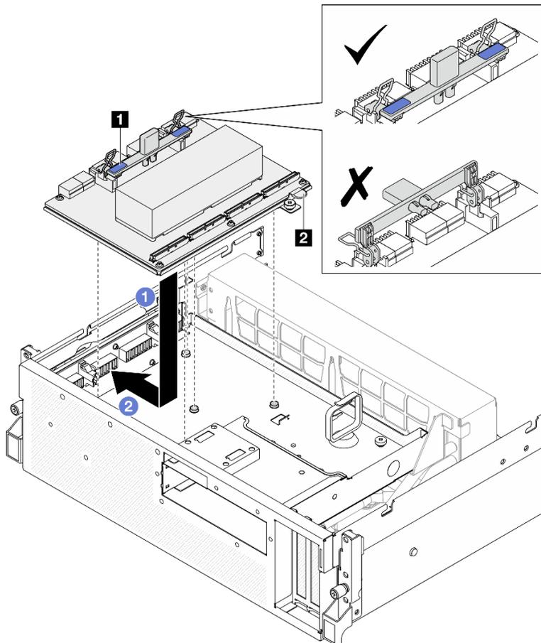
Figura 294. Installazione del Scheda dello switch PCIe SXM5
