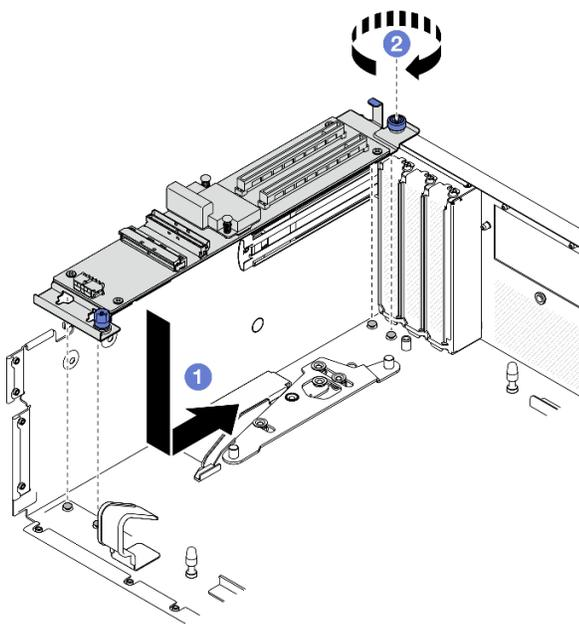
Figura 217. Installazione del modulo della scheda di espansione I/O anteriore
