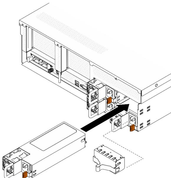
Figura 86. Installazione dell'unità di alimentazione
