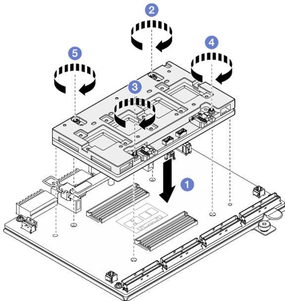
Figura 186. Installazione della Scheda CX-7 Mezz
