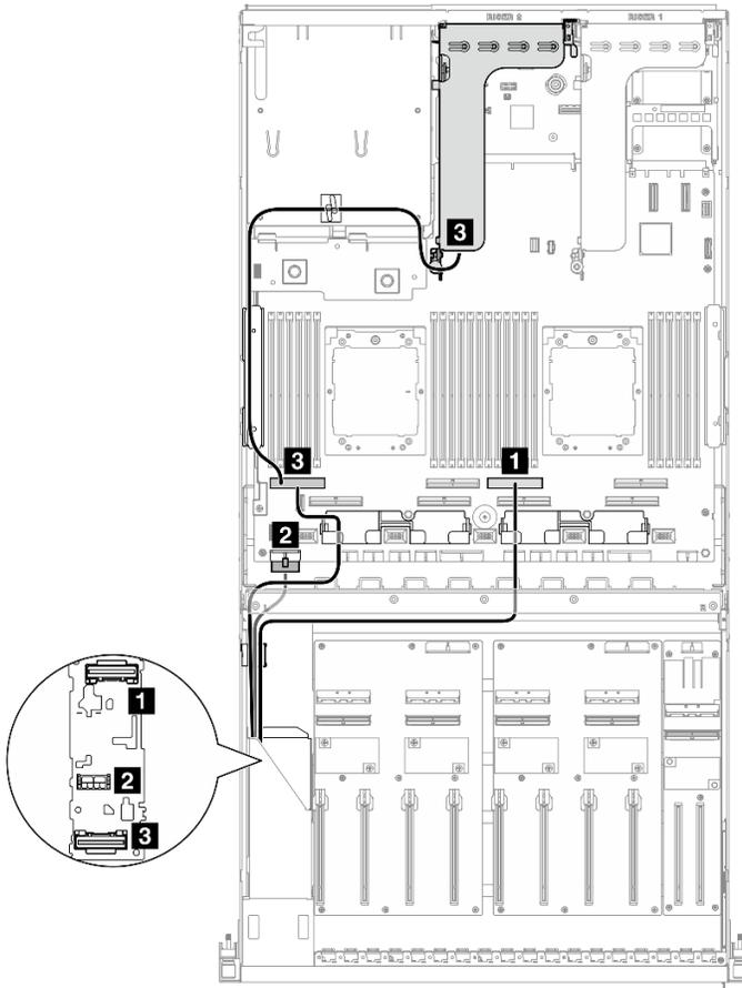
Figura 333. Intradamento dei cavi per il backplane dell'unità E3.S
