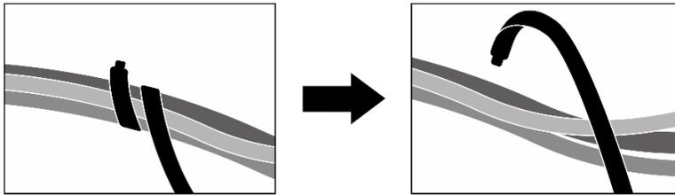
Figura 204. Rimozione delle fascette
