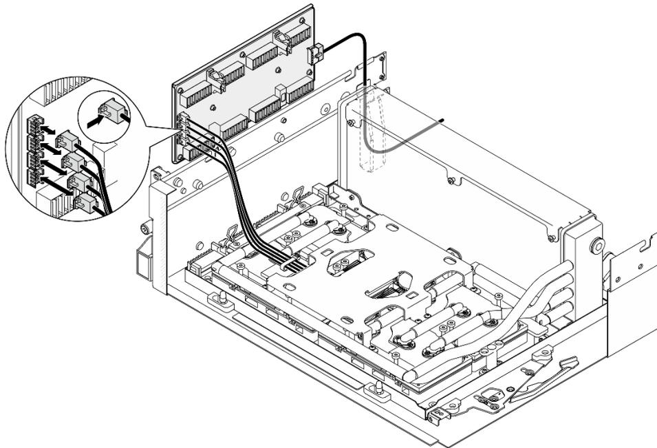
Figura 236. Collegamento di cavi della pompa dell'assieme piastra a freddo
