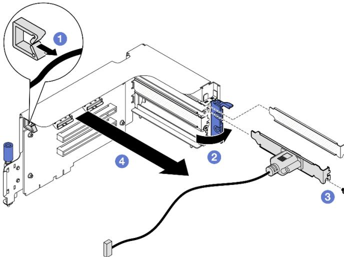
Figura 93. Rimozione del modulo della porta seriale
