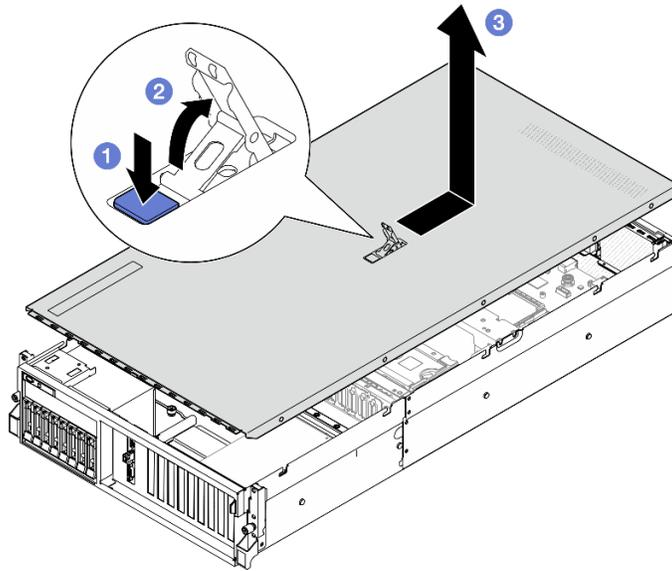
Figura 116. Rimozione del coperchio superiore
