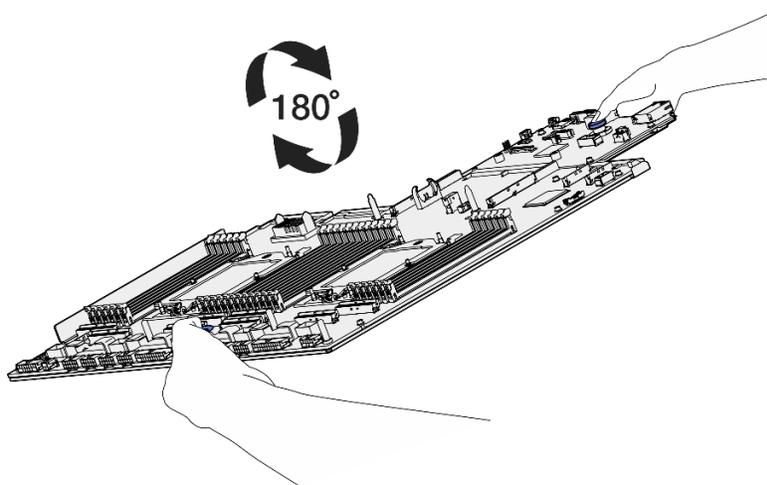
Figura 101. Capovolgimento dell'assieme della scheda di sistema
