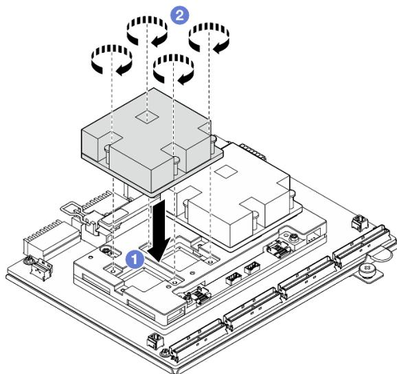
Figura 192. Installazione del Dissipatore di calore CX-7
