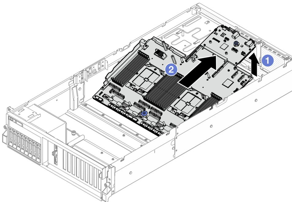
Figura 99. Rimozione dell'assieme della scheda di sistema
