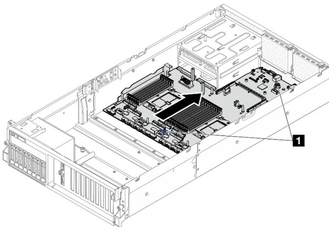
Figura 115. Installazione dell'assieme della scheda di sistema
