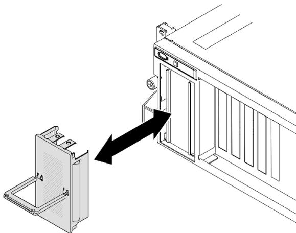
Figura 125. Rimozione del coperchio del telaio unità EDSFF
