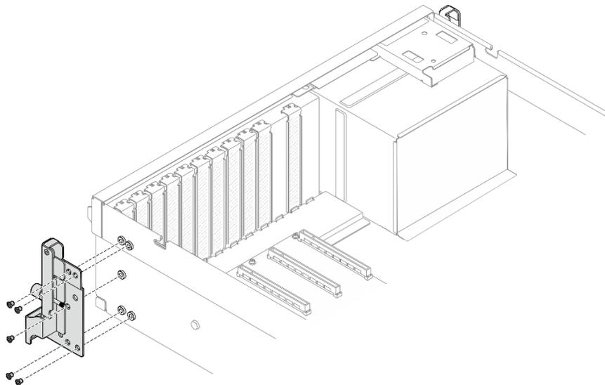
Figura 55. Rimozione della staffa di montaggio destra
