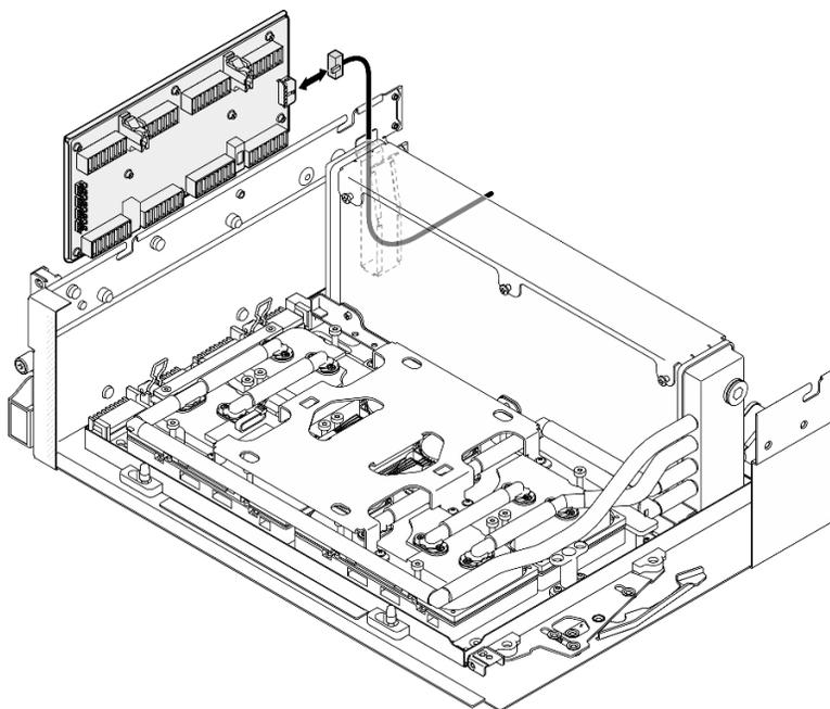
Figura 232. Scollegamento dei cavi di alimentazione della scheda interposer
