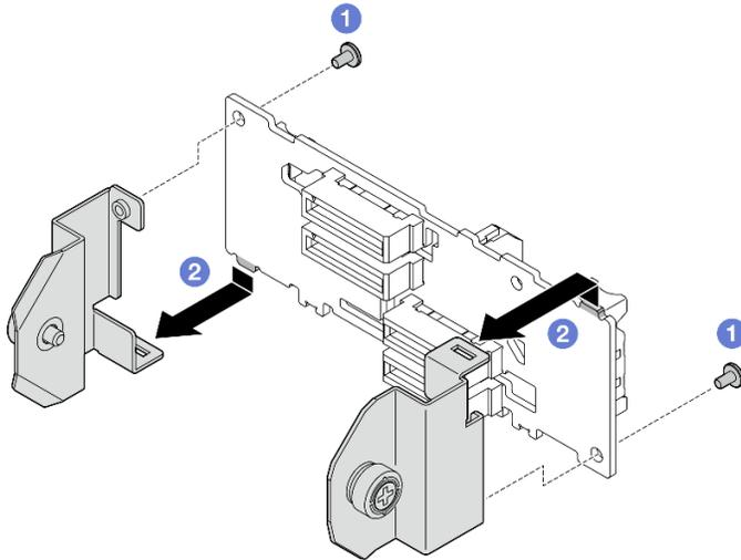
Figura 138. Rimozione della staffa del backplane dell'unità E3.S
