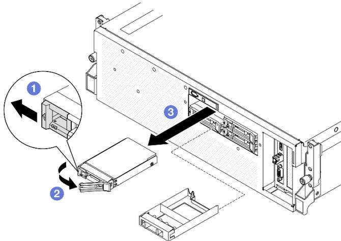
Figura 171. Rimozione di un'unità hot-swap da 2,5"
