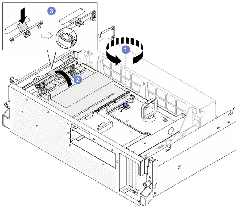
Figura 181. Rimozione del Assieme CX-7
