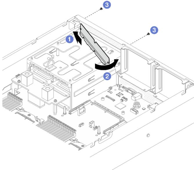
Figura 168. Installazione del deflettore posteriore del flusso d'aria
