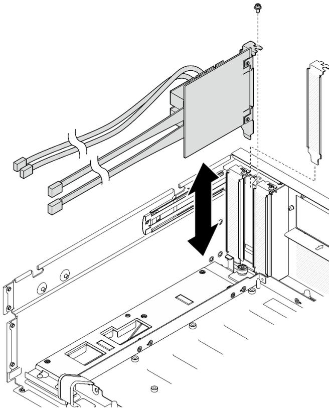
Figura 263. Rimozione del Scheda della porta OSFP
