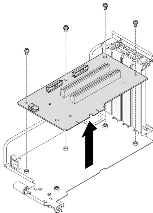
*Figura 71. Rimozione della scheda verticale PCIe*
