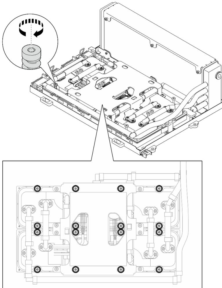
Figura 258. Installazione della vite Torx T15
