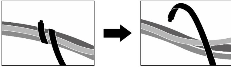
Figura 226. Rimozione delle fascette
