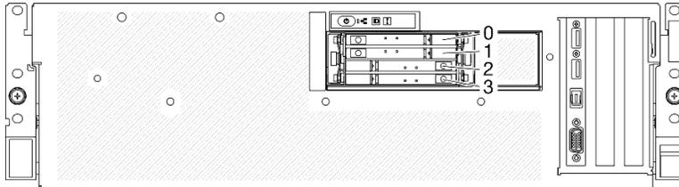
Figura 195. Numerazione dei vani delle unità hot-swap E3.S nel Modello di GPU SXM5
