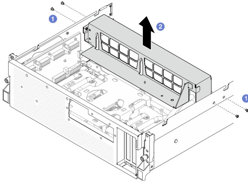
Figura 221. Rimozione della staffa del radiatore
