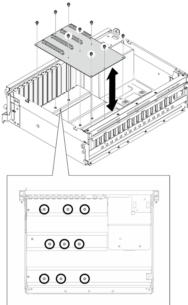
Figura 156. Installazione della scheda di distribuzione della GPU - modello di GPU 4-DW
