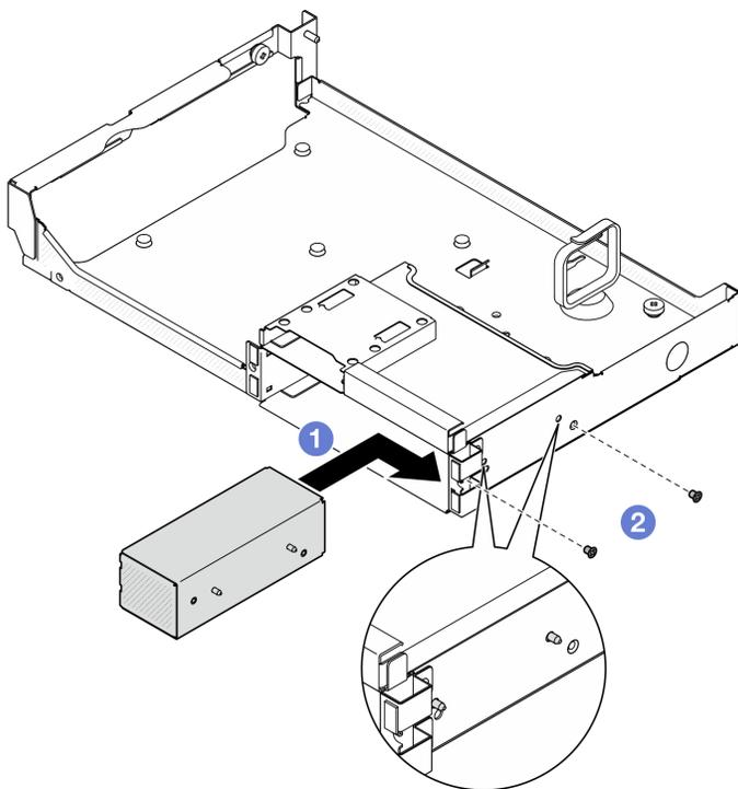
Figura 206. Installazione dell'elemento di riempimento del telaio unità E3.S
