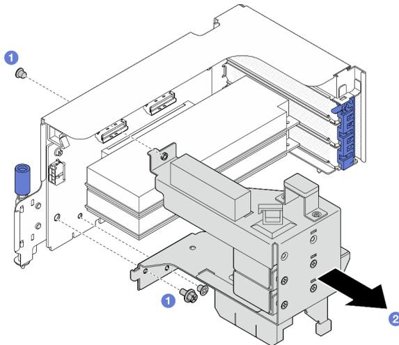
Figura 65. Rimozione della staffa di blocco dell'adattatore PCIe
