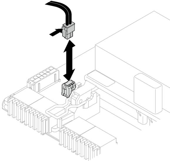
Figura 183. Scollegamento del cavo di alimentazione
