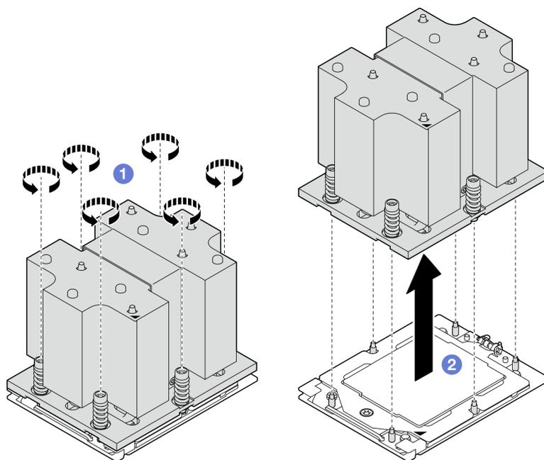
Figura 88. Rimozione del dissipatore di calore
