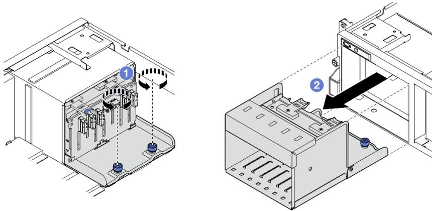
Figura 123. Rimozione dell'assieme del telaio unità da 2,5"
