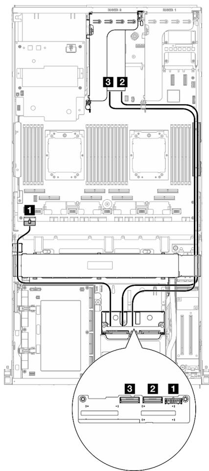
Figura 364. Instradamento dei cavi del backplane dell'unità da 2,5" (adattatore RAID sulla scheda verticale PCIe 2)
