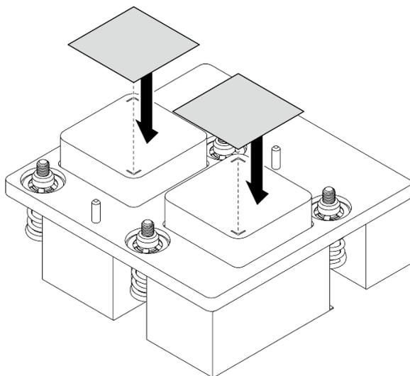
Figura 191. Applicazione del tampone di mastice
