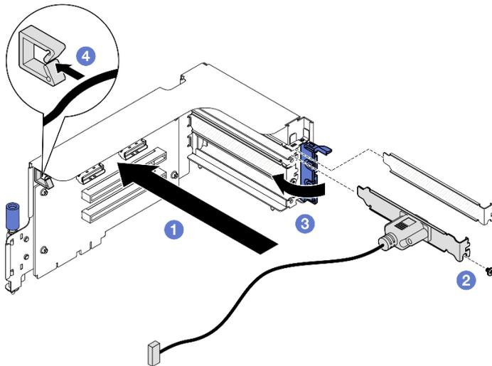
Figura 94. Installazione del modulo della porta seriale
