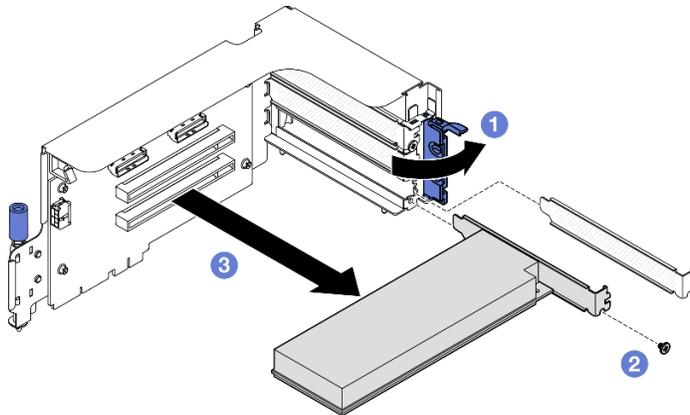
Figura 63. Rimozione dell'adattatore PCIe posteriore
