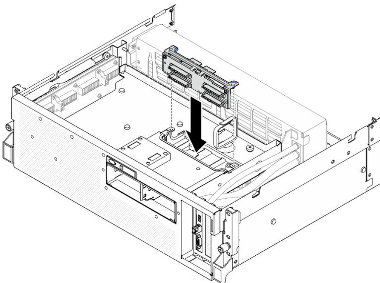
Figura 177. Installazione del modulo backplane dell'unità da 2,5"
