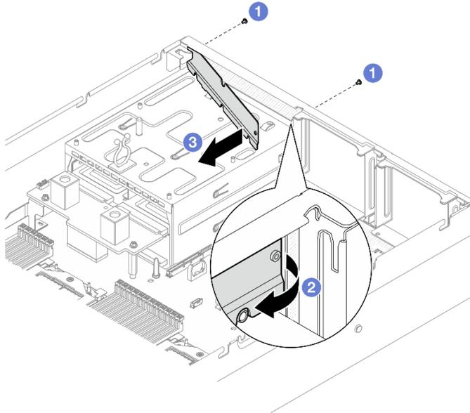
Figura 167. Rimozione del deflettore posteriore del flusso d'aria
