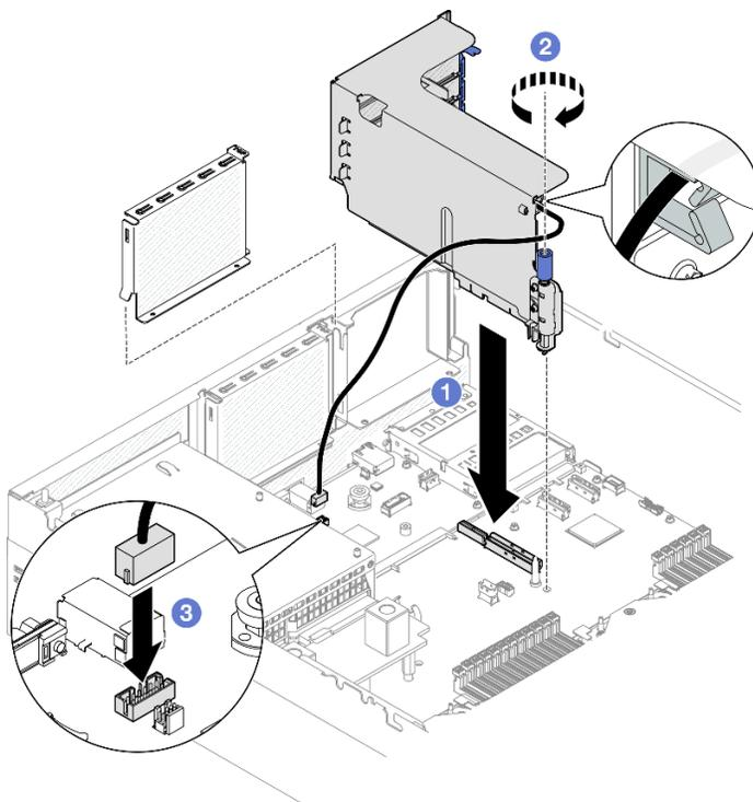
Figura 80. Installazione della scheda verticale PCIe 1 (con modulo della porta seriale)
