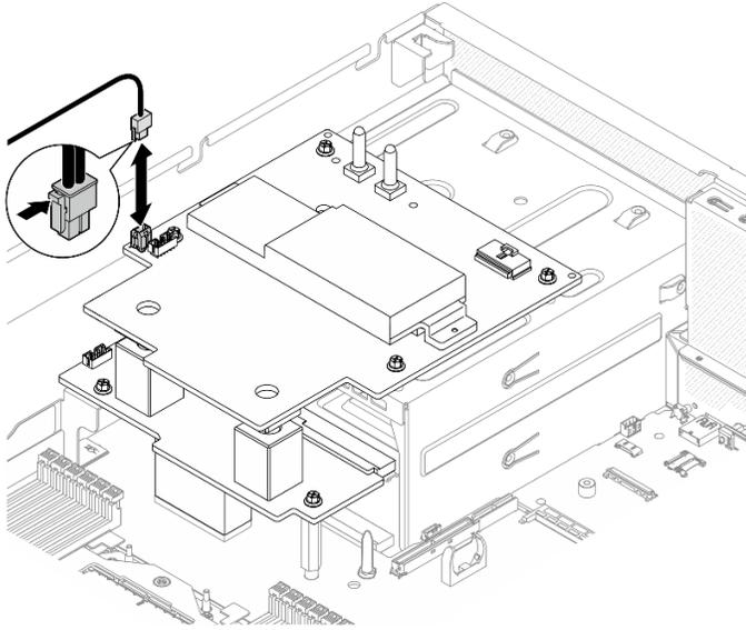
Figura 289. Collegamento dei cavi di alimentazione della Scheda della piastra CX-7
