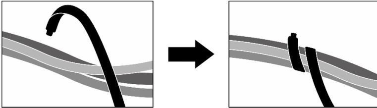
Figura 373. Fissaggio dei cavi con le fascette
