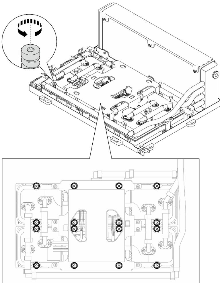
Figura 246. Rimozione della vite Torx T15
