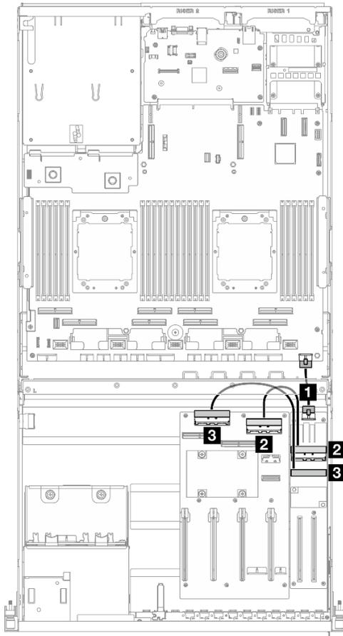
Figura 318. Instradamento dei cavi per la scheda di espansione I/O anteriore
