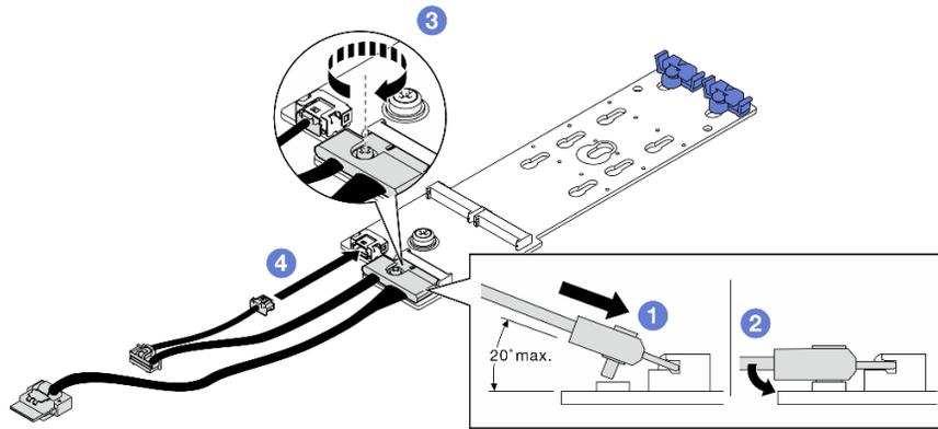
Figura 43. Collegamento dei cavi per il backplane M.2 SATA/NVMe o NVMe RAID
