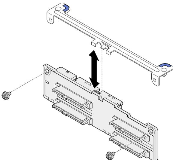
Figura 176. Installazione della staffa del backplane dell'unità da 2,5"
