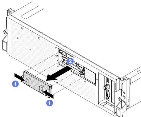
Passo 2. Se il vano dell'unità contiene un elemento di riempimento, tirare la leva di rilascio sull'elemento di riempimento ed estrarlo dal vano.
