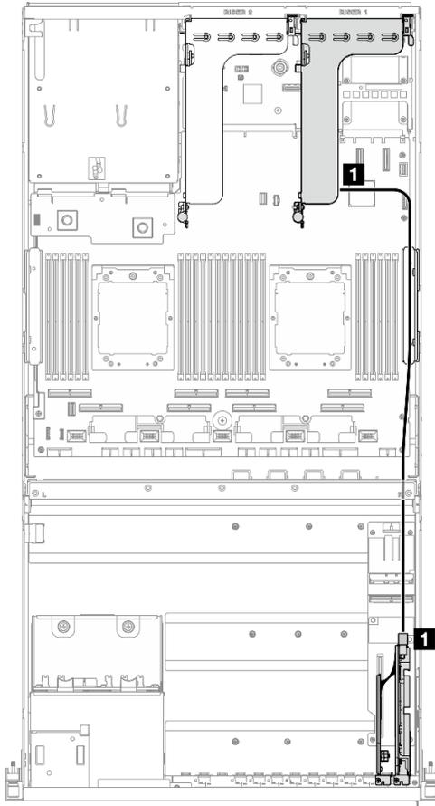
Figura 316. Instradamento dei cavi di alimentazione dell'Adattatore DPU
