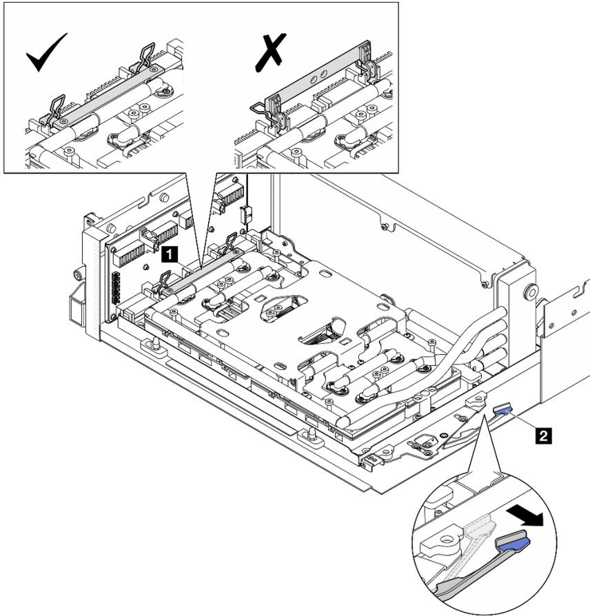
Figura 229. Regolazione dell'Assieme GPU-L2A
