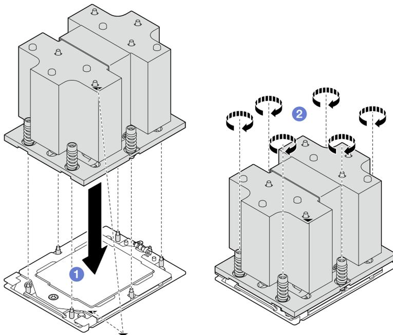
Figura 92. Installazione del dissipatore di calore
