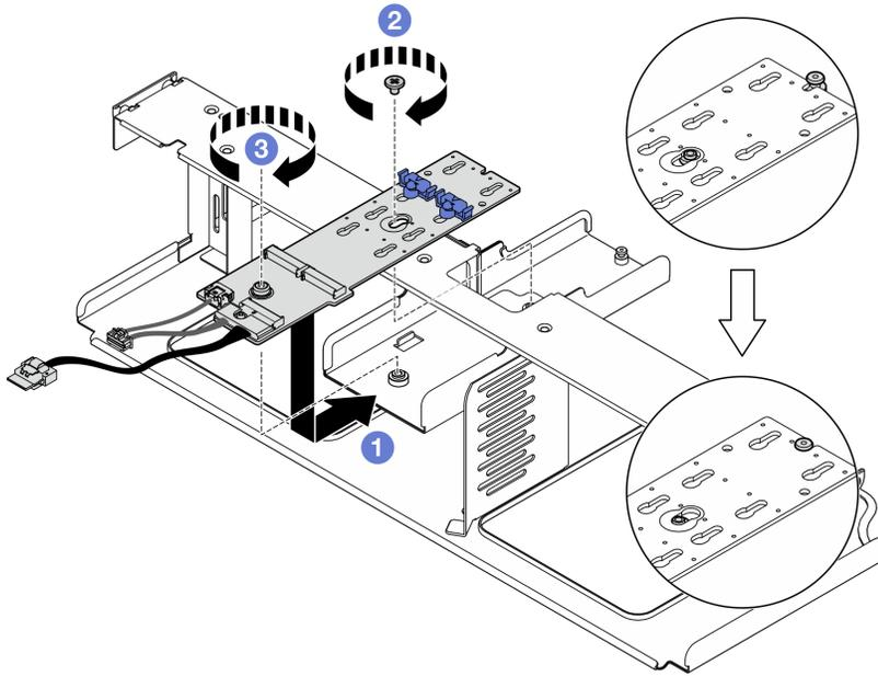
Figura 45. Installazione del backplane M.2
