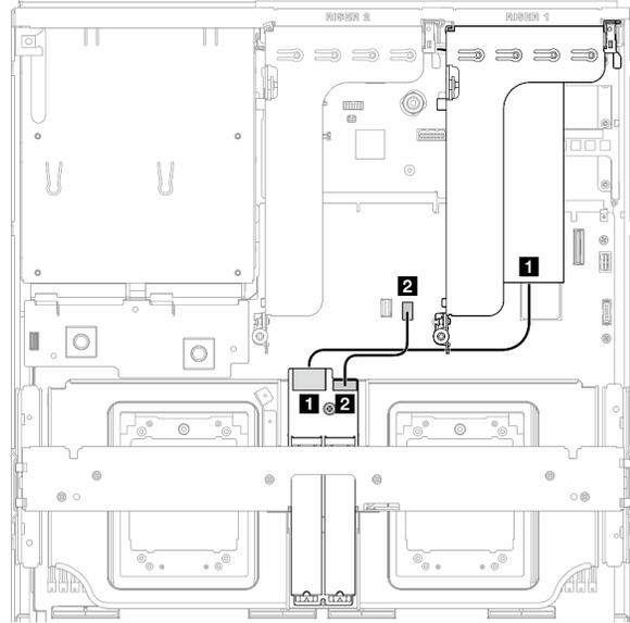
Figura 325. Instradamento dei cavi del backplane M.2 SATA/x4 NVMe (adattatore RAID sulla scheda verticale PCIe 1)
