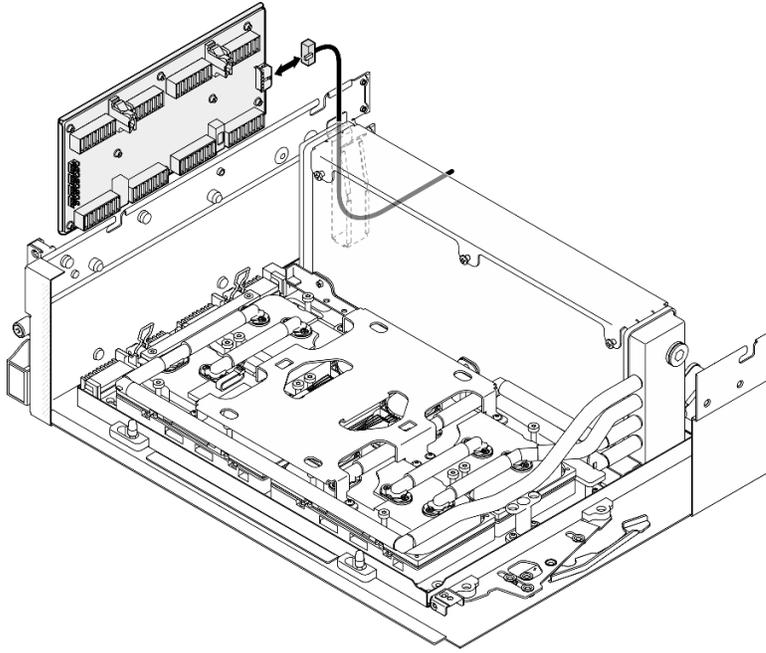
Figura 235. Collegamento dei cavi di alimentazione della scheda interposer
