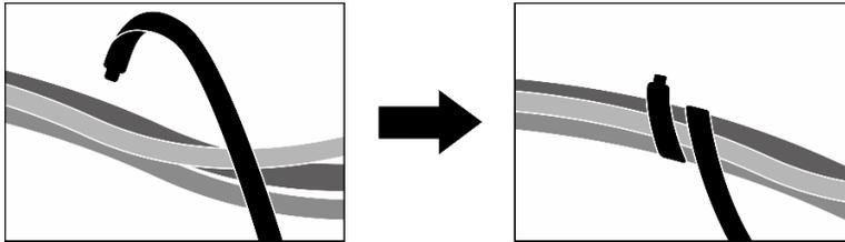
*Figura 361. Fissaggio dei cavi con le fascette*
