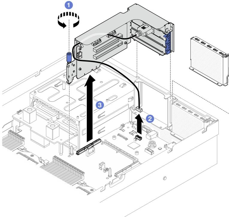
Figura 75. Rimozione della scheda verticale PCIe 2 (con modulo della porta seriale)
