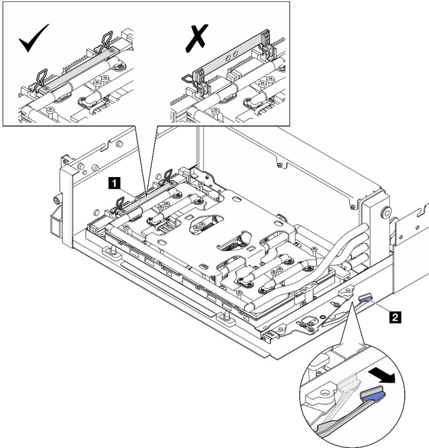
Figura 234. Regolazione dell'Assieme GPU-L2A
