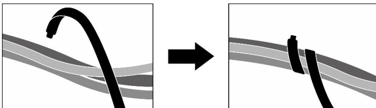
Figura 241. Fissaggio dei cavi con le fascette
