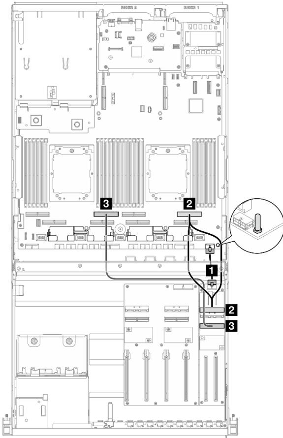
Figura 317. Instradamento dei cavi per la scheda di espansione I/O anteriore
