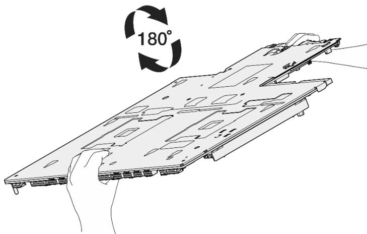
Figura 112. Capovolgimento dell'assieme della scheda di sistema
