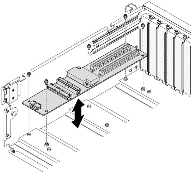
Figura 147. Installazione della scheda di espansione I/O anteriore
