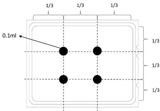
Figura 91. Applicazione del lubrificante termico
