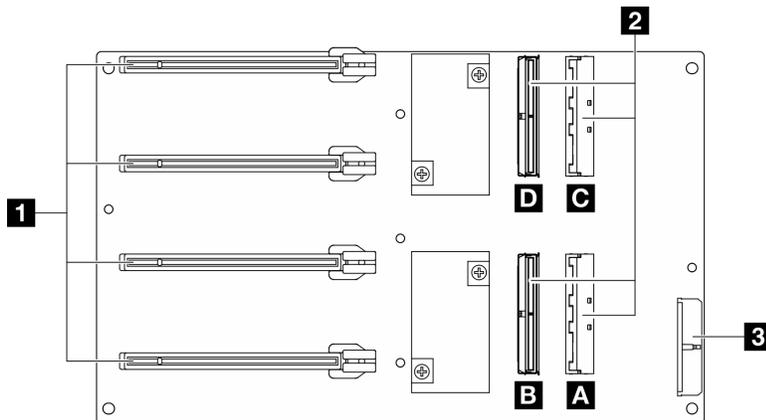
Figura 301. Connettori sulla Scheda di distribuzione della GPU diretta
