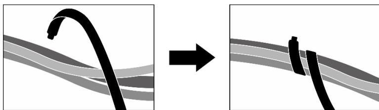
Figura 363. Fissaggio dei cavi con le fascette
