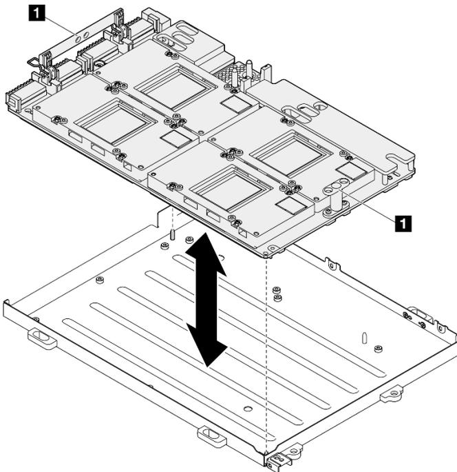
Figura 276. Rimozione del Assieme della scheda GPU SXM5
