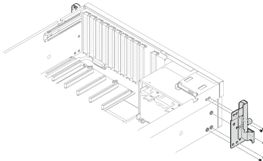
Figura 56. Rimozione della staffa di montaggio sinistra
