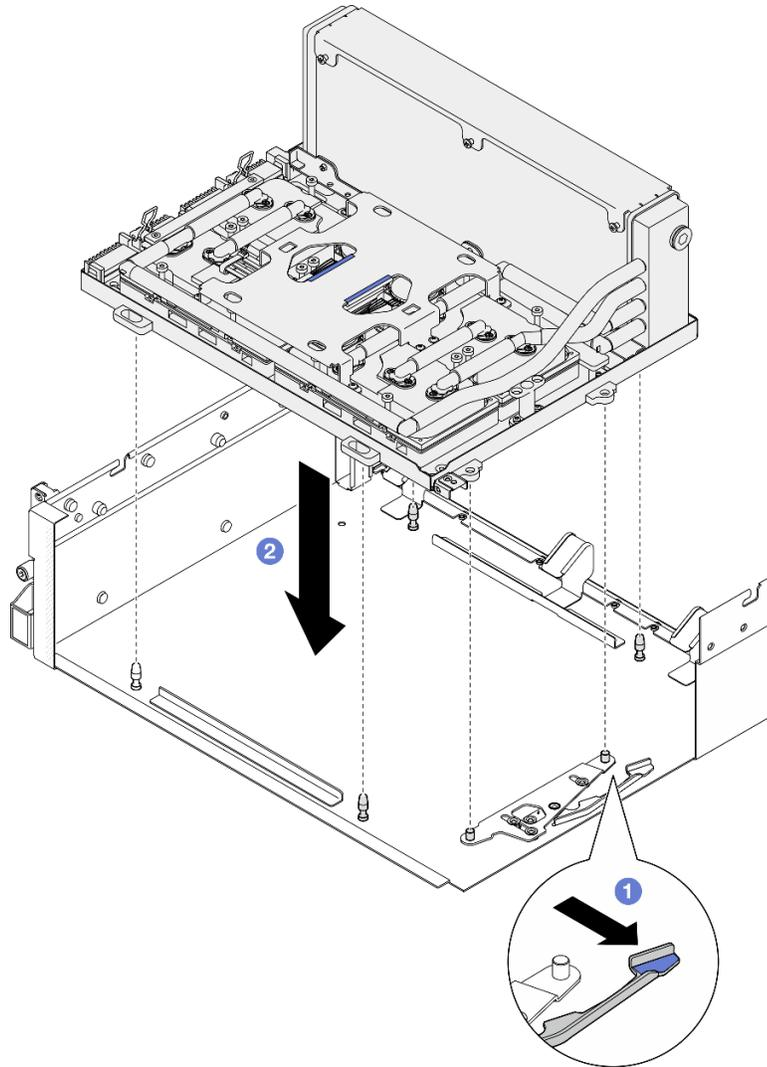
Figura 259. Installazione del Assieme GPU-L2A
