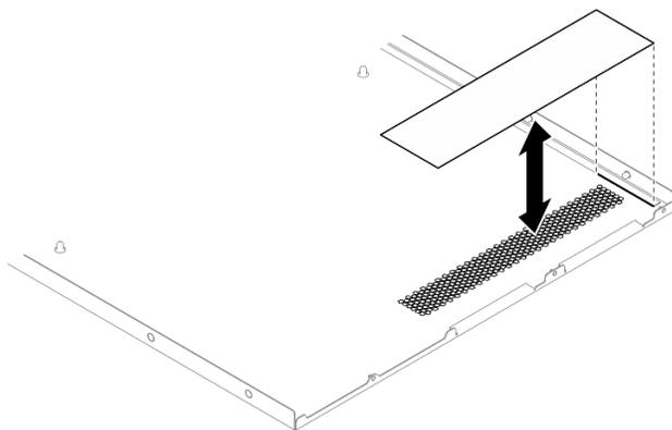
Figura 169. Rimozione del controllo del flusso d'aria del coperchio superiore
