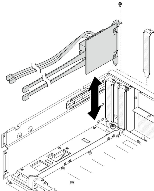
Figura 265. Installazione del Scheda della porta OSFP
