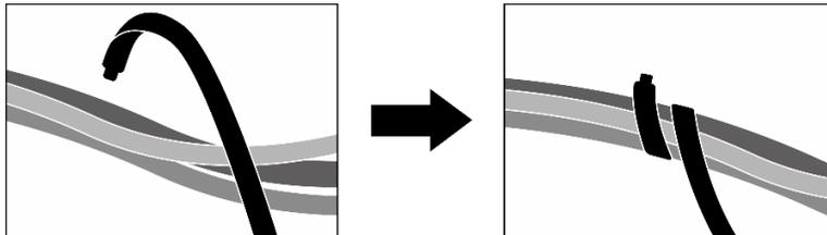
Figura 366. Fissaggio dei cavi con le fascette
