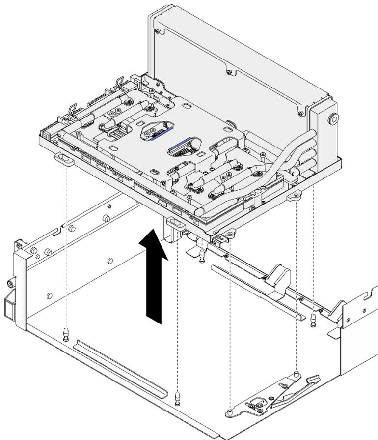
Figura 244. Rimozione dell'Assieme GPU-L2A
