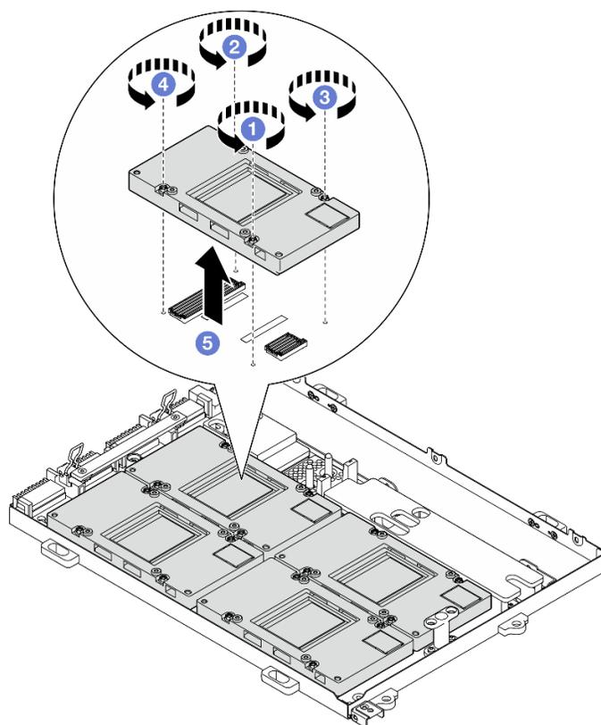
Figura 269. Rimozione della GPU SXM5
