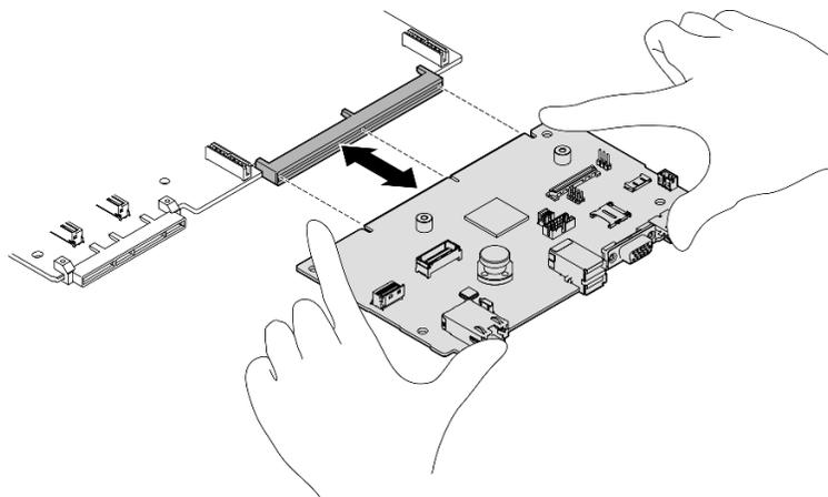
Figura 106. Rimozione della scheda I/O di sistema
