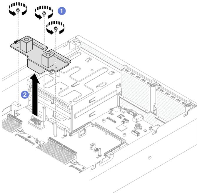
Figura 82. Rimozione della scheda di distribuzione dell'alimentazione
