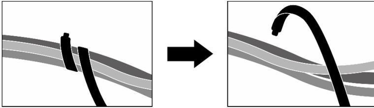
Figura 262. Rimozione delle fascette
