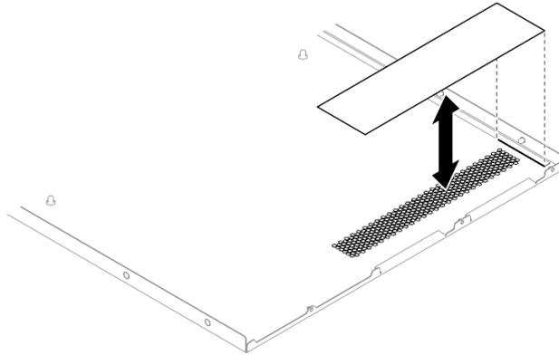
Figura 170. Installazione del controllo del flusso d'aria del coperchio superiore
