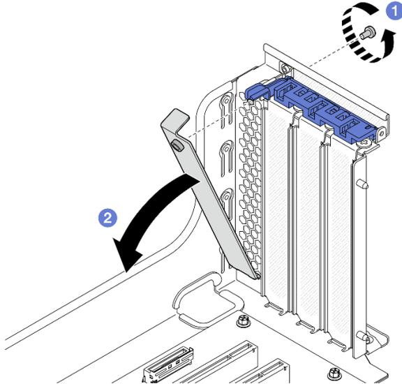
Figura 163. Rimozione del controllo del flusso d'aria della scheda verticale PCIe
