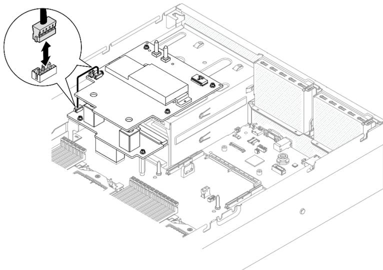
Figura 288. Collegamento del cavo laterale
