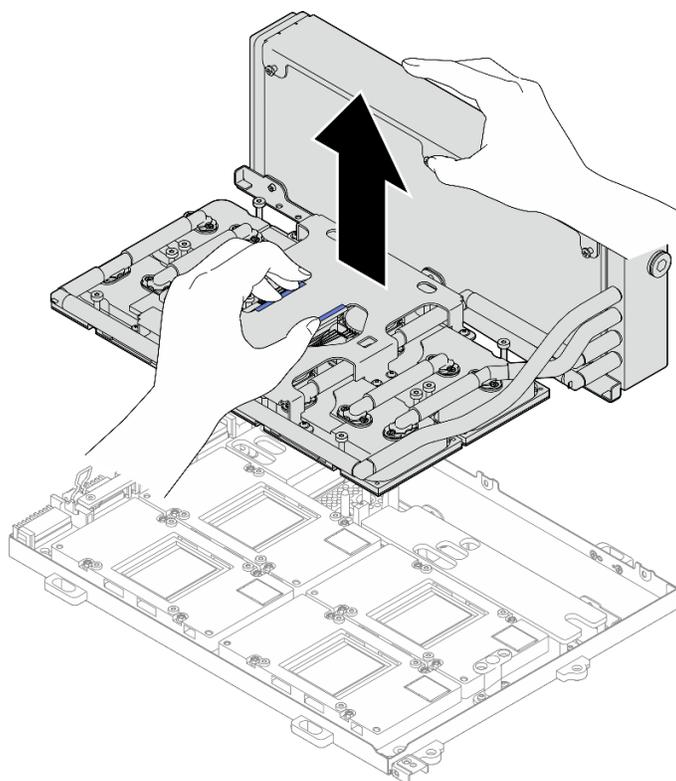
Figura 248. Rimozione del L2A
