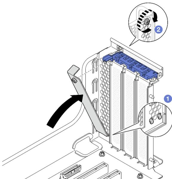
Figura 164. Installazione del controllo del flusso d'aria della scheda verticale PCIe
