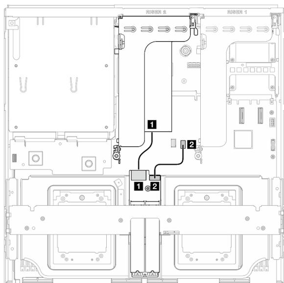
Figura 341. Instradamento dei cavi del backplane M.2 SATA/x4 NVMe (adattatore RAID sulla scheda verticale PCIe 2)
