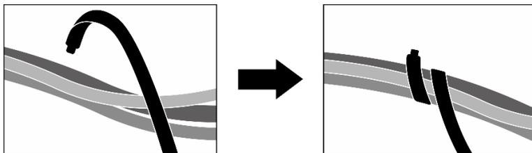
Figura 389. Fissaggio dei cavi con le fascette
