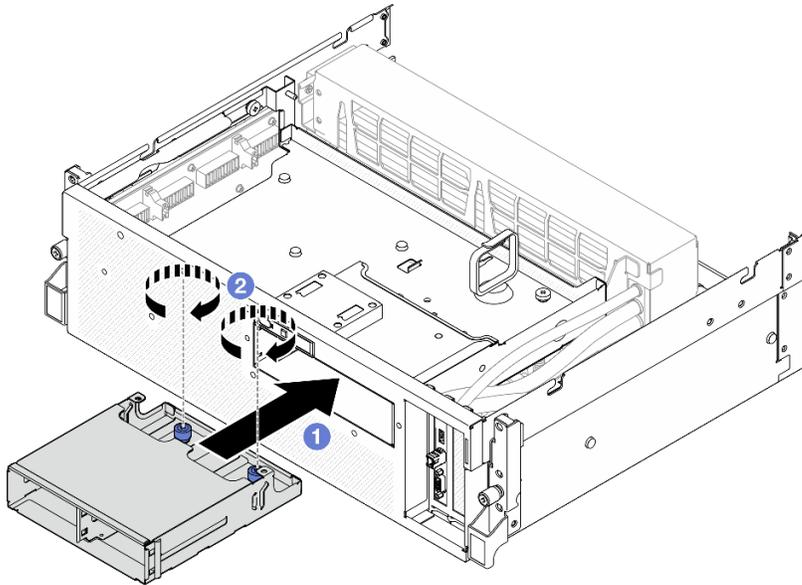
Figura 179. Installazione del telaio unità da 2,5"
