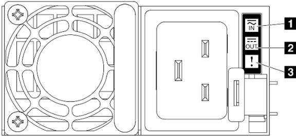
Figura 399. LED dell'alimentatore
