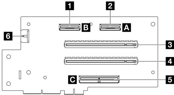
Figura 307. Connettori della scheda verticale PCIe con interfaccia host a tre cavi
