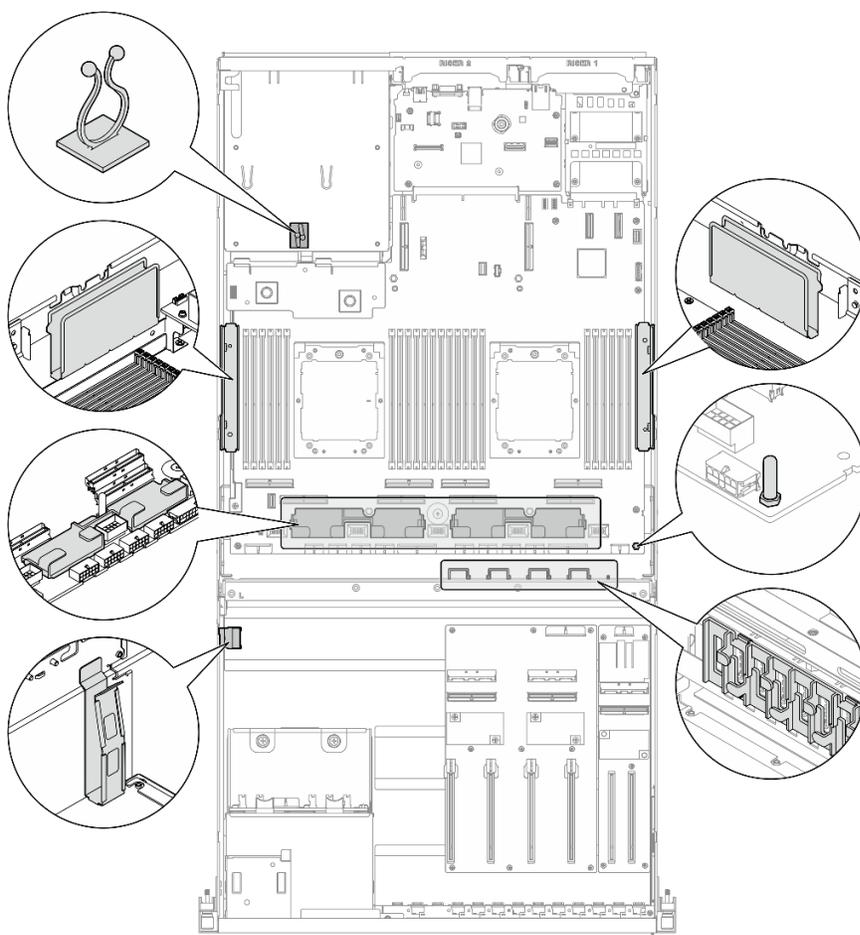
Figura 311. Posizioni della guida e dei fermi per i cavi nello chassis
