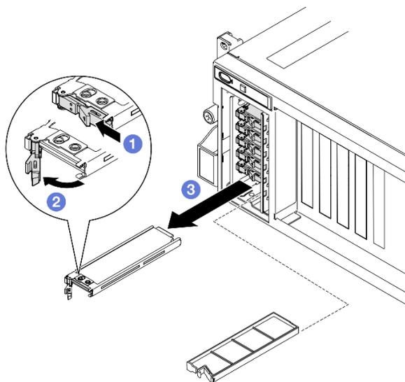
Figura 126. Rimozione dell'unità hot-swap E1.S
