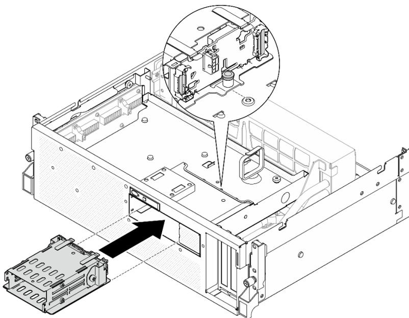
Figura 203. Installazione dell'assieme del telaio unità E3.S
