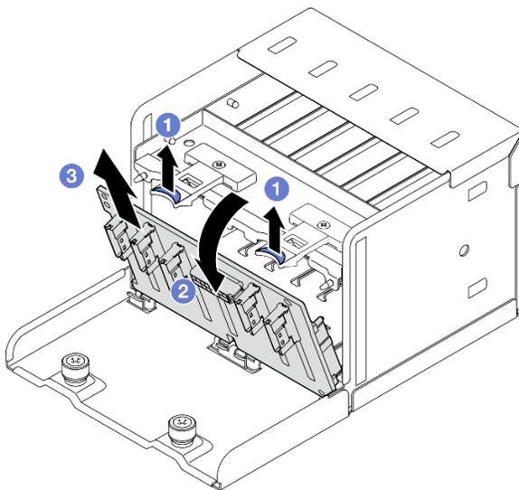
Figura 121. Rimozione del backplane dell'unità da 2,5"
