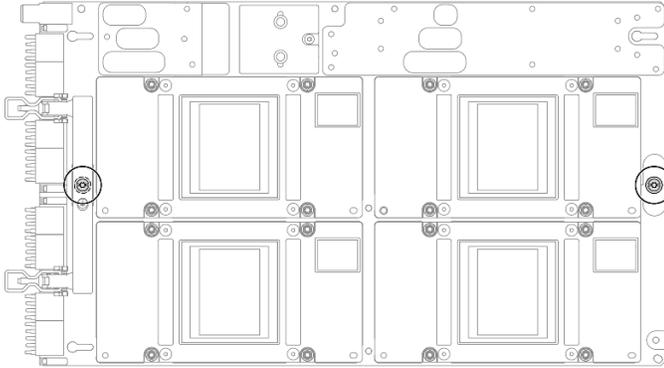
Figura 275. Rimozione delle viti T15
