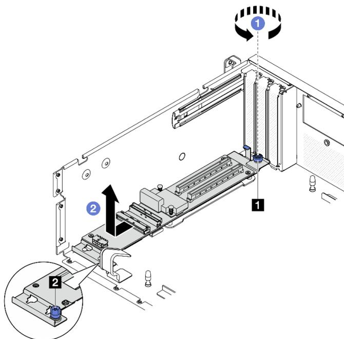
Figura 214. Rimozione del modulo della scheda di espansione I/O anteriore
