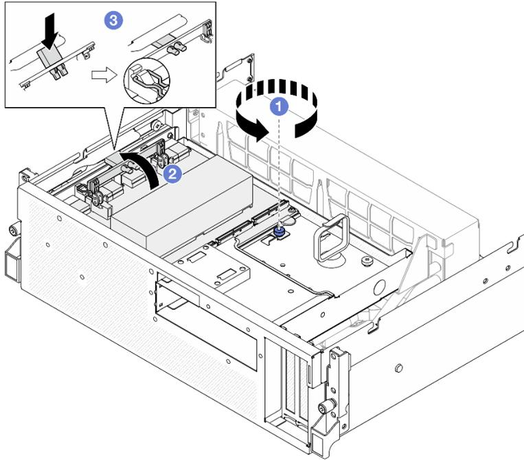
Figura 291. Rimozione della Scheda dello switch PCIe SXM5
