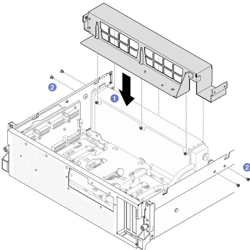
Figura 218. Installazione della staffa del radiatore
