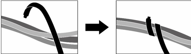
Figura 282. Fissaggio dei cavi con le fascette
