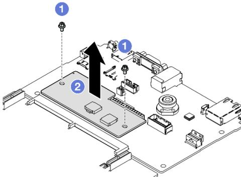
Figura 96. Rimozione del Modulo firmware e sicurezza RoT
