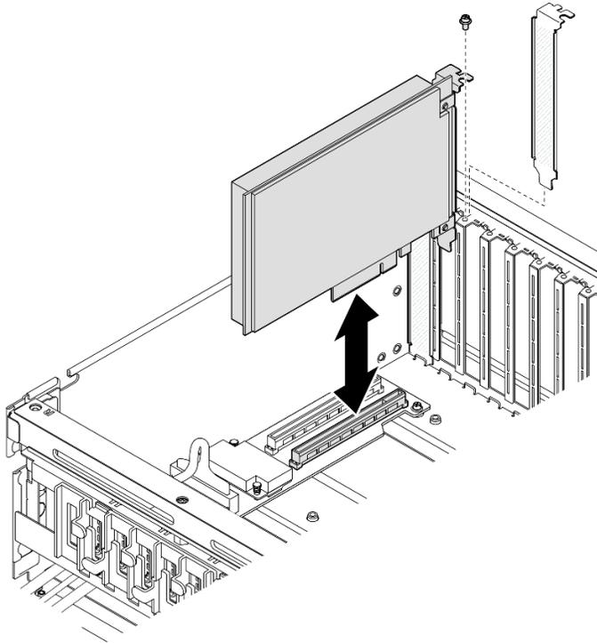
Figura 62. Installazione dell'adattatore PCIe anteriore
