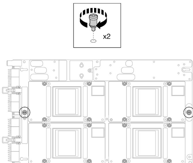
Figura 281. Installazione delle viti T15
