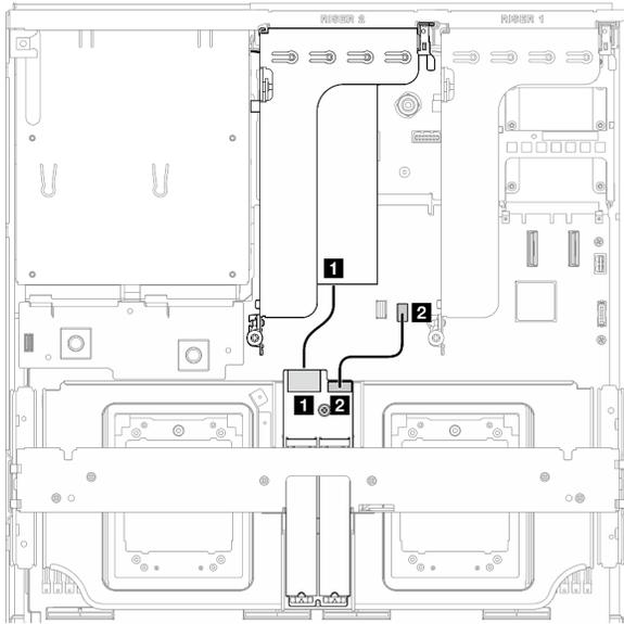
Figura 378. Instradamento dei cavi del backplane M.2 SATA/x4 NVMe (adattatore RAID sulla scheda verticale PCIe 2)
