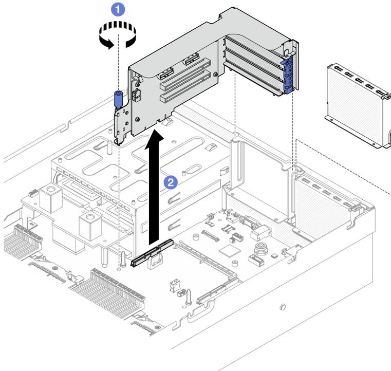
Figura 69. Rimozione della scheda verticale PCIe (senza modulo della porta seriale)
