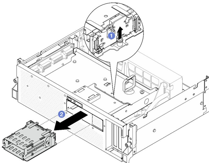
Figura 202. Rimozione dell'assieme del telaio unità E3.S
