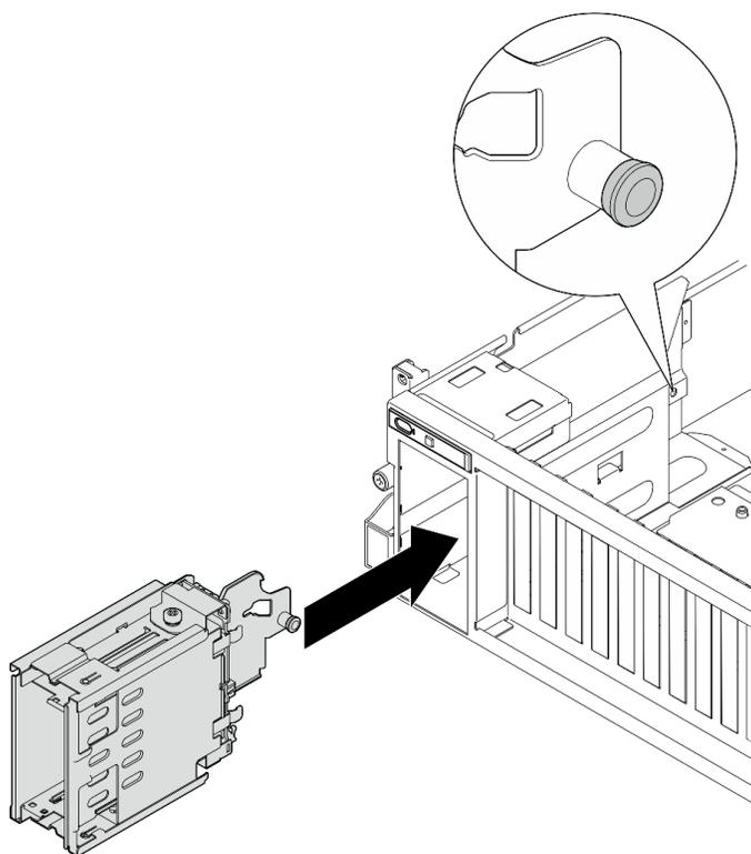
Figura 144. Installazione dell'assieme del telaio unità E3.S
