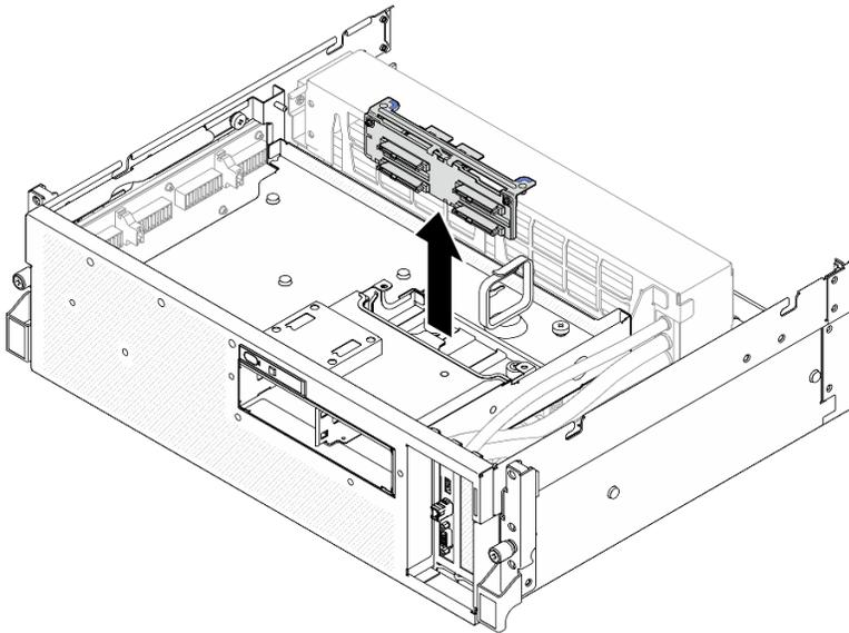
Figura 174. Rimozione del modulo backplane dell'unità da 2,5"
