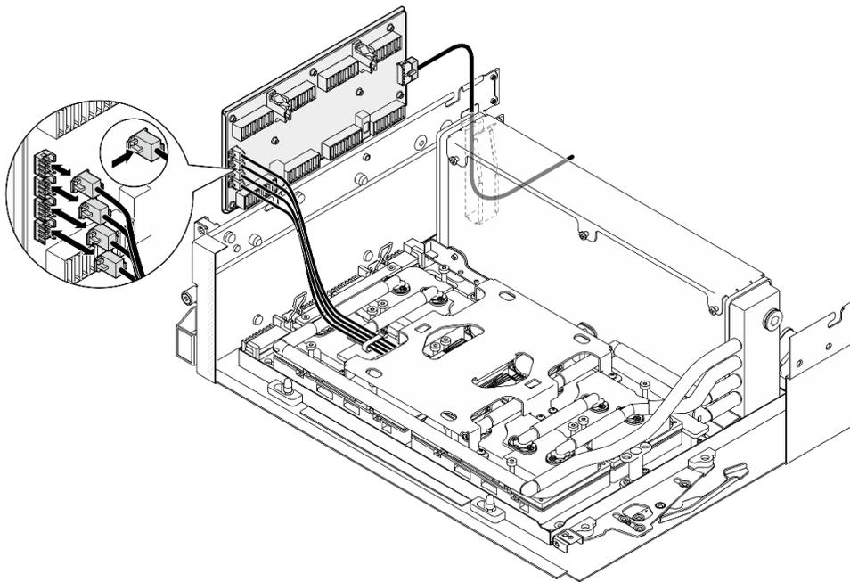
*Figura 231. Scollegamento dei cavi della pompa dell'assieme piastra a freddo*
