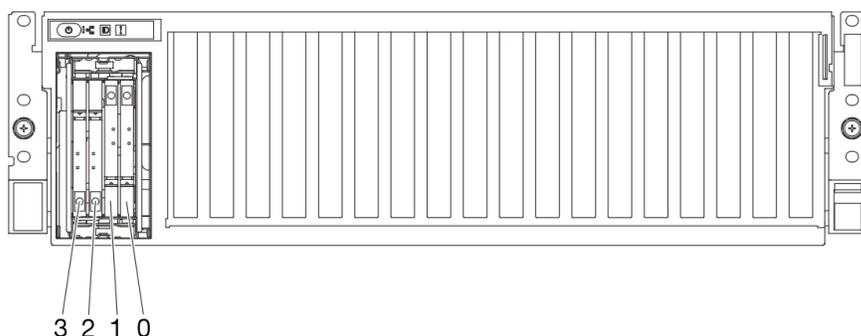
Figura 130. Numerazione dei vani delle unità hot-swap E3.S nel modello di GPU 8-DW
