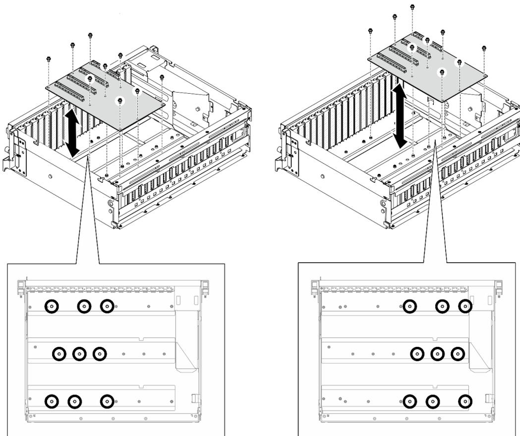
Figura 157. Installazione della scheda di distribuzione della GPU - modello di GPU 8-DW
