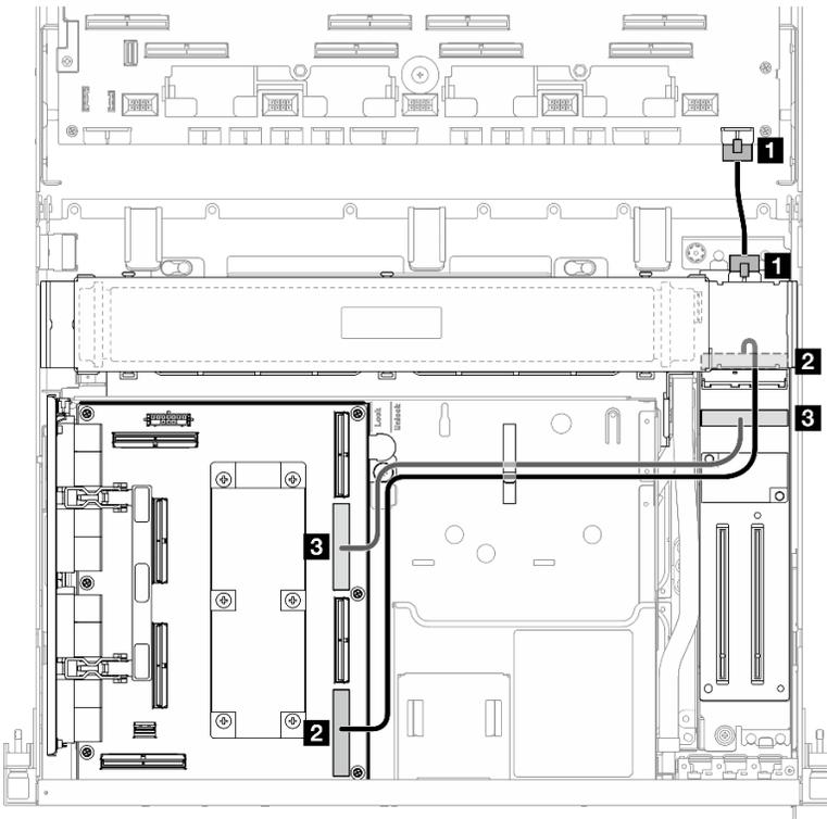
Figura 374. Instradamento dei cavi per la scheda di espansione I/O anteriore
