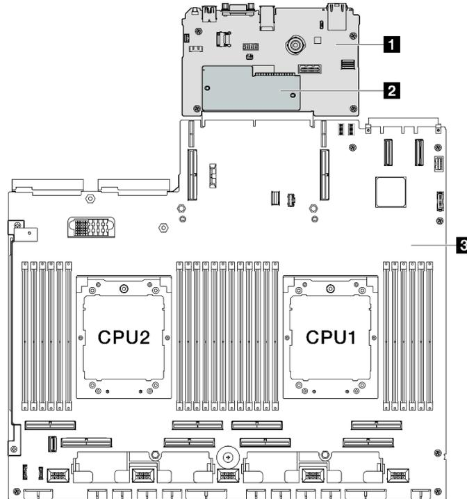
Figura 95. Layout dell'assieme della scheda di sistema
