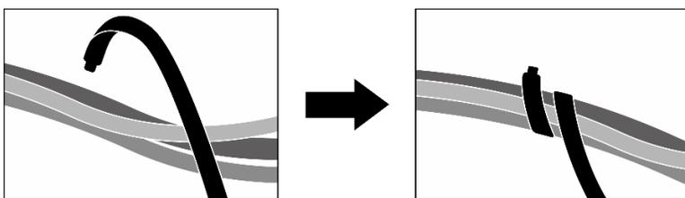
Figura 266. Fissaggio dei cavi con le fascette
