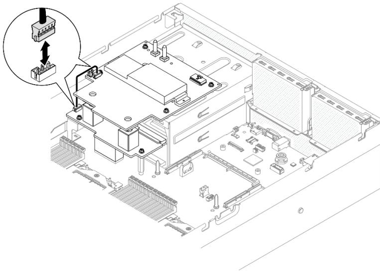
Figura 284. Scollegamento del cavo laterale
