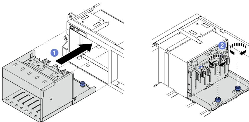
Figura 124. Installazione dell'assieme del telaio unità da 2,5"
