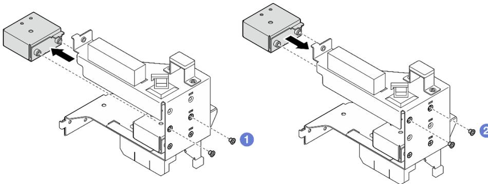
Figura 66. Regolazione della posizione della staffa di supporto half-height PCIe
