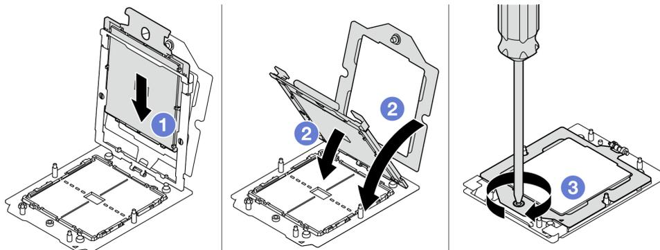
Figura 90. Installazione del processore
