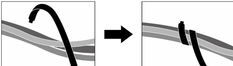
Figura 219. Fissaggio dei cavi con le fascette
