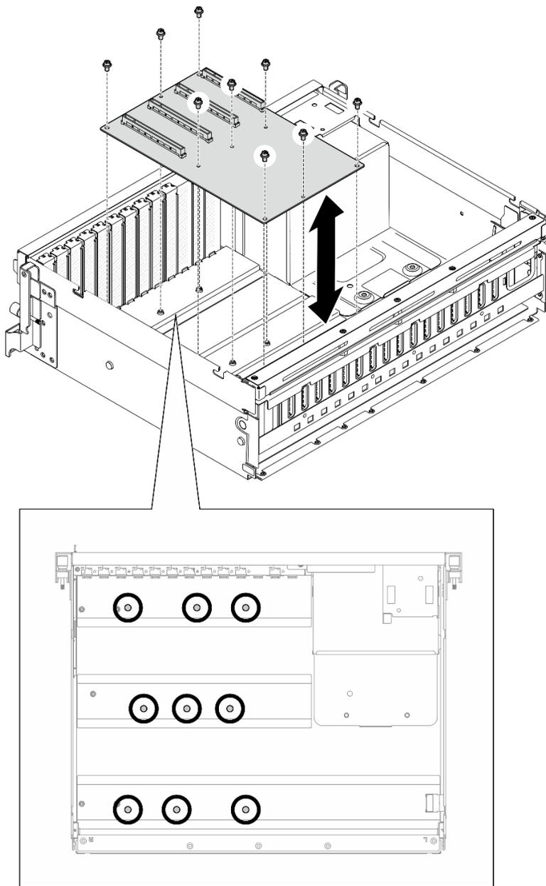
Figura 154. Rimozione della scheda di distribuzione della GPU - modello di GPU 4-DW
