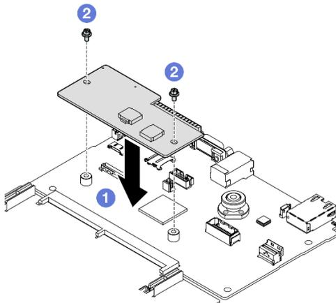
Figura 97. Installazione del Modulo firmware e sicurezza RoT
