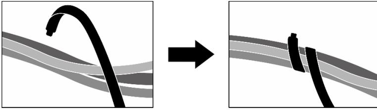
Figura 385. Fissaggio dei cavi con le fascette
