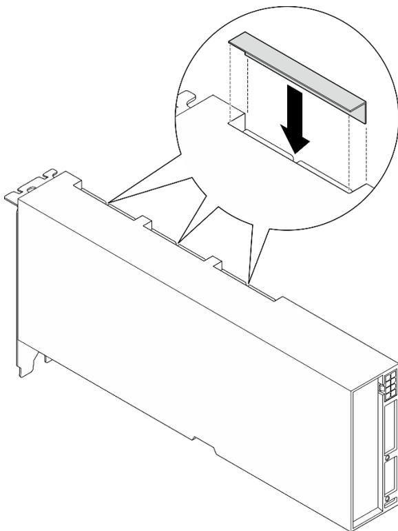
Figura 150. Installazione del coperchio del connettore di collegamento
