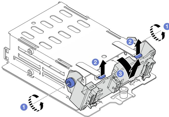
Figura 198. Rimozione del modulo backplane dell'unità E3.S
