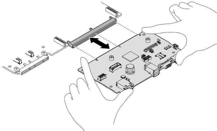
Figura 107. Installazione della scheda I/O di sistema
