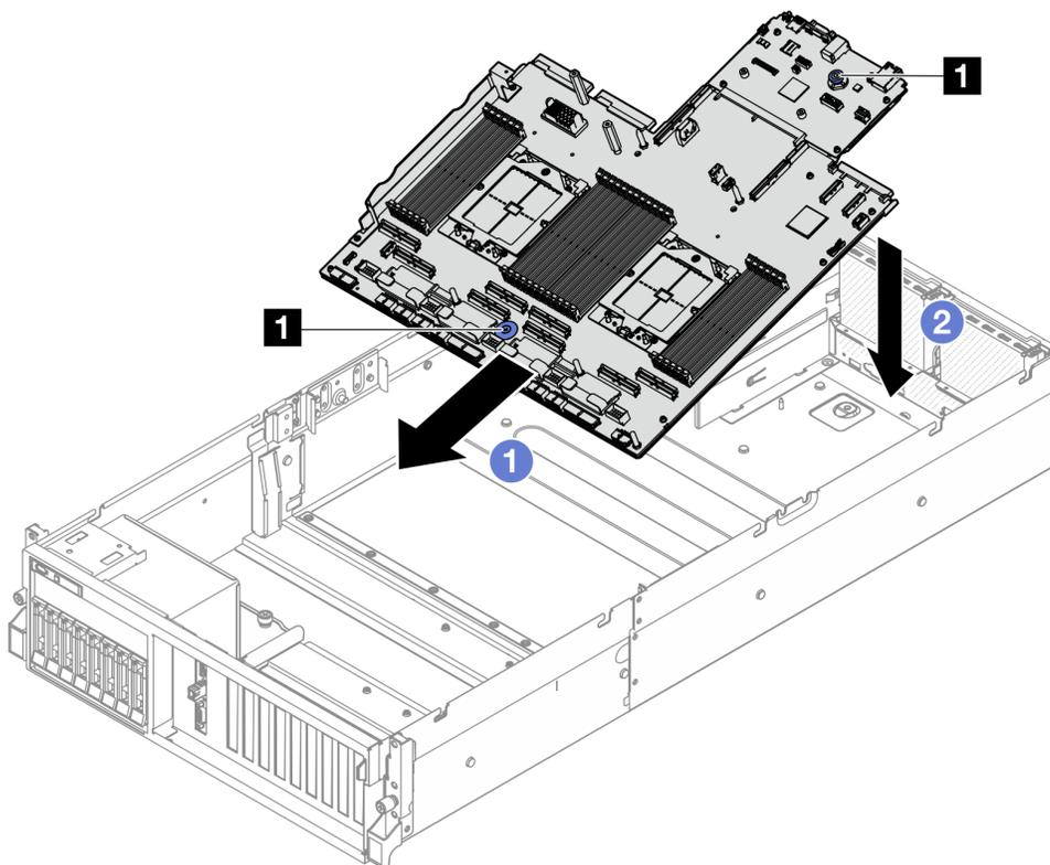
Figura 114. Installazione dell'assieme della scheda di sistema
