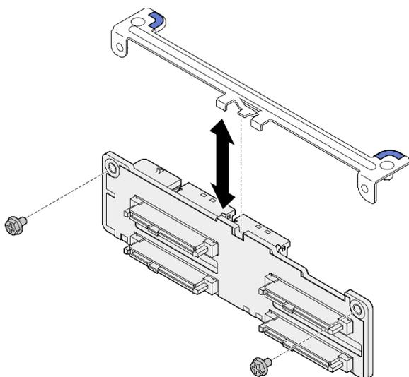
Figura 175. Rimozione della staffa del backplane dell'unità da 2,5"
