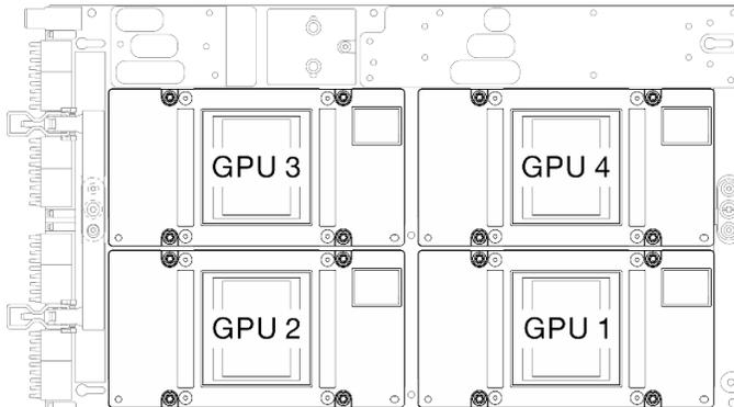
Figura 267. Numerazione GPU SXM5
