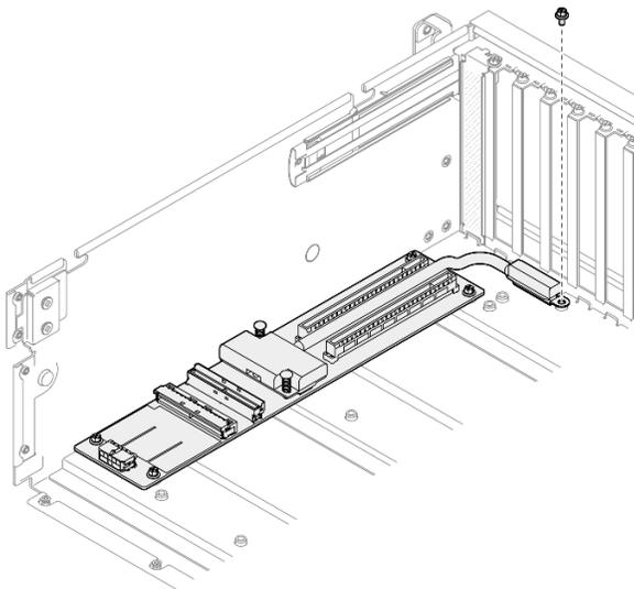
Figura 145. Rimozione delle viti
