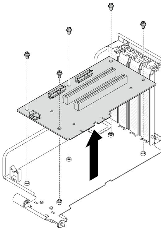
*Figura 70. Rimozione della scheda verticale PCIe*
