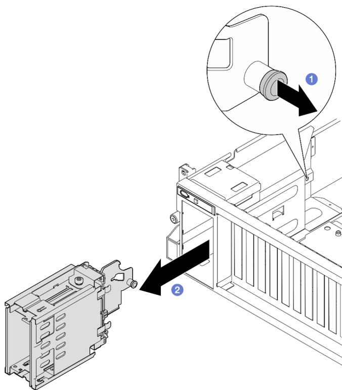
Figura 142. Rimozione dell'assieme del telaio unità E3.S
