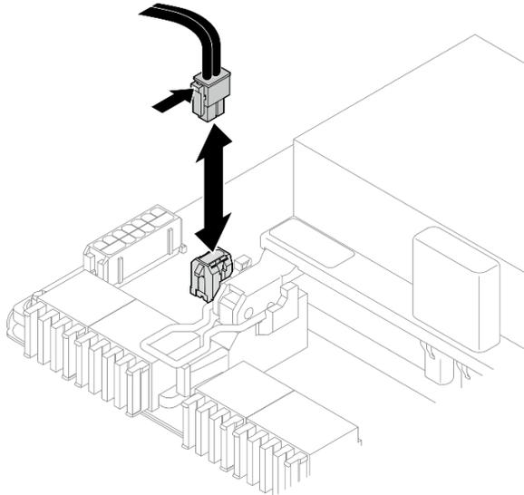
Figura 187. Scollegamento del cavo di alimentazione
