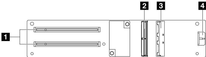
Figura 303. Connettori sulla scheda di espansione I/O anteriore
