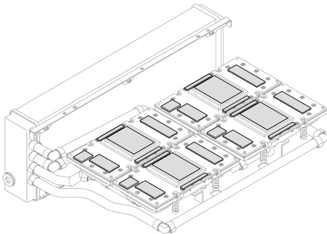
Figura 250. Rimozione PCM e tamponi di mastice dalle piastre a freddo
