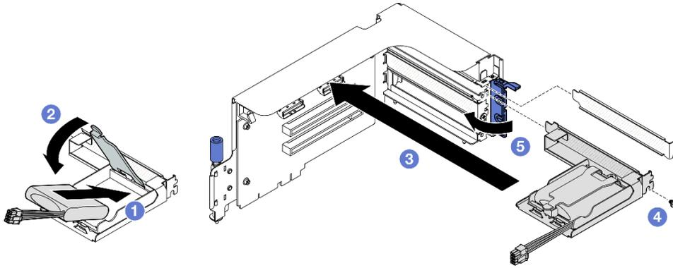
Figura 25. Installazione del modulo di alimentazione flash
