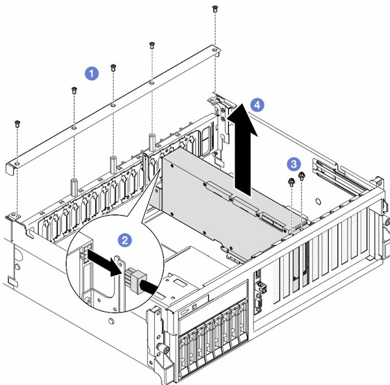
Figura 149. Rimozione dell'adattatore GPU
