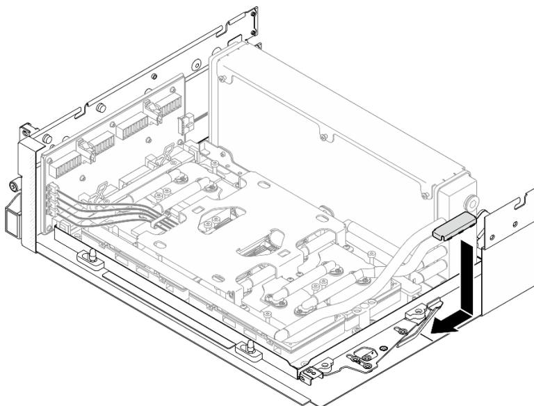
Figura 239. Installazione della staffa di blocco dell'Assieme della scheda GPU SXM5
