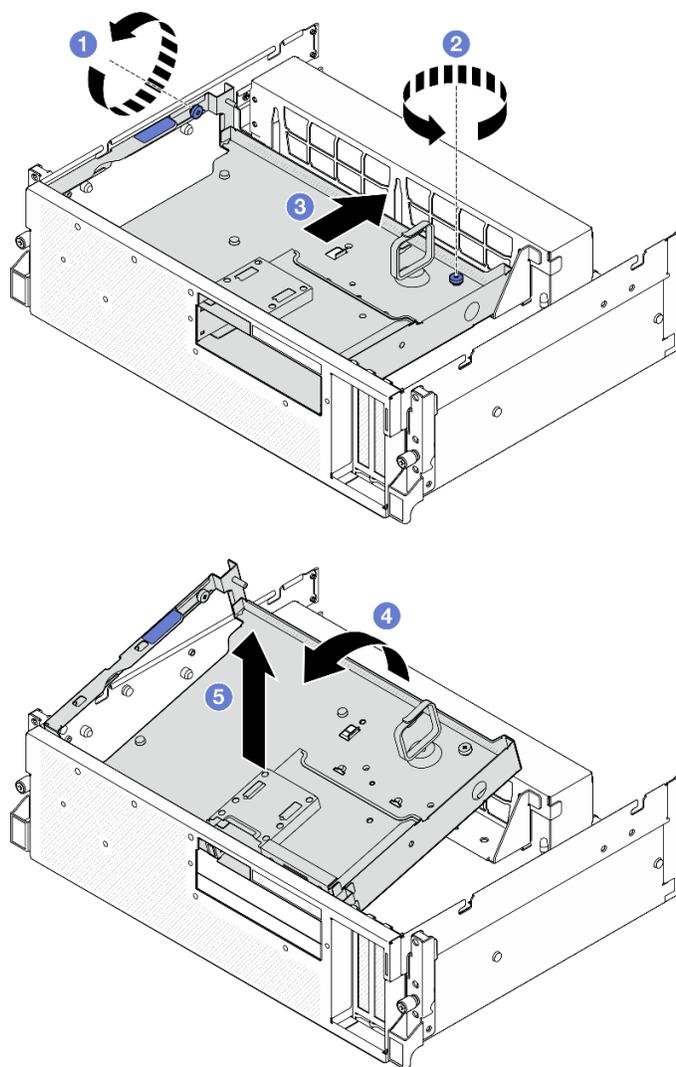
Figura 209. Rimozione del vassoio dell'unità anteriore
