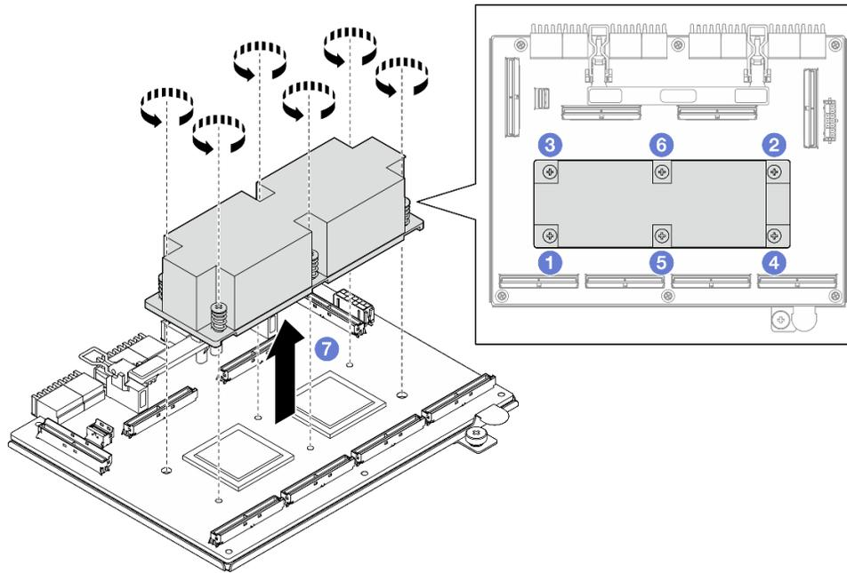
Figura 292. Rimozione del dissipatore di calore della Scheda dello switch PCIe SXM5
