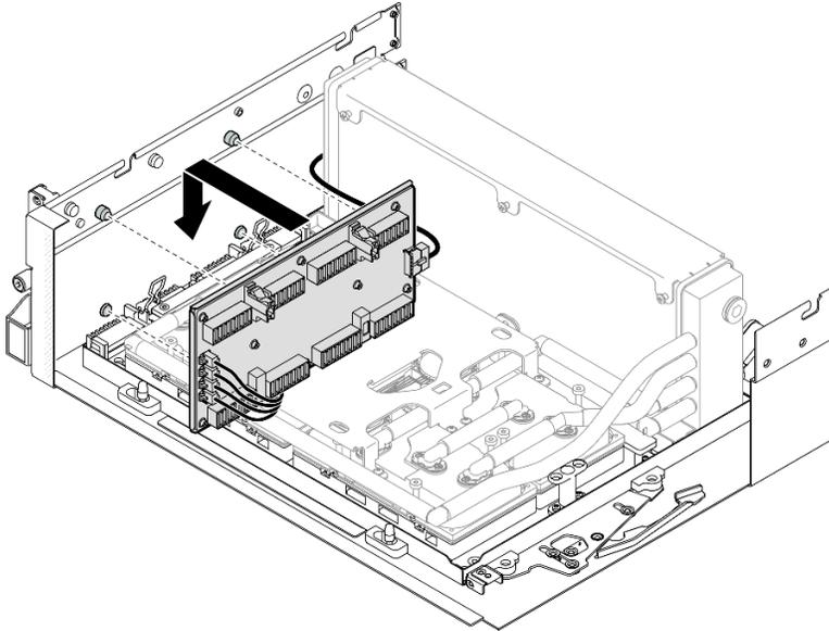
*Figura 237. Installazione della scheda interposer*
