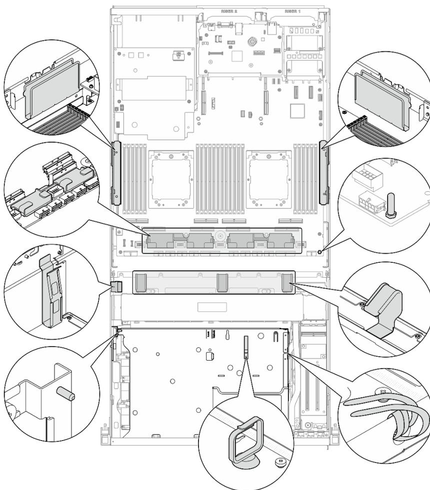
Figura 353. Posizioni della guida per cavi, del fermacavo, della guida di blocco dei cavi e delle fascette nello chassis
