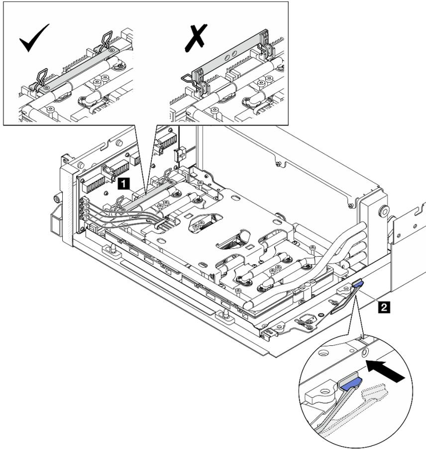
Figura 238. Regolazione Assieme GPU-L2A
