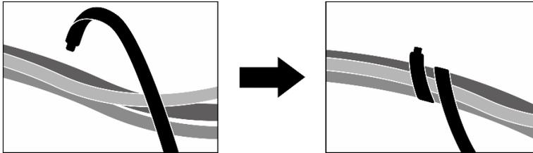
Figura 261. Fissaggio dei cavi con le fascette
