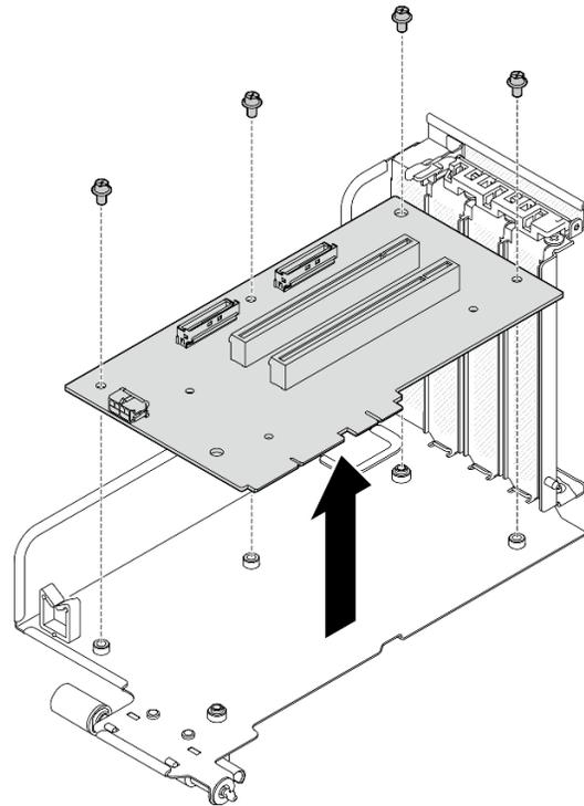
Figura 74. Rimozione della scheda verticale PCIe
