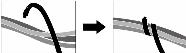
Figura 211. Fissaggio dei cavi con le fascette
