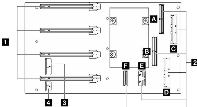
Figura 302. Connettori sulla Scheda di distribuzione della GPU commutata
