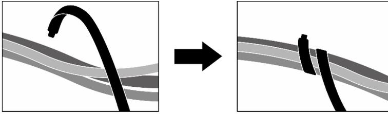
Figura 207. Fissaggio dei cavi con le fascette
