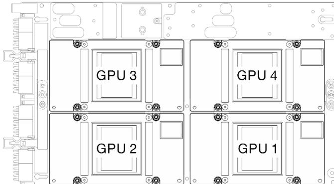
Figura 270. Numerazione GPU SXM5
