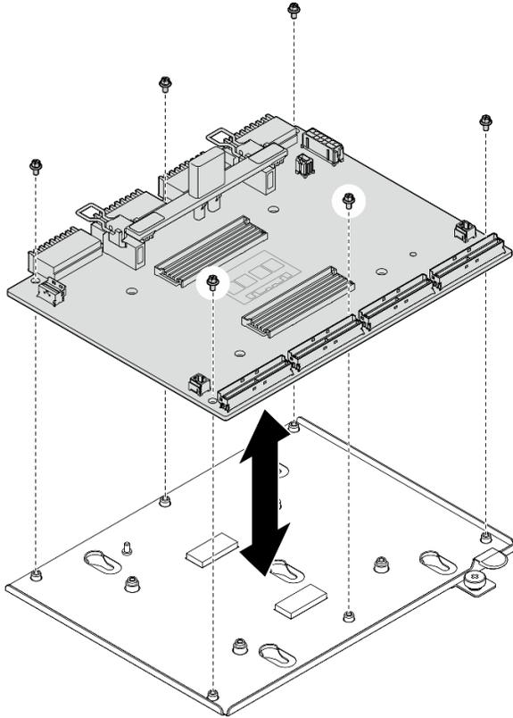
Figura 185. Smontaggio Scheda della piastra CX-7
