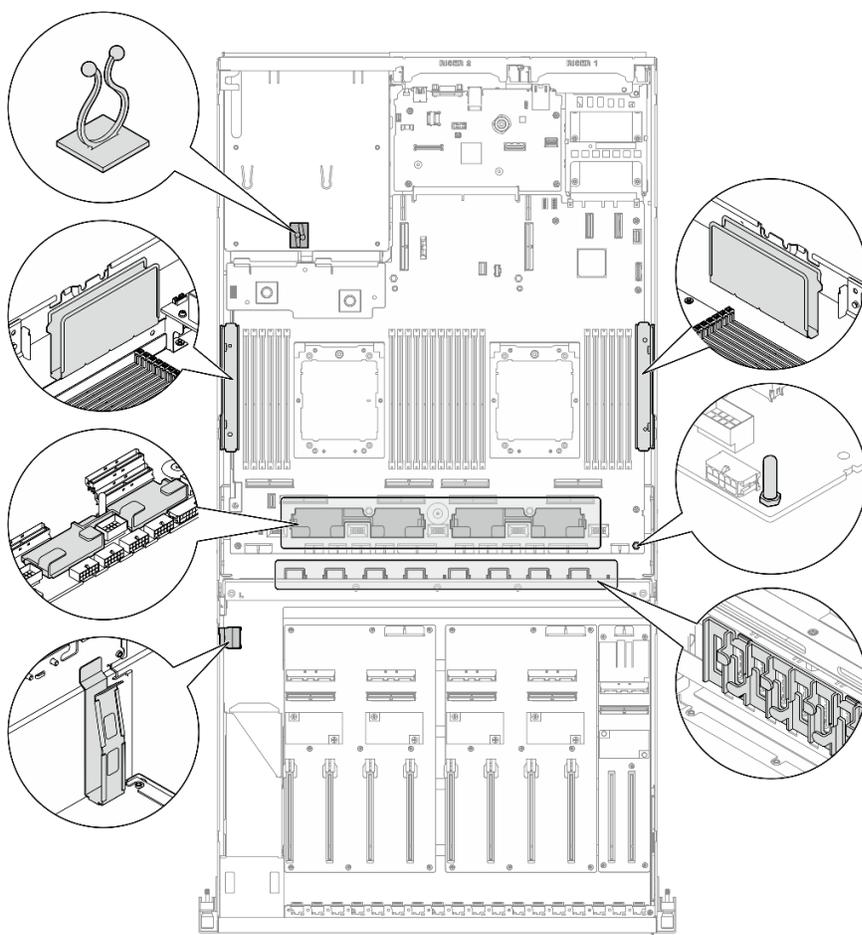
Figura 329. Posizioni della guida e dei fermi per i cavi nello chassis
