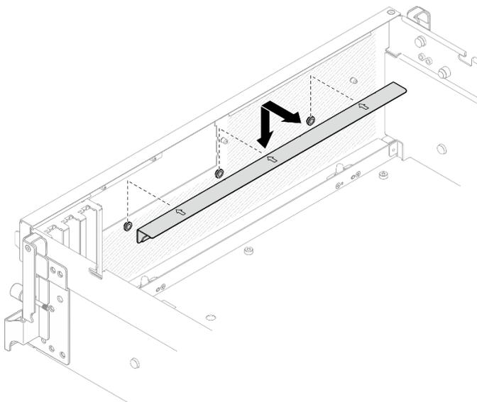
Figura 240. Installazione della staffa di supporto del vassoio dell'unità anteriore
