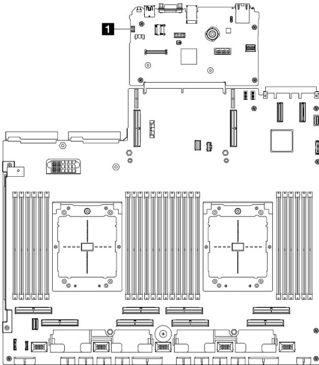
Figura 38. Posizione del connettore dello switch di intrusione
