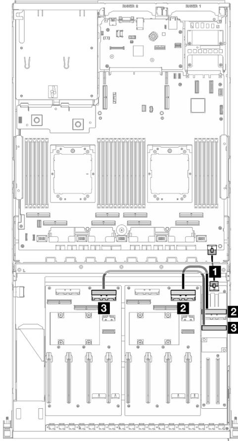
Figura 338. Instradamento dei cavi per la scheda di espansione I/O anteriore
