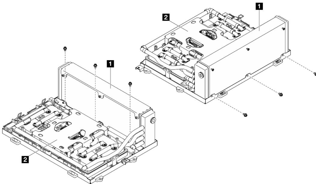
Figura 257. Installazione della vite Phillips #1
