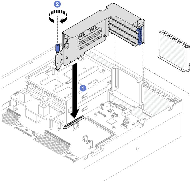
Figura 79. Installazione della scheda verticale PCIe (senza modulo della porta seriale)
