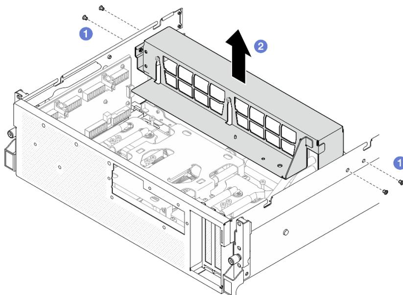
Figura 213. Rimozione della staffa del radiatore
