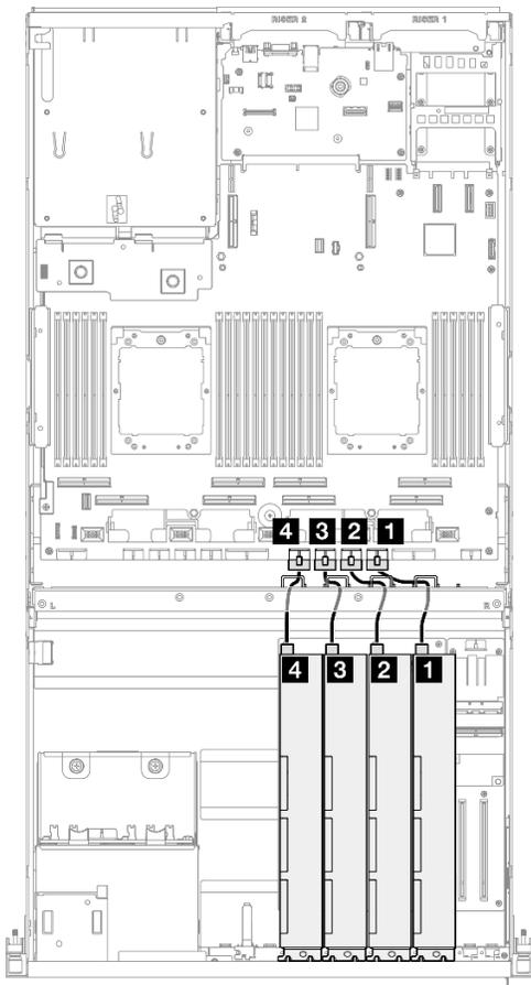
Figura 319. Intradamento dei cavi di alimentazione per gli adattatori GPU
