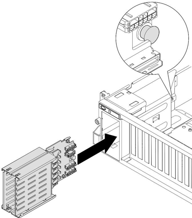
Figura 143. Installazione dell'assieme del telaio unità E1.S
