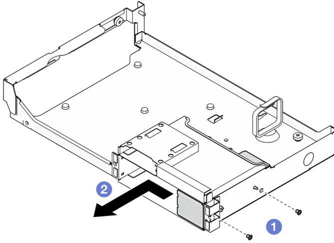
Figura 205. Rimozione dell'elemento di riempimento del telaio unità E3.S
