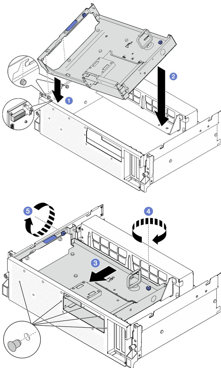
Figura 210. Installazione del vassoio dell'unità anteriore
