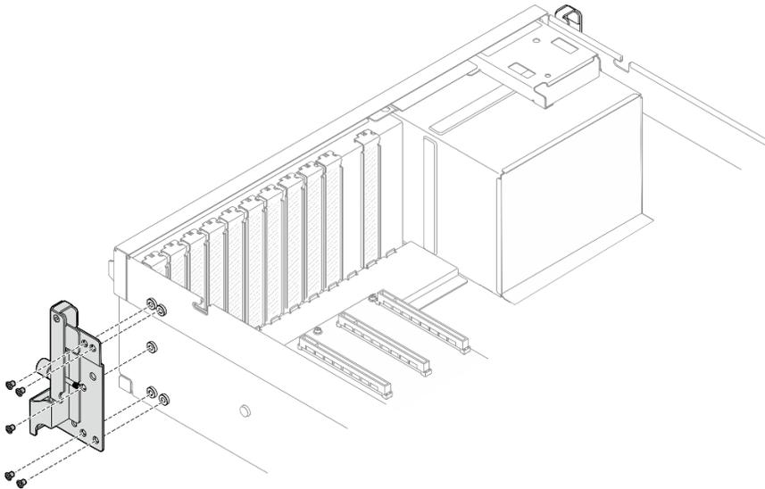
Figura 57. Installazione della staffa di montaggio destra
