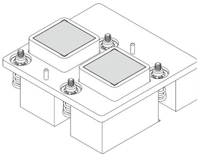
Figura 189. Rimozione dei tamponi di mastice dal Dissipatore di calore CX-7
