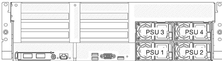
Figura 85. Numerazione del vano dell'alimentatore
