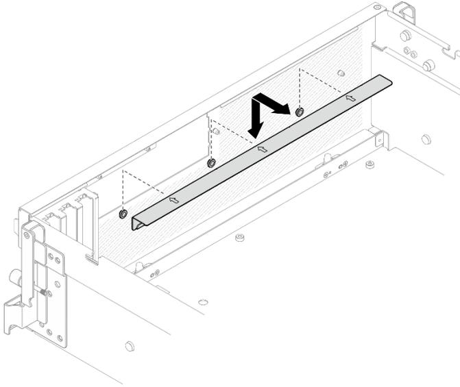
*Figura 227. Rimozione della staffa di supporto del vassoio dell'unità anteriore*
