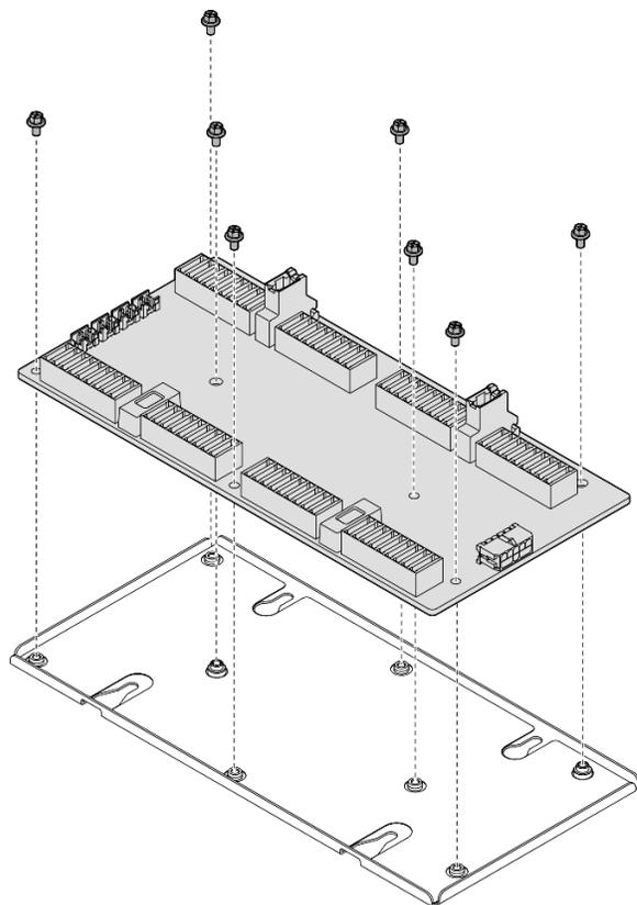
Figura 233. Smontaggio della scheda interposer
