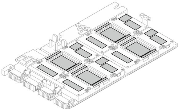
Figura 251. Rimozione PCM e tamponi di mastice dalle GPU SXM5
