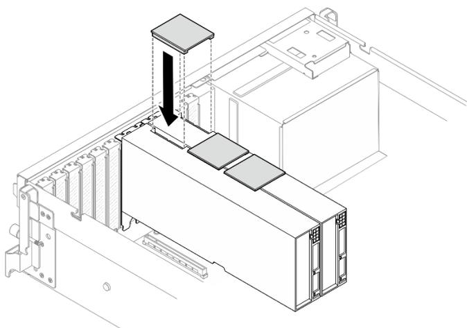
Figura 162. Installazione del Bridge di collegamento dell'adattatore GPU
