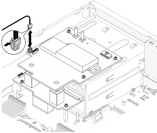
Figura 285. Scollegamento del cavo di alimentazione della Scheda della piastra CX-7
