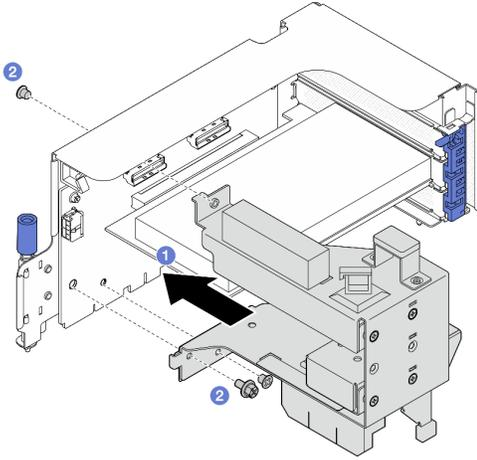
Figura 67. Installazione della staffa di blocco dell'adattatore PCIe
