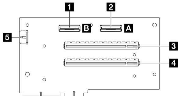
Figura 306. Connettori della scheda verticale PCIe con interfaccia host a due cavi
