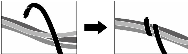
Figura 368. Fissaggio dei cavi con le fascette
