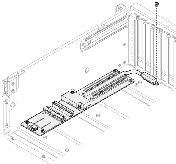
Figura 148. Installazione delle viti
