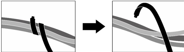
Figura 273. Rimozione delle fascette
