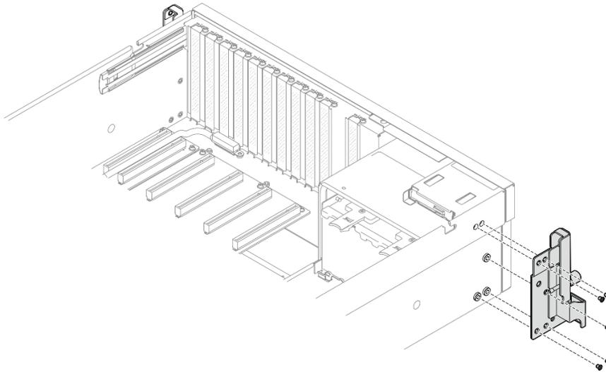
Figura 58. Installazione della staffa di montaggio sinistra
