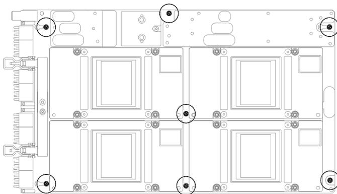
Figura 280. Installazione della vite Phillips #1
