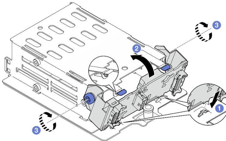
Figura 201. Installazione del modulo backplane dell'unità E3.S
