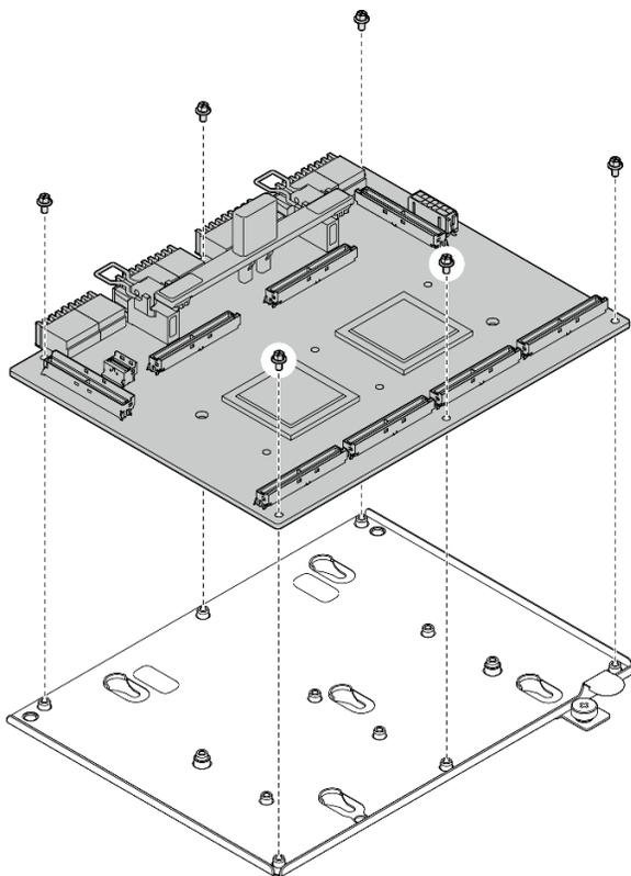
Figura 293. Smontaggio Scheda dello switch PCIe SXM5
