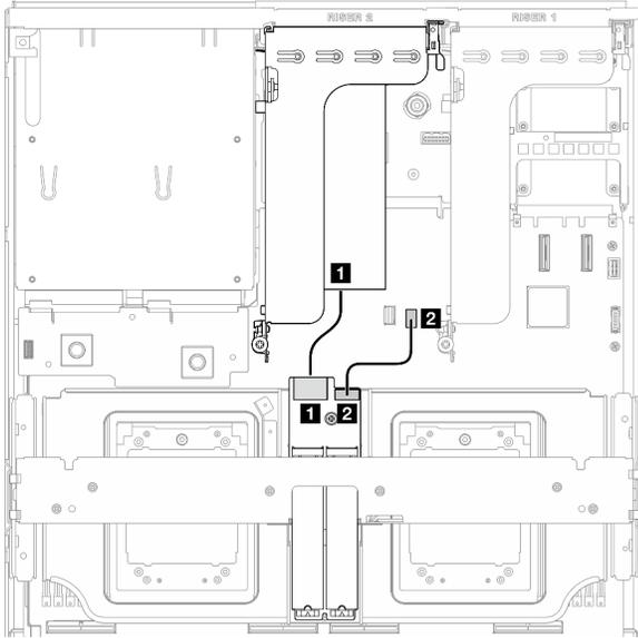
Figura 324. Instradamento dei cavi del backplane M.2 SATA/x4 NVMe (adattatore RAID sulla scheda verticale PCIe 2)
