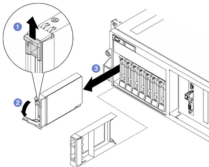
Figura 118. Rimozione di un'unità hot-swap da 2,5"
