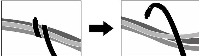
Figura 212. Rimozione delle fascette
