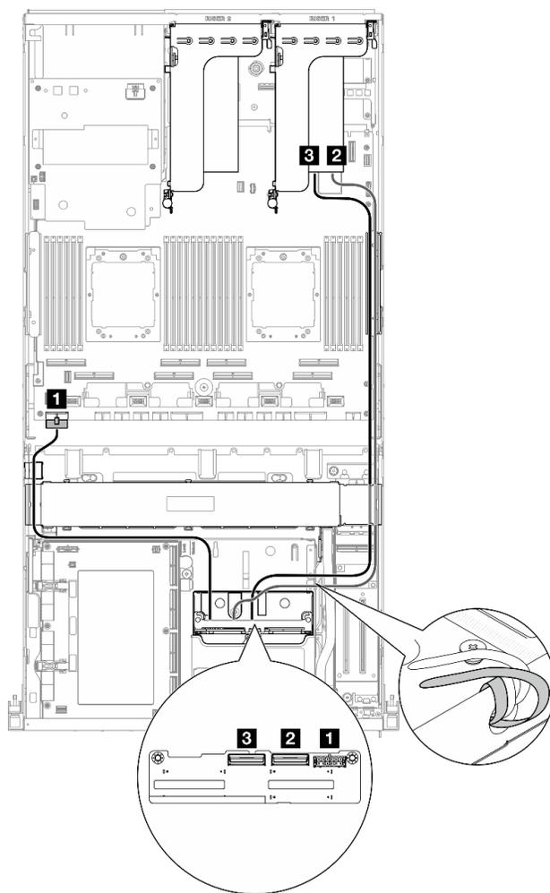
Figura 365. Instradamento dei cavi del backplane dell'unità da 2,5" (adattatore RAID sulla scheda verticale PCIe 1)
