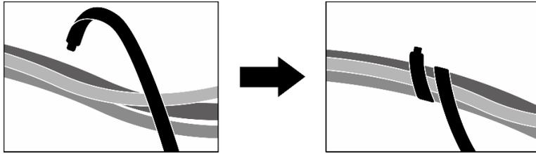
Figura 380. Fissaggio dei cavi con le fascette
