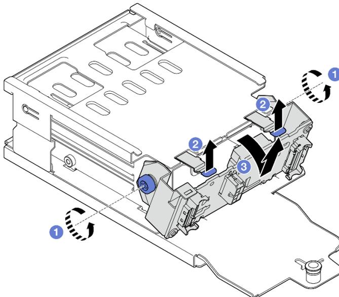
Figura 137. Rimozione del modulo backplane dell'unità E3.S
