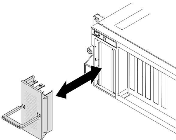
Figura 131. Rimozione del coperchio del telaio unità EDSFF
