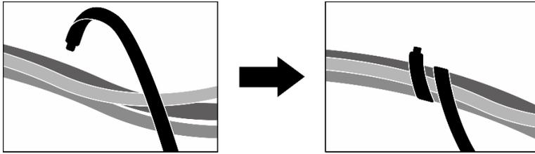
Figura 225. Fissaggio dei cavi con le fascette
