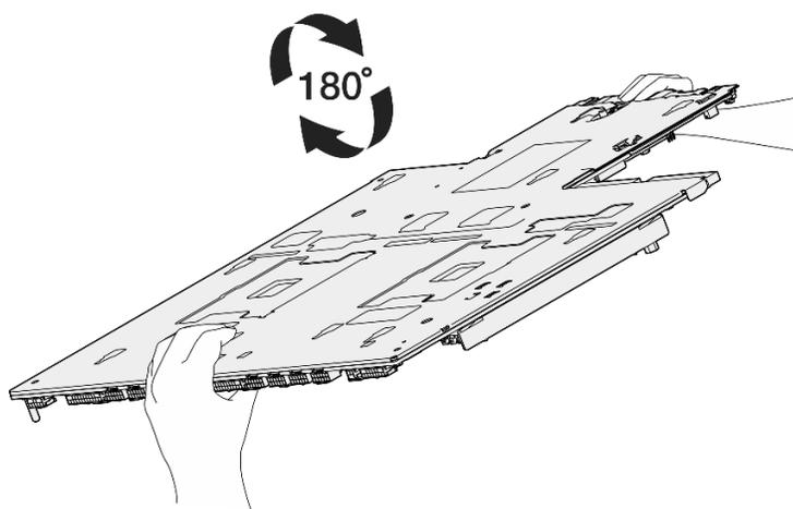
Figura 103. Capovolgimento dell'assieme della scheda di sistema
