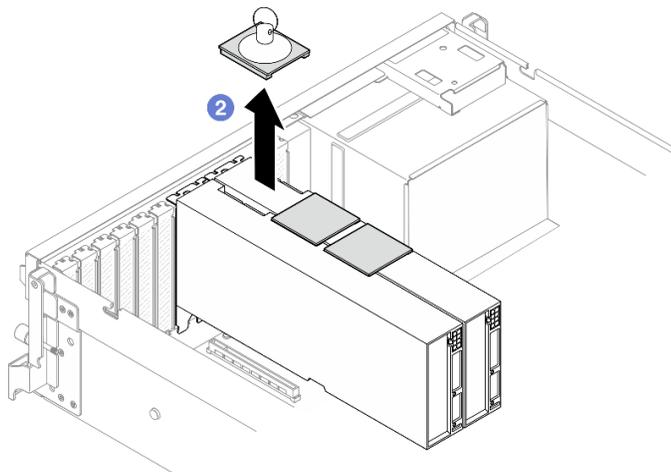
Figura 160. Rimozione del Bridge di collegamento dell'adattatore GPU
