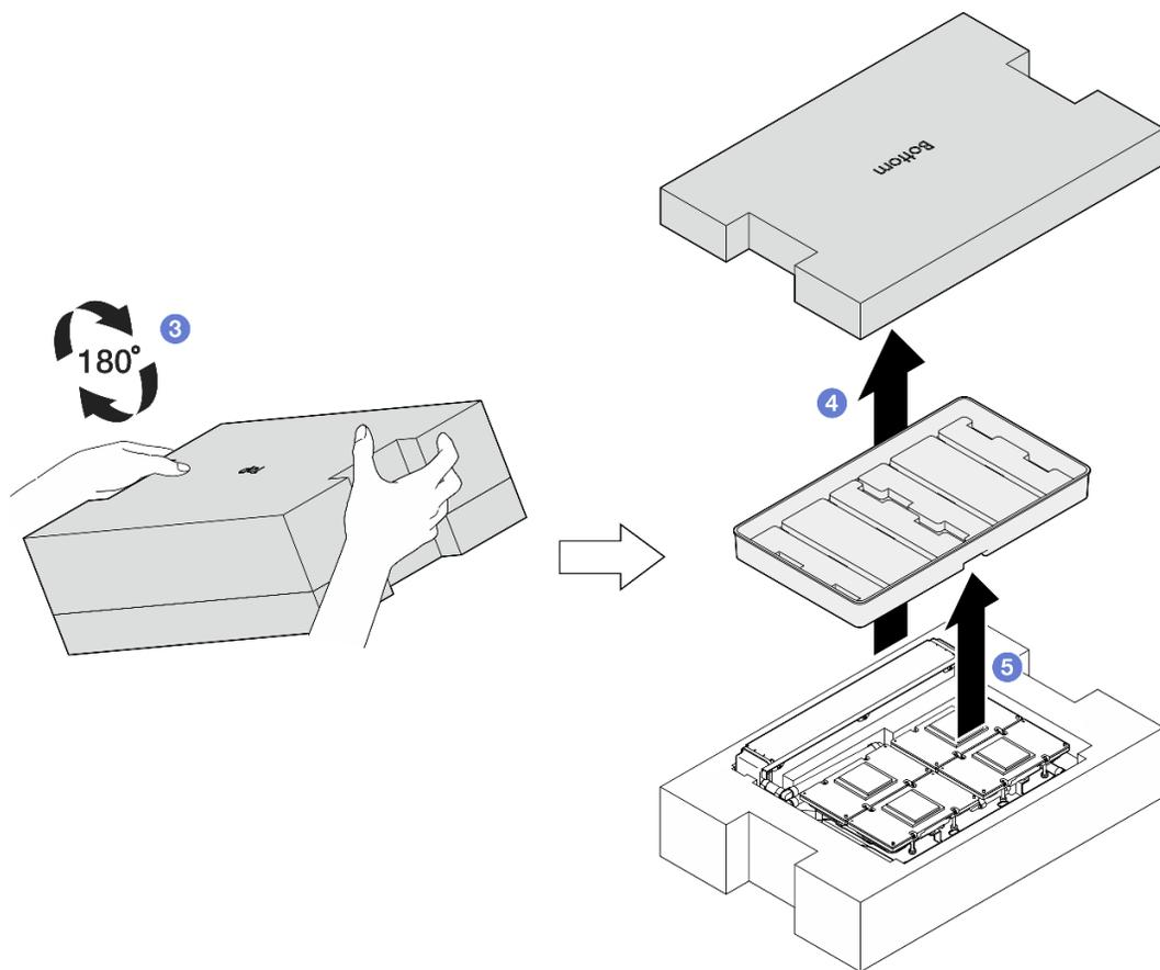
Figura 249. Capovolgimento del modulo L2A
