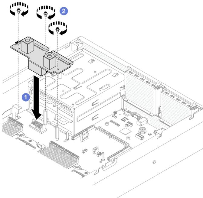
Figura 83. Installazione della scheda di distribuzione dell'alimentazione
