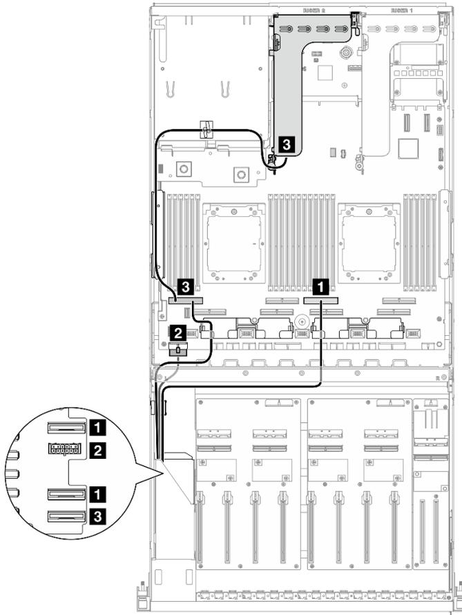
Figura 331. Intradamento dei cavi per il backplane dell'unità E1.S
