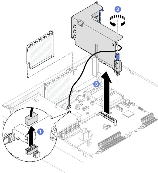
Figura 72. Rimozione della scheda verticale PCIe 1 (con modulo della porta seriale)
