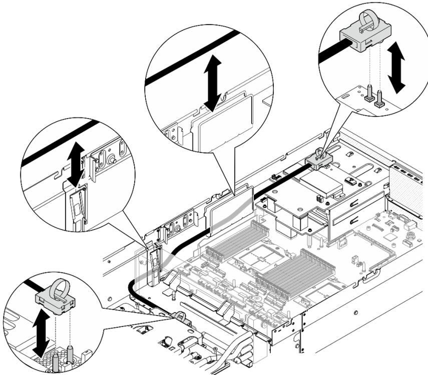
Passo 3. Mantenere il radiatore per il bordo superiore e la assieme piastra a freddo per la maniglia di sollevamento per estrarre l'Assieme GPU-L2A dallo chassis.
