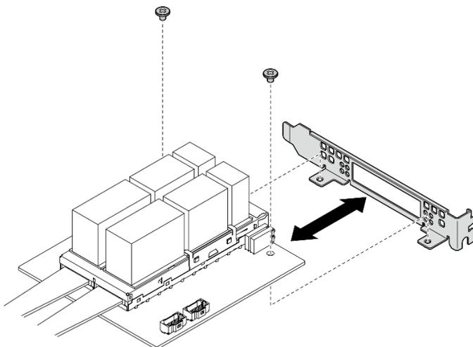
Figura 264. Smontaggio Scheda della porta OSFP
