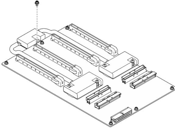
Figura 153. Rimozione delle viti
