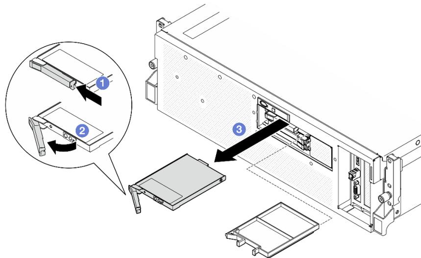
Figura 193. Rimozione dell'unità hot-swap E3.S
