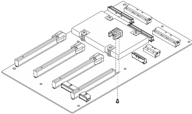
Figura 165. Rimozione del rinforzo dello slot PCIe
