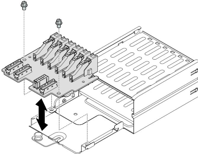
Figura 135. Rimozione del backplane dell'unità E1.S
