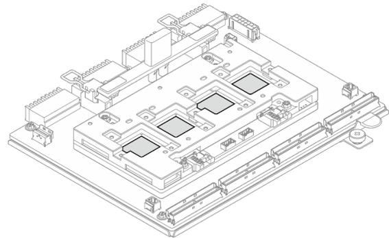
Figura 190. Rimozione dei tamponi di mastice dagli ASIC
