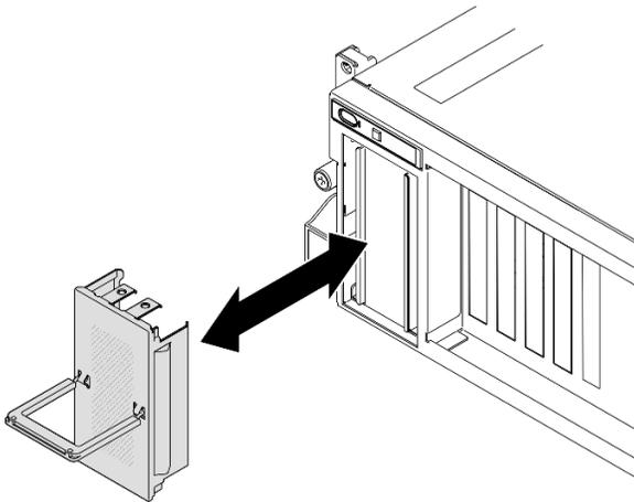
Figura 128. Installazione del coperchio del telaio unità EDSFF
