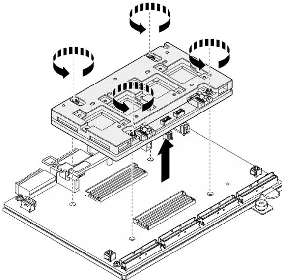
Figura 184. Rimozione del Scheda CX-7 Mezz
