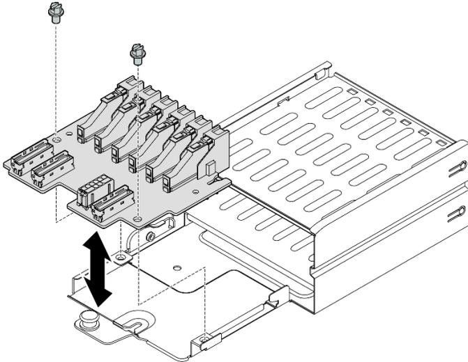
Figura 136. Installazione del backplane dell'unità E1.S
