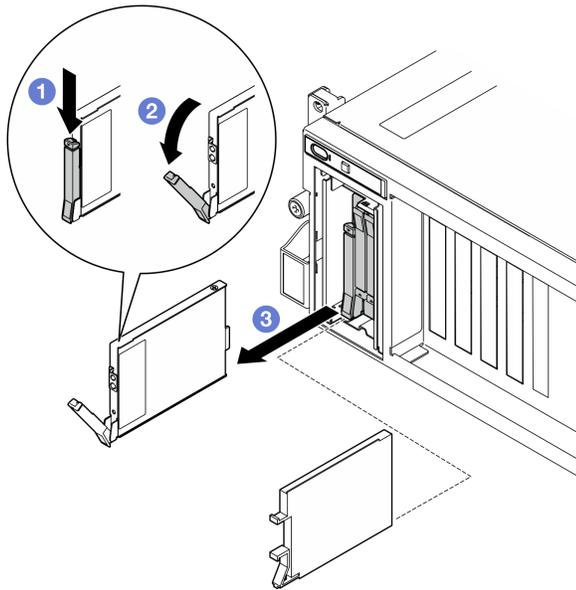
Figura 127. Rimozione dell'unità hot-swap E3.S
