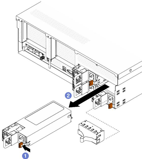
Figura 84. Rimozione dell'unità di alimentazione
