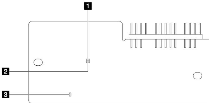
Figura 402. LED sul modulo firmware e sicurezza RoT
