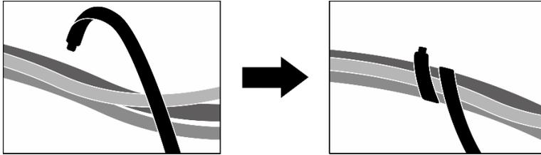
Figura 371. Fissaggio dei cavi con le fascette
