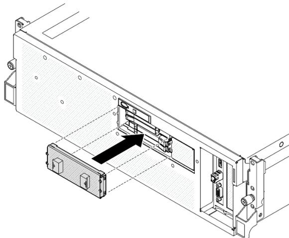
Figura 194. Installazione del coperchio del telaio unità E3.S
