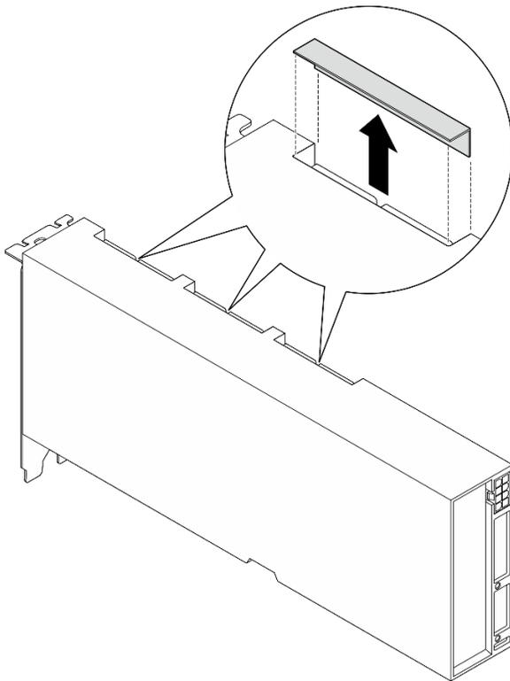
Figura 151. Rimozione del coperchio del connettore di collegamento
