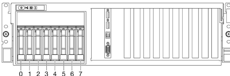
Figura 119. Numerazione dei vani delle unità da 2,5" nel modello di GPU 4-DW
