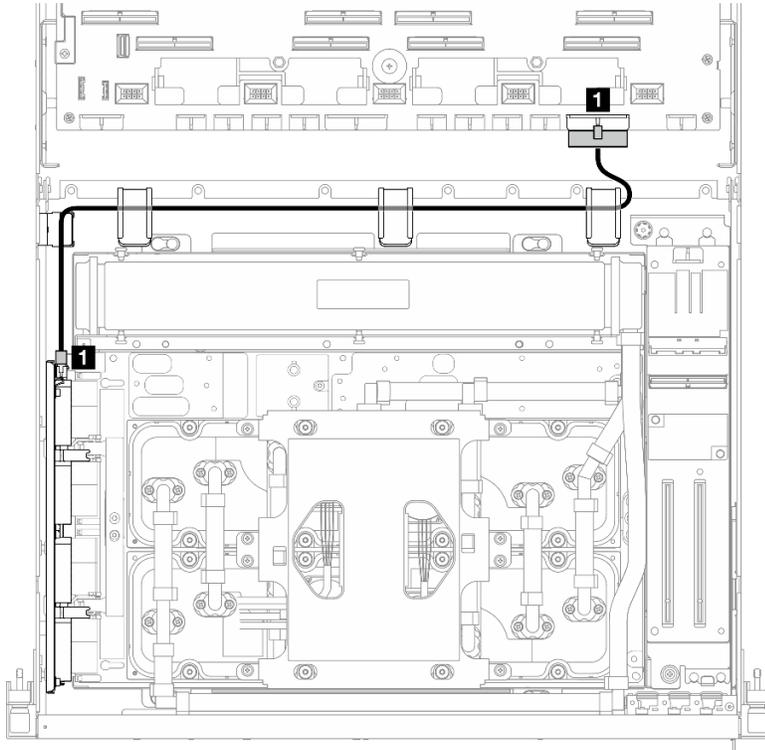
Figura 375. Instradamento dei cavi di alimentazione della scheda interposer
