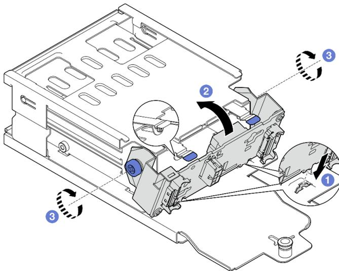
Figura 140. Installazione del modulo backplane dell'unità E3.S
