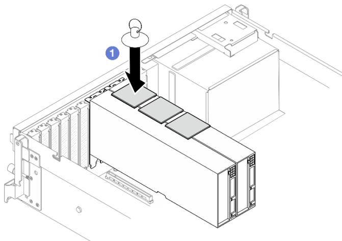
Figura 159. Rimozione del Bridge di collegamento dell'adattatore GPU
