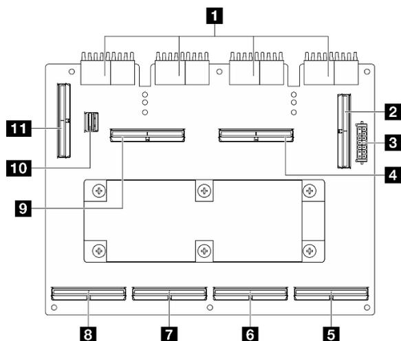
Figura 309. Connettori sulla Scheda dello switch PCIe SXM5
