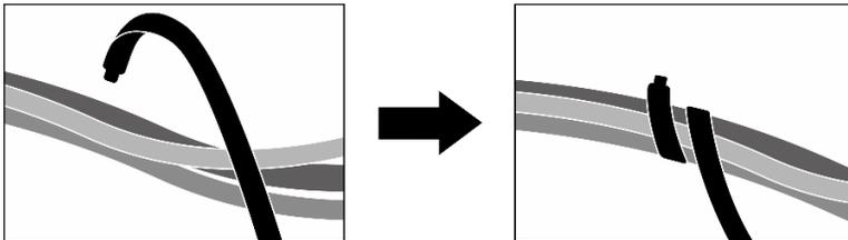
Figura 355. Fissaggio dei cavi con le fascette
