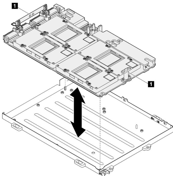
Figura 279. Installazione del Assieme della scheda GPU SXM5
