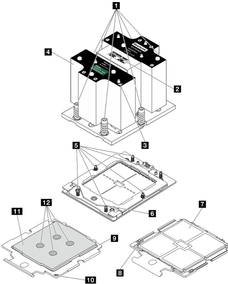
Figura 87. Componenti del processore e del dissipatore di calore
