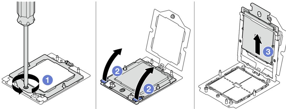
Figura 89. Rimozione del processore
