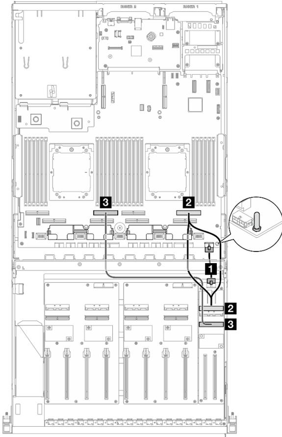
Figura 335. Instradamento dei cavi per la scheda di espansione I/O anteriore
