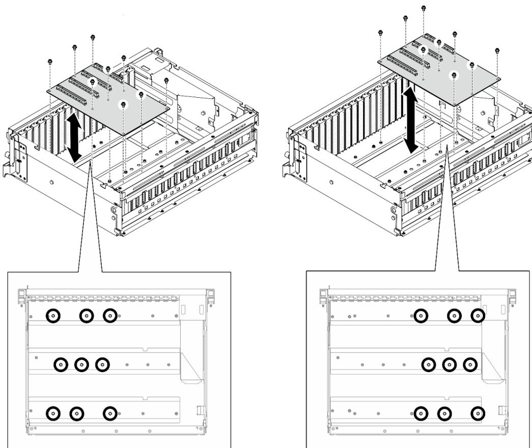
Figura 155. Rimozione della scheda di distribuzione della GPU - modello di GPU 8-DW
