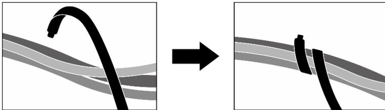
Figura 272. Fissaggio dei cavi con le fascette
