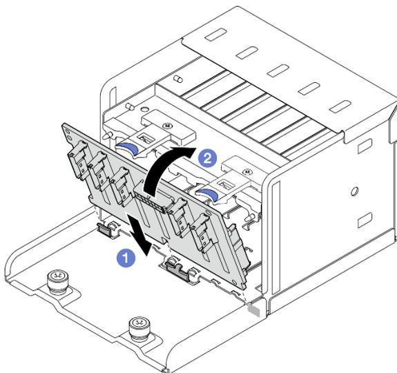
Figura 122. Installazione del backplane dell'unità da 2,5"
