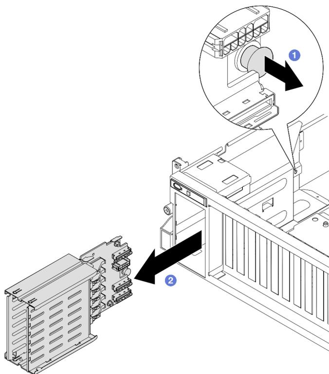
Figura 141. Rimozione dell'assieme del telaio unità E1.S
