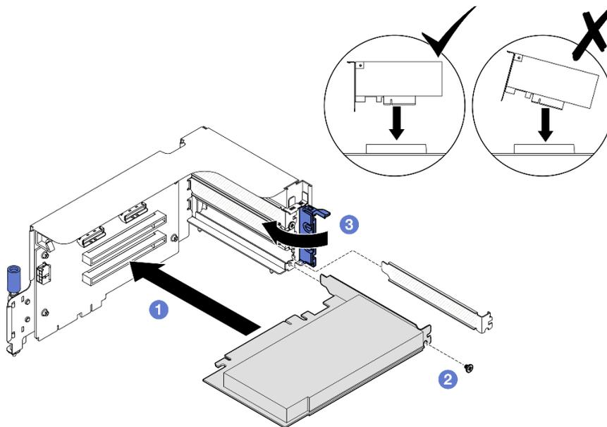
Figura 64. Installazione dell'adattatore PCIe posteriore
