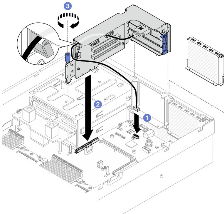
Figura 81. Installazione della scheda verticale PCIe 2 (con modulo della porta seriale)
