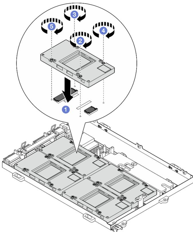
Figura 271. Installazione della GPU SXM5
