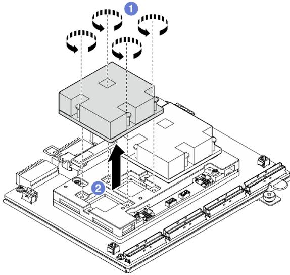
Figura 188. Rimozione del Dissipatore di calore CX-7
