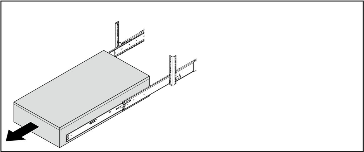
Passo 4. Sollevare la seconda coppia di fermi di blocco e rimuovere completamente il server dal rack, quindi posizionarlo su una superficie piana e stabile.
