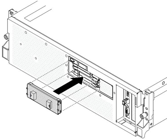
Figura 197. Installazione del coperchio del telaio unità E3.S
