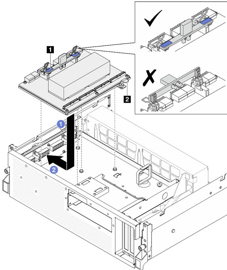
Figura 182. Installazione del Assieme CX-7
