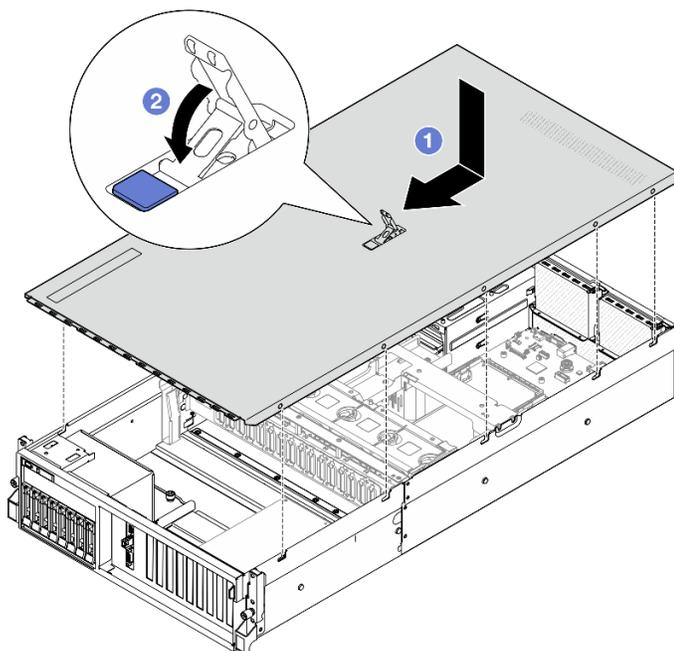
Figura 117. Installazione del coperchio superiore
