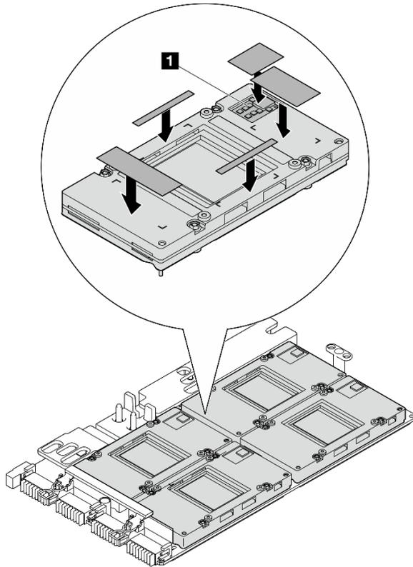
Figura 254. Applicazione del tampone di mastice
