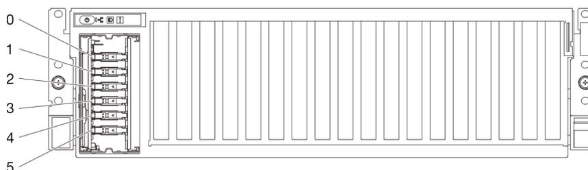
Figura 129. Numerazione dei vani delle unità hot-swap E1.S nel modello di GPU 8-DW
