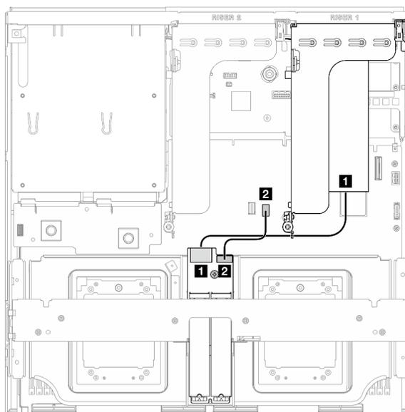
Figura 342. Instradamento dei cavi del backplane M.2 SATA/x4 NVMe (adattatore RAID sulla scheda verticale PCIe 1)
