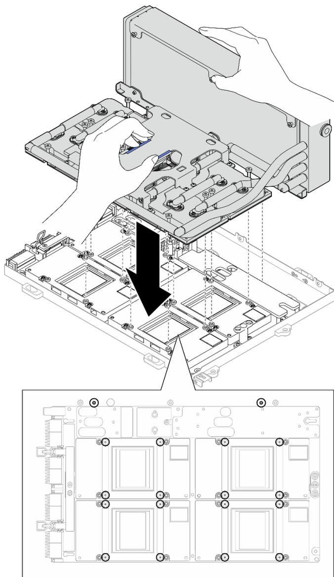
Figura 256. Installazione del L2A
