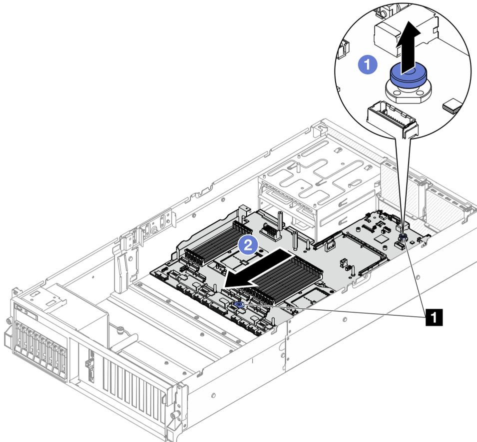
Figura 98. Disinserimento dell'assieme della scheda di sistema
