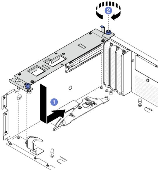
Figura 223. Installazione della piastra della scheda di espansione I/O anteriore
