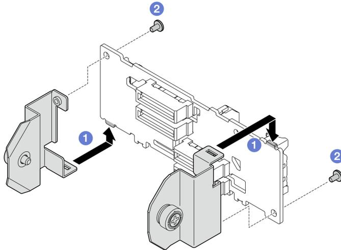
Figura 139. Installazione della staffa del backplane dell'unità E3.S
