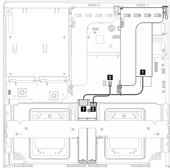
Figura 379. Instradamento dei cavi del backplane M.2 SATA/x4 NVMe (adattatore RAID sulla scheda verticale PCIe 1)
