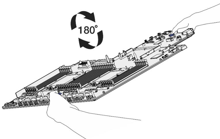
Figura 110. Capovolgimento dell'assieme della scheda di sistema
