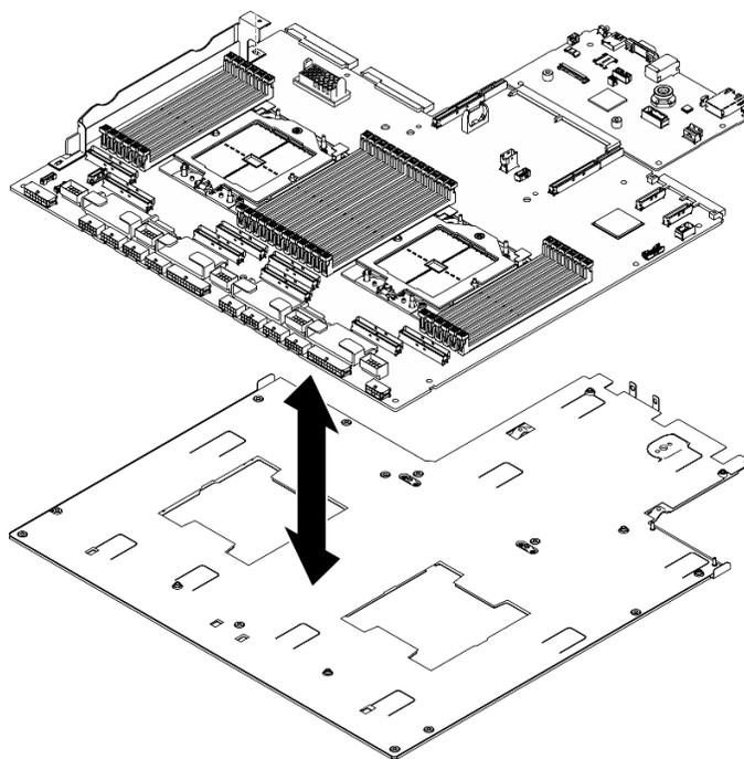
Figura 108. Installazione dell'assieme della scheda di sistema
