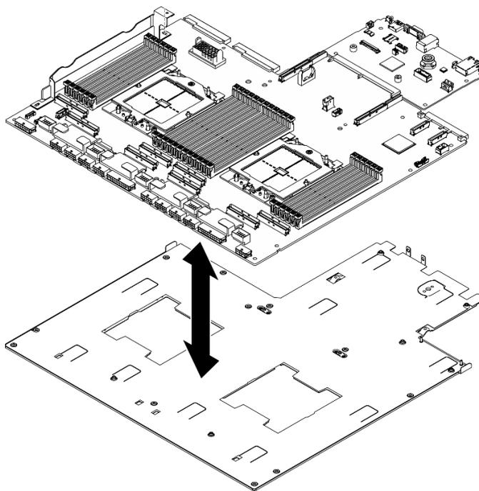
Figura 105. Smontaggio dell'assieme della scheda di sistema
