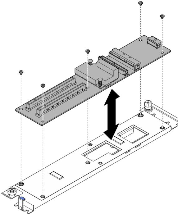
Figura 215. Rimozione della scheda di espansione I/O anteriore
