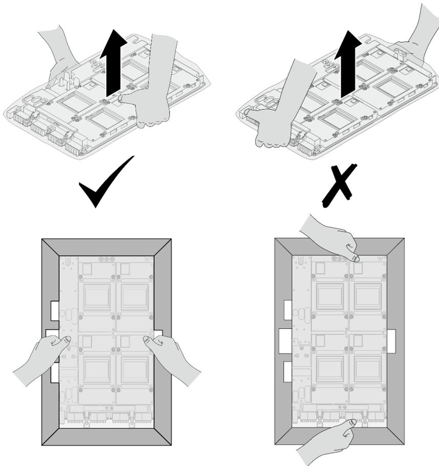
Figura 277. Rimozione della Assieme della scheda GPU SXM5 dalla confezione
