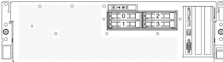
Figura 172. Numerazione dei vani delle unità da 2,5" nel Modello di GPU SXM5
