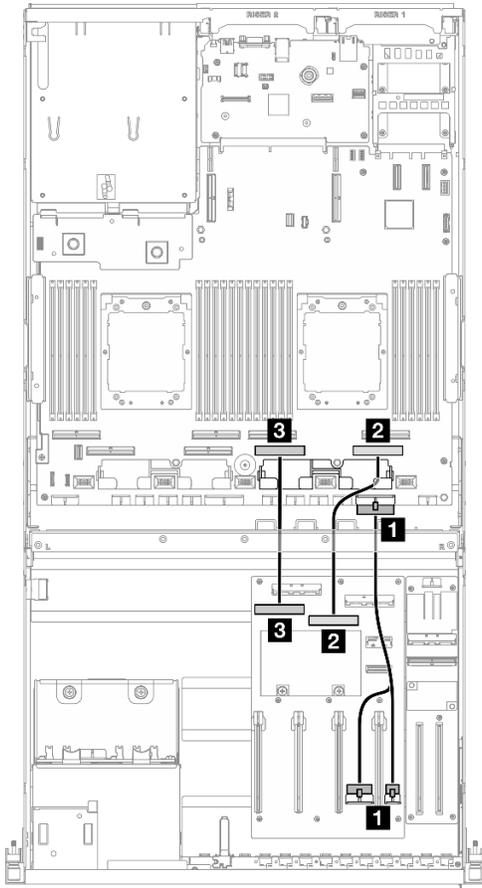
Figura 321. Instradamento dei cavi per la Scheda di distribuzione della GPU commutata
