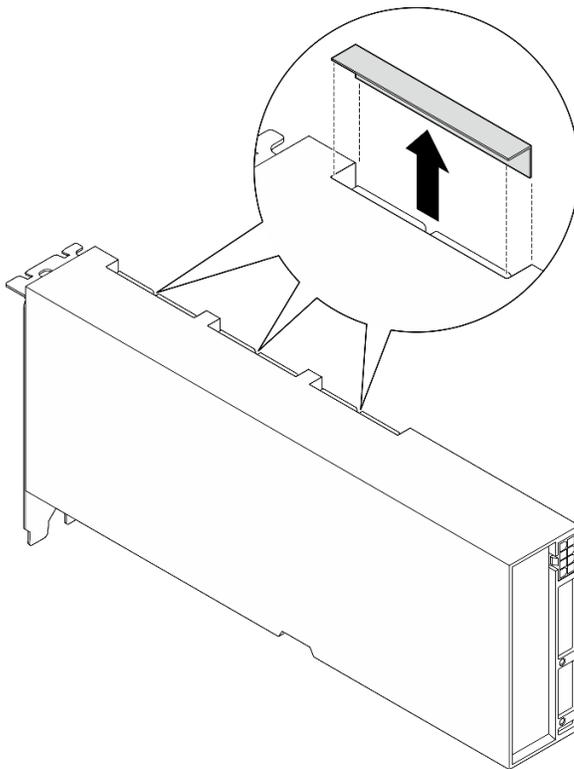
*Figura 161. Rimozione del coperchio del connettore di collegamento*
