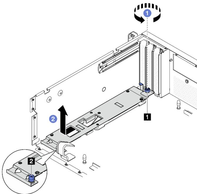
Figura 222. Rimozione della piastra della scheda di espansione I/O anteriore
