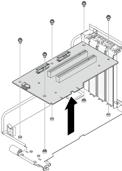
Figura 76. Rimozione della scheda verticale PCIe
