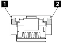
Figura 403. LED Porta di gestione del sistema XCC
