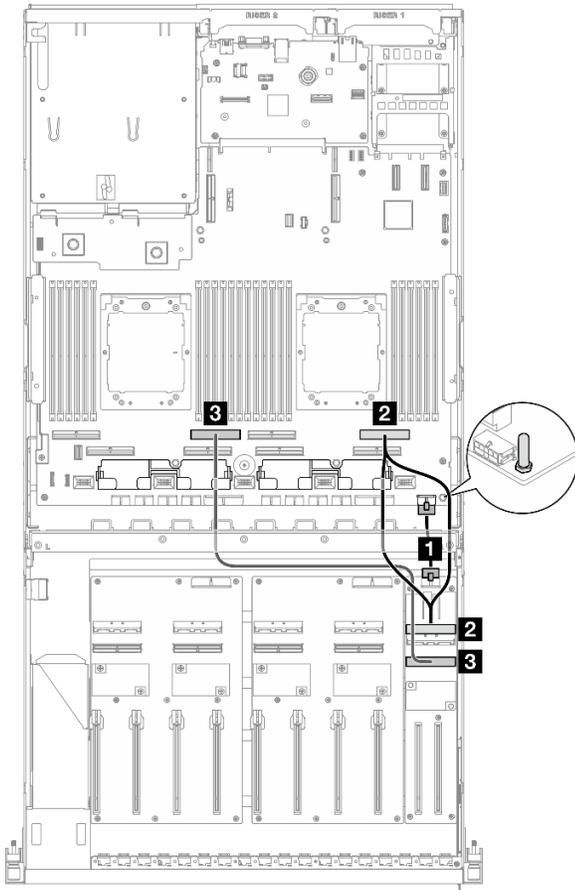
Figura 337. Instradamento dei cavi per la scheda di espansione I/O anteriore
