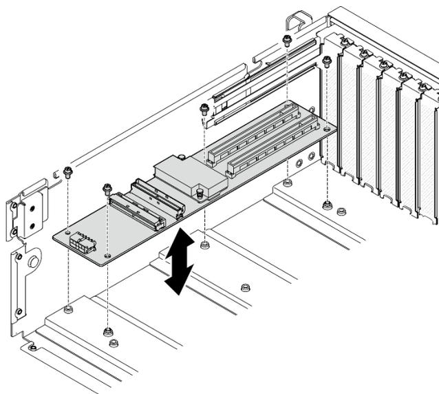
Figura 146. Rimozione della scheda di espansione I/O anteriore
