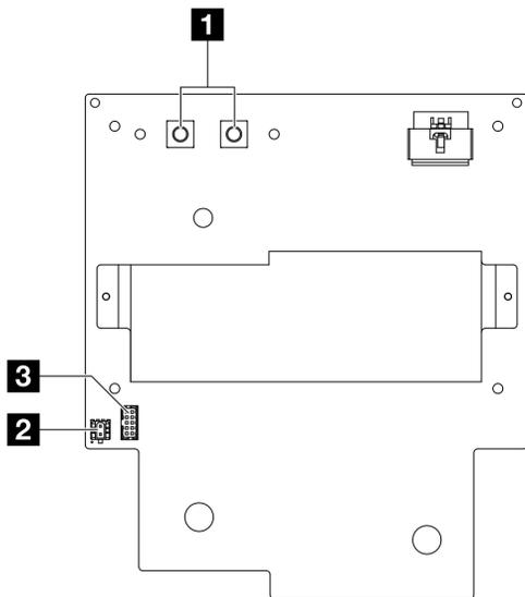
Figura 308. Connettori sulla Scheda di distribuzione dell'alimentazione della GPU SXM5
