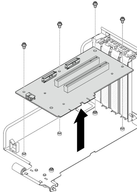
Figura 77. Rimozione della scheda verticale PCIe
