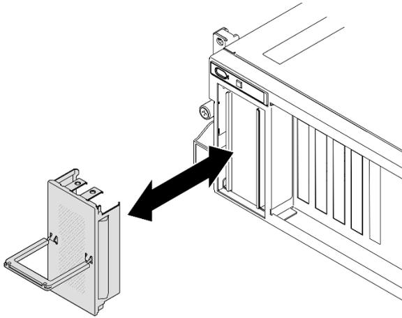
Figura 134. Installazione del coperchio del telaio unità EDSFF
