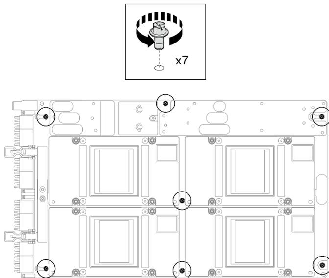
Figura 274. Rimozione della vite Phillips #1
