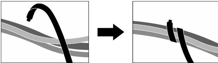
Figura 358. Fissaggio dei cavi con le fascette
