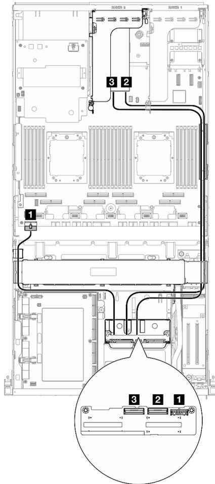
Figura 356. Instradamento dei cavi del backplane dell'unità da 2,5" (adattatore RAID sulla scheda verticale PCIe 2)
