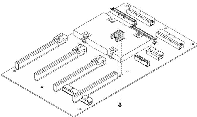
Figura 166. Installazione del rinforzo dello slot PCIe
