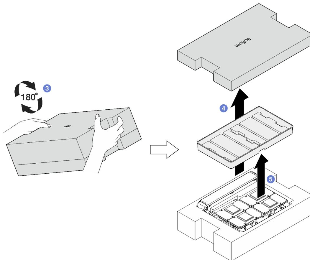
Figura 252. Capovolgimento del modulo L2A
