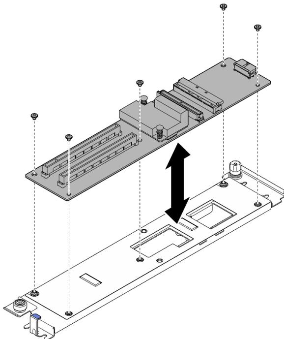
Figura 216. Installazione della scheda di espansione I/O anteriore
