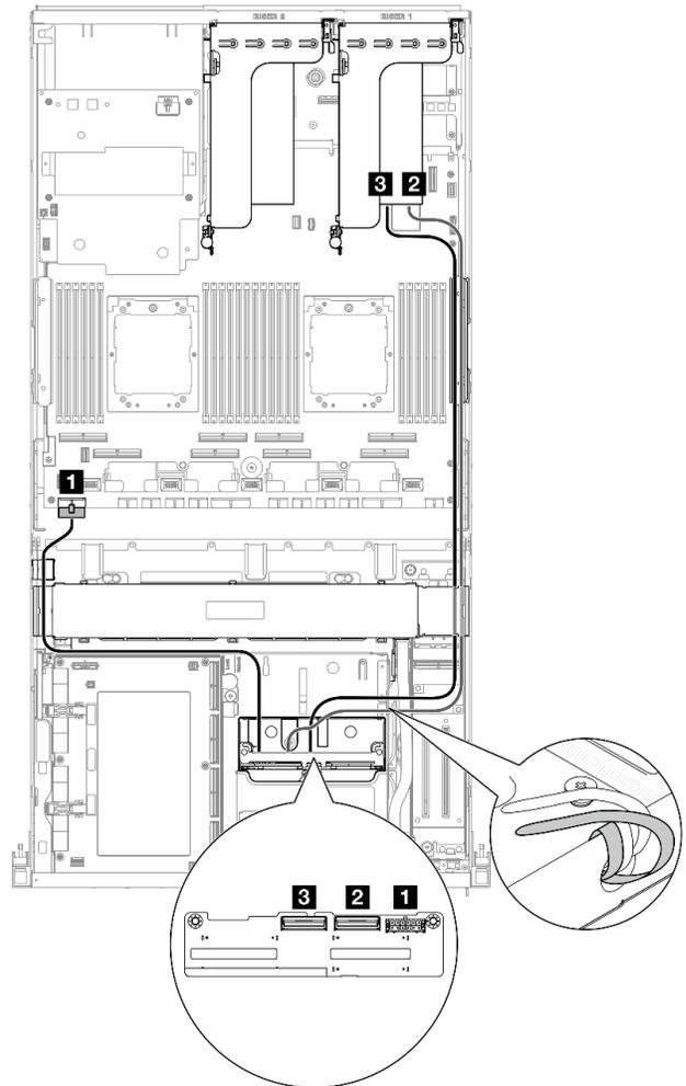
Figura 357. Instradamento dei cavi del backplane dell'unità da 2,5" (adattatore RAID sulla scheda verticale PCIe 1)
