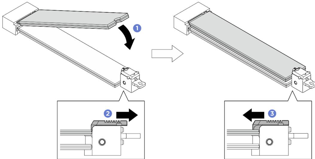
Figure 128. Installation de l'unité M.2 supérieure
