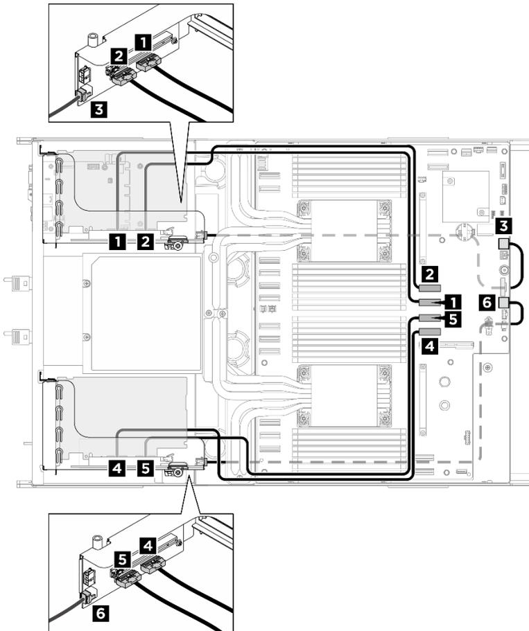
Figure 239. Cheminement des câbles de la carte mezzanine PCIe
