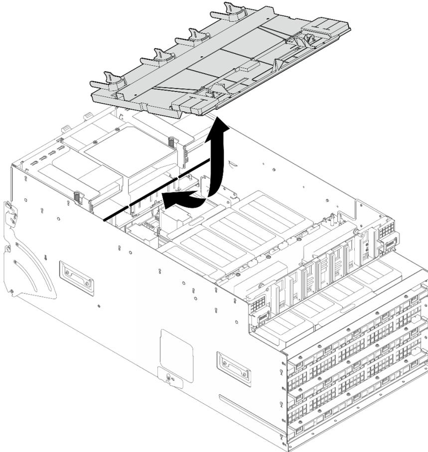
Figure 33. Installation du bloc cadre du support de câble et grille
