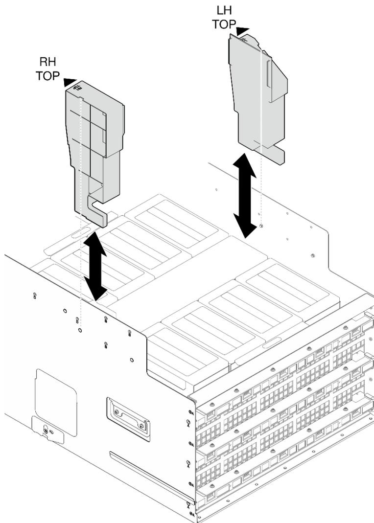
Figure 66. Installation d'un conduit de ventilation du GPU
