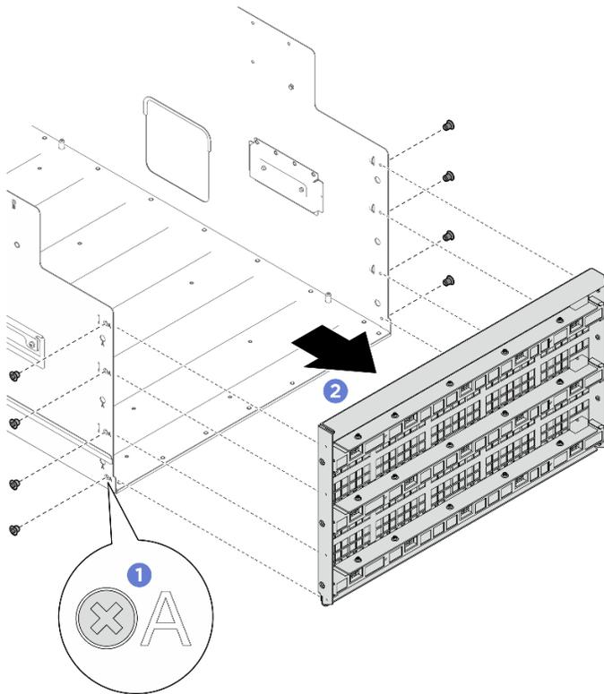
Figure 69. Retrait de la cloison
