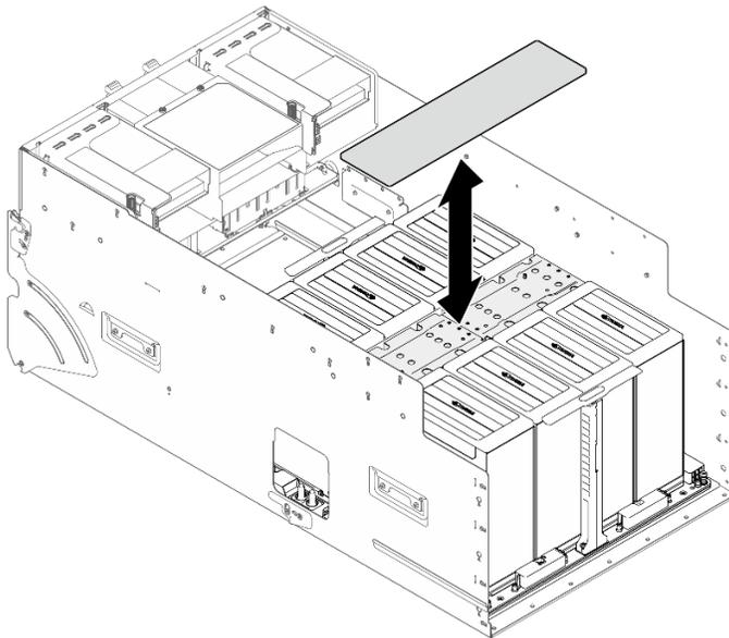
Figure 89. Installation du cache du dissipateur thermique NVSwitch
