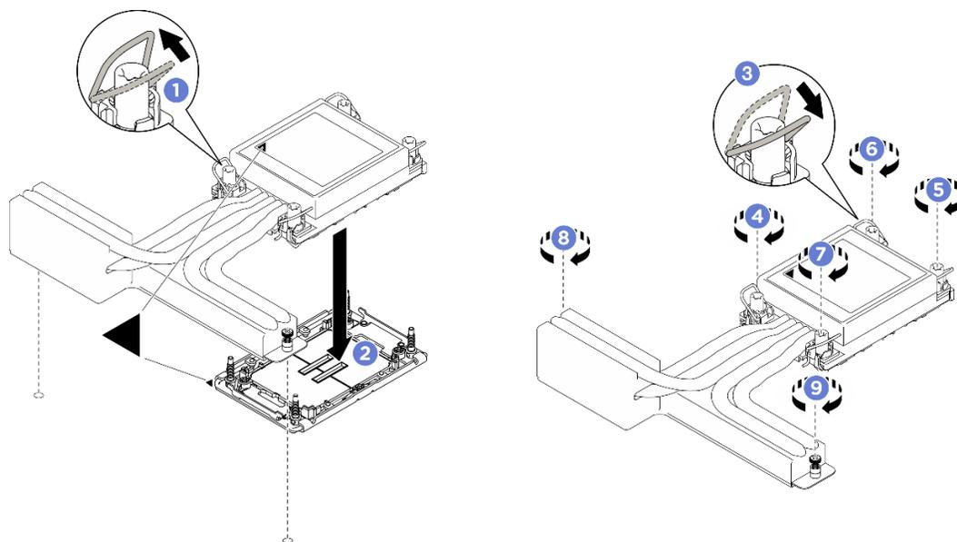
Figure 200. Installation du module de processeur-dissipateur thermique
