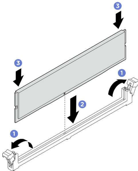
Figure 133. Installation du module de mémoire
