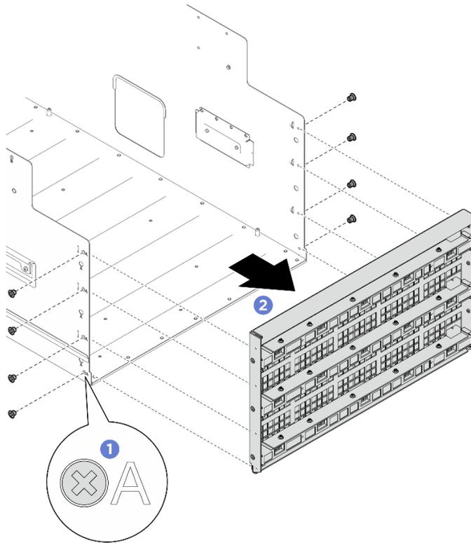
Figure 93. Retrait de la cloison
