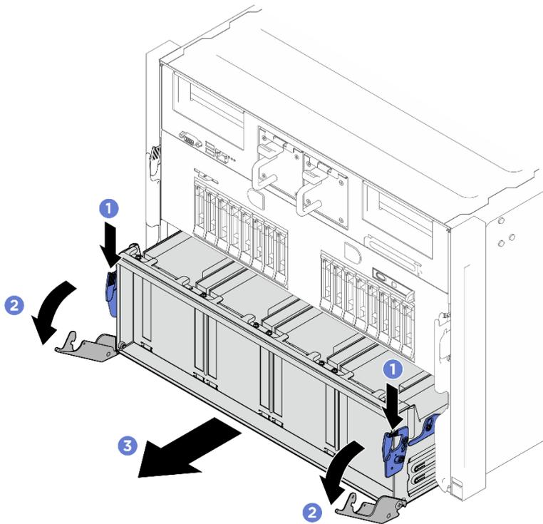
Figure 139. Déplacement (en tirant) de la navette de commutation PCIe jusqu'à la première position d'arrêt
