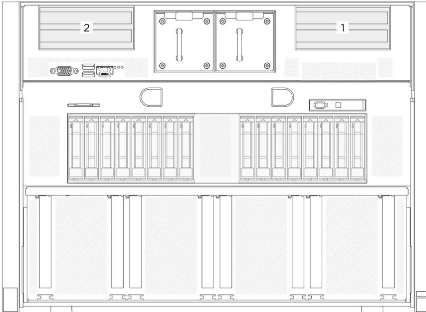
Figure 168. Emplacements des cartes mezzanines PCIe
