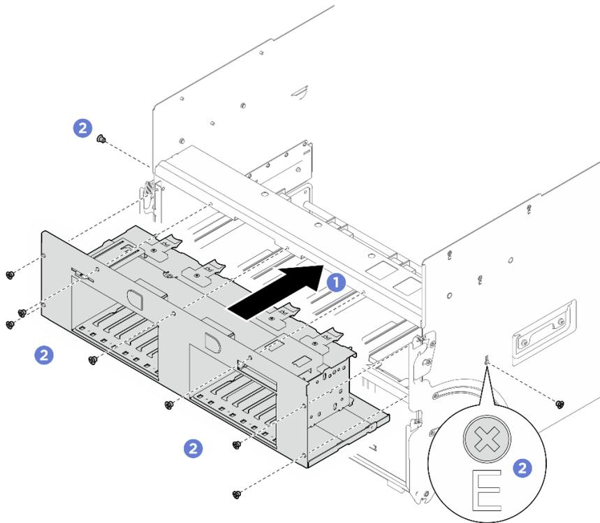
Figure 42. Installation du boîtier d'unités de disque dur
