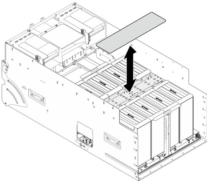
Figure 102. Installation du cache du dissipateur thermique NVSwitch
