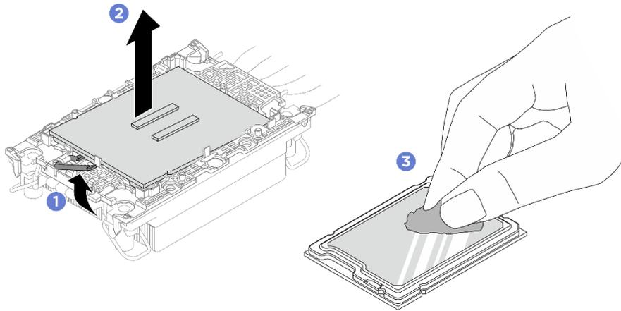
Figure 193. Dissociation d'un processeur du support et du dissipateur thermique
