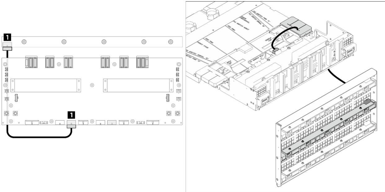
Figure 233. Cheminement des câbles de la carte de contrôleur de ventilation arrière (partie intermédiaire)
