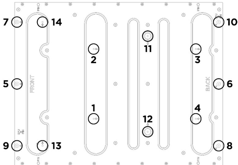
Figure 99. Séquence de serrage des vis
