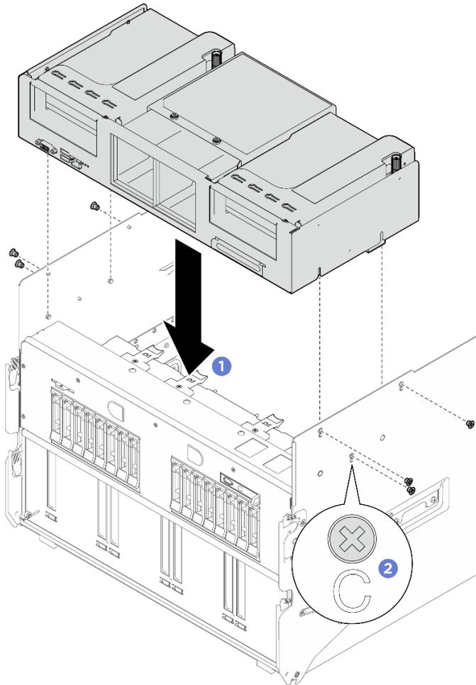
Figure 63. Installation du boîtier FIO/PCI
