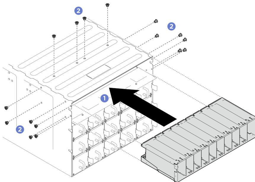
Figure 203. Installation du boîtier PSU
