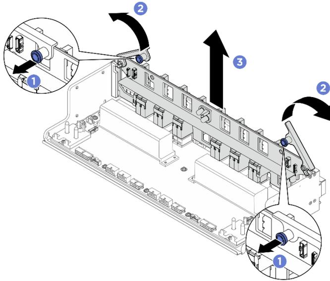
Figure 204. Retrait de l'interposeur du bloc d'alimentation
