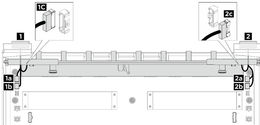
Figure 247. Cheminement des câbles des ventilateurs auxiliaires arrière
