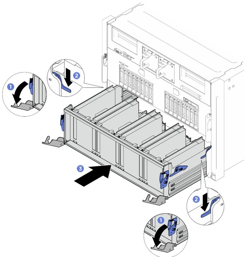
Figure 143. Coulissement de la navette de commutation PCIe vers sa première position d'arrêt
