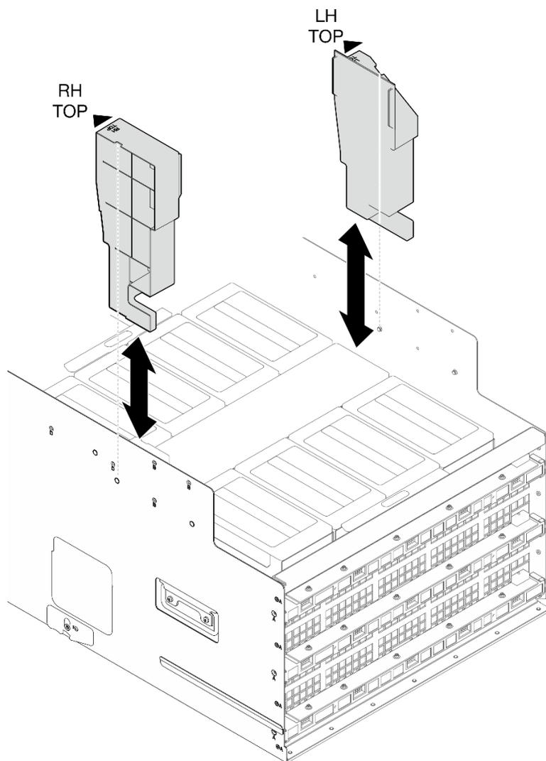
Figure 65. Retrait du conduit de ventilation du GPU
