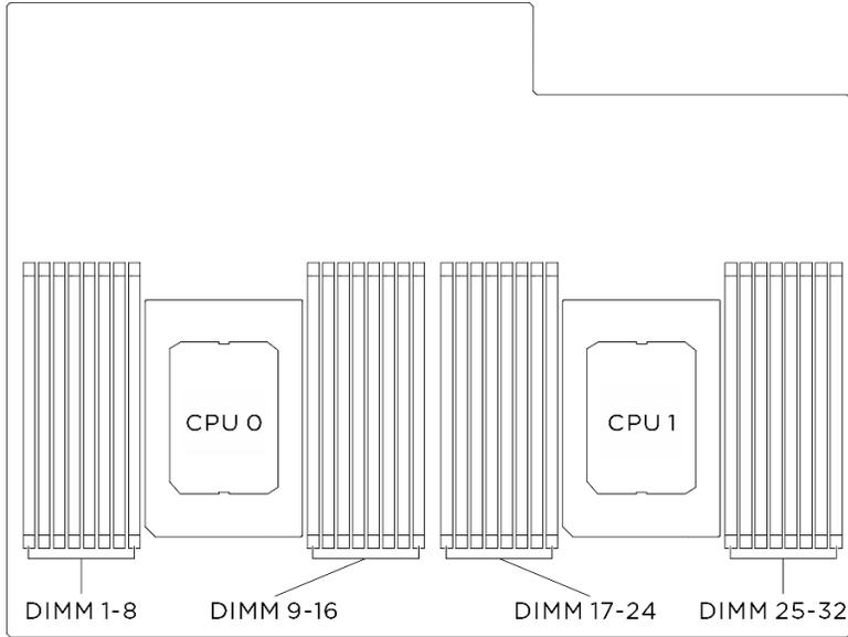
Figure 132. Disposition des modules de mémoire et des processeurs
