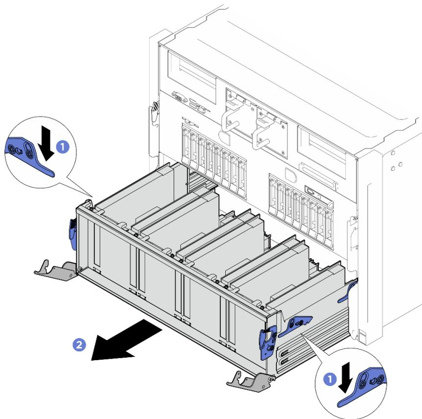
Figure 155. Déplacement (en tirant) de la navette de commutation PCIe jusqu'à la seconde position d'arrêt
