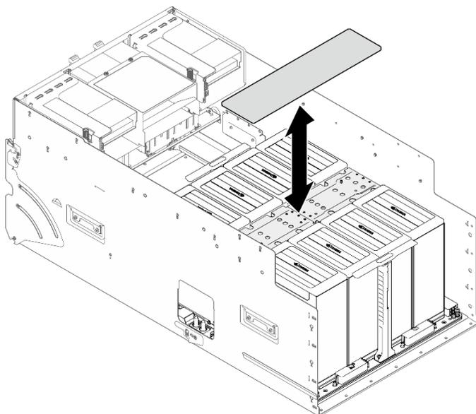
Figure 94. Retrait du cache du dissipateur thermique NVSwitch
