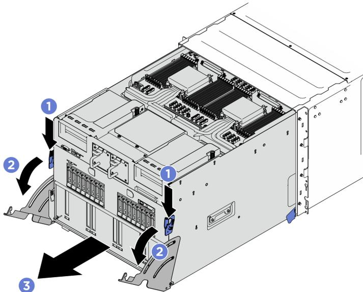
Figure 118. Mise en place (en tirant) de la navette système en position d'arrêt
