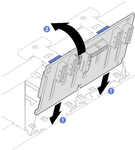
Figure 25. Installation d'un fond de panier d'unité 2,5 pouces
