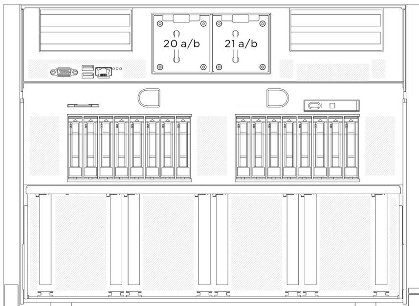
Figure 48. Numéros des ventilateurs avant
