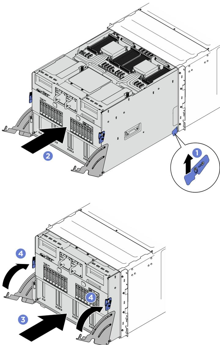
Figure 43. Installation de la navette système
