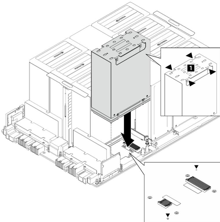
Figure 111. Installation du module GPU et dissipateur thermique
