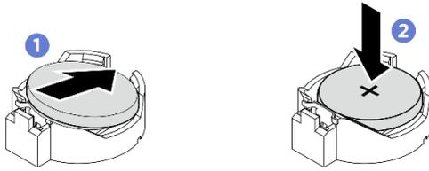
Figure 39. Installation de la pile CMOS
