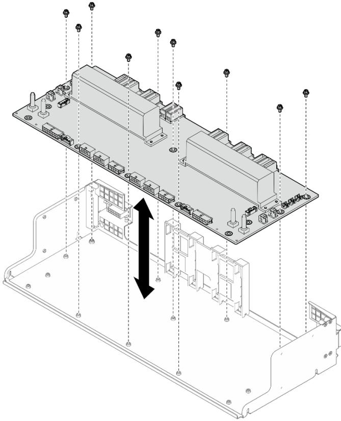
Figure 183. Installation du tableau de distribution
