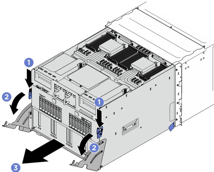
Figure 135. Mise en place (en tirant) de la navette système en position d'arrêt
