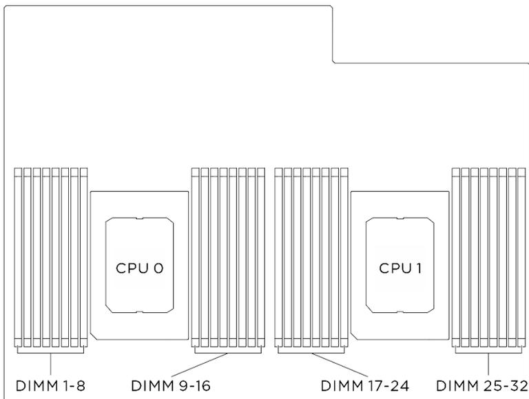
Figure 130. Disposition des modules de mémoire et des processeurs
