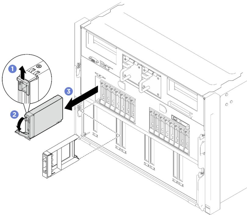
Figure 18. Retrait d'une unité remplaçable à chaud 2,5 pouces
