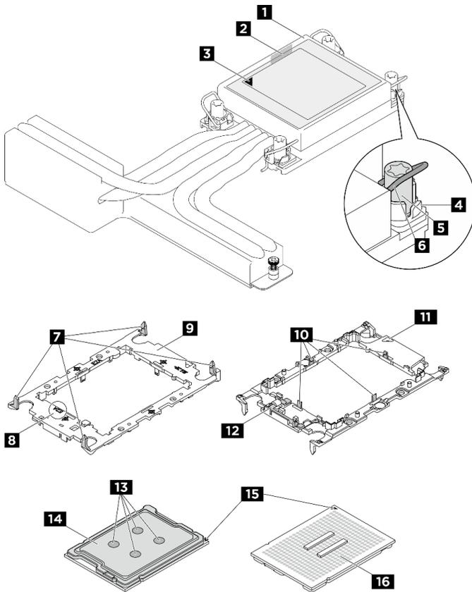
Figure 195. Composants du module de processeur-dissipateur thermique
