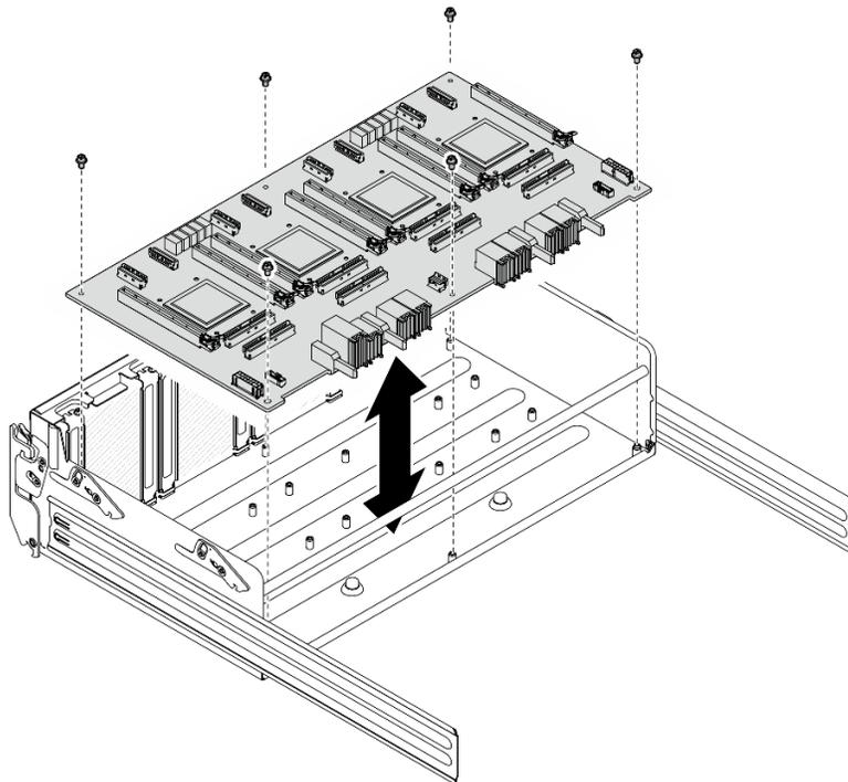
Figure 151. Installation du tableau de commutation PCIe
