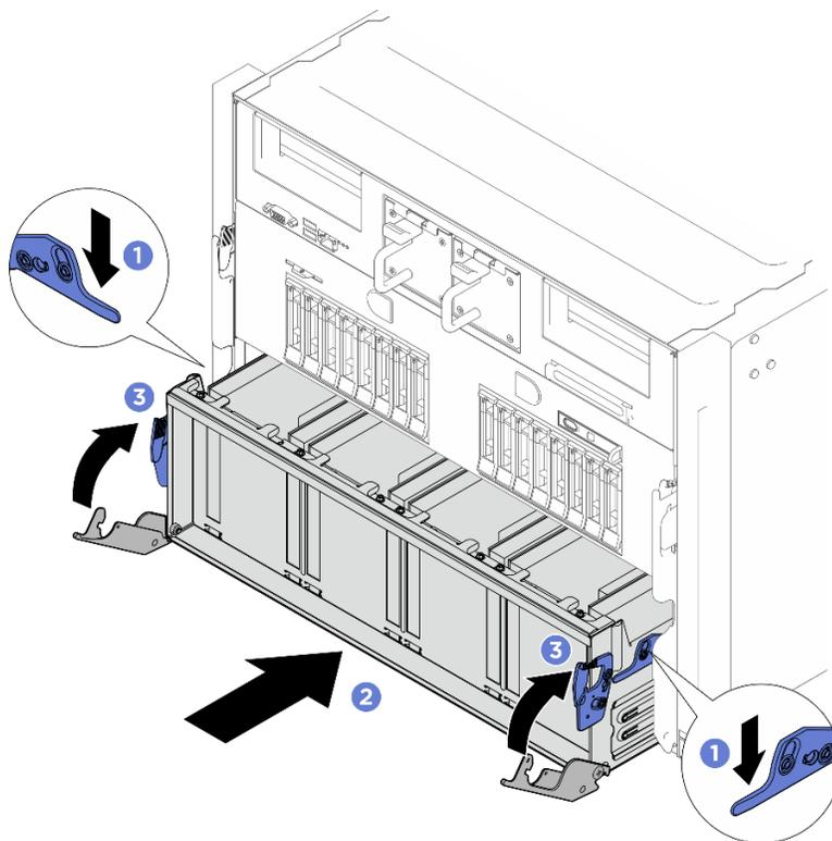
Figure 90. Installation de la navette de commutation PCIe
