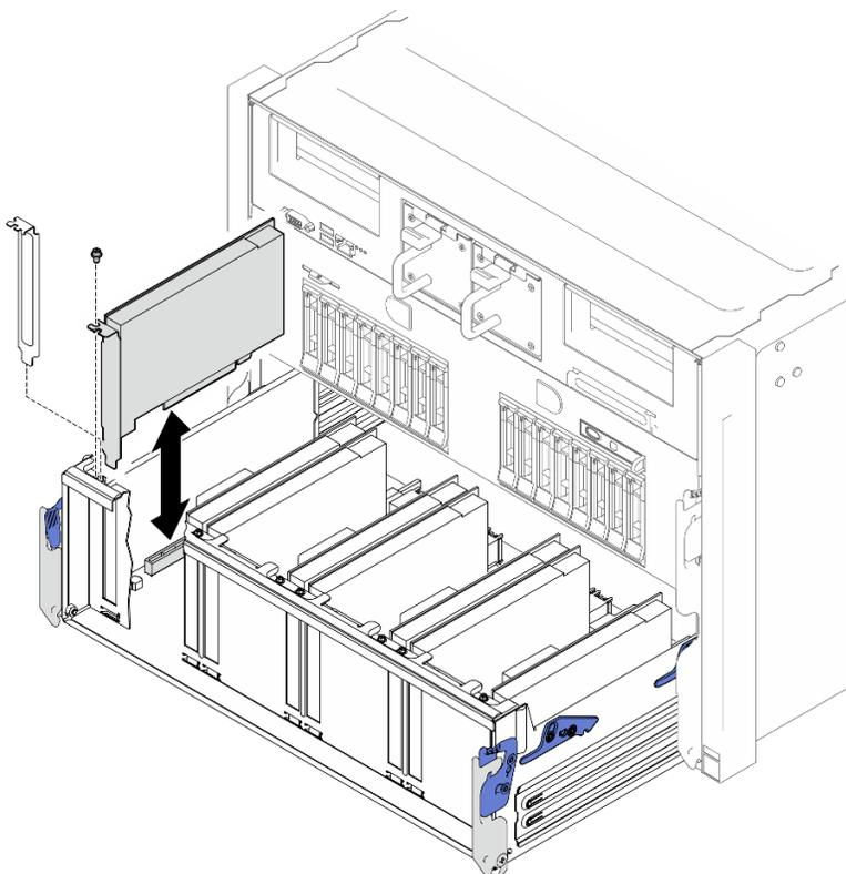
Figure 141. Retrait de l'adaptateur PCIe inférieur
