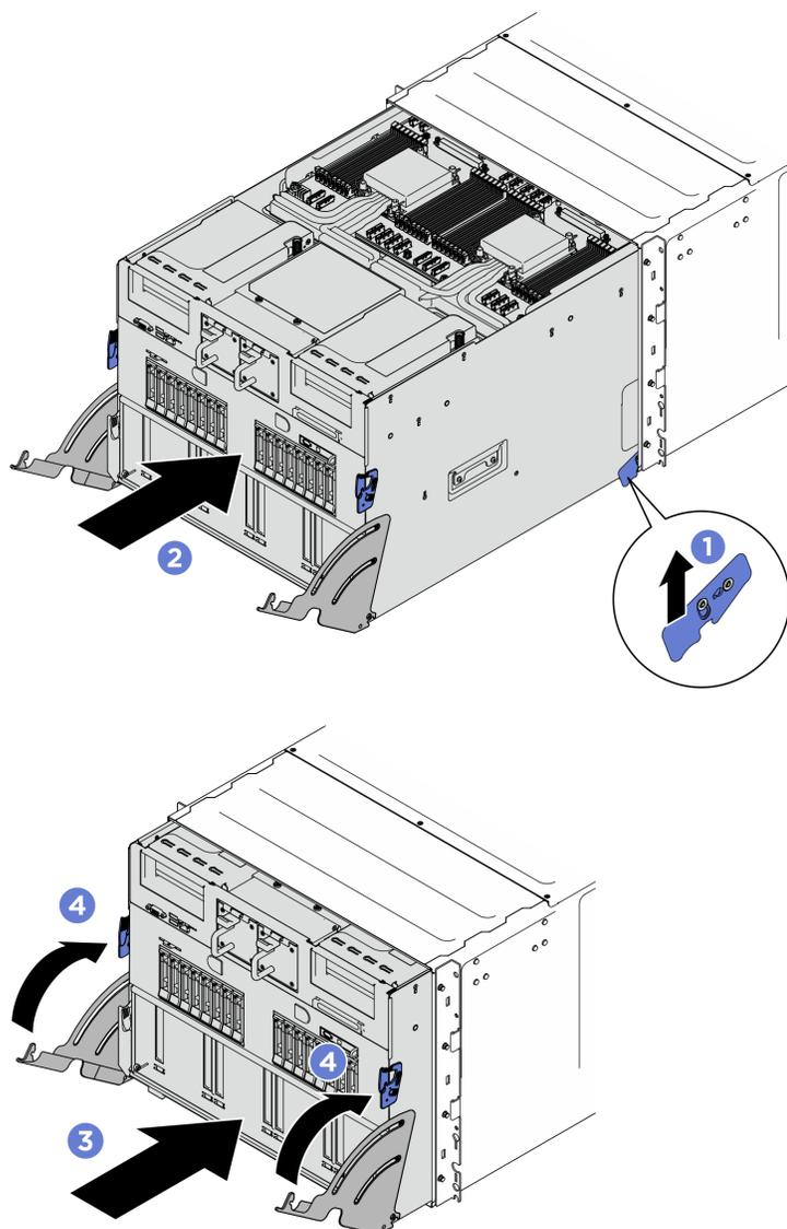
Figure 201. Installation de la navette système
