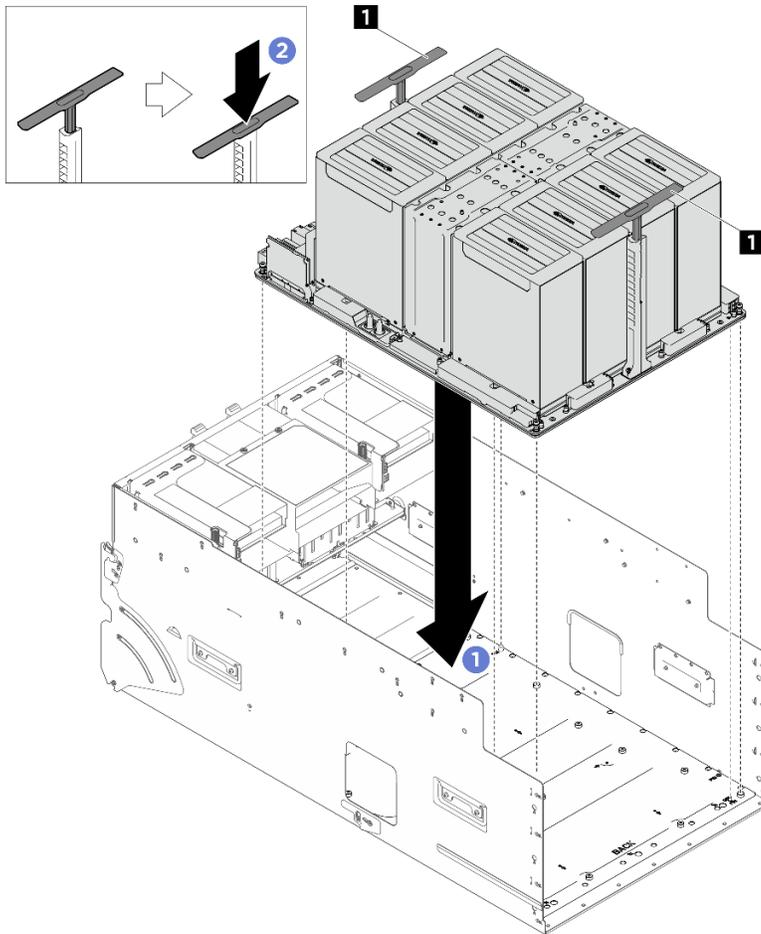
Figure 87. Installation du complexe GPU
