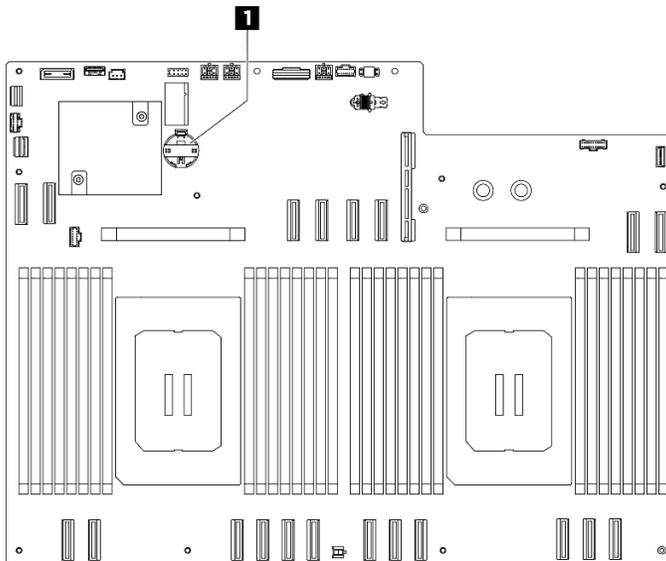
Figure 38. Emplacement de la pile CMOS
