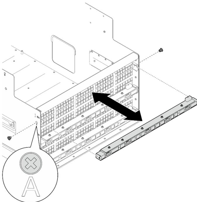
Figure 59. Installation du bloc carte de contrôleur de ventilation arrière
