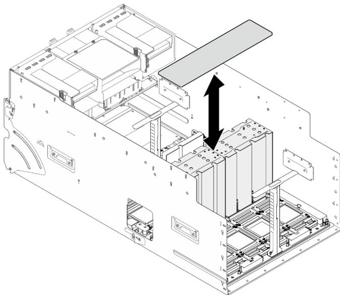
Figure 70. Retrait du cache du dissipateur thermique NVSwitch
