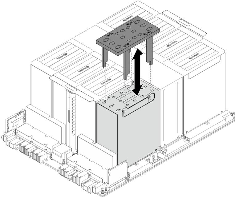
Figure 112. Installation du gabarit
