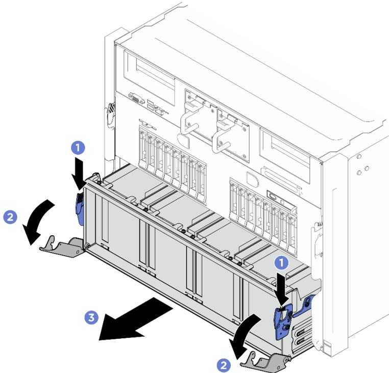
Figure 160. Déplacement (en tirant) de la navette de commutation PCIe jusqu'à la première position d'arrêt
