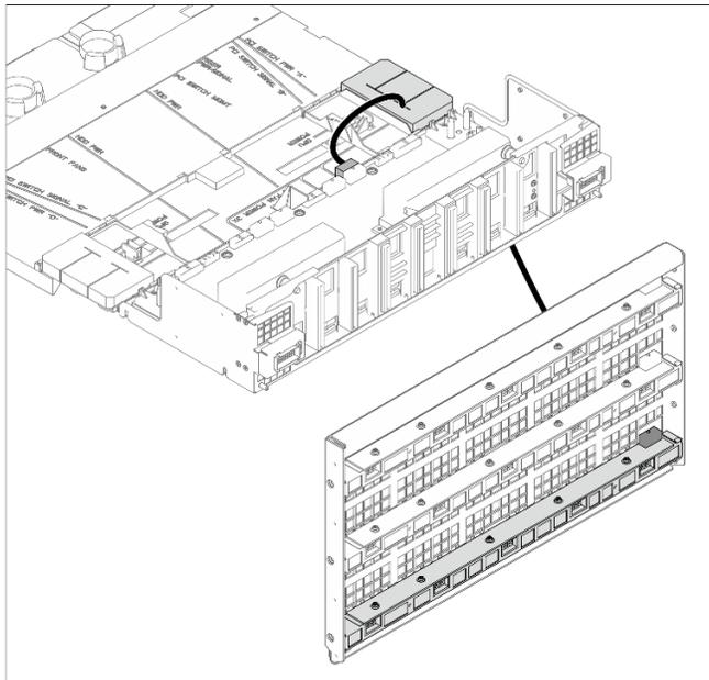
Figure 234. Cheminement des câbles de la carte de contrôleur de ventilation arrière (partie inférieure)
