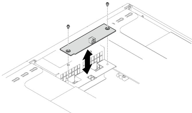
Figure 54. Installation de la carte de contrôleur de ventilation avant
