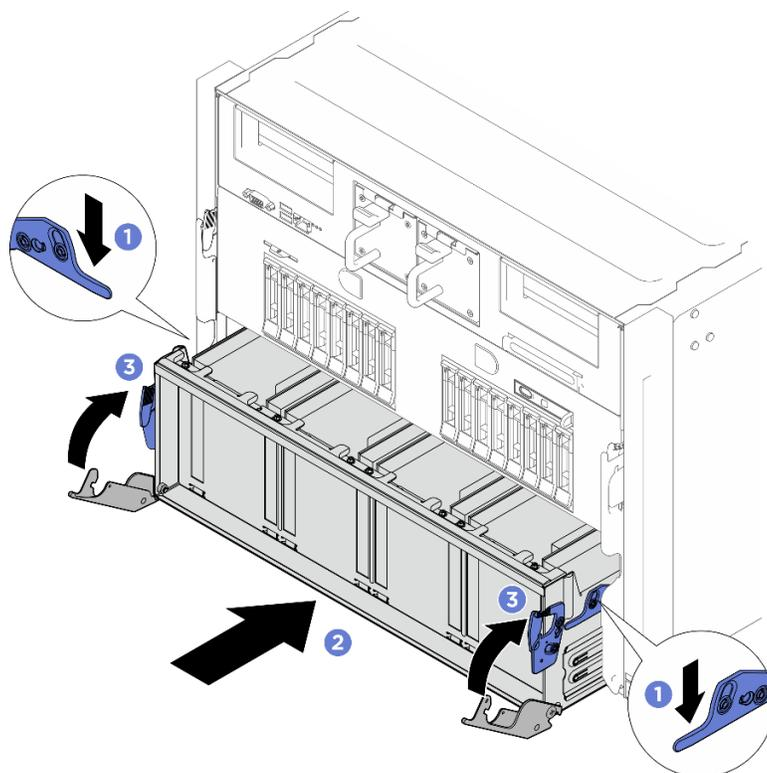
Figure 159. Installation de la navette de commutation PCIe
