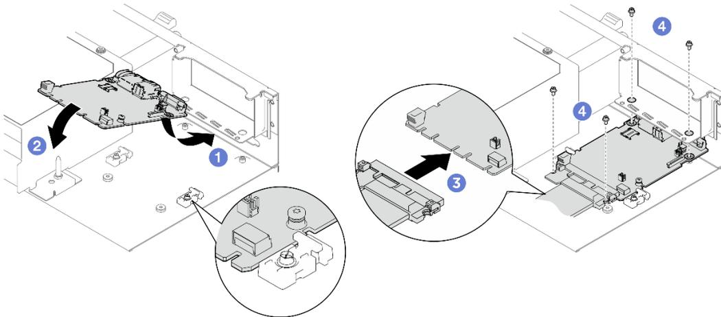
Figure 212. Installation de la carte d'E-S système
