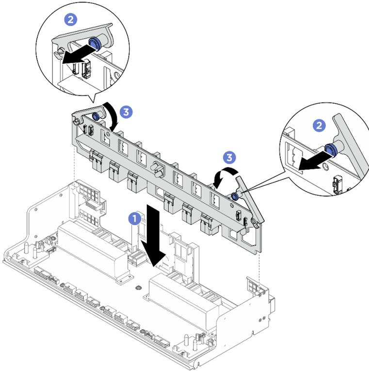
Figure 205. Installation de l'interposeur du bloc d'alimentation
