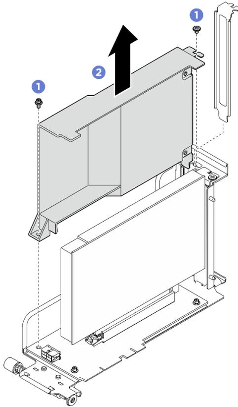
Figure 165. Retrait d'une grille d'aération pour carte mezzanine PCIe
