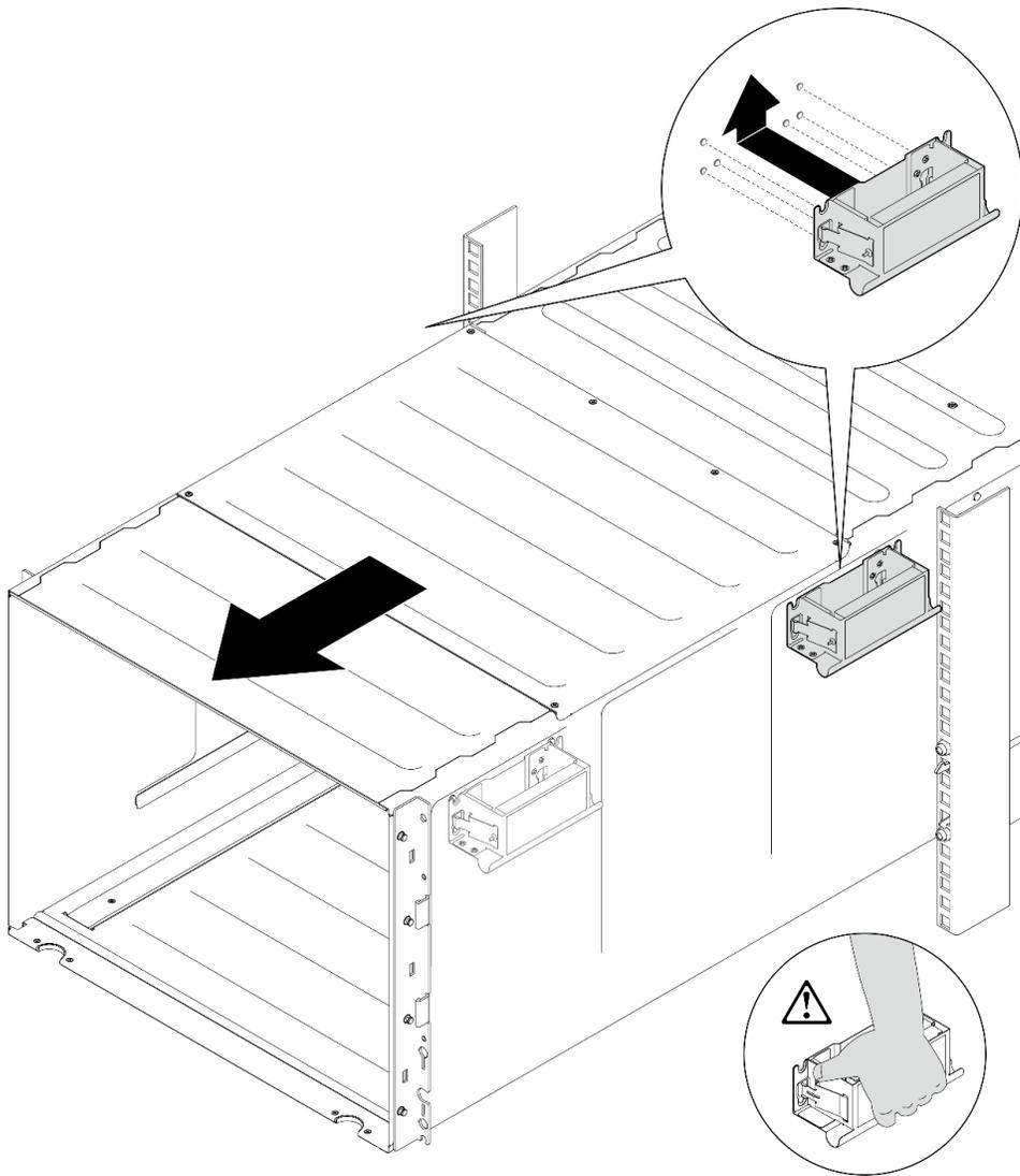
Figure 7. Installation de la poignée arrière
