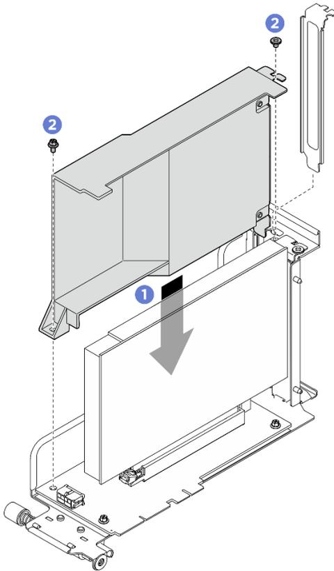
Figure 166. Installation d'une grille d'aération de carte mezzanine PCIe
