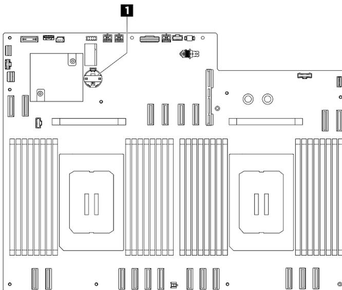
Figure 36. Emplacement de la pile CMOS
