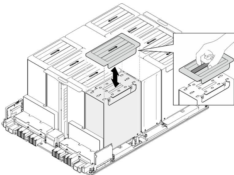
Figure 115. Installation d'un cache en plastique
