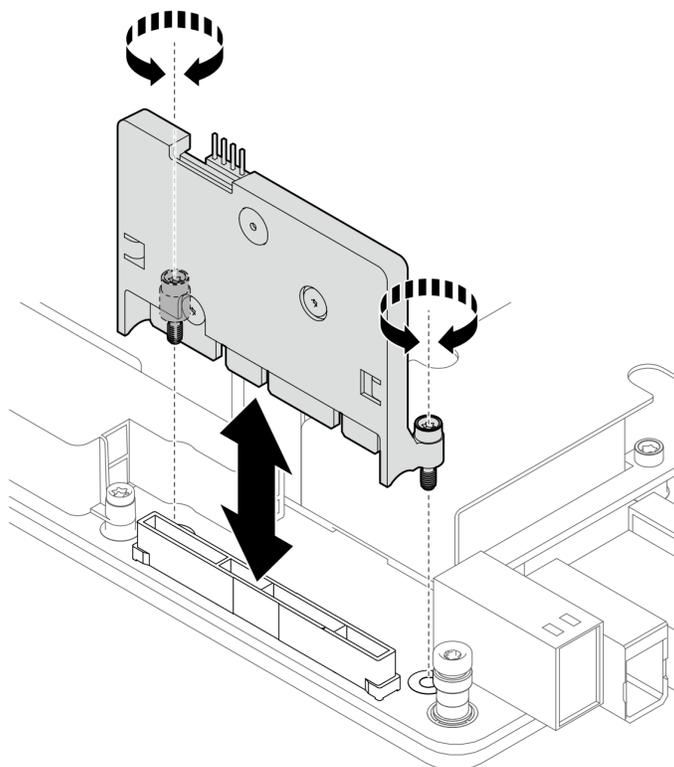
Figure 117. Installation de la carte HMC
