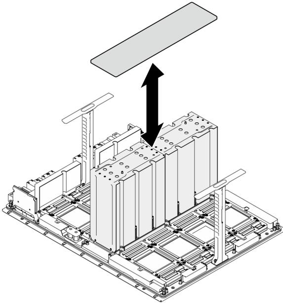
Figure 74. Retrait du cache du dissipateur thermique NVSwitch
