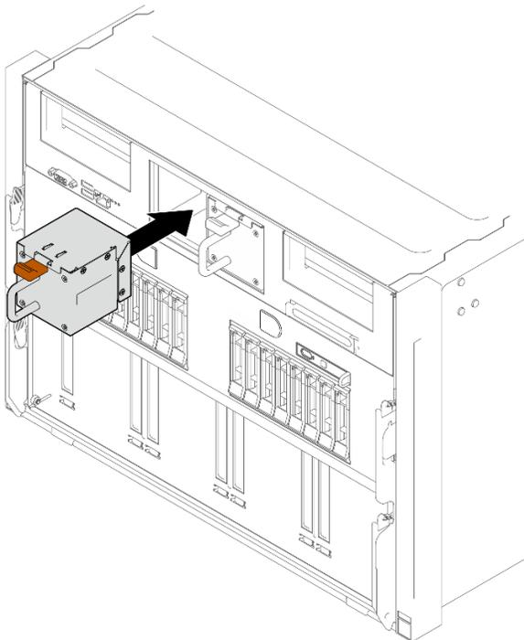
Figure 50. Installation de ventilateur avant
