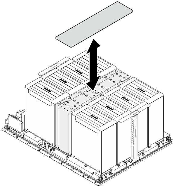
Figure 86. Retrait du cache du dissipateur thermique NVSwitch
