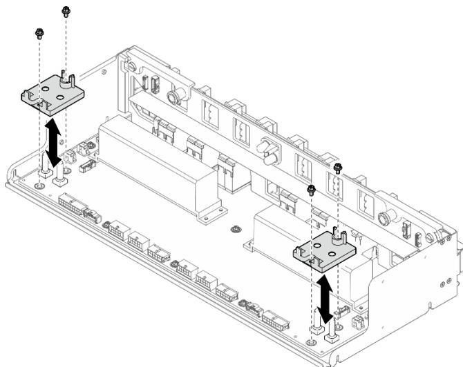
Figure 181. Retrait du dispositif de retenue des câbles
