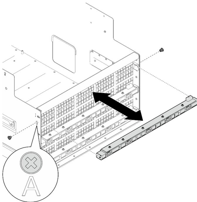
Figure 56. Retrait d'un bloc carte de contrôleur de ventilation arrière
