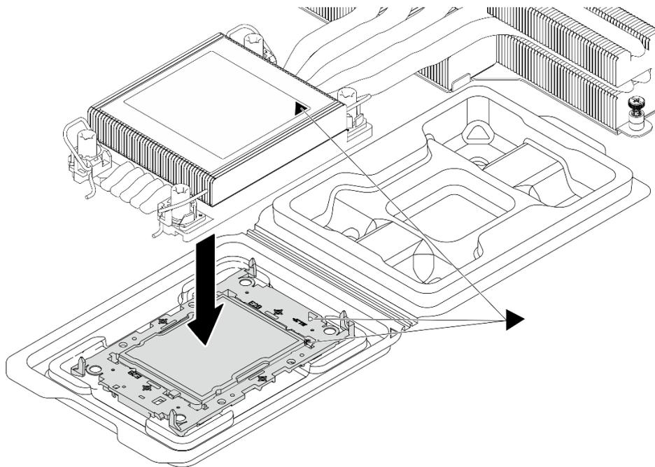
Figure 198. Assemblage du module de processeur-dissipateur thermique avec le processeur dans le plateau d'expédition
