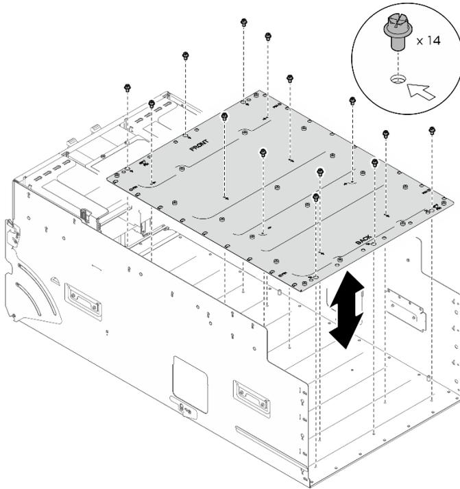
Figure 97. Retrait de la plaque d'adaptateur du complexe GPU
