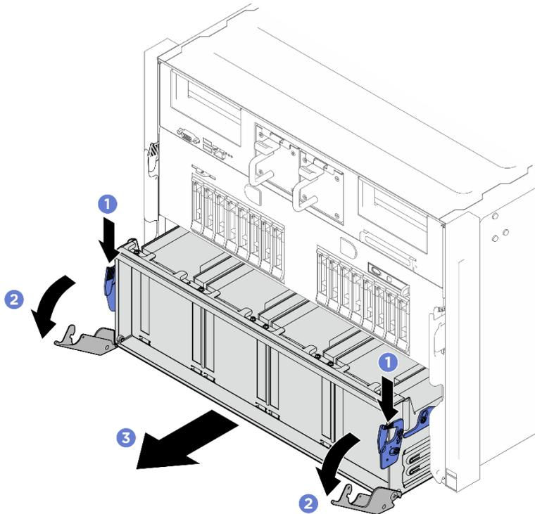
Figure 154. Déplacement (en tirant) de la navette de commutation PCIe jusqu'à la première position d'arrêt
