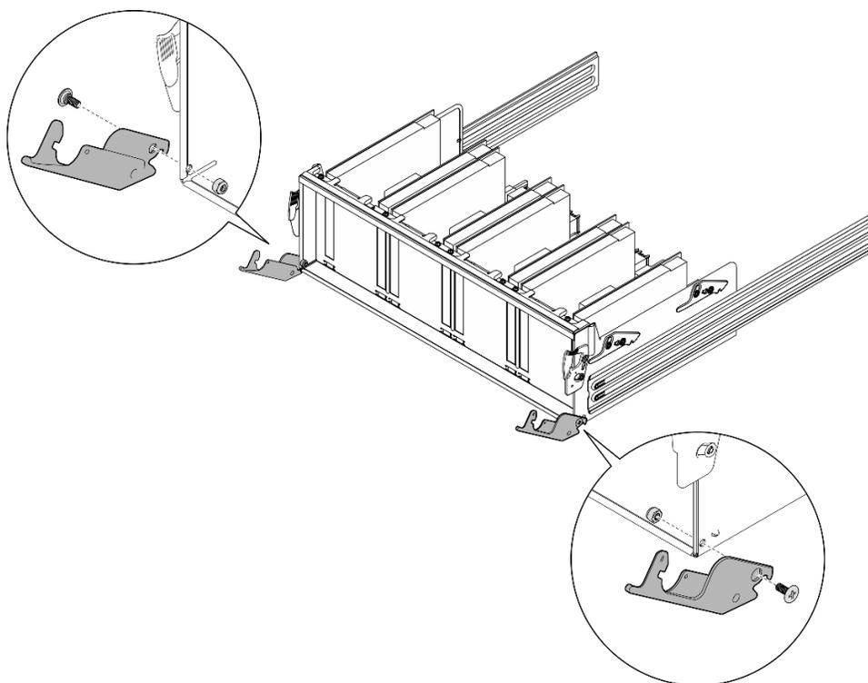
Figure 162. Installation des leviers de dégagement
