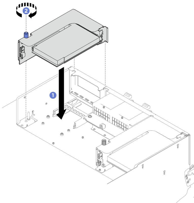
Figure 177. Installation de l'assemblage de cartes mezzanines PCIe
