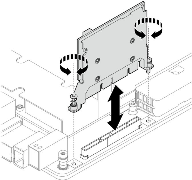
Figure 105. Installation de la carte d'adaptateur CX-7
