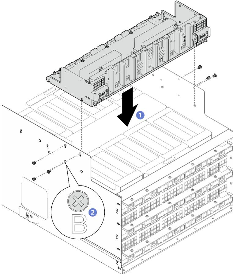
Figure 180. Installation du complexe d'alimentation
