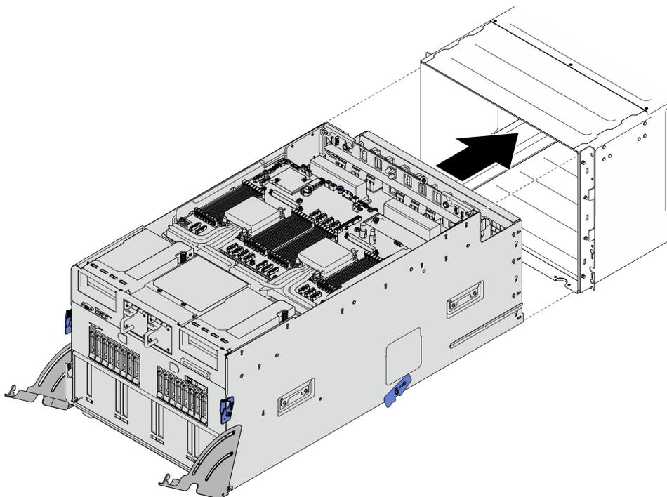
Figure 216. Mise en place (en poussant) de la navette système en position d'arrêt
