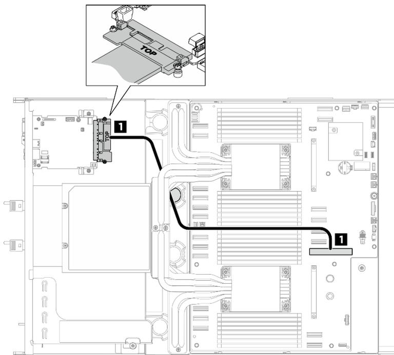
Figure 248. Cheminement des câbles de la carte d'E-S système
