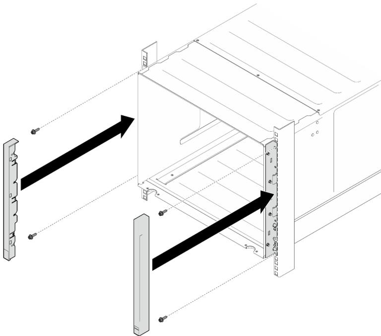
Figure 14. Installation du cache de la barrette EIA
