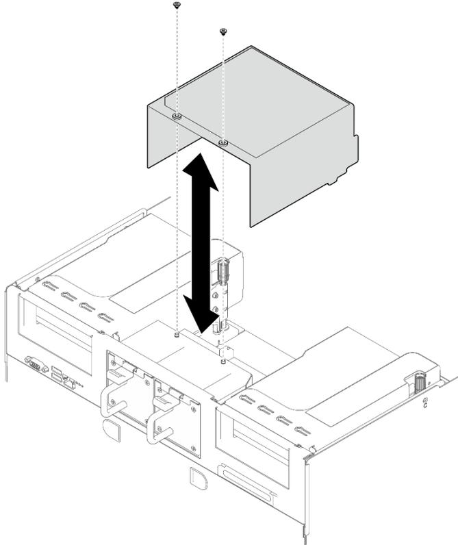
Figure 29. Retrait du conduit de ventilation
