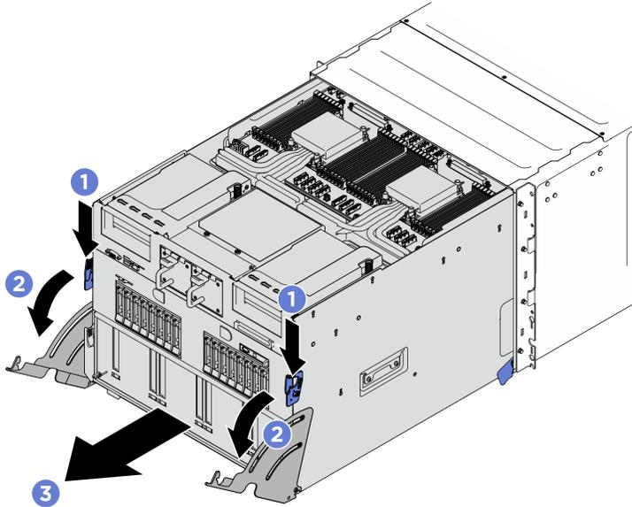
Figure 169. Mise en place (en tirant) de la navette système en position d'arrêt
