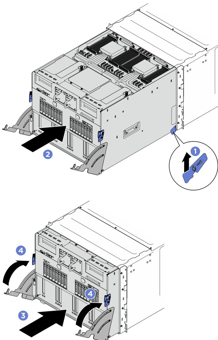
Figure 148. Installation de la navette système
