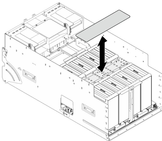
Figure 82. Retrait du cache du dissipateur thermique NVSwitch
