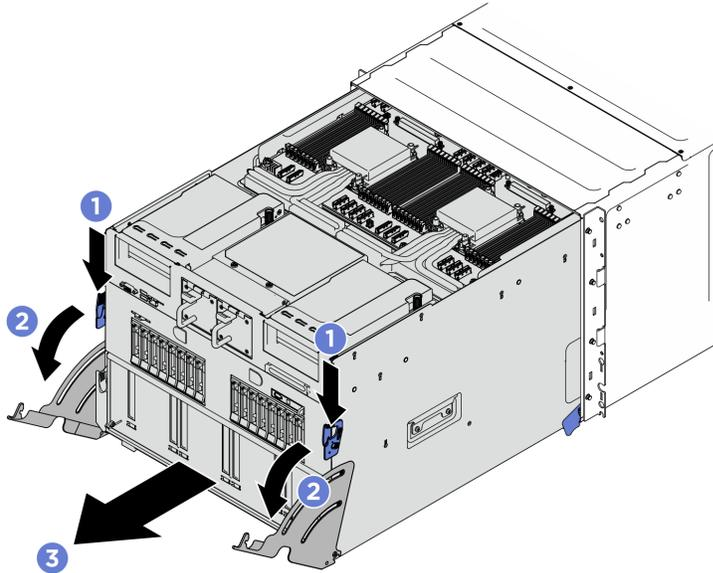
Figure 145. Mise en place (en tirant) de la navette système en position d'arrêt
