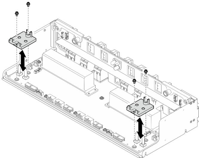
Figure 184. Installation du dispositif de retenue des câbles
