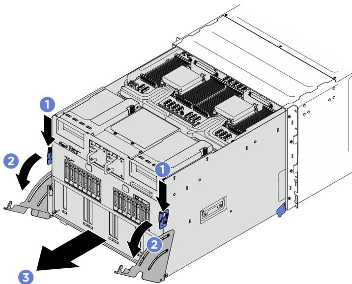
Figure 191. Mise en place (en tirant) de la navette système en position d'arrêt
