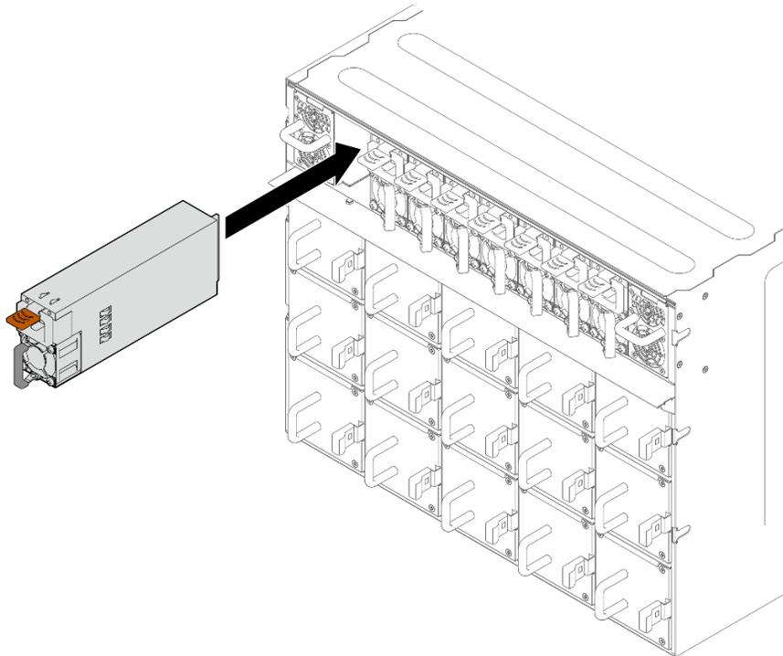
Figure 188. Installation du bloc d'alimentation
