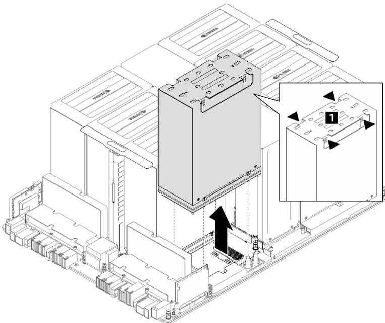
Figure 110. Retrait du module GPU et dissipateur thermique
