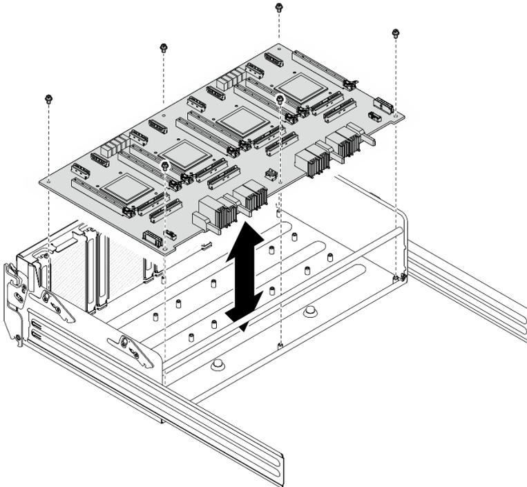
Figure 150. Retrait du tableau de commutation PCIe
