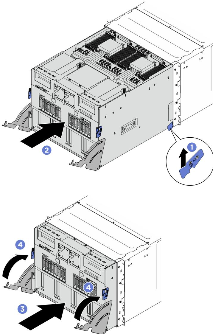
Figure 55. Installation de la navette système
