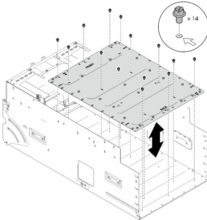
Figure 98. Installation de la plaque d'adaptateur du complexe GPU
