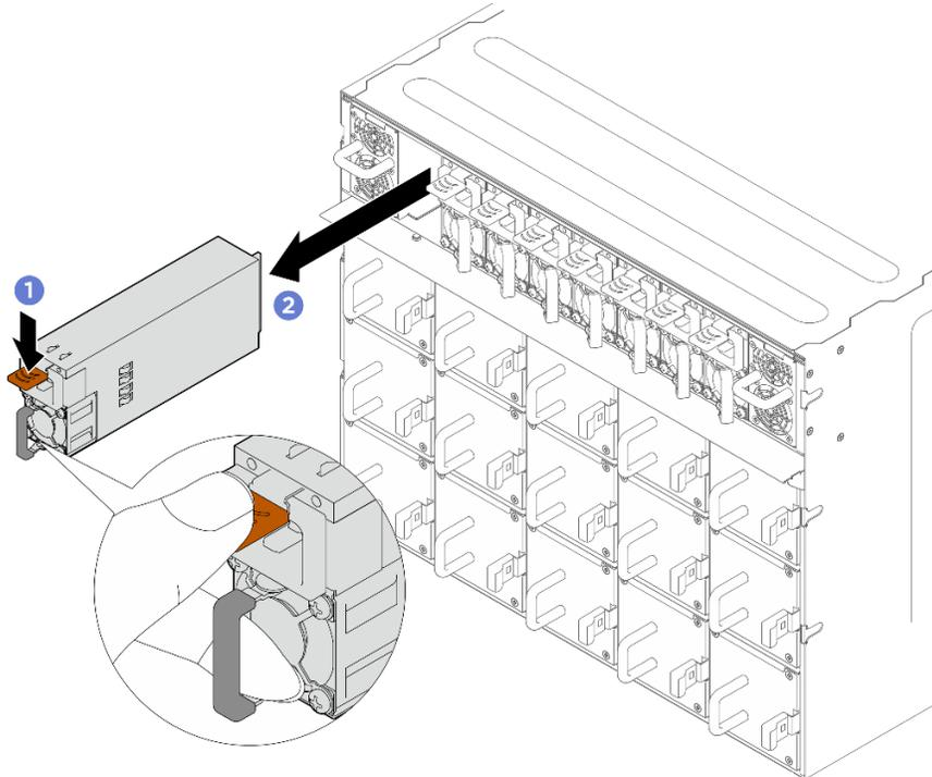
Figure 186. Retrait d'un bloc d'alimentation
