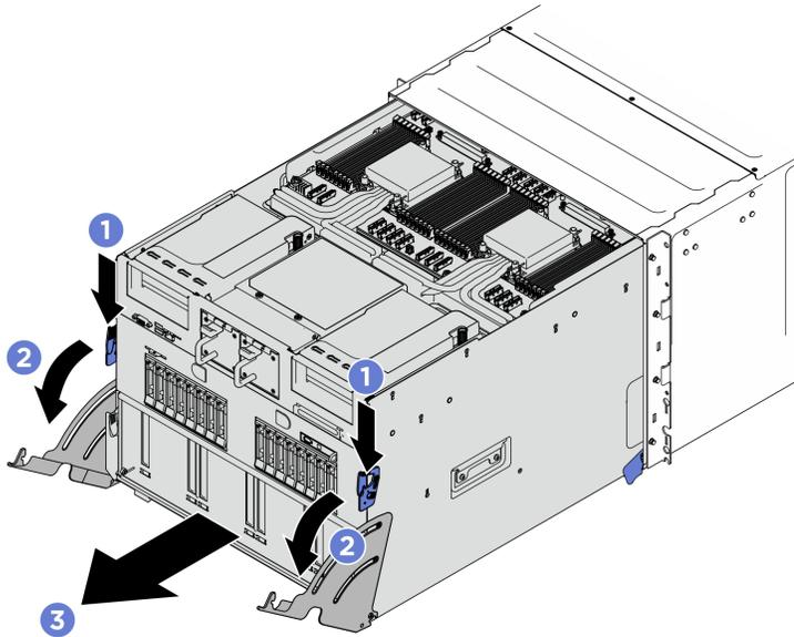
Figure 129. Mise en place (en tirant) de la navette système en position d'arrêt
