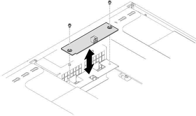
Figure 53. Retrait de la carte de contrôleur de ventilation avant
