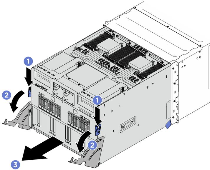
Figure 52. Mise en place (en tirant) de la navette système en position d'arrêt
