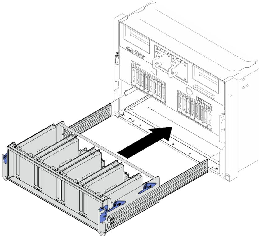
Figure 157. Coulisement de la navette de commutation PCIe jusqu'à la seconde position d'arrêt
