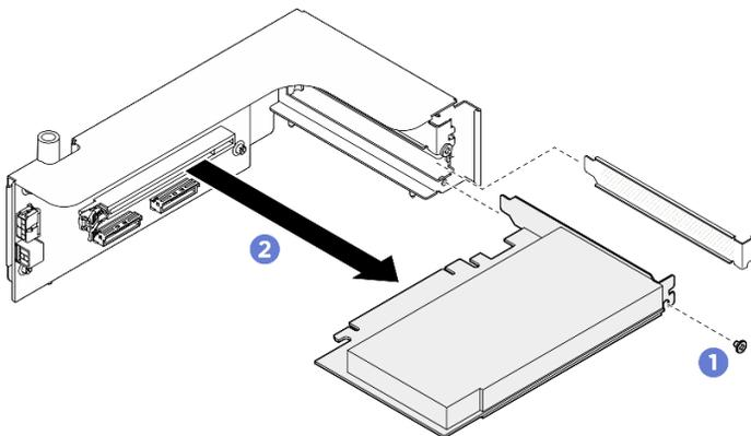
Figure 172. Retrait d'un adaptateur PCIe
