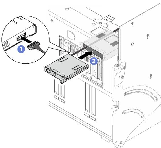
Figure 121. Installation du panneau de diagnostics intégré
