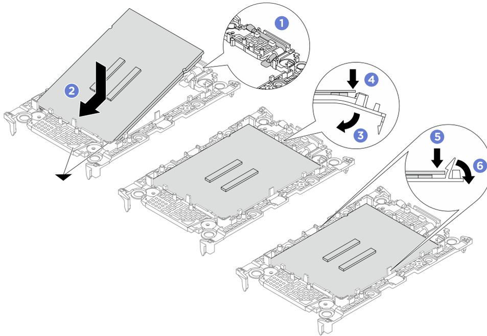
Figure 196. Installation d'un support de processeur
