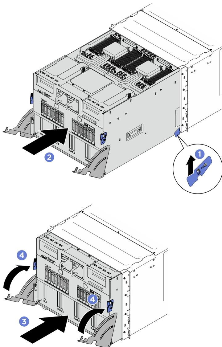
Figure 64. Installation de la navette système
