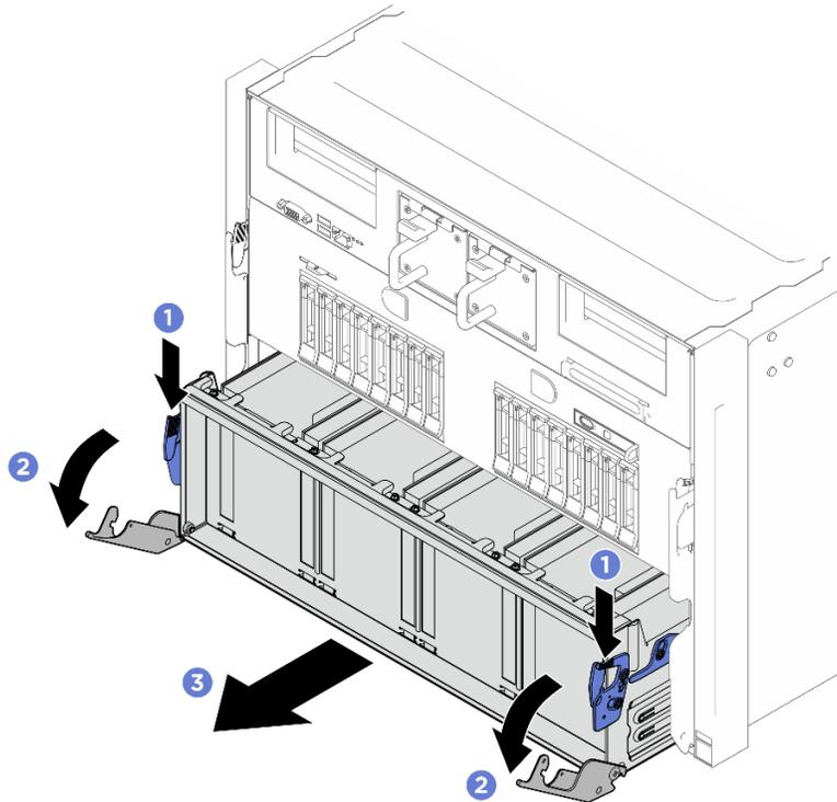
Figure 79. Déplacement (en tirant) de la navette de commutation PCIe jusqu'à la première position d'arrêt
