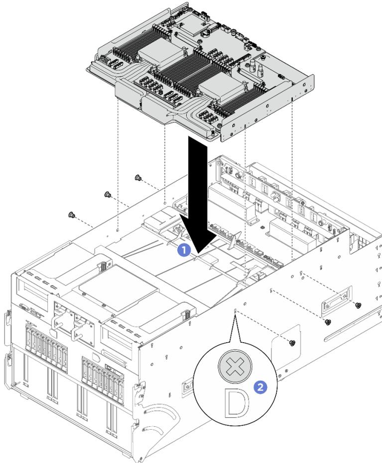
Figure 35. Installation du plateau de calcul
