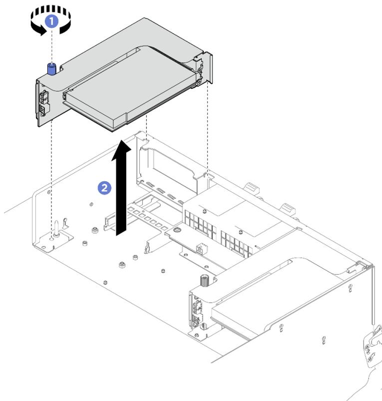
Figure 170. Retrait de l'assemblage de cartes mezzanines PCIe
