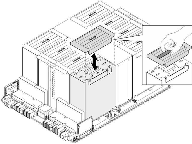
Etape 2. À l'aide de vos deux mains, saisissez la zone en retrait du module GPU et dissipateur thermique (1). Ensuite, alignez le module sur les deux trous de guidage de la carte mère du GPU, puis placez-le délicatement sur la carte mère du GPU.
