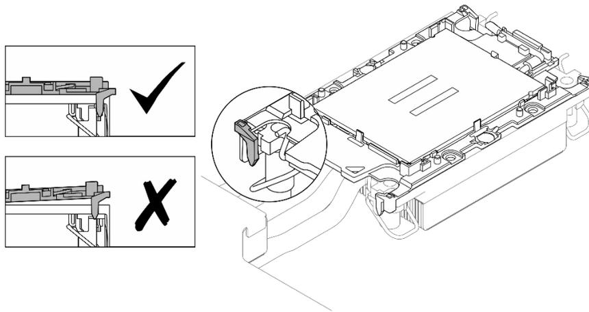
Figure 199. Inspecter visuellement les clips de support
