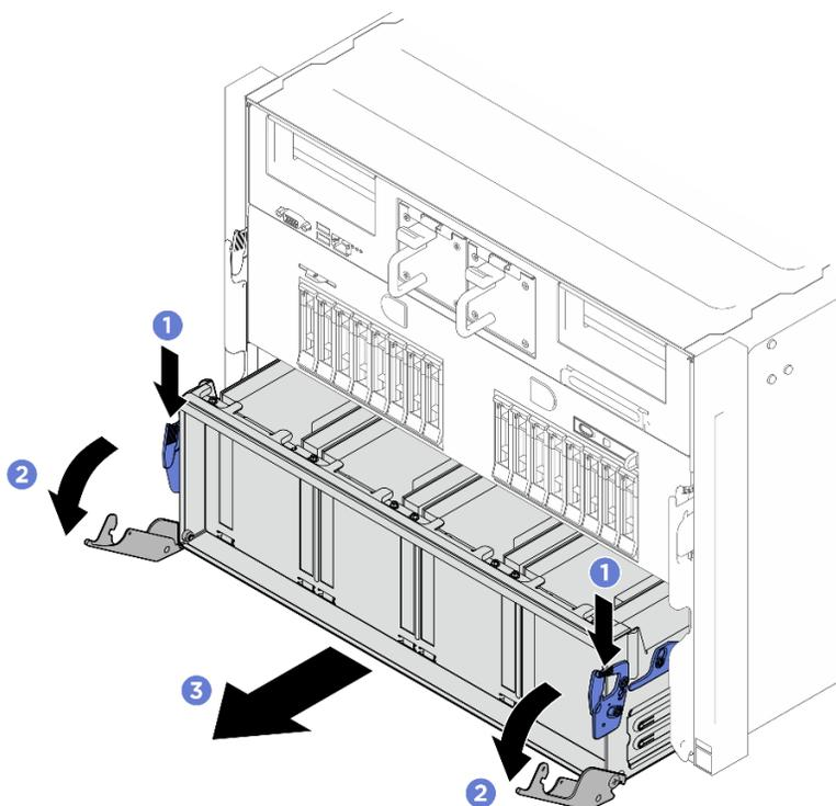
Figure 91. Déplacement (en tirant) de la navette de commutation PCIe jusqu'à la première position d'arrêt
