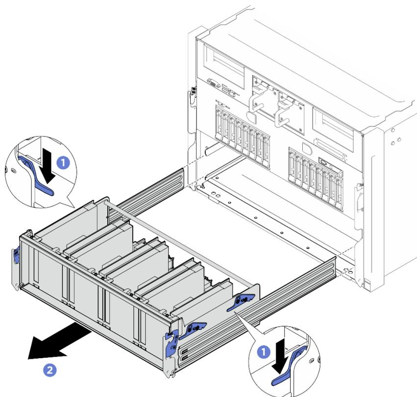
Figure 156. Retrait de la navette de commutation PCIe
