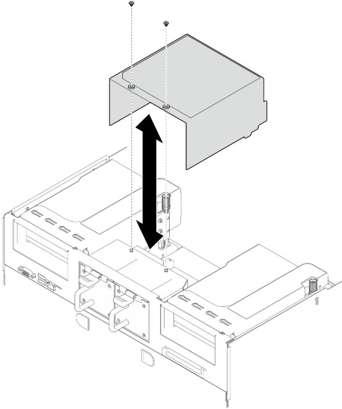
Figure 30. Installation d'un conduit de ventilation
