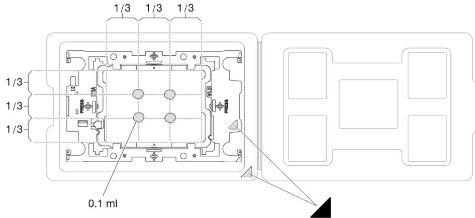
Figure 197. Application de pâte thermoconductrice avec processeur dans le plateau d'expédition
