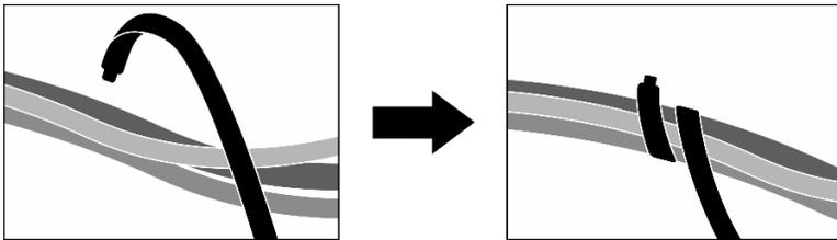
Figure 245. Fixation des câbles à l'aide d'attaches de câbles
