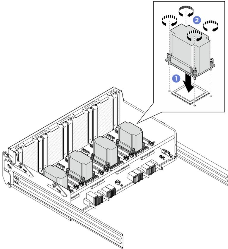
Figure 153. Installation du dissipateur thermique du tableau de commutation PCIe
