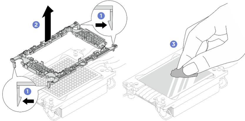
Figure 194. Dissociation d'un support de processeur du dissipateur thermique
