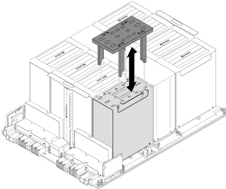
Figure 107. Installation du gabarit
