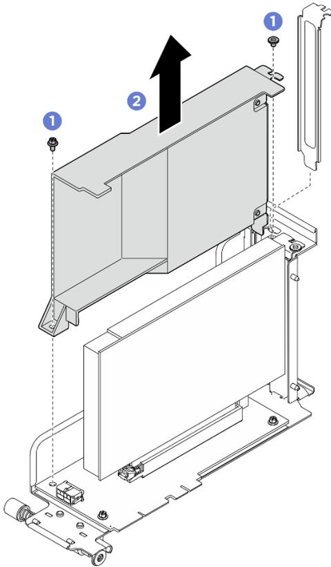
Figure 171. Retrait d'une grille d'aération pour carte mezzanine PCIe
