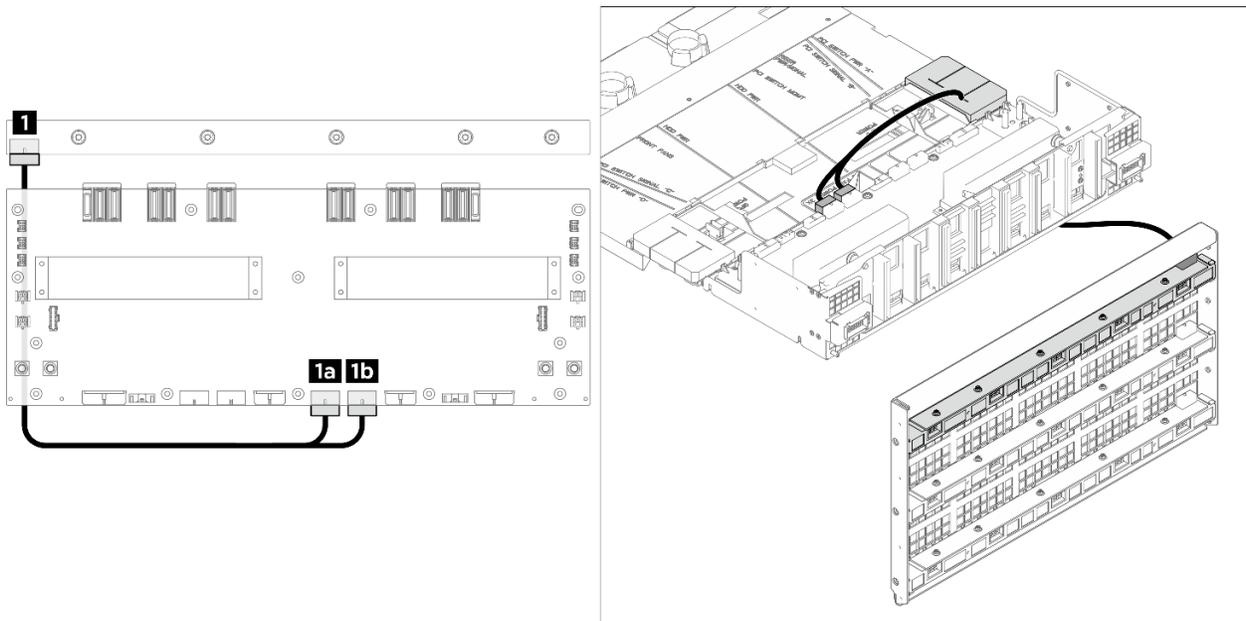
Figure 232. Cheminement des câbles de la carte de contrôleur de ventilation arrière (partie supérieure)
