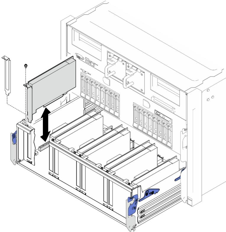
Figure 142. Installation de l'adaptateur PCIe inférieur
