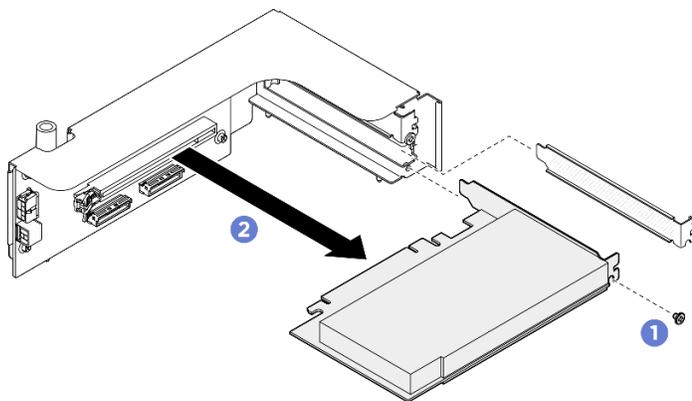
Figure 146. Retrait de l'adaptateur PCIe supérieur
