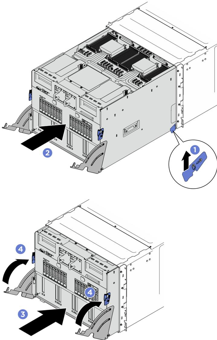
Figure 27. Installation de la navette système
