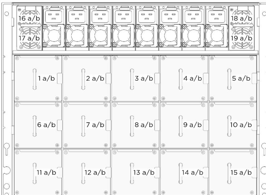
Figure 45. Numéros des ventilateurs arrière
