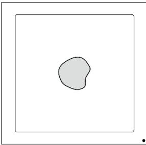
Figure 152. Application de la pâte thermoconductrice
