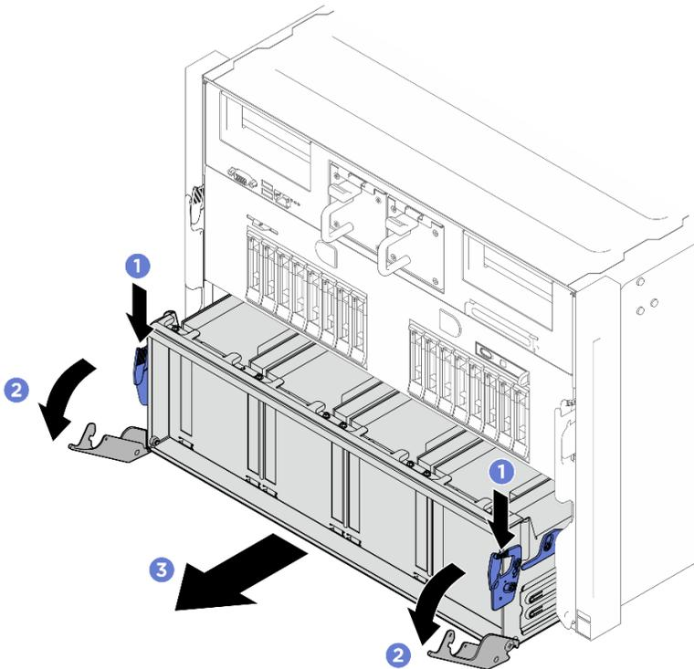
Figure 67. Déplacement (en tirant) de la navette de commutation PCIe jusqu'à la première position d'arrêt
