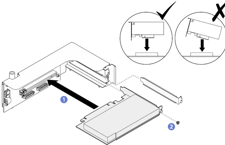
Figure 147. Installation de l'adaptateur PCIe supérieur
