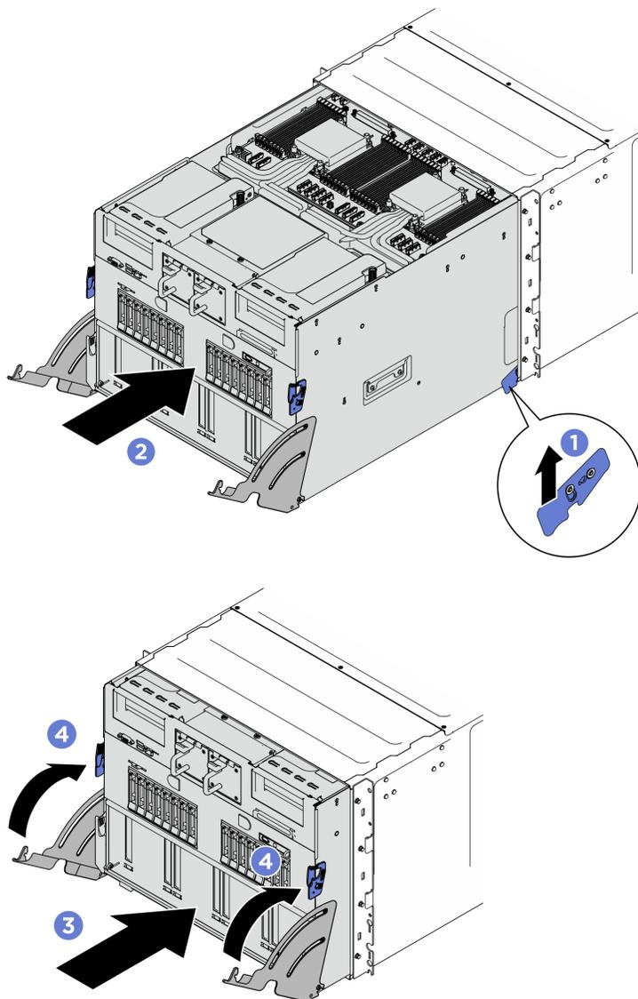
Figure 178. Installation de la navette système
