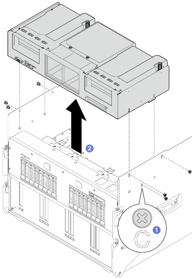
Figure 62. Retrait du boîtier FIO/PCI
