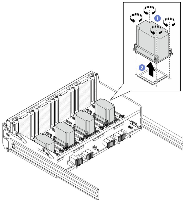
Figure 149. Retrait du dissipateur thermique du tableau de commutation PCIe
