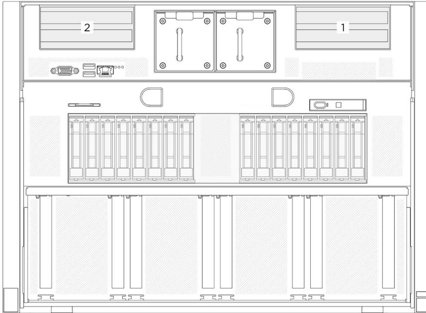
Figure 175. Emplacements des cartes mezzanines PCIe
