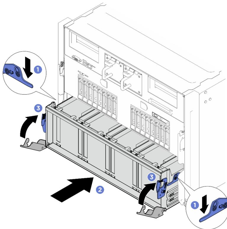
Figure 144. Installation de la navette de commutation PCIe
