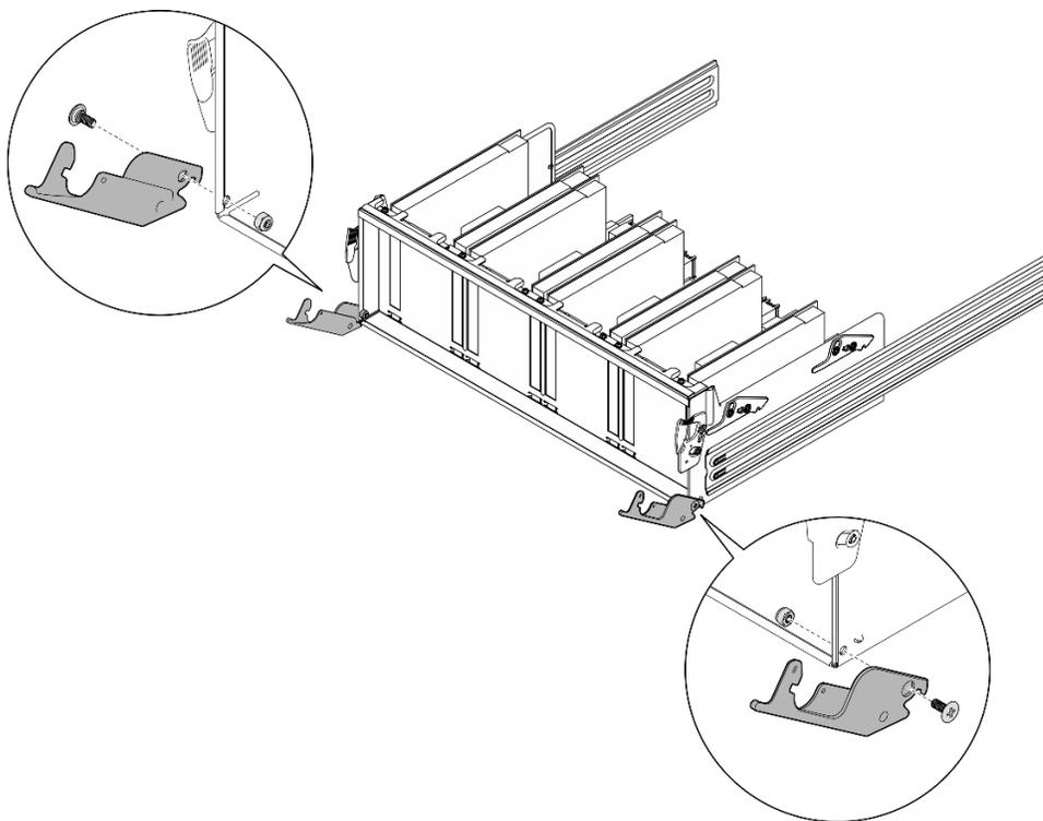
Figure 161. Retrait du levier de déverrouillage
