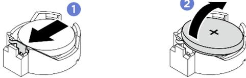
Figure 37. Retrait de la pile CMOS
