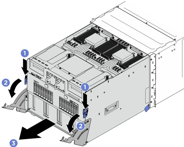
Figure 61. Mise en place (en tirant) de la navette système en position d'arrêt
