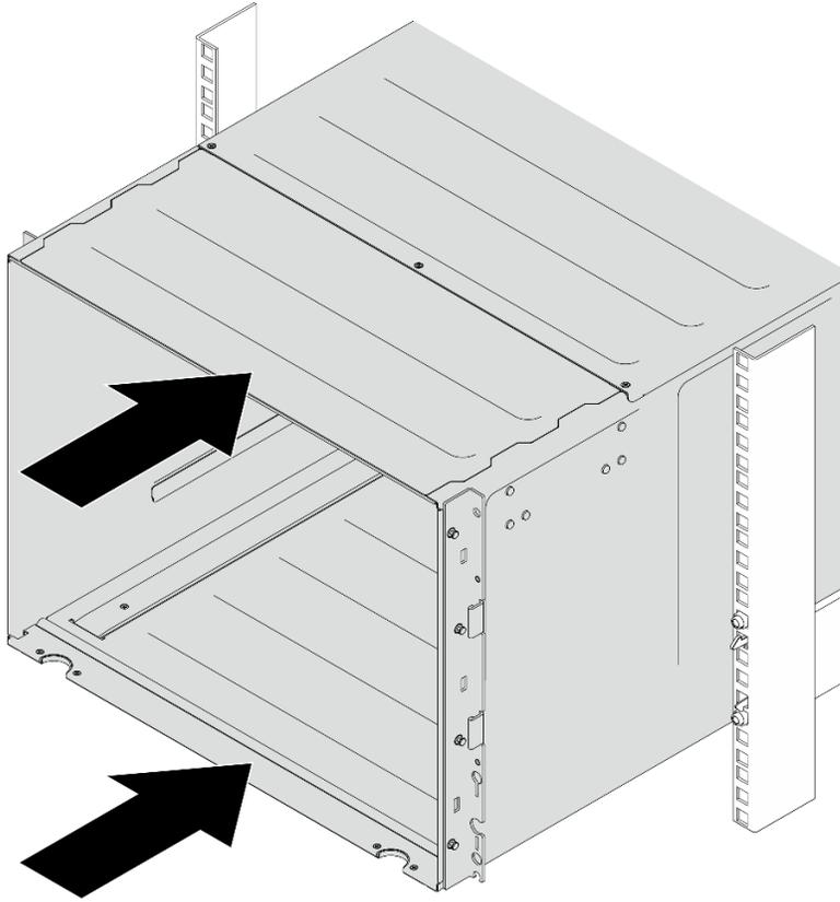
Figure 13. Coulisement du châssis
