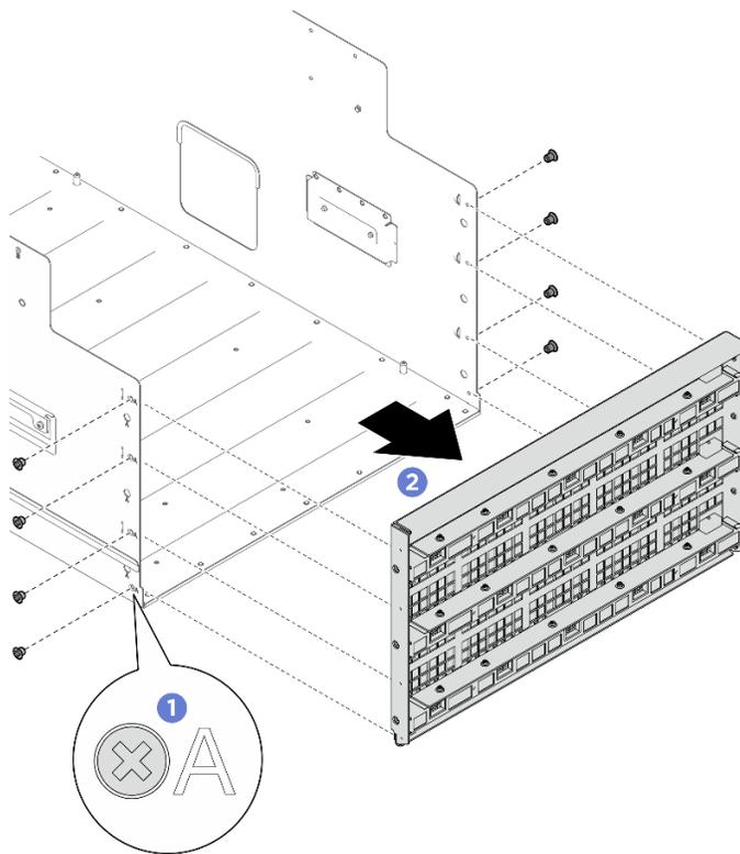
Figure 81. Retrait de la cloison
