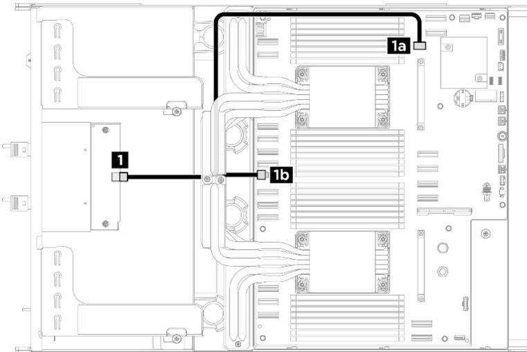
Figure 231. Cheminement des câbles de la carte de contrôleur de ventilation avant
