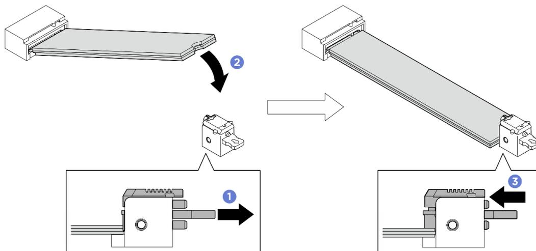
Figure 127. Installation de l'unité M.2 inférieure
