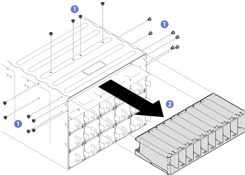
Figure 202. Retrait du boîtier PSU
