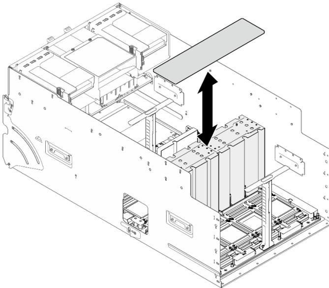
Figure 77. Installation du cache du dissipateur thermique NVSwitch
