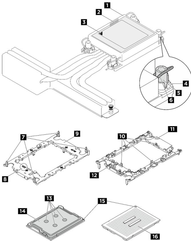
Figure 189. Composants du module de processeur-dissipateur thermique
