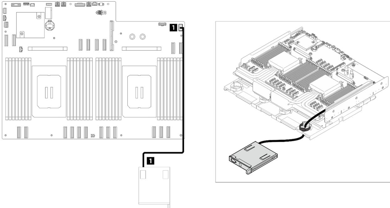
Figure 237. Cheminement des câbles du panneau de diagnostics intégré
