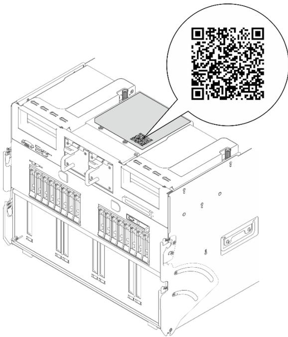
Figure 15. Étiquette de maintenance et code QR
