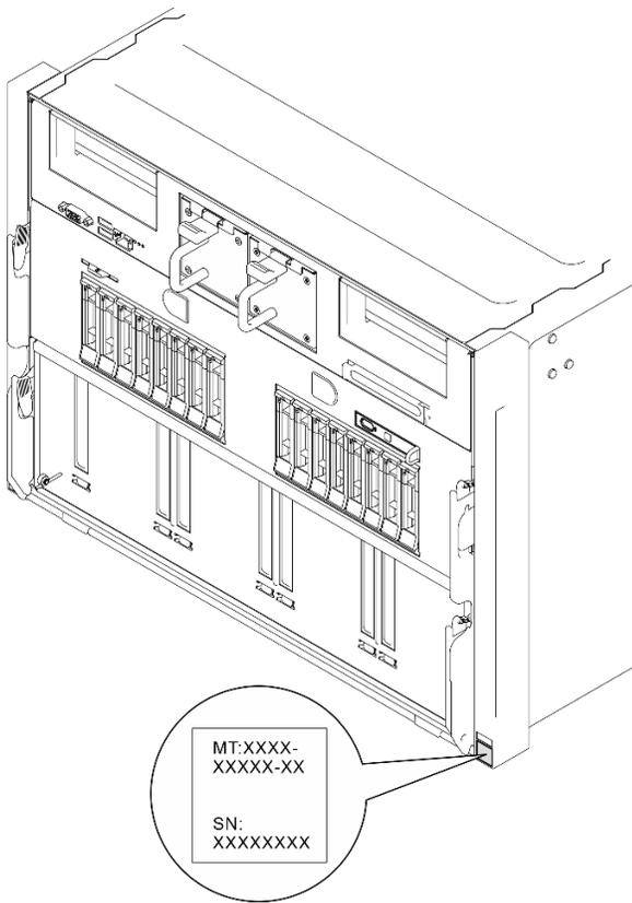
Figure 13. Emplacement de l'étiquette d'identification
