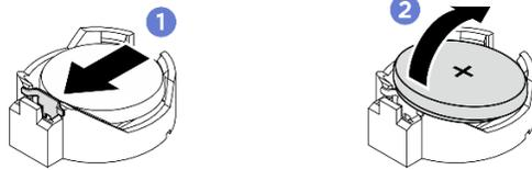
Figure 49. Retrait de la pile CMOS
