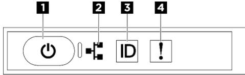
Figura 3. LED del pannello di diagnostica integrato
