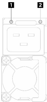
Figura 10. LED dell'alimentatore
