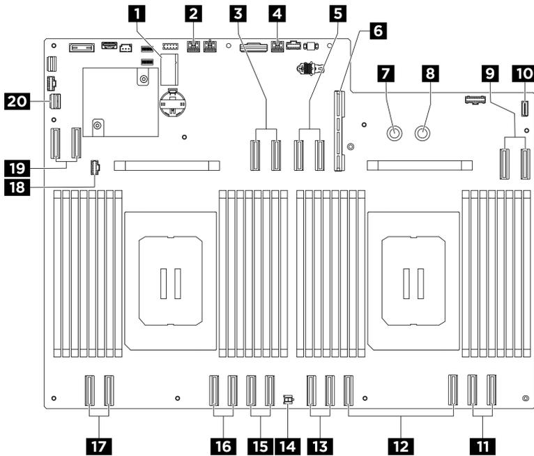
Figura 6. Connettori della scheda di sistema
