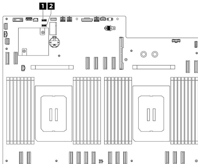
Figura 7. Switch della scheda di sistema
