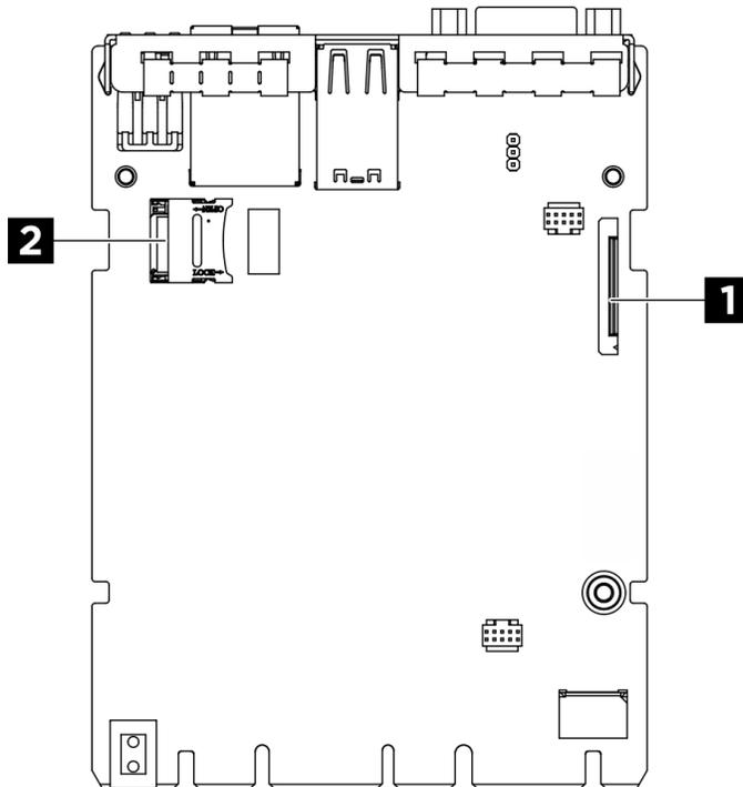
Figura 8. Connettori della scheda I/O di sistema
