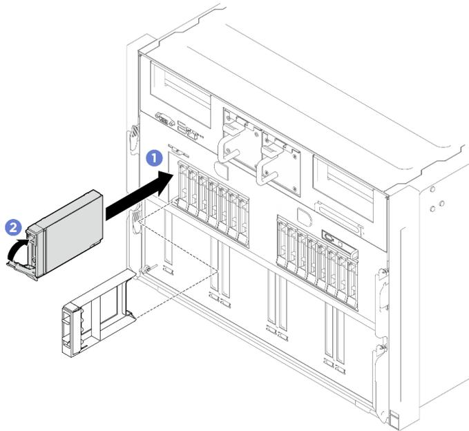
그림 20. 2.5인치 핫 스왑 드라이브 설치
