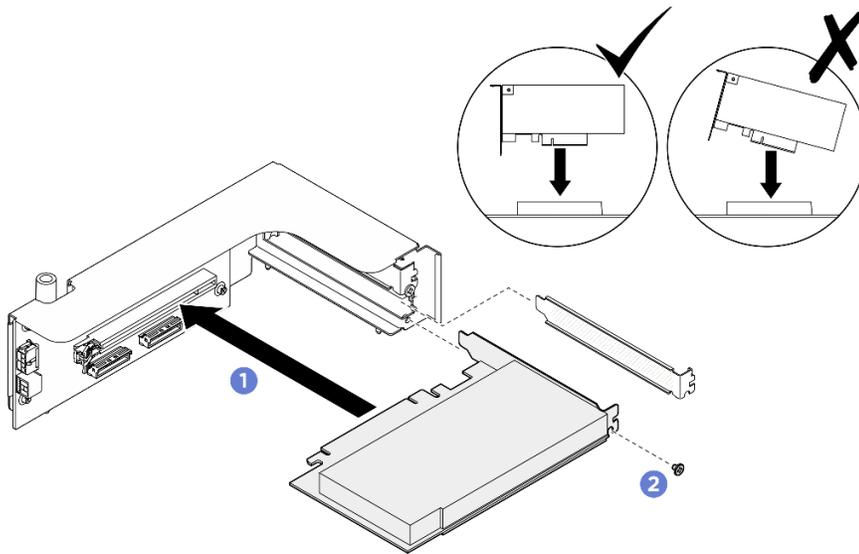
그림 147. 상단 PCIe 어댑터 설치
