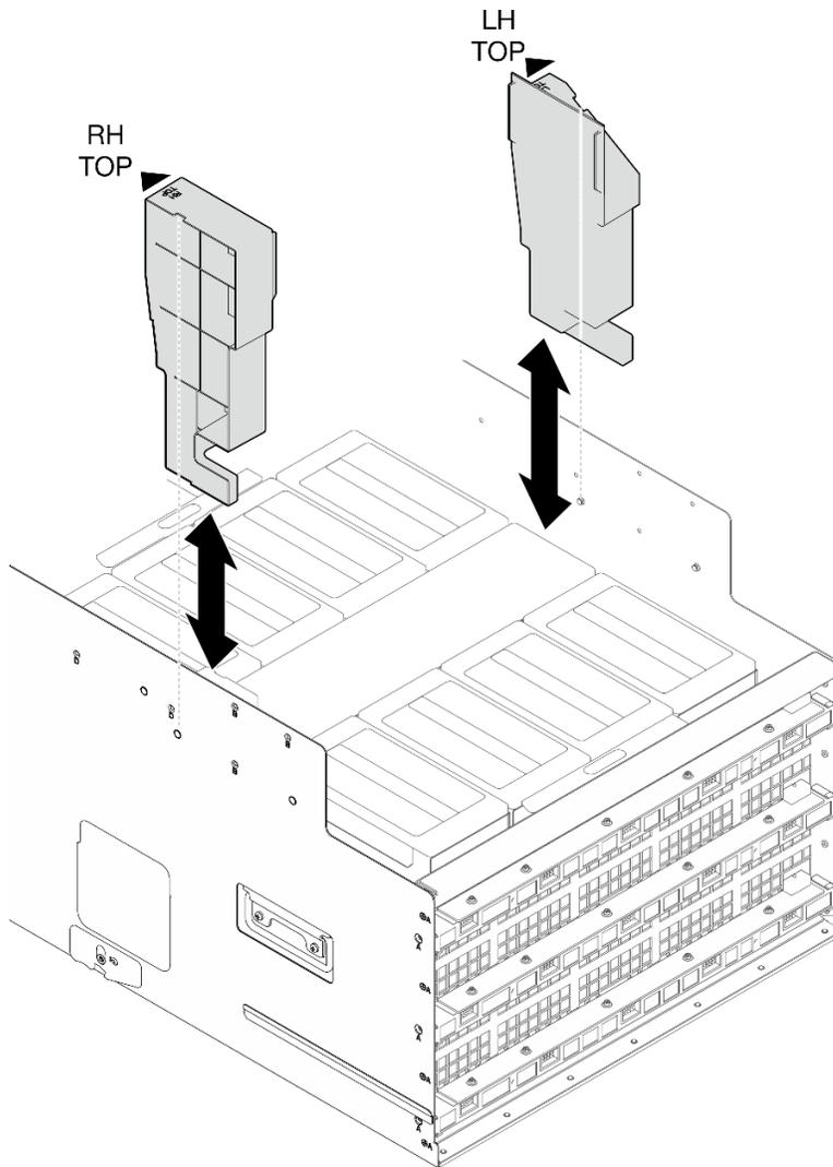
그림 66. GPU 통풍관 설치
