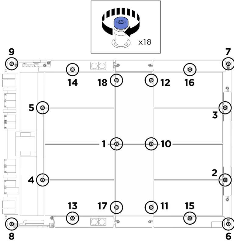
**그림 88. 나사 설치**
