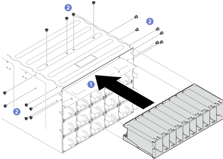
그림 203. PSU 케이스지 설치
