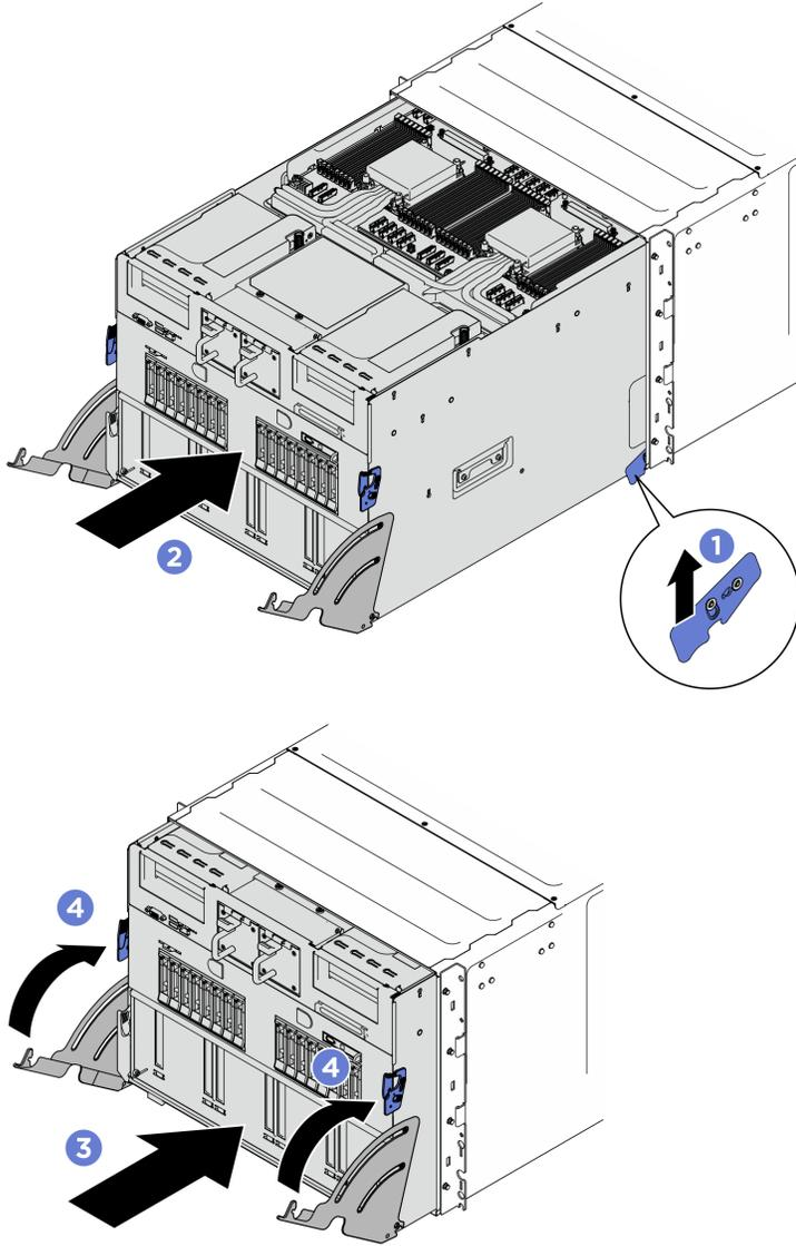
그림 178. 시스템 셔플 설치
