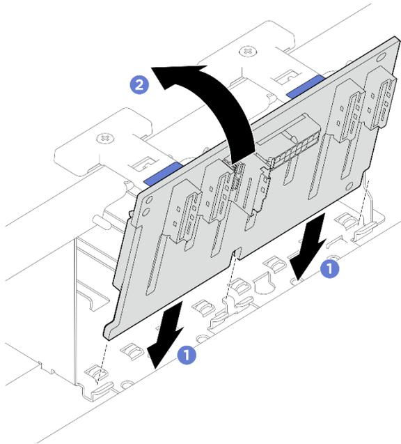
**그림 25. 2.5인치 드라이브 백플레인 설치**
