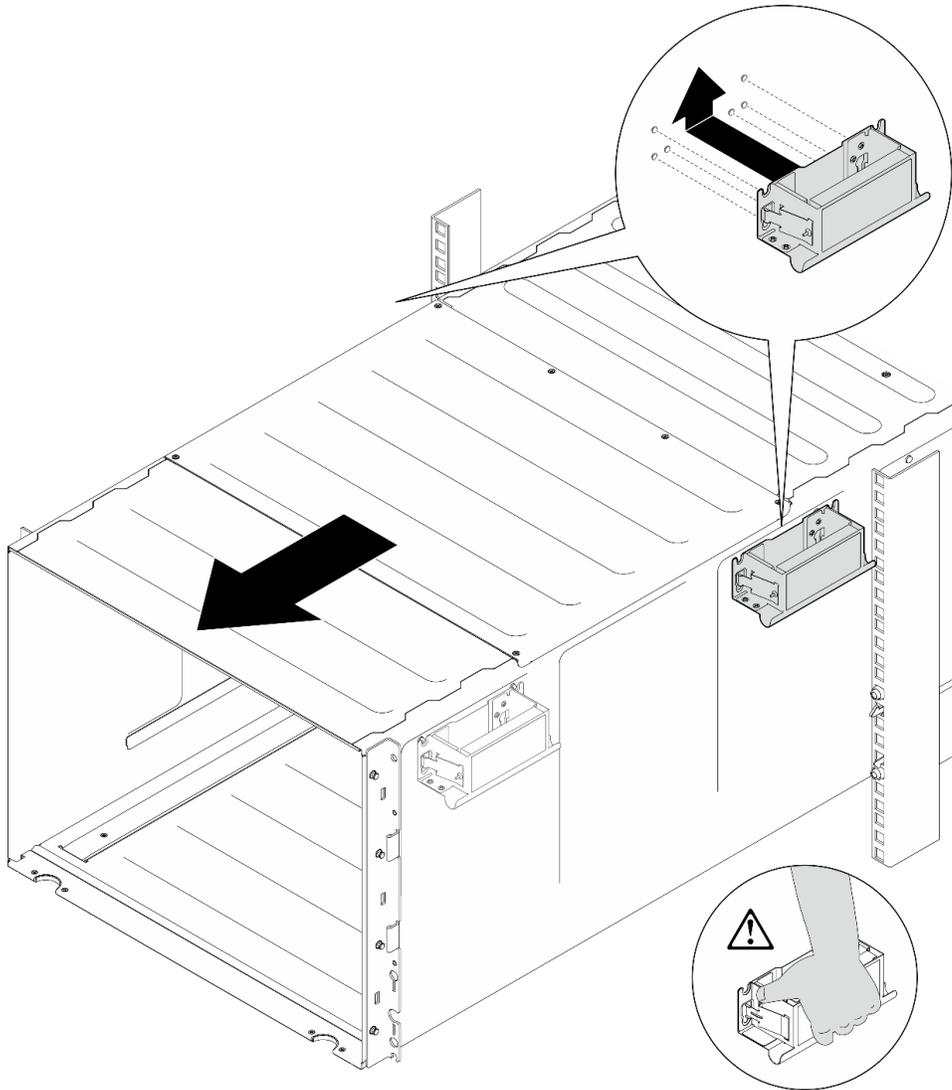
**그림 7. 뒷면 손잡이 설치**
