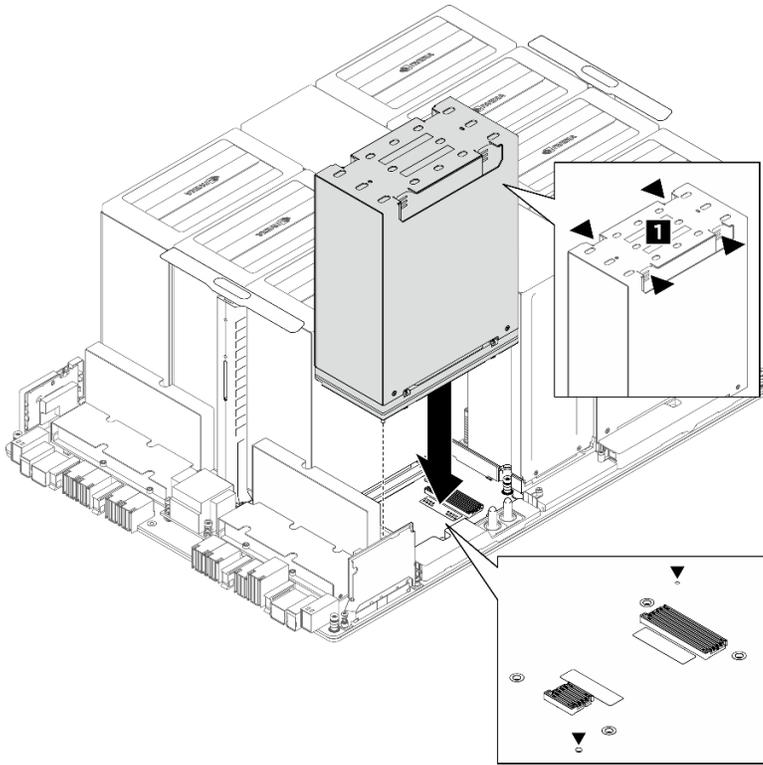
**그림 111. GPU 및 방열판 모듈 설치**
