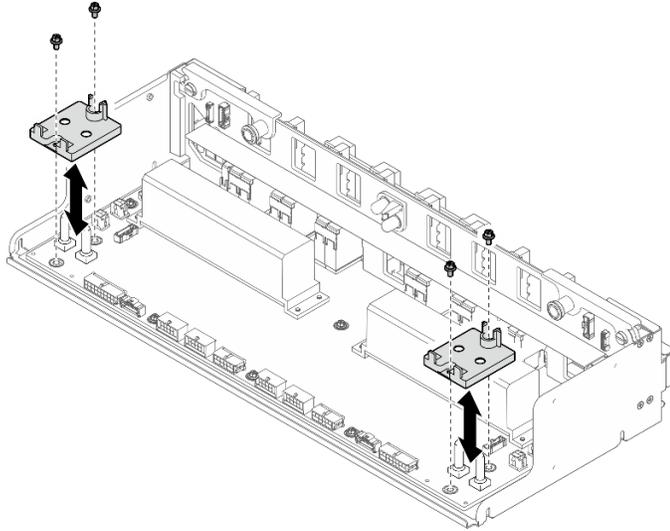
그림 184. 케이블 고정장치 설치
