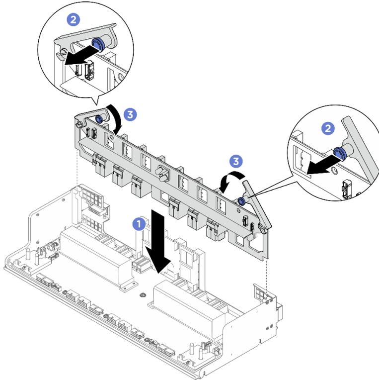
**그림 205. PSU 인터포저 설치**
