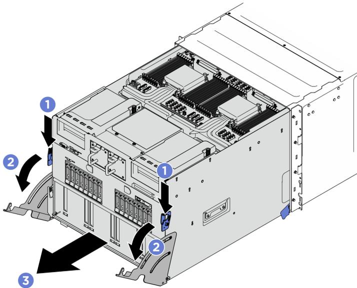
그림 61. 시스템 셔틀을 정지 위치로 당기기
