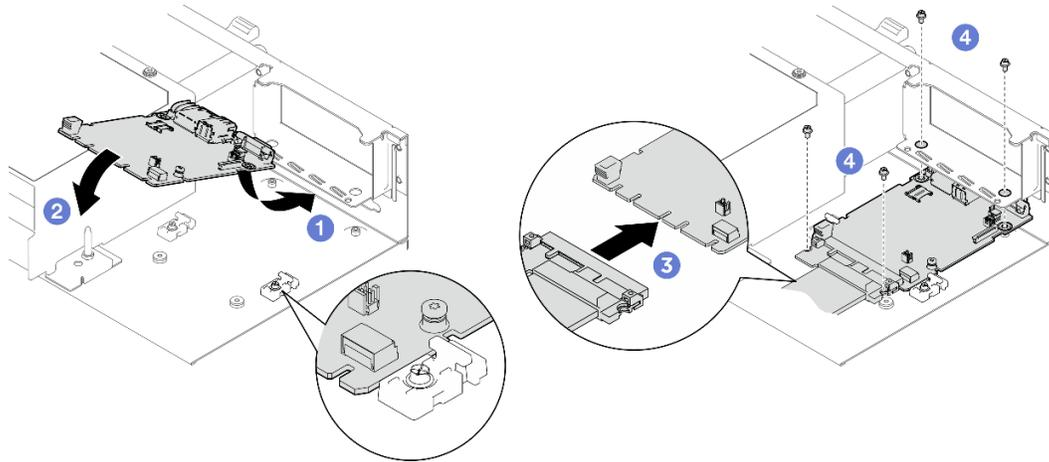
그림 212. 시스템 I/O 보드 설치
