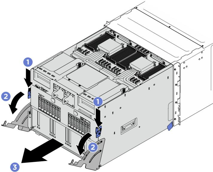
그림 28. 시스템 셔틀을 정지 위치로 당기기
