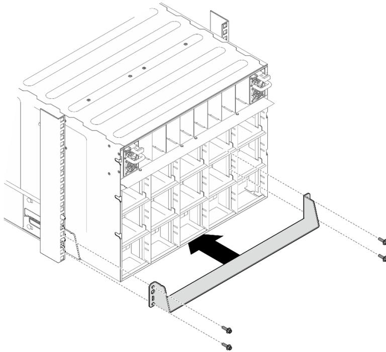
**그림 15. 하단 지지 브래킷 설치**
