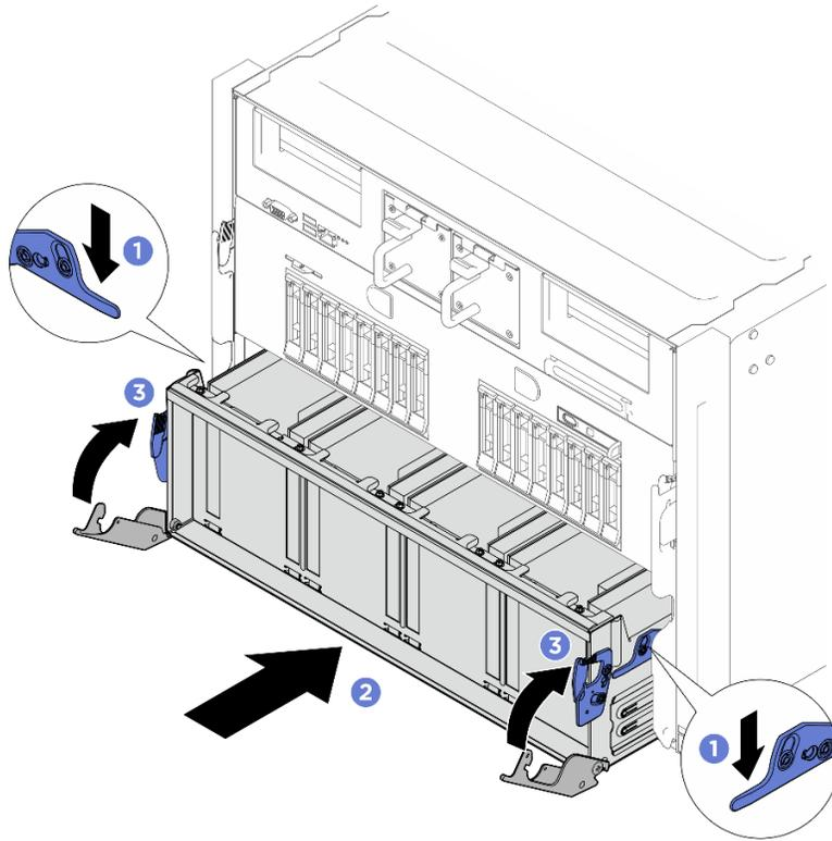
그림 144. PCIe 스위치 셔틀 설치
