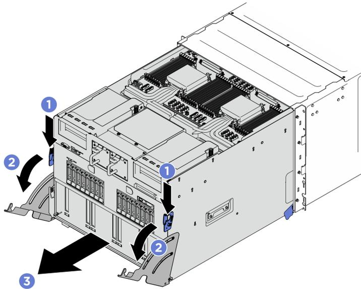
그림 118. 시스템 서플을 정지 위치로 당기기
