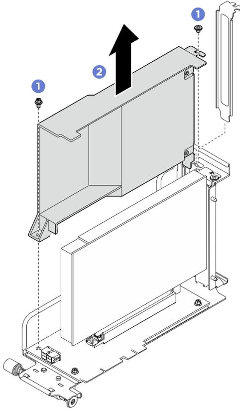
**그림 171. PCIe 라이저 공기 조절 장치 제거**
