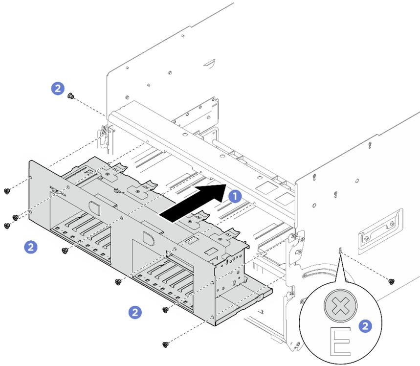
**그림 42. 드라이브 케이지 설치**
