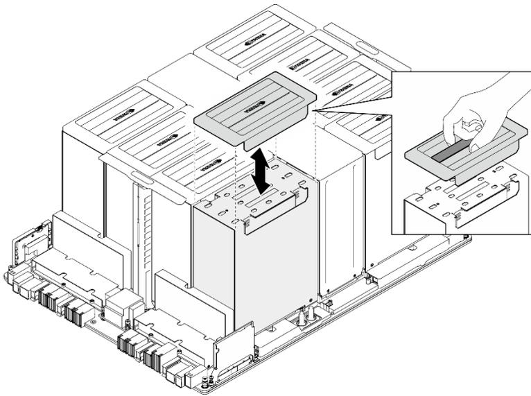
**그림 115. 플라스틱 덮개 설치**
