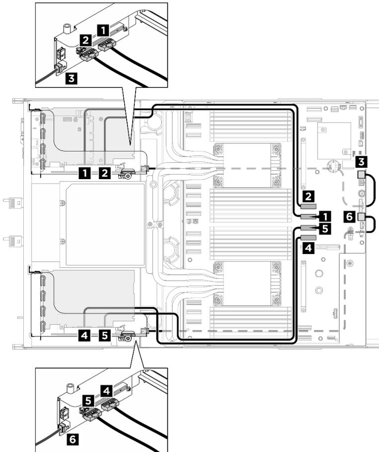
그림 239. PCIe 라이저 케이블 배선
