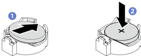
**그림 39. CMOS 배터리 설치**
