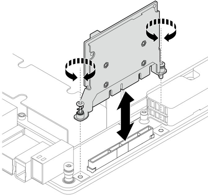
그림 105. CX-7 어댑터 카드 설치
