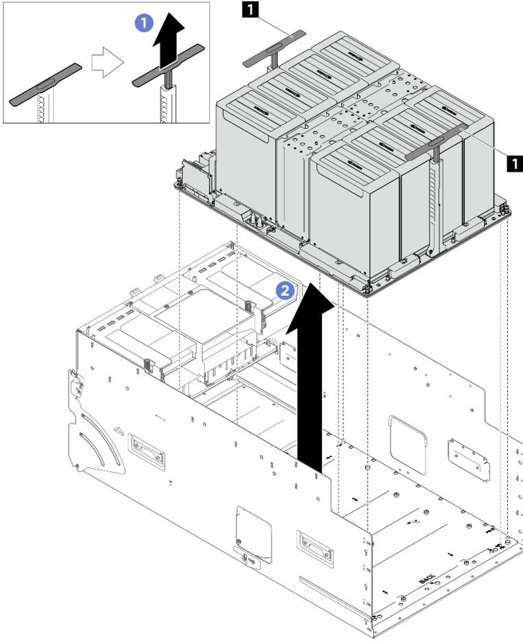
그림 84. GPU 복합체 제거
