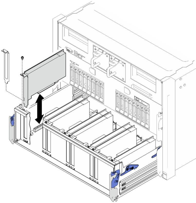
**그림 142. 하단 PCIe 어댑터 설치**
