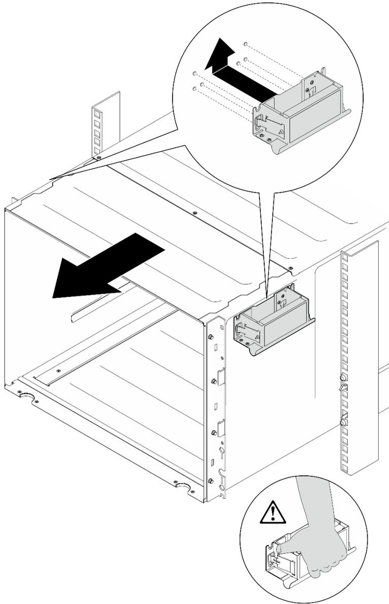
**그림 6. 앞면 손잡이 설치**
