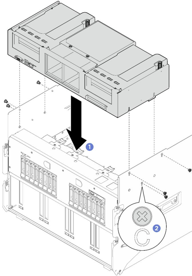
**그림 63. FIO/PCI 케이지 설치**
