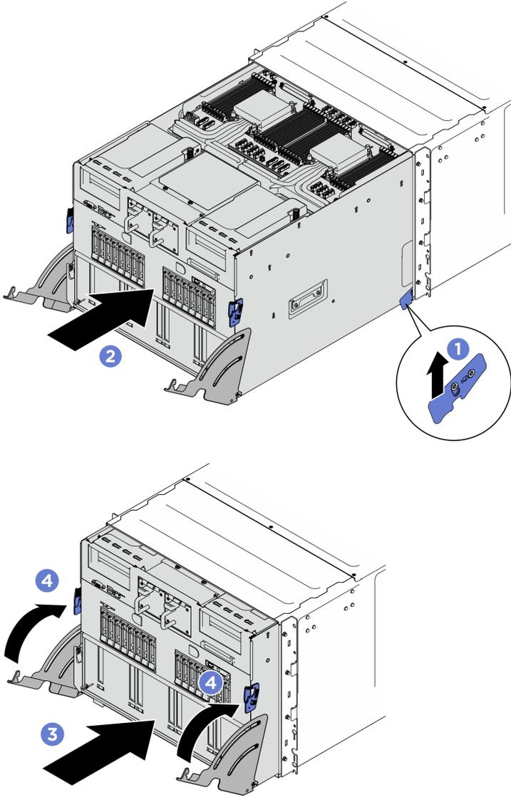
그림 134. 시스템 셔플 설치
