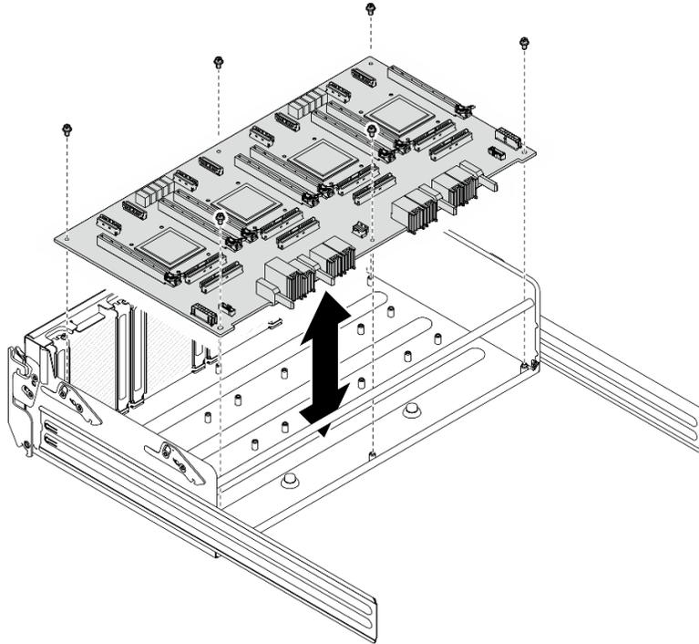
그림 151. PCIe 스위치 보드 설치
