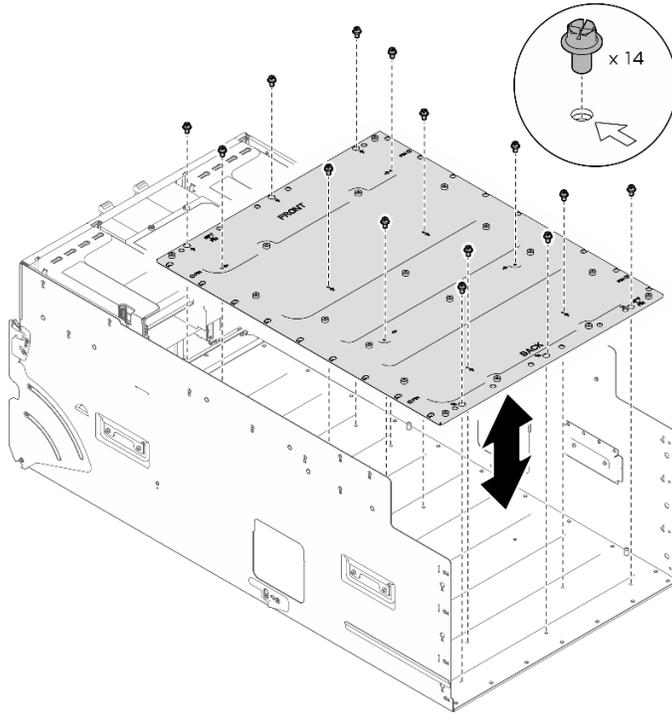
**그림 98. GPU 복합체 어댑터판 설치**
