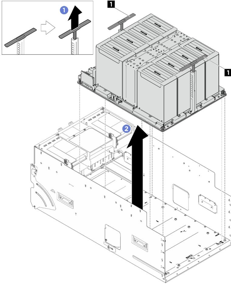
**그림 96. GPU 복합체 제거**
