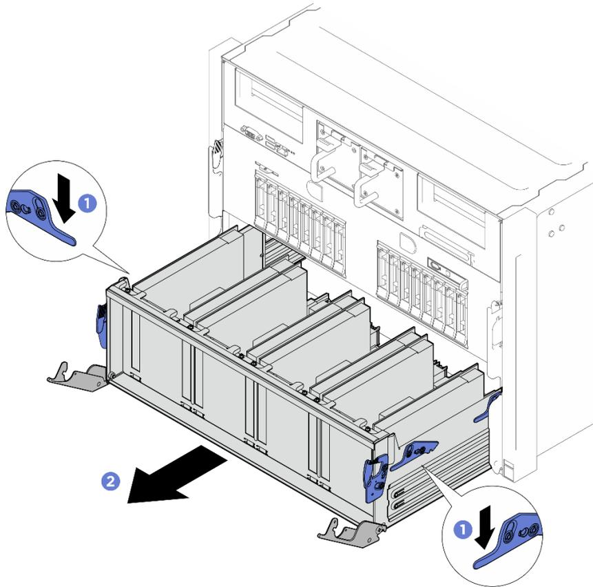
**그림 140. PCIe 스위치 셔들을 두 번째 정지 위치로 당기기**
