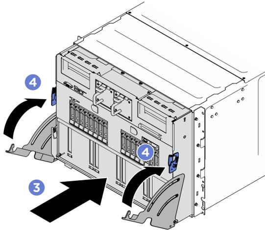
그림 148. 시스템 셔틀 설치
