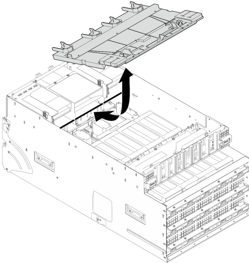
그림 32. 케이블 홀더 프레임 및 배플 어셈블리 제거
