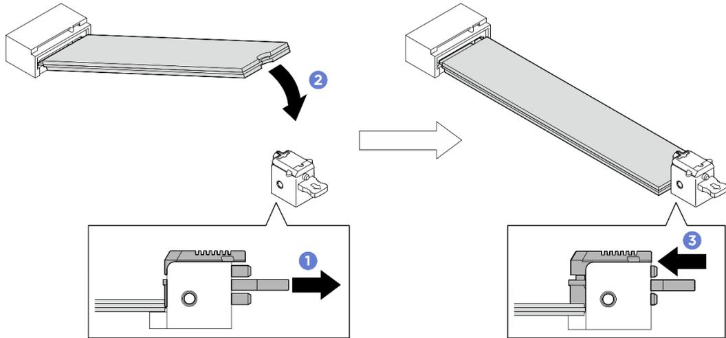
그림 127. 하단 M.2 드라이브 설치
