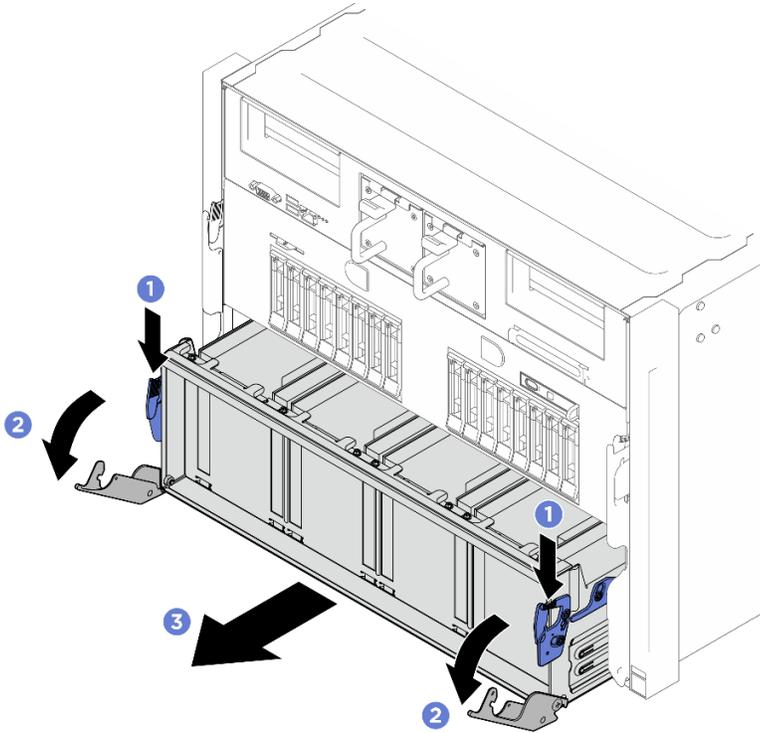
그림 154. PCIe 스위치 셔틀을 첫 번째 정지 위치로 당기기
