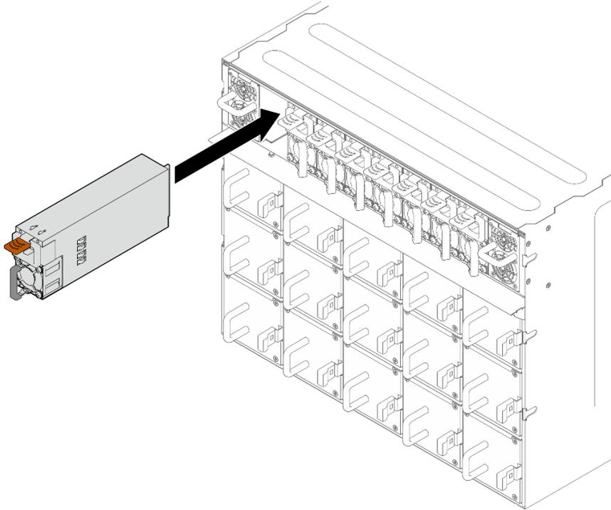
그림 188. 전원 공급 장치 설치
