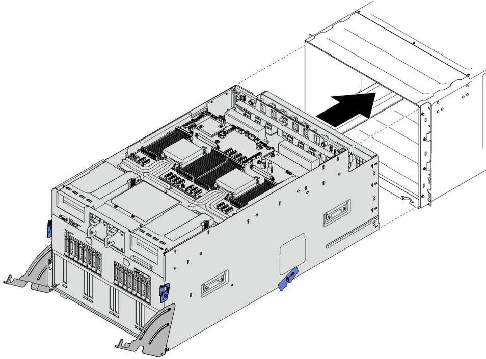
**그림 216. 시스템 서버를 정지 위치로 밀기**
