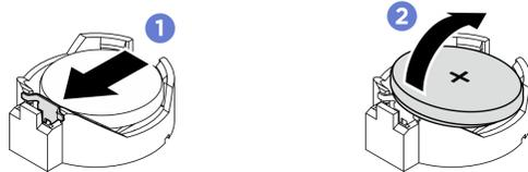
그림 37. CMOS 배터리 제거
