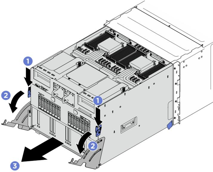
**그림 129. 시스템 서플을 정지 위치로 당기기**
