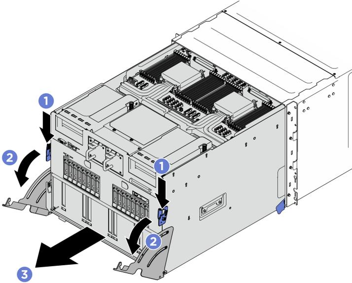
그림 214. 시스템 셔틀을 정지 위치로 당기기
