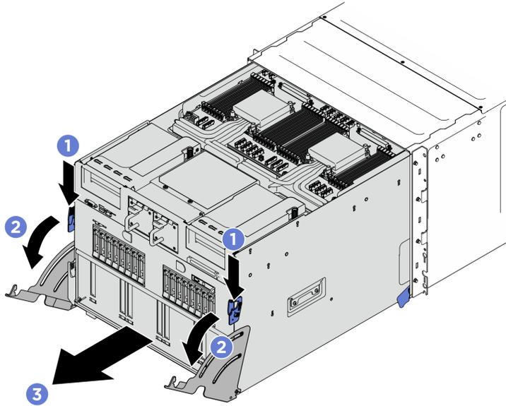
그림 210. 시스템 서플을 정지 위치로 당기기
