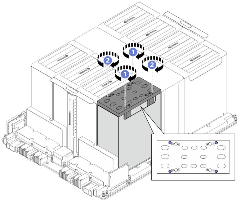
그림 113. 나사 설치
