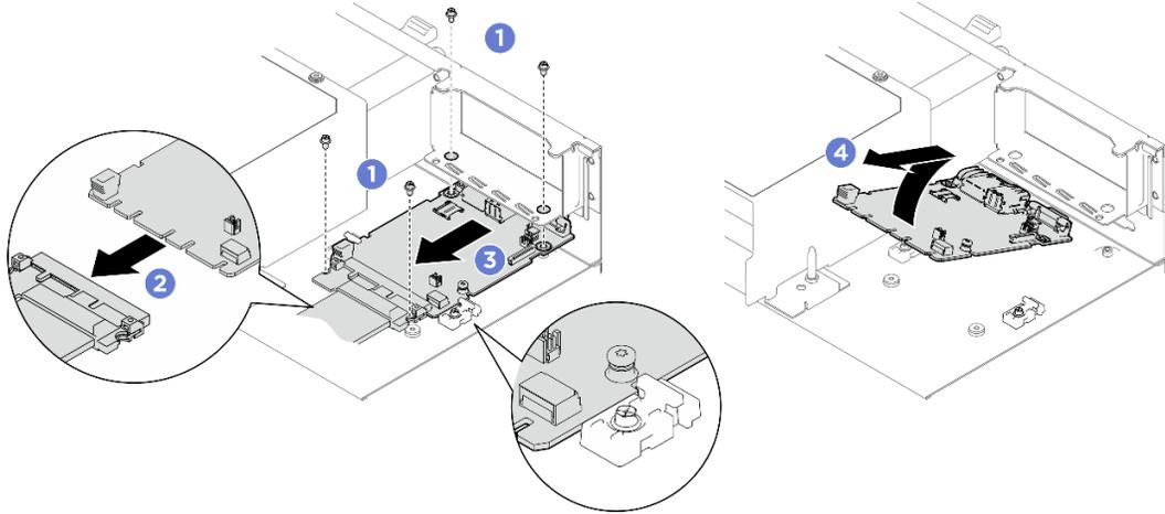
그림 211. 시스템 I/O 보드 제거
