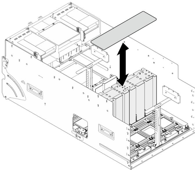
**그림 77. NVSwitch 방열판 덮개 설치**
