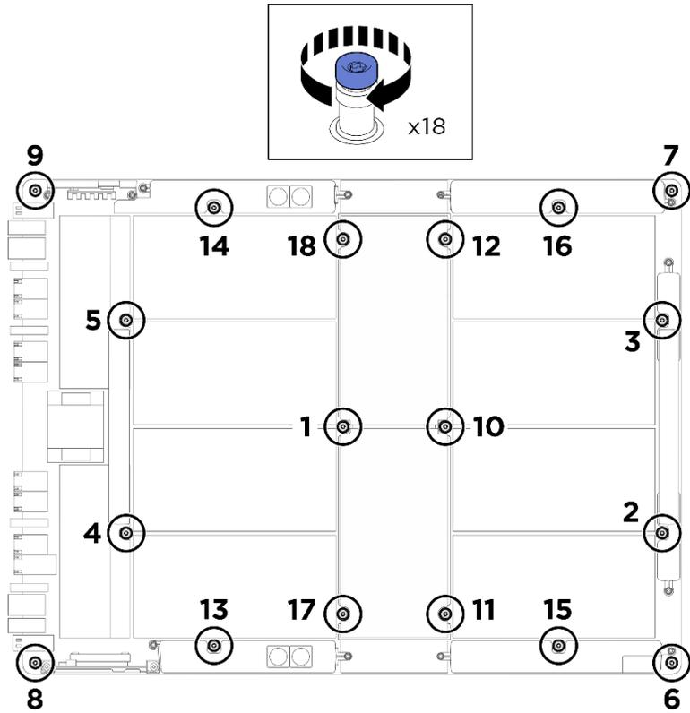
**그림 101. 나사 설치**
