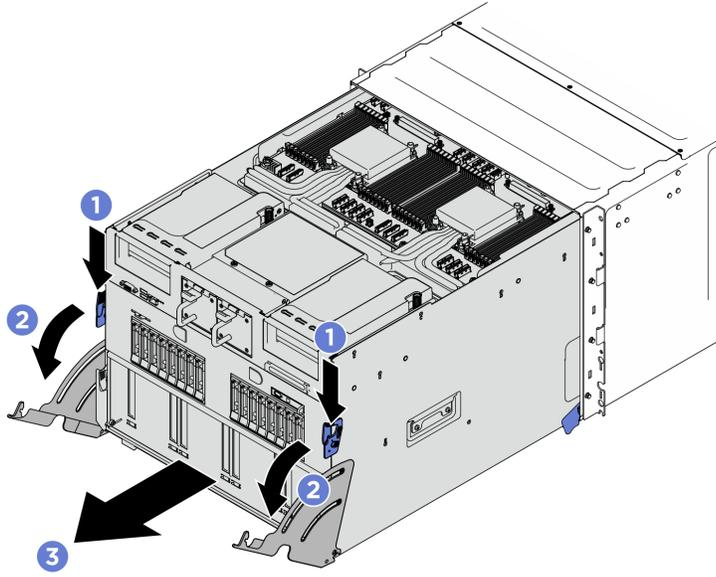
**그림 22. 시스템 서들을 정지 위치로 당기기**
