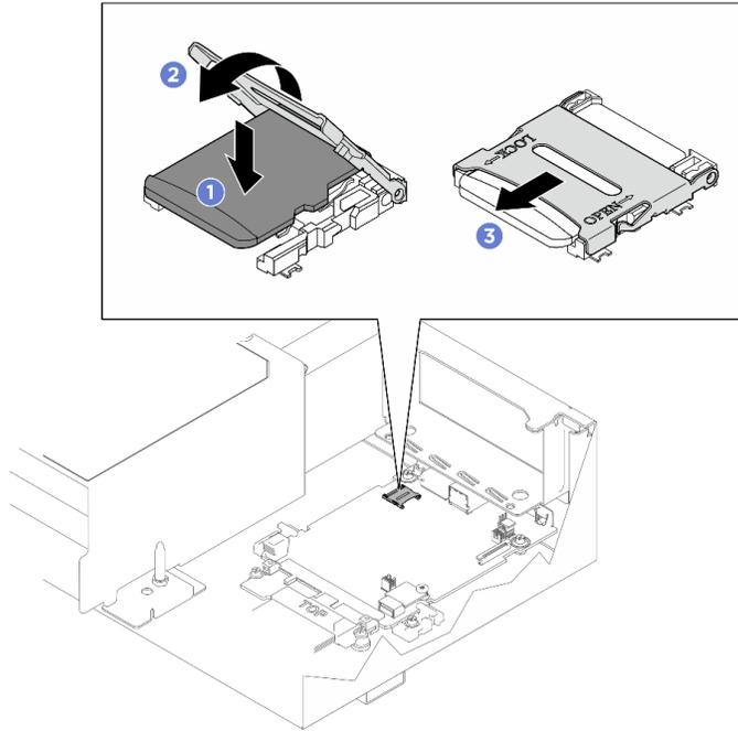
**그림 137. microSD 카드 설치**
