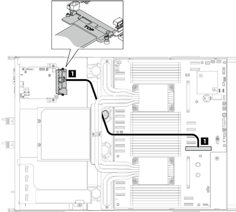
그림 248. 시스템 I/O 보드 케이블 배선
