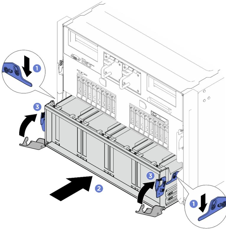
그림 159. PCIe 스위치 셔틀 설치
