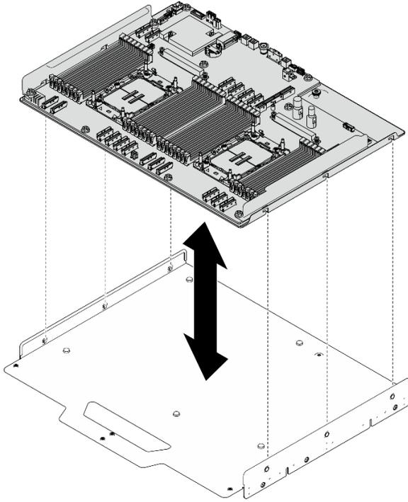
그림 208. 시스템 보드 설치
