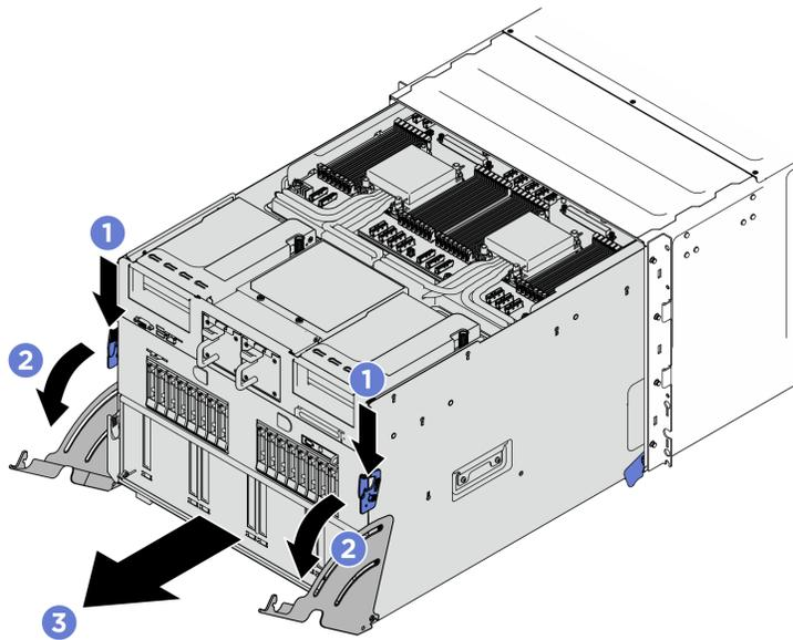
**그림 164. 시스템 셔틀을 정지 위치로 당기기**
