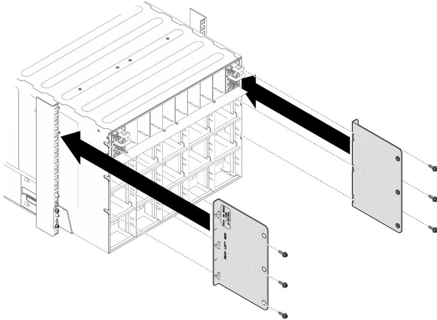
그림 16. 상단 지지 브래킷 설치
