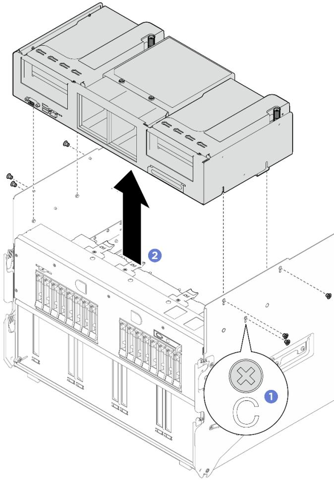
그림 62. FIO/PCI 케이스 제거
