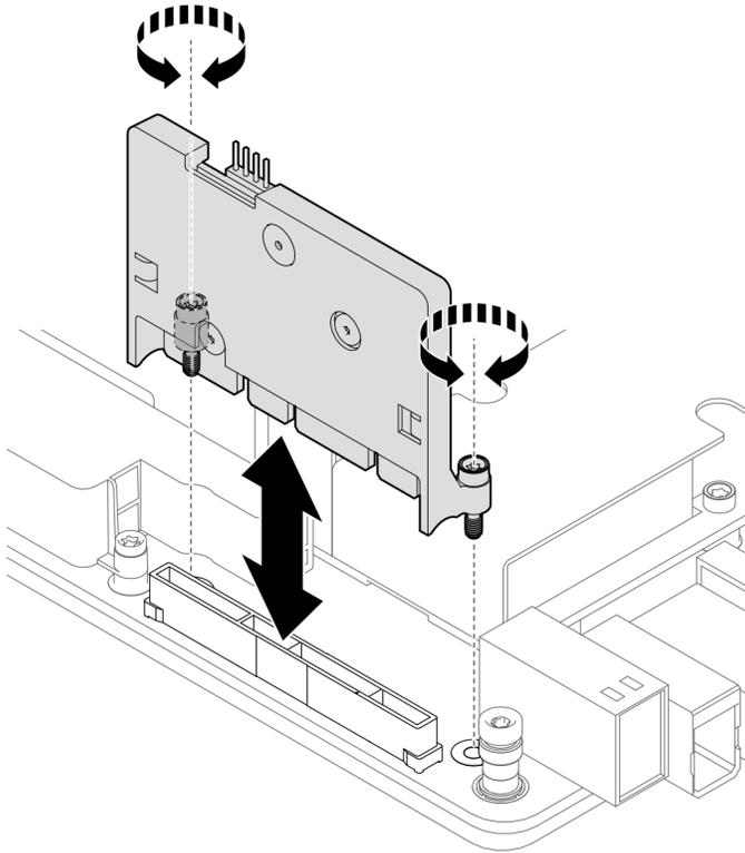
그림 117. HMC 카드 설치
