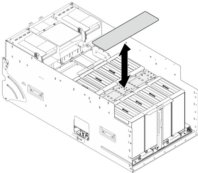
**그림 89. NVSwitch 방열판 덮개 설치**
