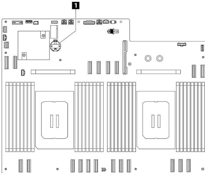
그림 36. CMOS 배터리 위치
