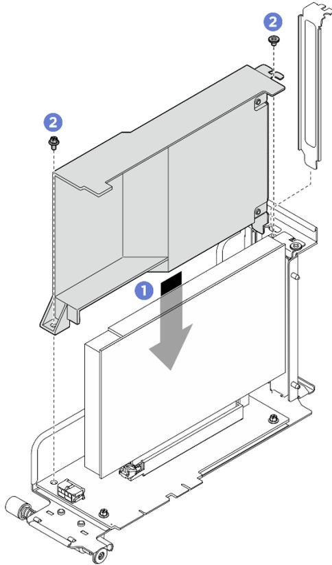
그림 166. PCIe 라이저 공기 조절 장치 설치
