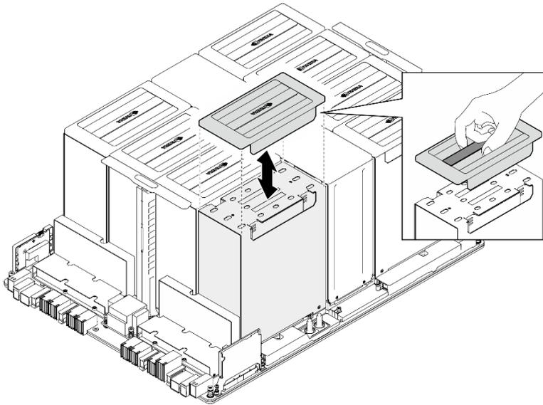
단계 2. 양손으로 GPU 및 방열판 모듈 **1**의 오목한 부분을 잡은 다음 모듈을 GPU 베이스보드에 있는 두 개의 가이드 구멍에 맞추고 GPU 베이스보드에 조심스럽게 놓습니다.
