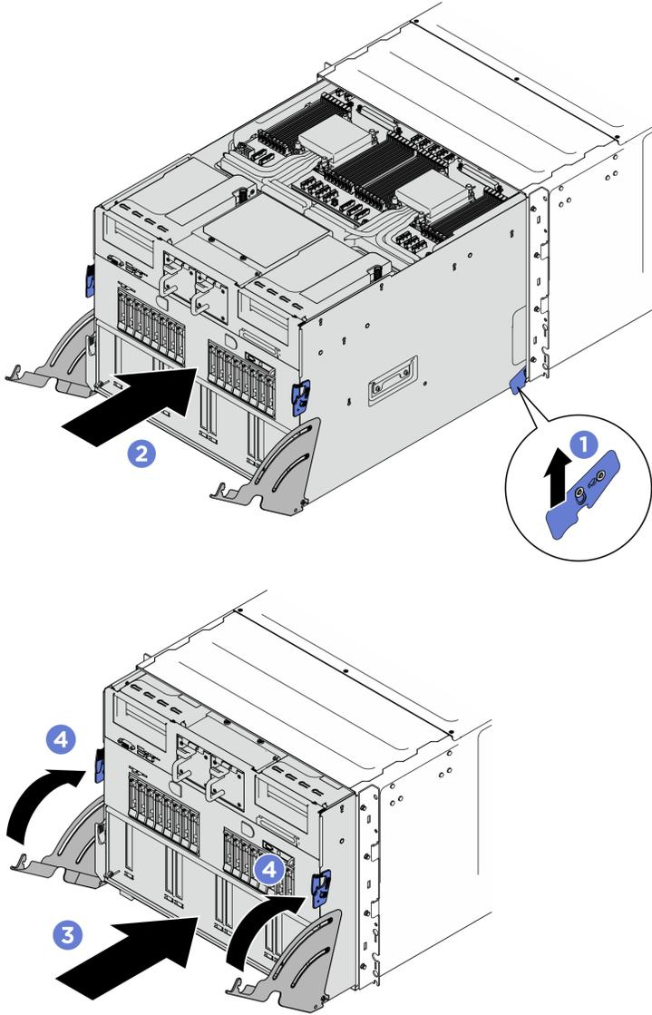
그림 122. 시스템 서플 설치
