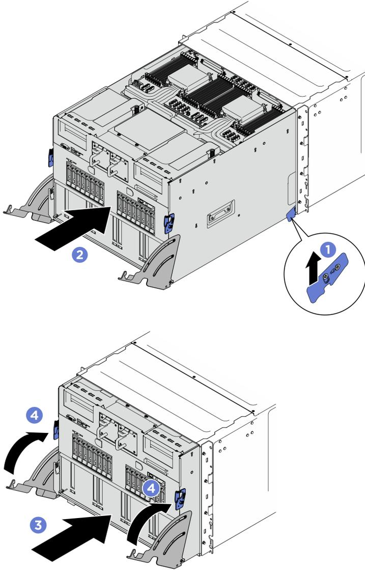
그림 31. 시스템 셔플 설치
