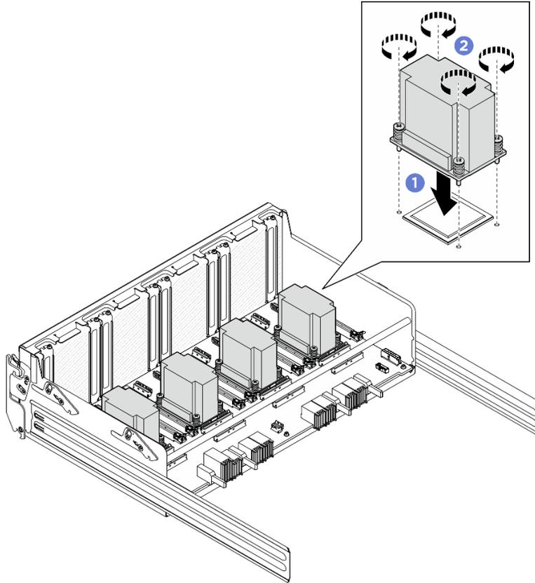
그림 153. PCIe 스위치 보드 방열판 설치
