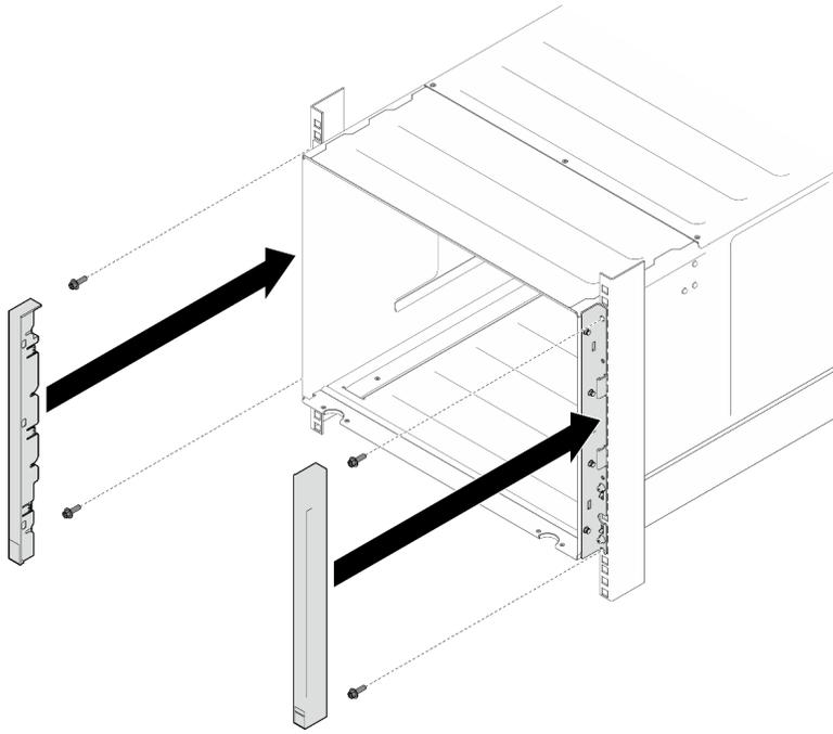
**그림 14. EIA 덮개 설치**
