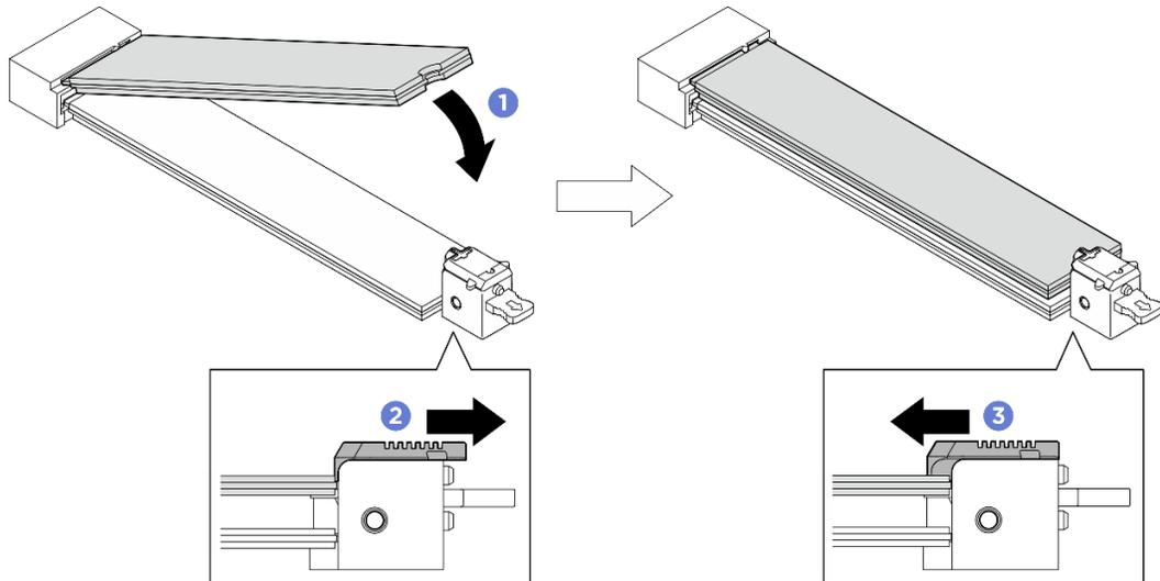
그림 128. 상단 M.2 드라이브 설치
