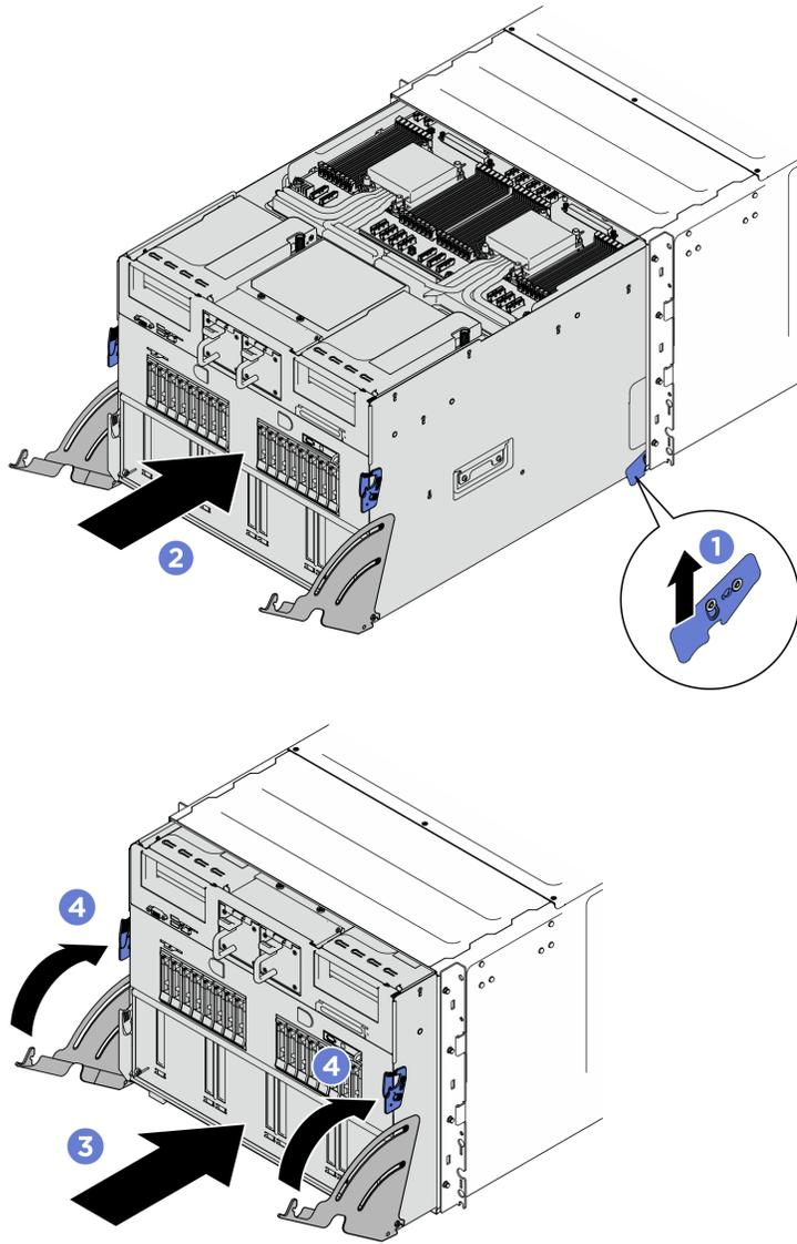
그림 64. 시스템 셔플 설치
