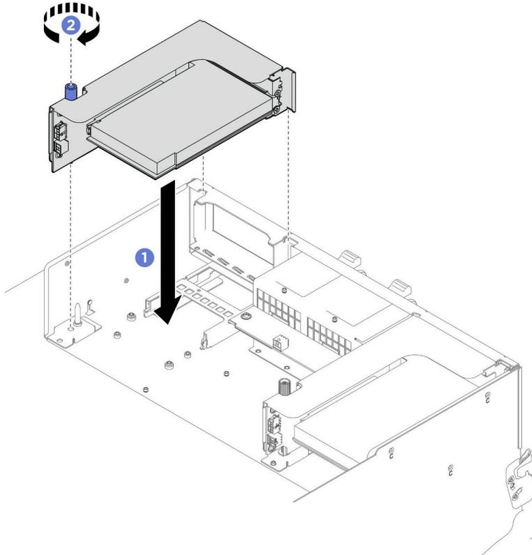
그림 177. PCIe 라이저 어셈블리 설치
