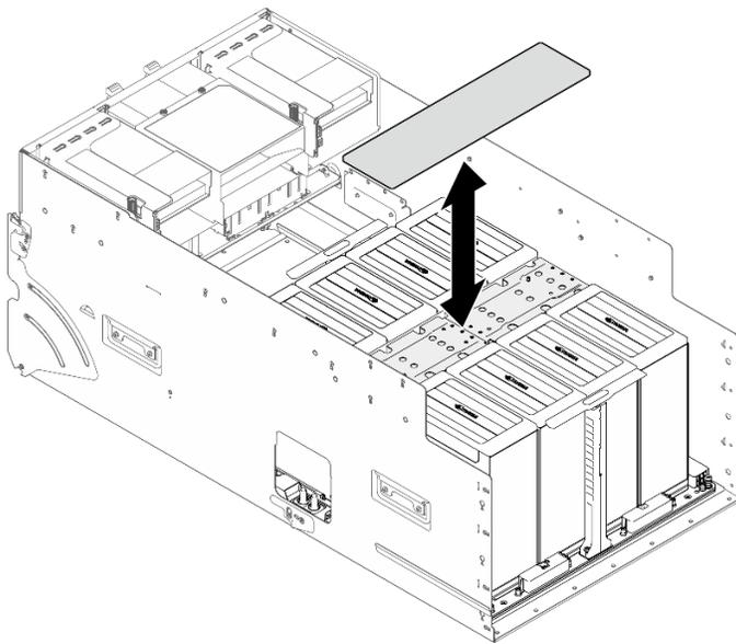
**그림 102. NVSwitch 방열판 덮개 설치**
