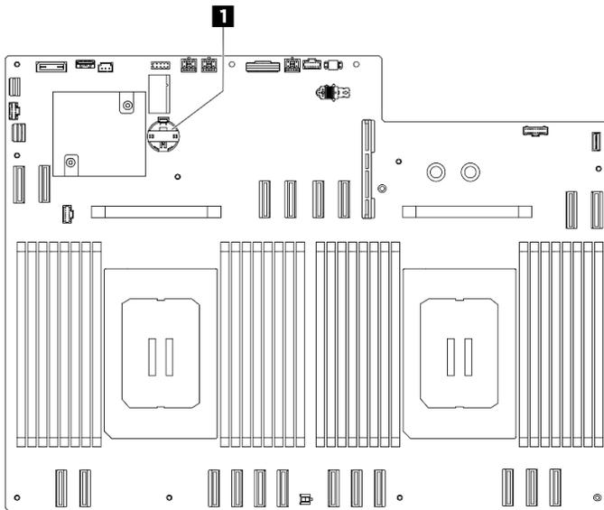
**그림 38. CMOS 배터리 위치**
