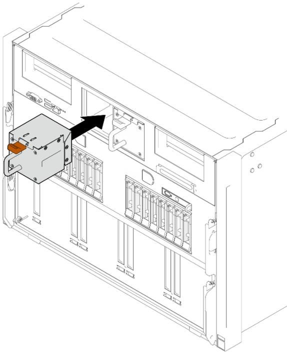
**그림 50. 앞면 팬 설치**
