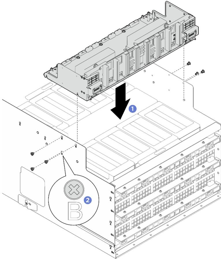
그림 180. 전원 복합체 설치
