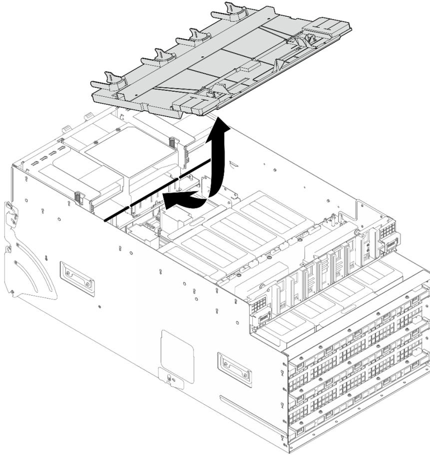
그림 33. 케이블 홀더 프레임 및 배플 어셈블리 설치
