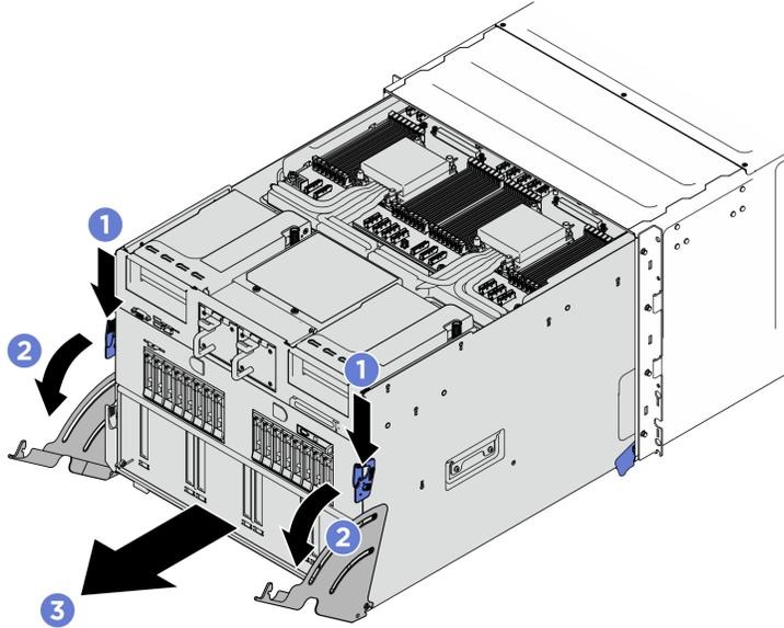
**그림 145. 시스템 서들을 정지 위치로 당기기**
