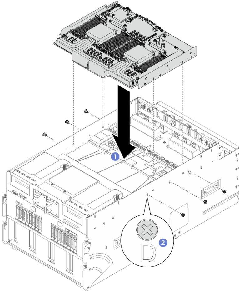
그림 35. 컴퓨팅 트레이 설치
