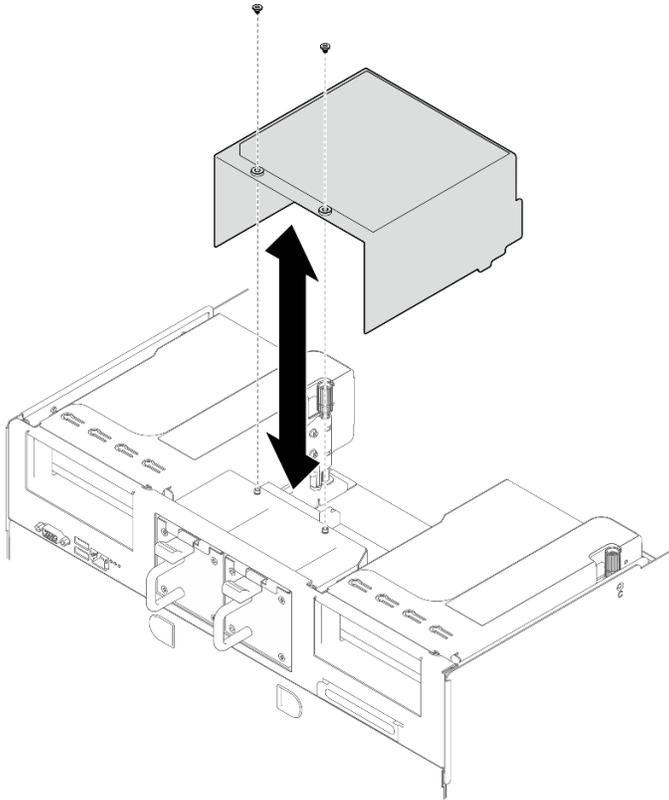
**그림 30. 통풍관 설치**
