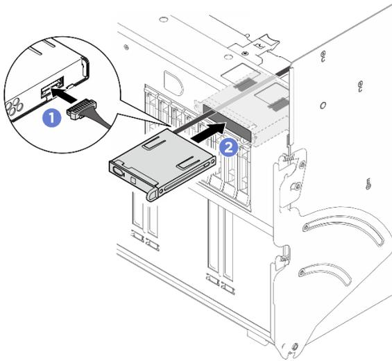
그림 121. 내장형 진단 패널 설치
