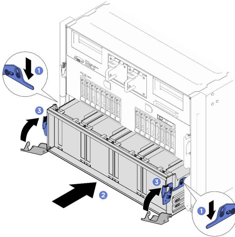
그림 90. PCIe 스위치 셔틀 설치
