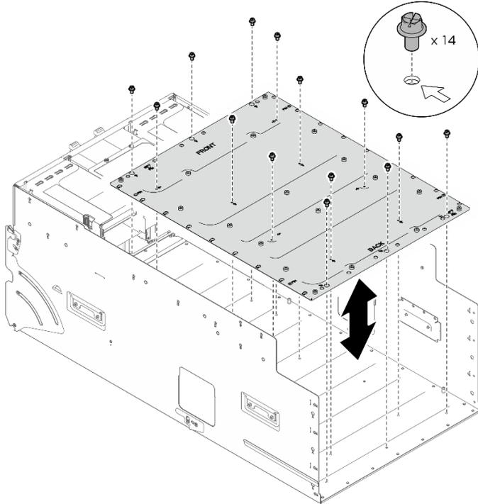
그림 97. GPU 복합체 어댑터판 제거
