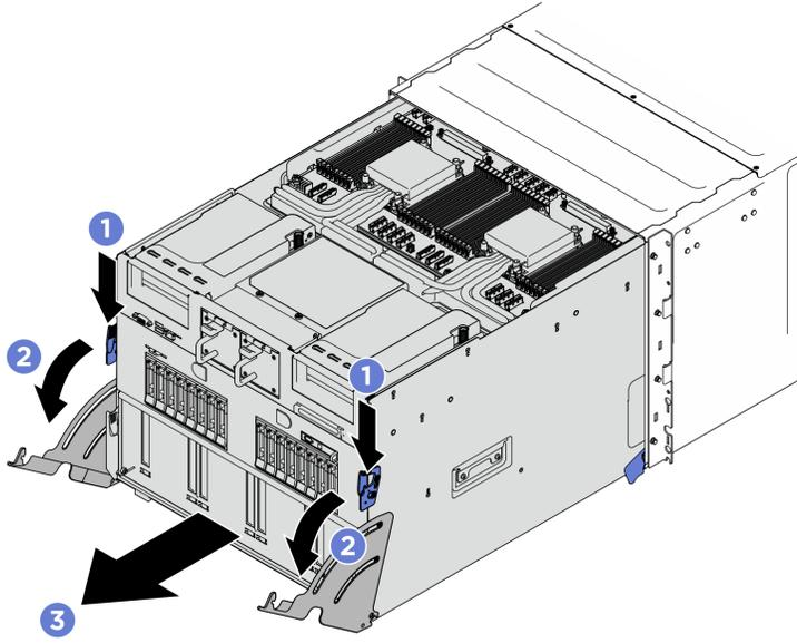
**그림 169. 시스템 셔들을 정지 위치로 당기기**
