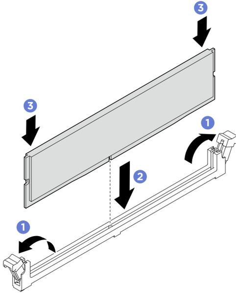
그림 133. 메모리 모듈 설치
