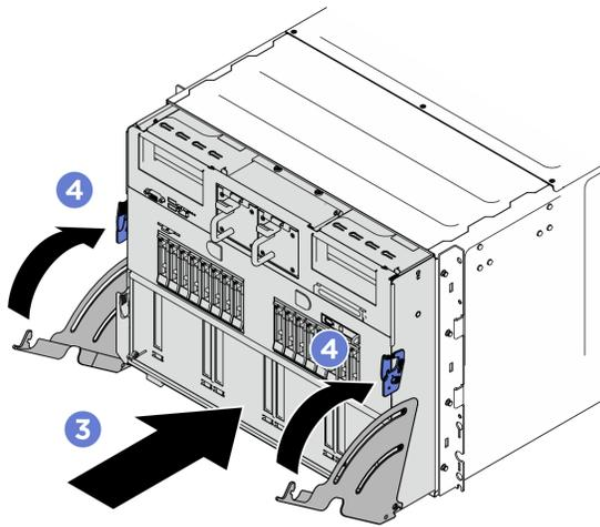
그림 167. 시스템 서플 설치
