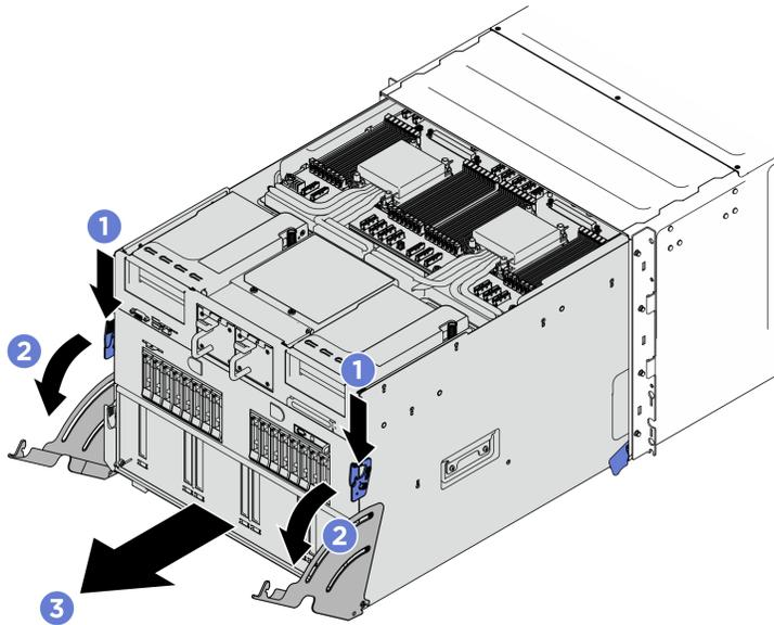
그림 135. 시스템 셔틀을 정지 위치로 당기기
