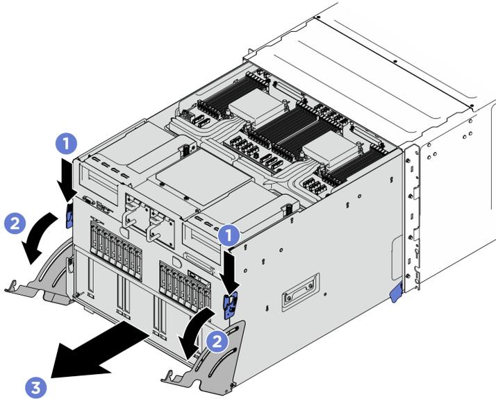
그림 191. 시스템 셔틀을 정지 위치로 당기기
