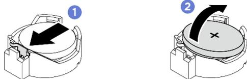
Figura 37. Remoção da bateria CMOS
