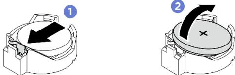
Figura 28. Extracción de la batería CMOS
