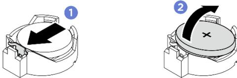
Figura 28. Remoção da bateria CMOS
