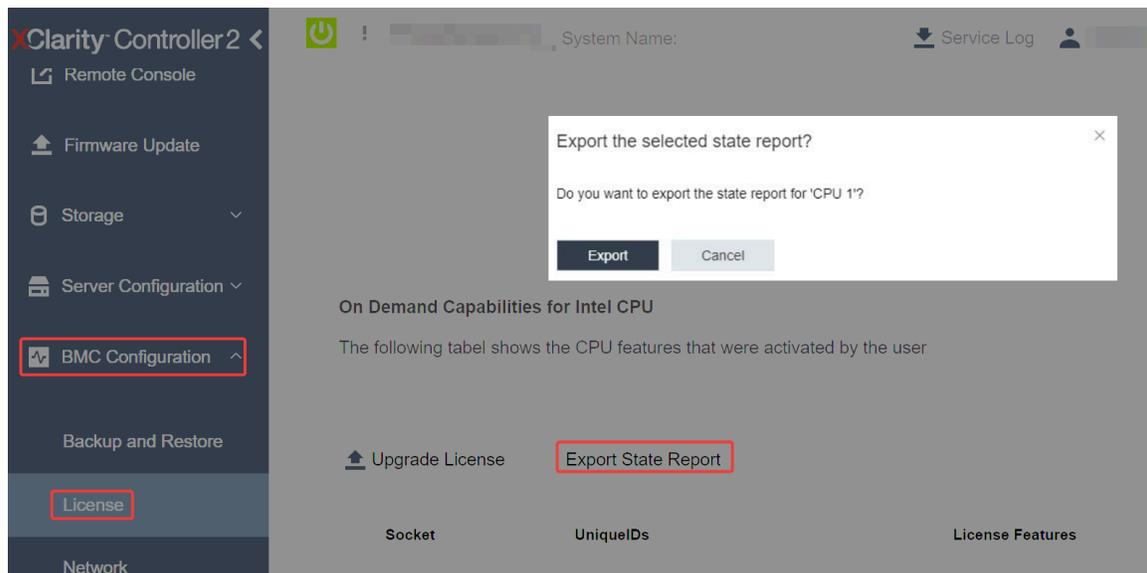
Figura 22. Exportar Relatório de Estado via GUI da Web do XCC
