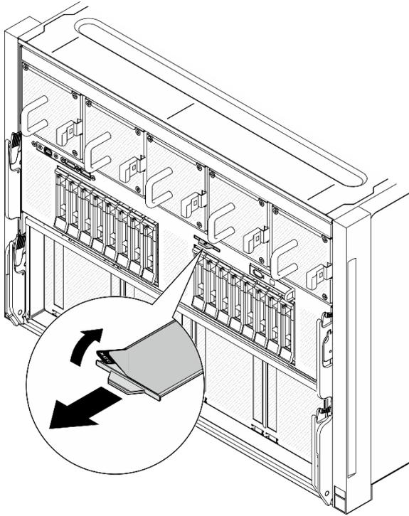
Figura 17. Etiqueta de acesso à rede do Lenovo XClarity Controller na guia de informações removível
