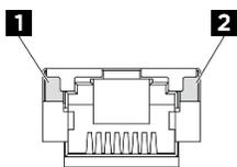
Figura 14. Porta de gerenciamento de sistemas XCC (10/100/1000 Mbps RJ-45) LEDs
