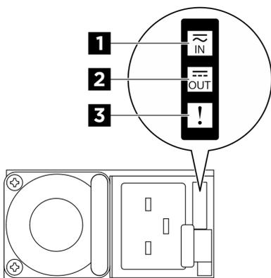
Figura 12. LEDs da fonte de alimentação CFFv4
