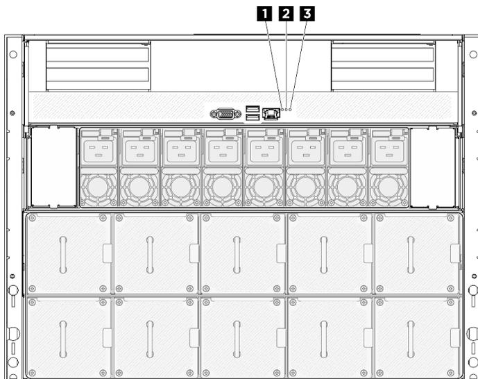
Figura 13. LEDs do sistema na vista traseira
