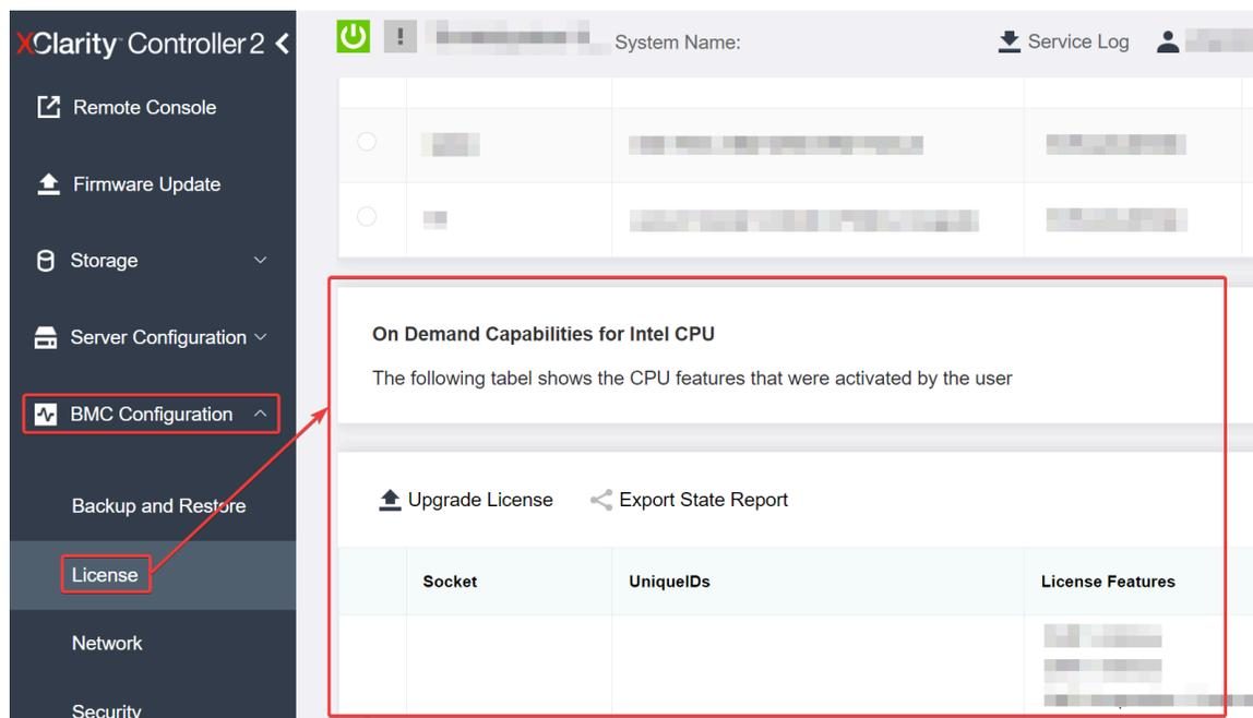
Figura 19. Recursos On Demand para CPU Intel na GUI da Web do XCC
