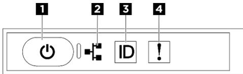
Figura 3. LEDs do painel de diagnóstico integrado
