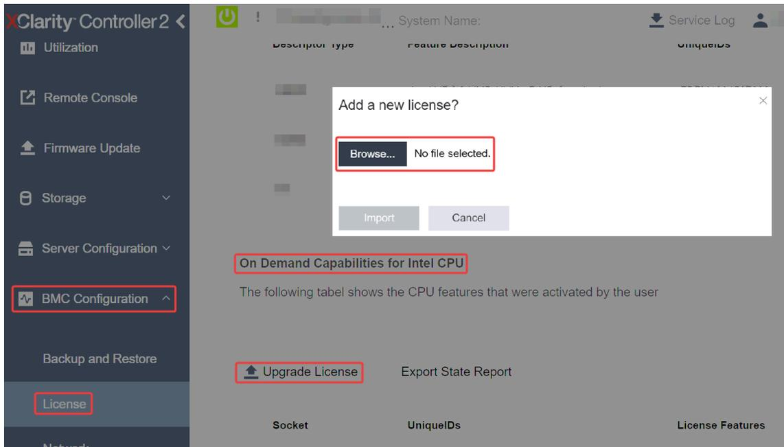
Figura 21. Fazendo upload da chave de ativação via GUI da Web do XCC
