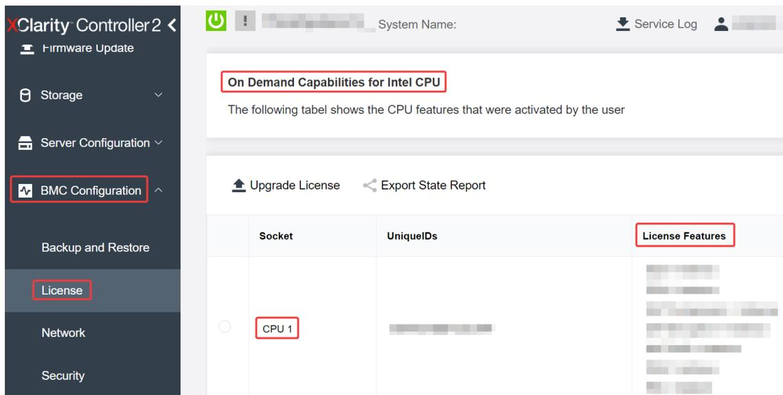
Figura 23. Verificando os recursos do Intel On Demand instalados em um processador na GUI da Web do XCC
