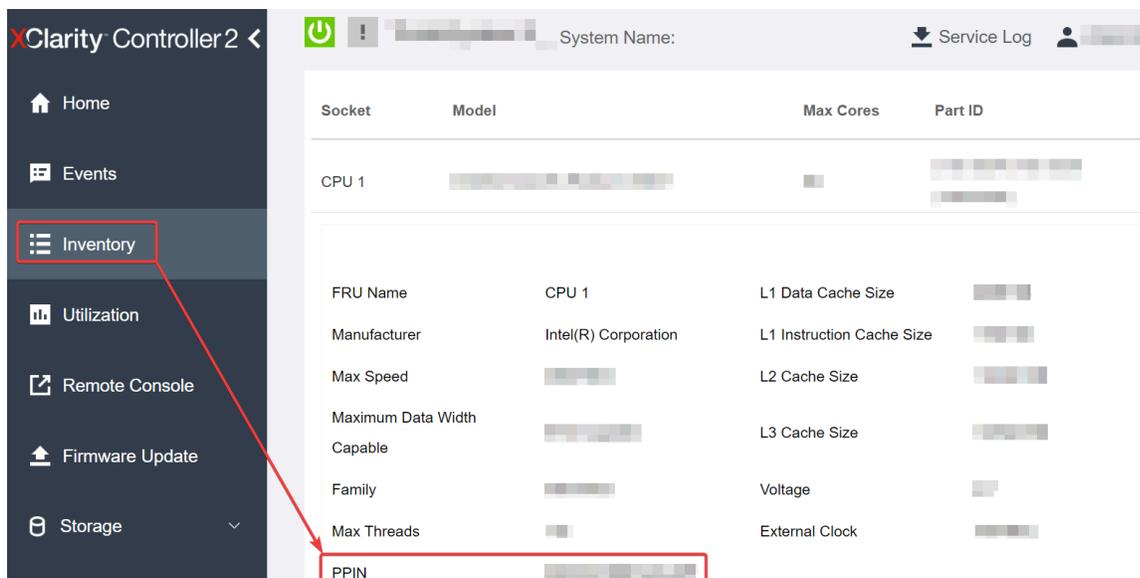
Figura 20. Lendo PPIN via GUI da Web do XCC
