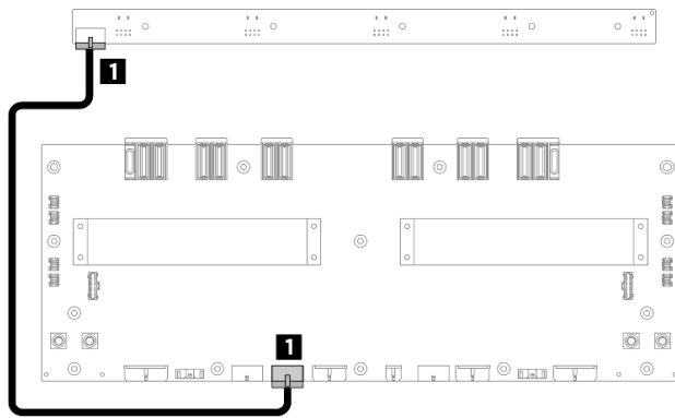
รูปภาพ 195. การเดินสายแผงควบคุมพัดลมด้านหลัง (ส่วนบน)
