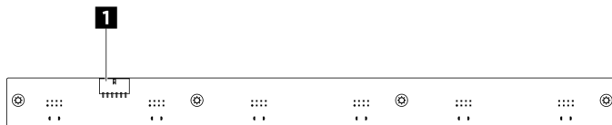
Abbildung 313. Netzteilanschluss der vorderen Lüfterplatine
