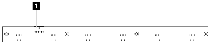
Figura 3. Connettore della scheda di controllo della ventola anteriore
