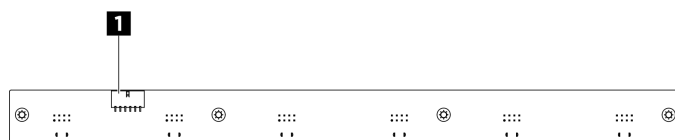
図 298. 前面 ファン制御ボード・コネクタ
