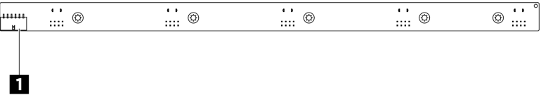
รูปภาพ 4. ขั้วต่อแผงควบคุมพัดลมด้านหลัง
