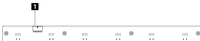
รูปภาพ 3. ขั้วต่อแผงควบคุมพัดลมด้านหน้า
