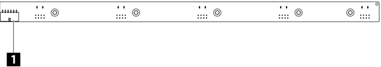
รูปภาพ 314. ขั้วต่อแผงควบคุมพัดลมด้านหลัง
