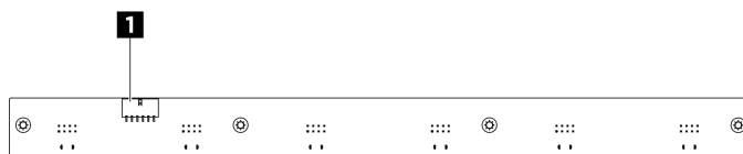
รูปภาพ 313. ขั้วต่อแผงควบคุมพัดลมด้านหน้า
