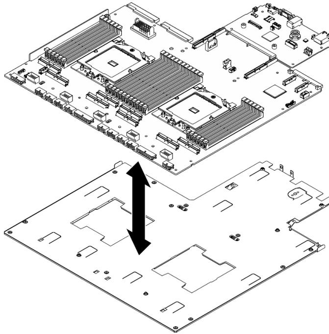
圖例 207. 拆卸主機板組件
