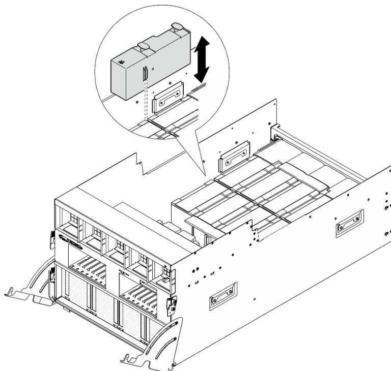
圖例 53. 卸下 GPU 空氣導管
