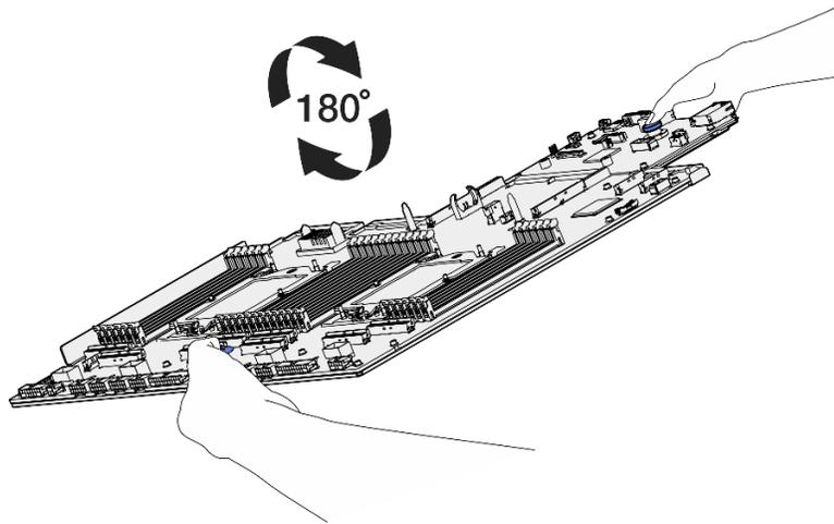
圖例 203. 將主機板組件上下倒置
