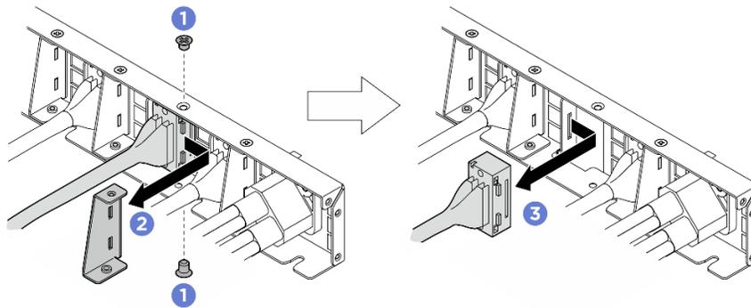
圖例 159. 卸下正面 I/O 模組、整合式診斷面板、GPU 管理或信號線
