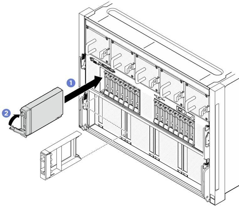
圖例 20. 安裝 2.5 吋熱抽換硬碟
