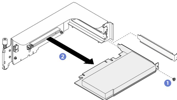
圖例 130. 卸下背面 PCIe 配接卡
