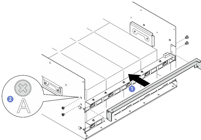
圖例 78. 安裝後支撐托架
