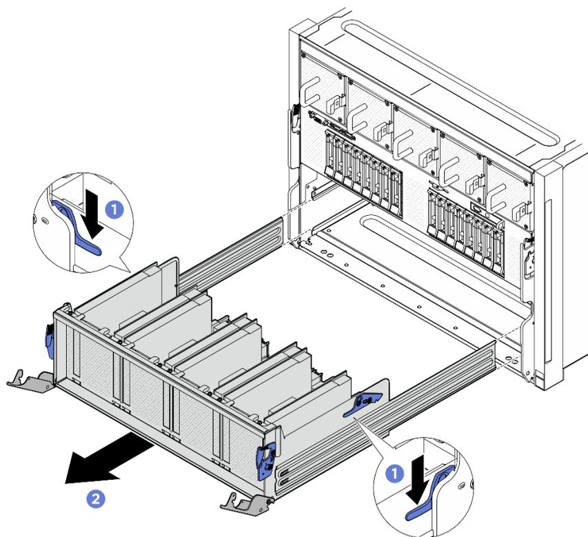
圖例 165. 將 PCIe 交換器滑動箱從 8U GPU 滑動箱卸下
