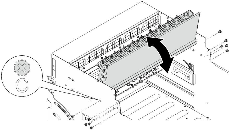
圖例 81. 翻轉前方 PCIe 交換器纜線載具
