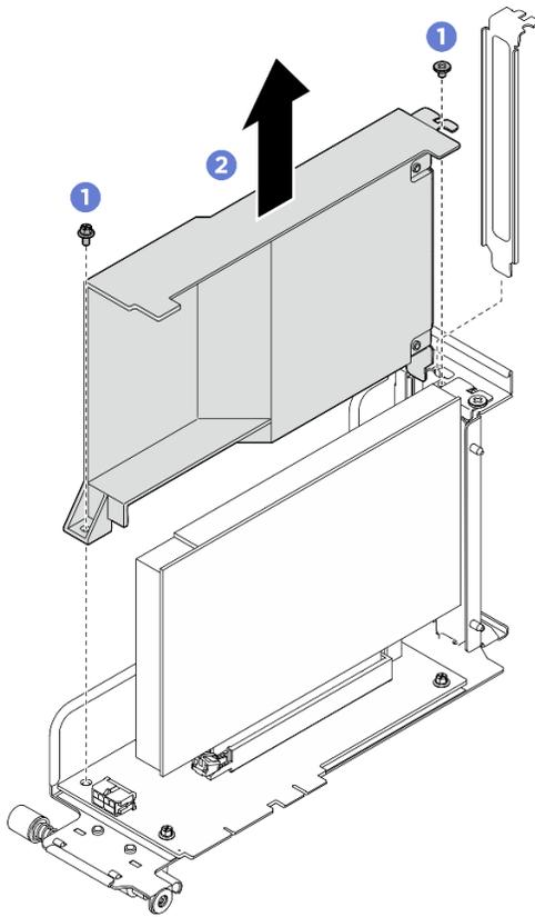
圖例 132. 卸下 PCIe 擴充卡空氣擋板
