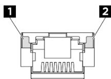
圖例 253. XCC 系統管理埠 (10/100/1000 Mbps RJ-45) LED
