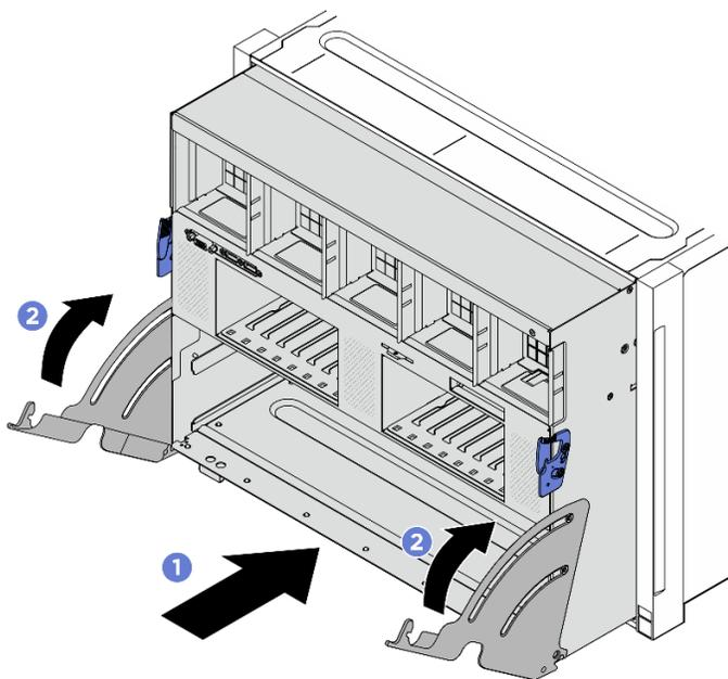
圖例 29. 安裝 8U GPU 滑動箱
