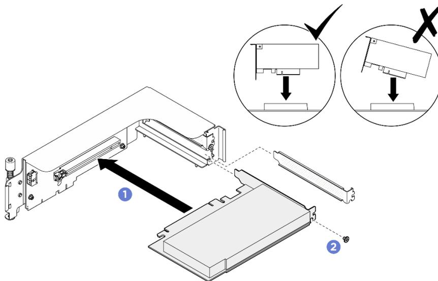
圖例 131. 安裝背面 PCIe 配接卡
