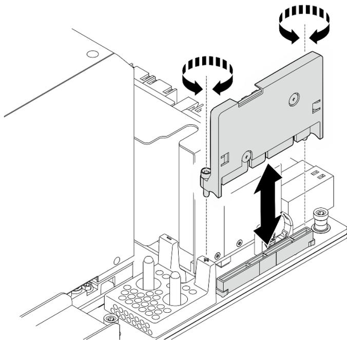
圖例 103. 卸下 HMC 卡
