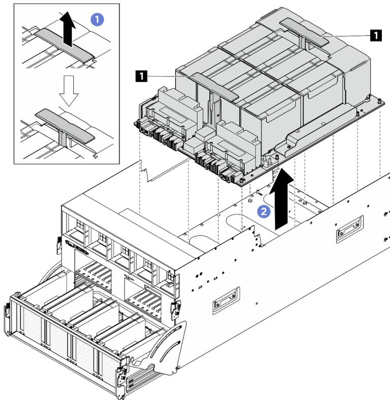
圖例 72. 卸下 GPU 複合體
