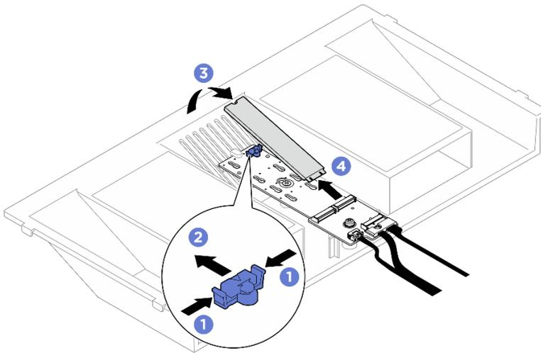
圖例 109. 卸下 M.2 硬碟
