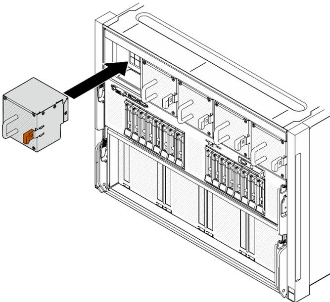
圖例 39. 安裝熱抽換風扇
