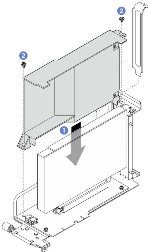
圖例 133. 安裝 PCIe 擴充卡空氣擋板
