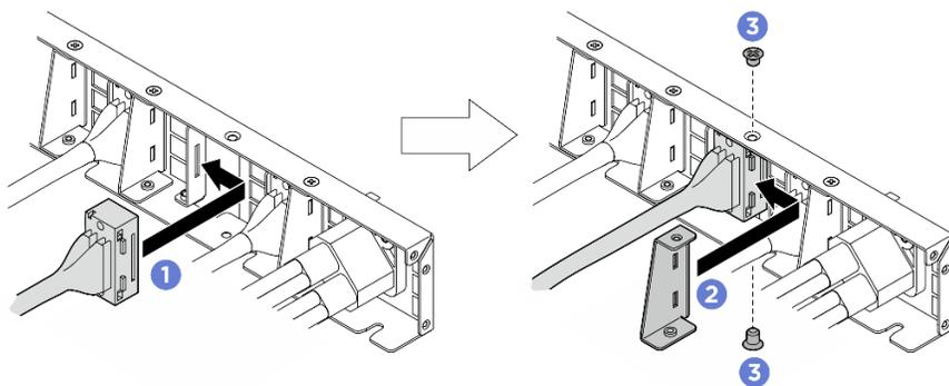
圖例 161. 安裝正面 I/O 模組、整合式診斷面板、GPU 管理或信號線
