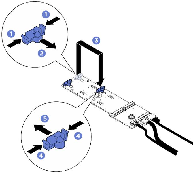
圖例 115. M.2 背板固定器調整
