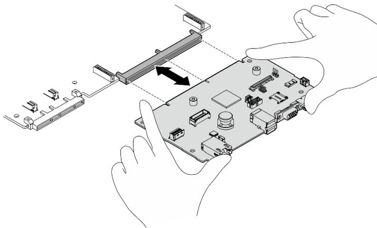
圖例 209. 安裝系統 I/O 板
