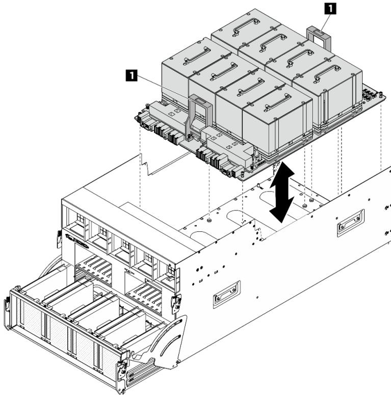
圖例 83. 卸下 GPU 複合體
