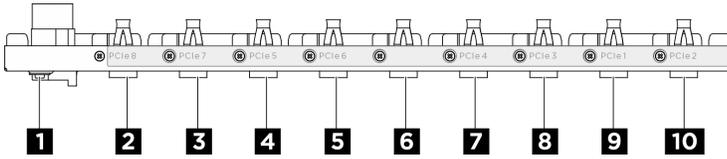
圖例 224. 後方 PCIe 交換器纜線載具纜線
