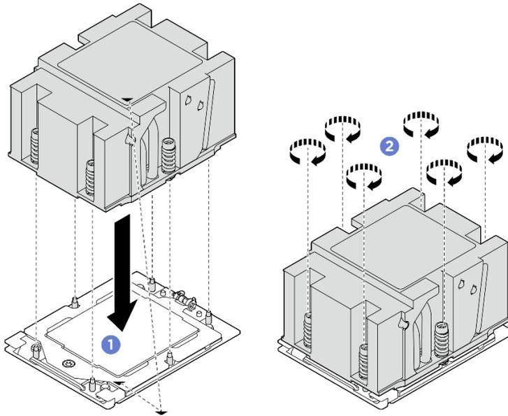
圖例 188. 安裝散熱槽
