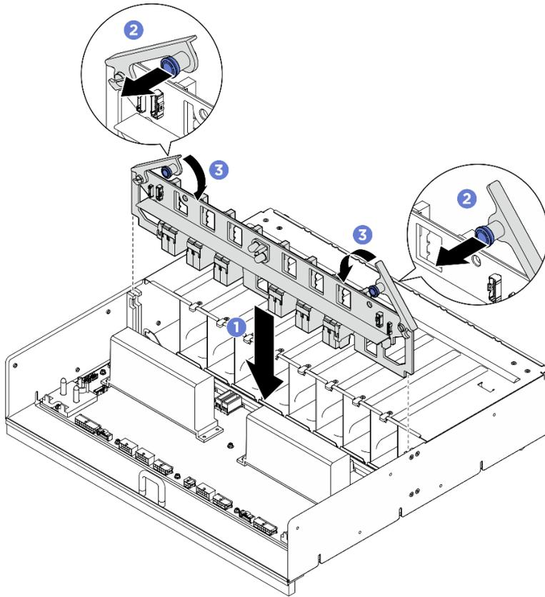
圖例 194. 安裝 PSU 轉插卡
