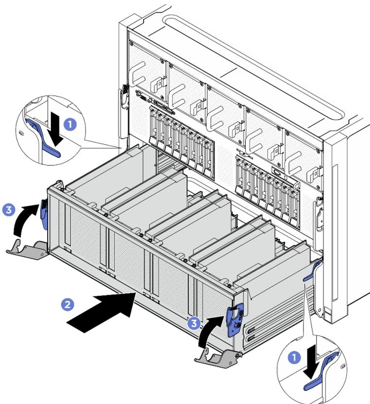
圖例 94. 將 PCIe 交換器滑動箱安裝到 8U GPU 滑動箱中
