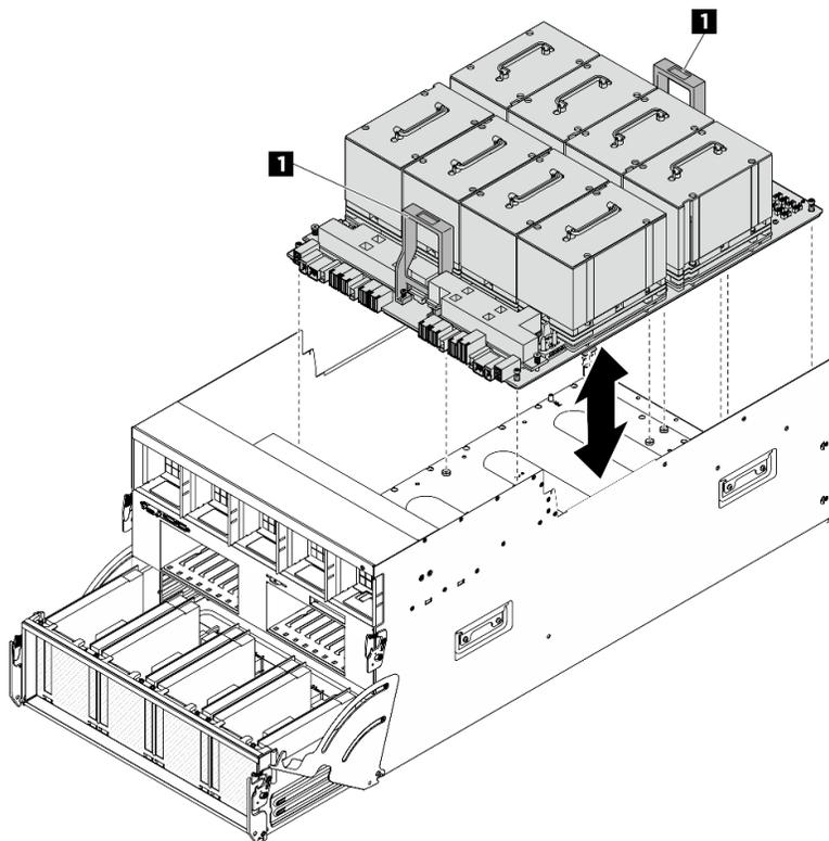
圖例 84. 安裝 GPU 複合體
