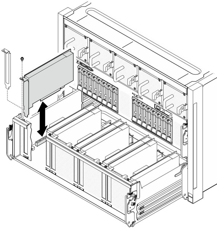
圖例 128. 安裝正面 PCIe 配接卡
