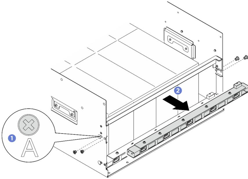
圖例 45. 卸下後方風扇控制板組件
