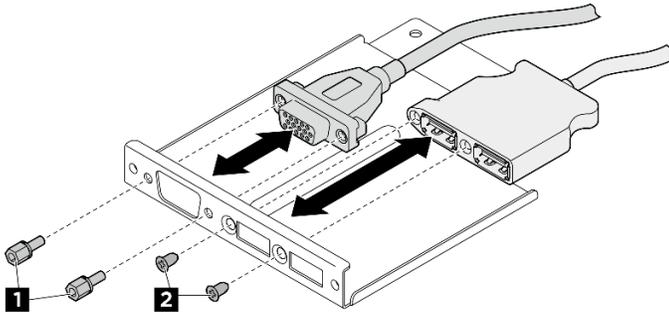
圖例 148. 卸下正面 I/O 模組纜線
