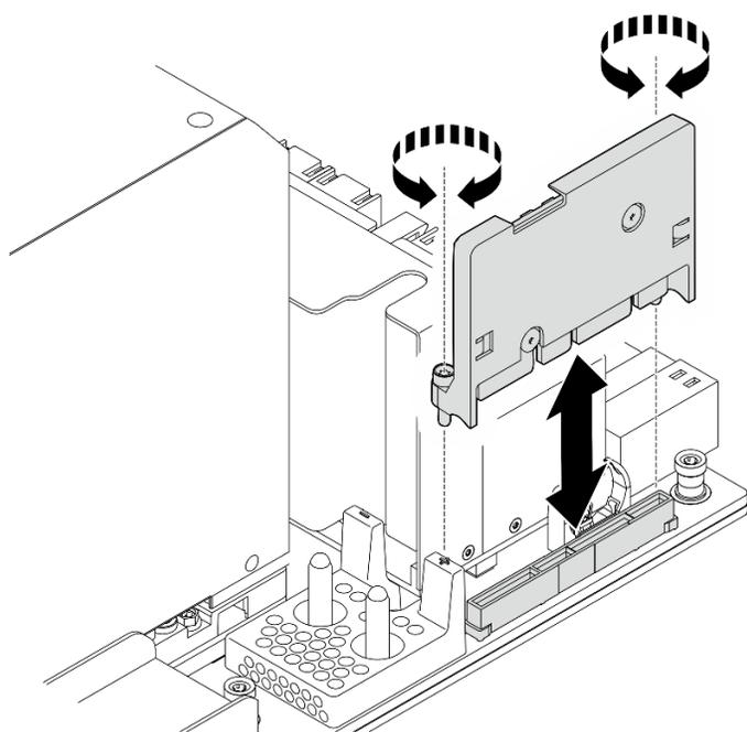
圖例 104. 安裝 HMC 卡
