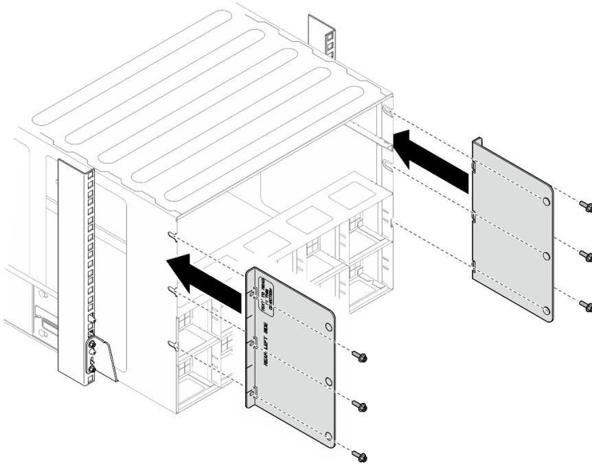
圖例 16. 安裝上支撐托架
