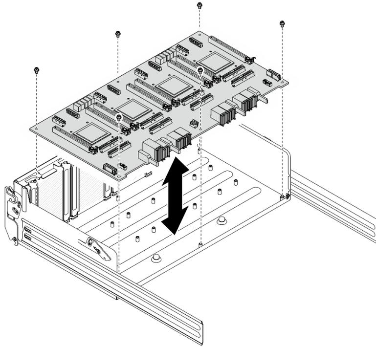
圖例 144. 安裝 PCIe 交換器板
