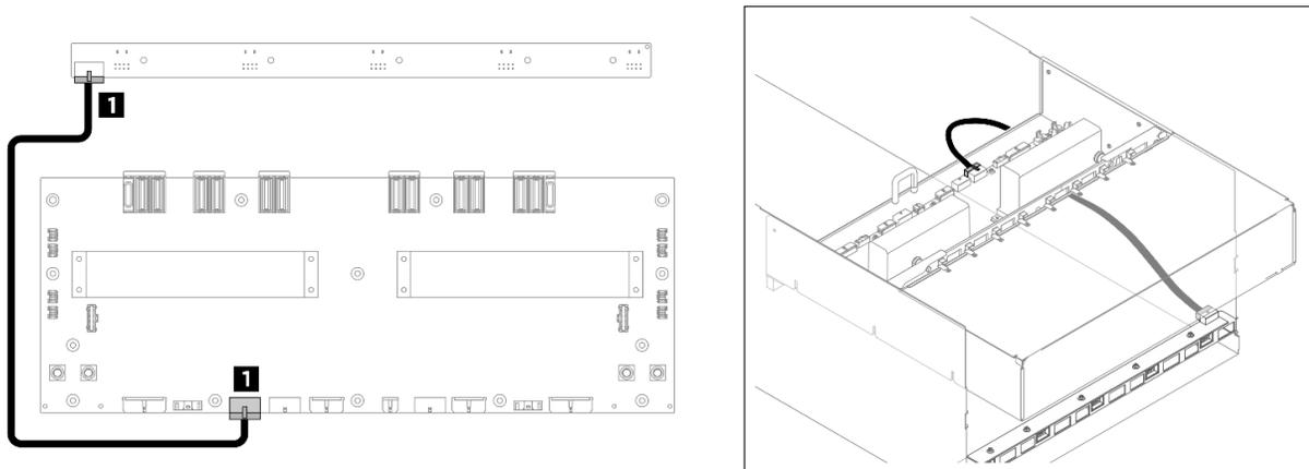
圖例 235. 後方風扇控制板 (下) 纜線佈線
