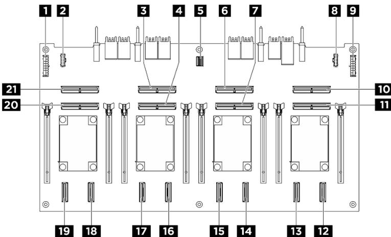
圖例 222. PCIe 交換器板接頭
