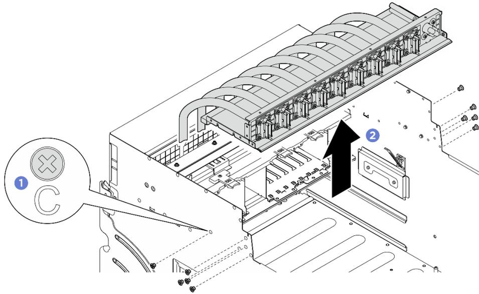
圖例 149. 卸下前方 PCIe 交換器纜線載具
