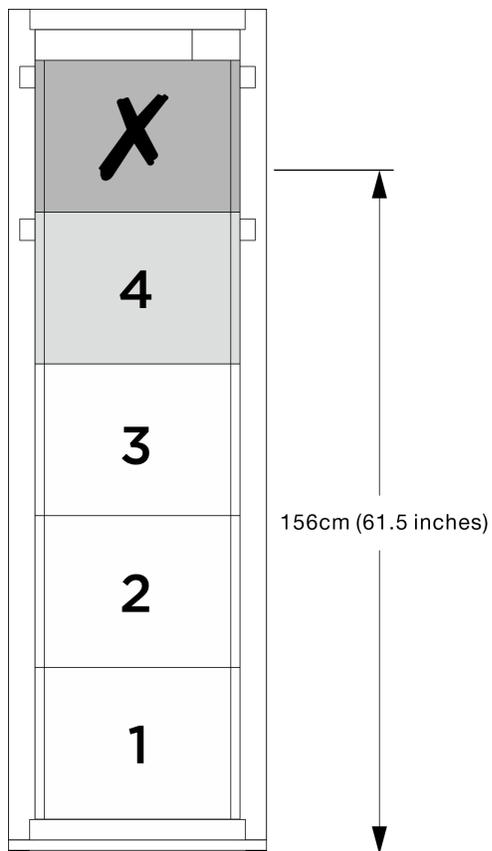
圖例 9. 最大安裝高度
