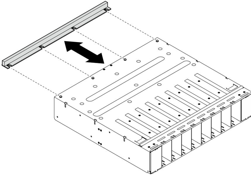
圖例 52. 安裝 GPU 空氣擋板
