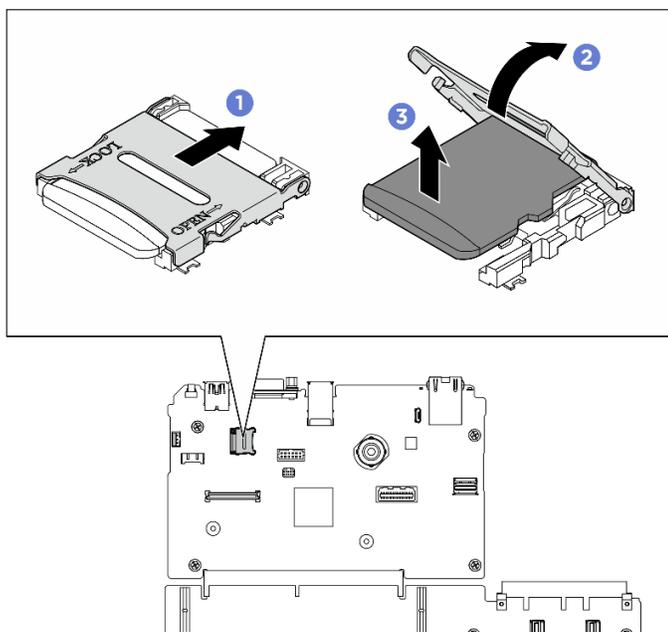
圖例 122. 卸下 MicroSD 卡
