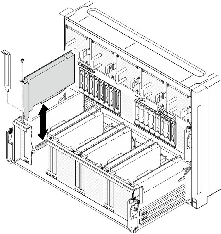
圖例 127. 卸下正面 PCIe 配接卡
