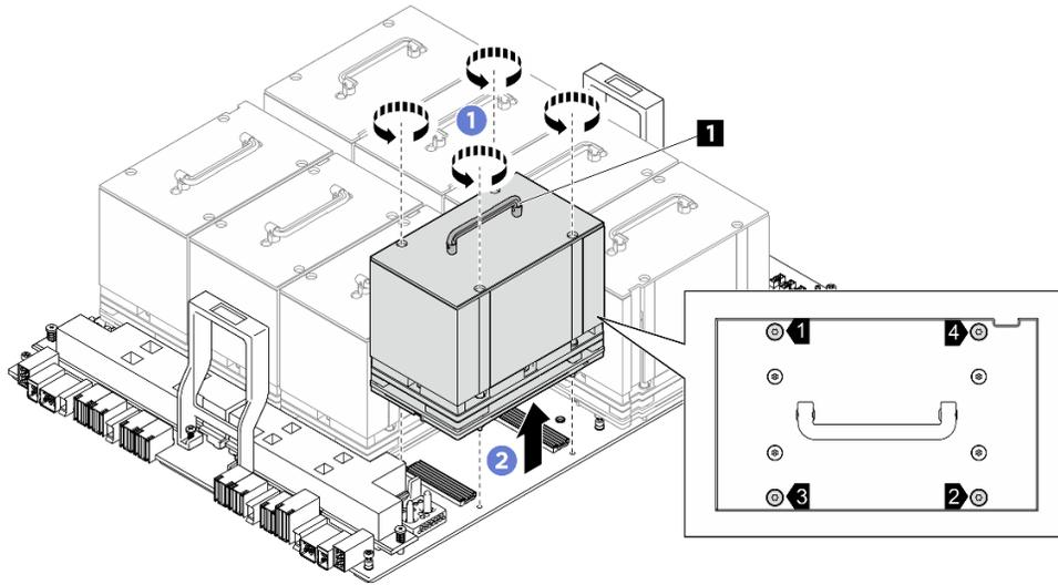
圖例 101. 卸下 GPU 和散熱槽模組
