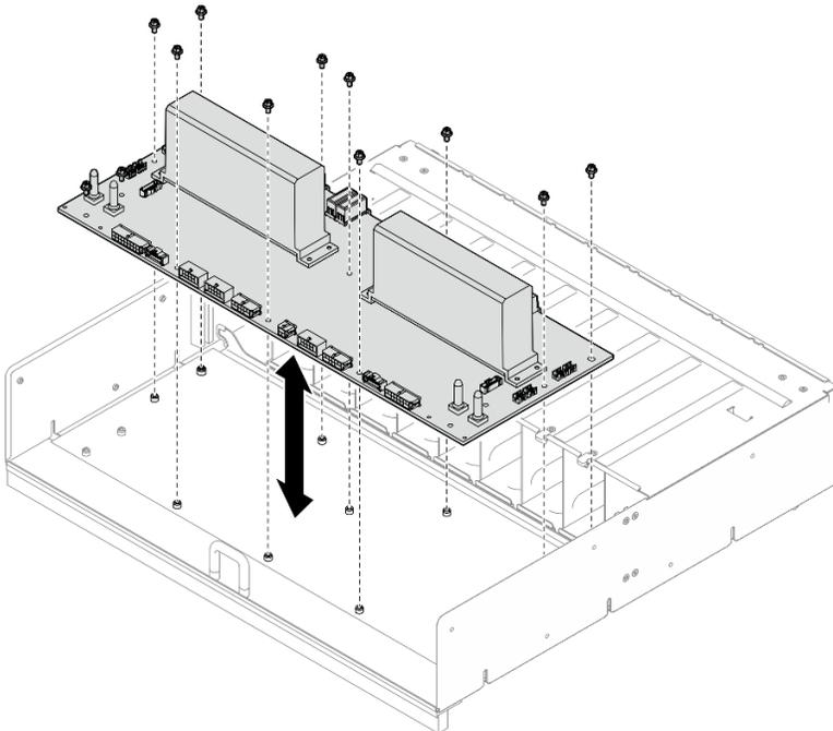
圖例 171. 卸下電源配送板
