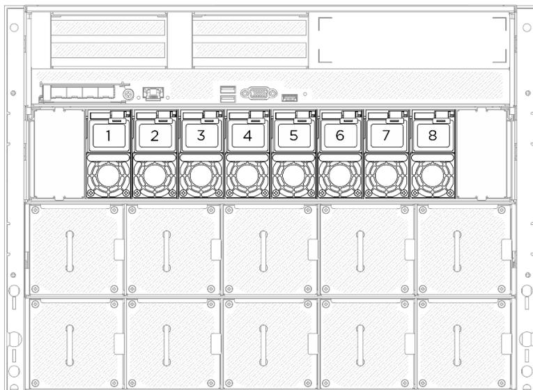
圖例 178. 電源供應器機槽編號
