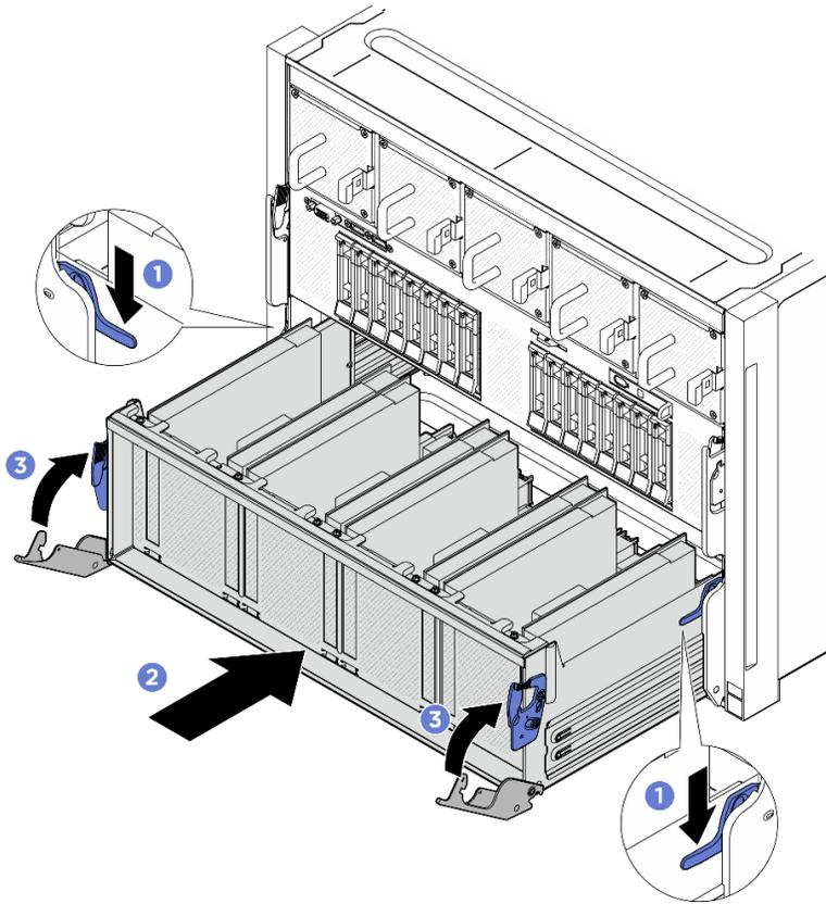
圖例 167. 將 PCIe 交換器滑動箱安裝到 8U GPU 滑動箱中
