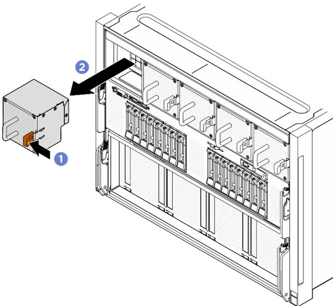
圖例 36. 熱抽換風扇卸下
