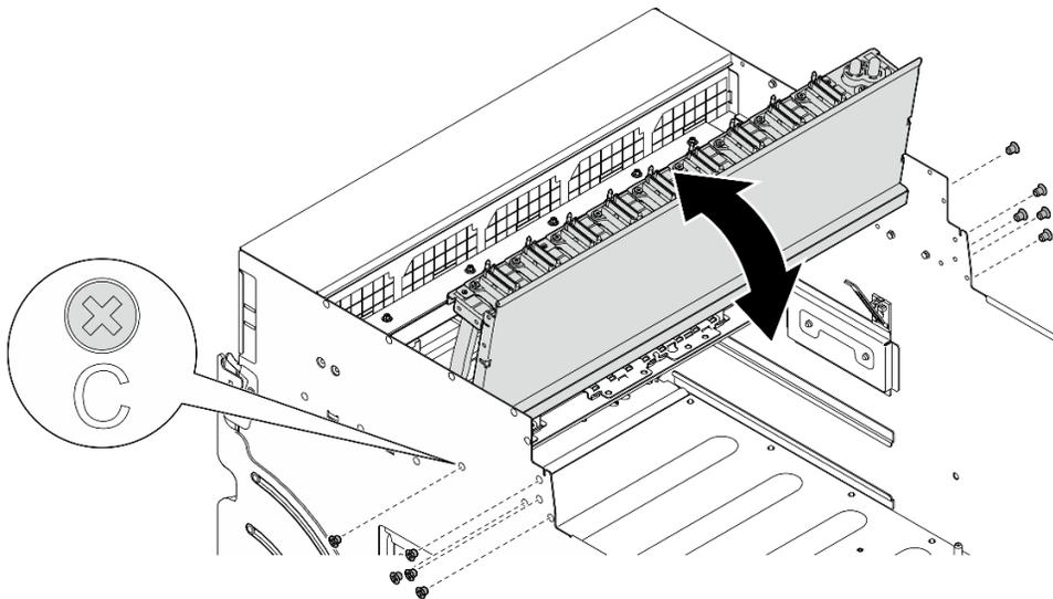
圖例 70. 翻轉前方 PCIe 交換器纜線載具
