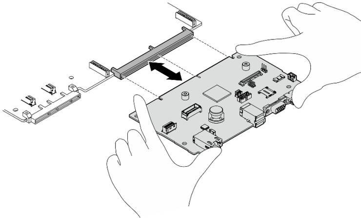
圖例 208. 卸下系統 I/O 板
