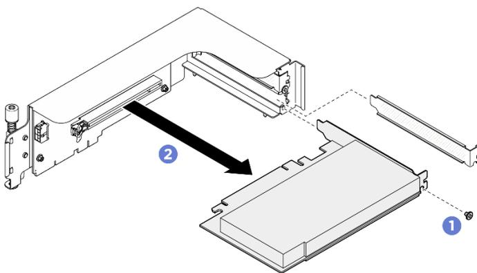
圖例 137. 卸下背面 PCIe 配接卡
