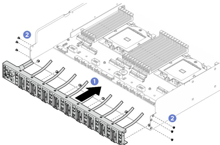
圖例 163. 安裝後方 PCIe 交換器纜線載具
