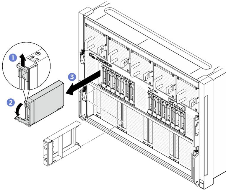
圖例 18. 卸下 2.5 吋熱抽換硬碟
