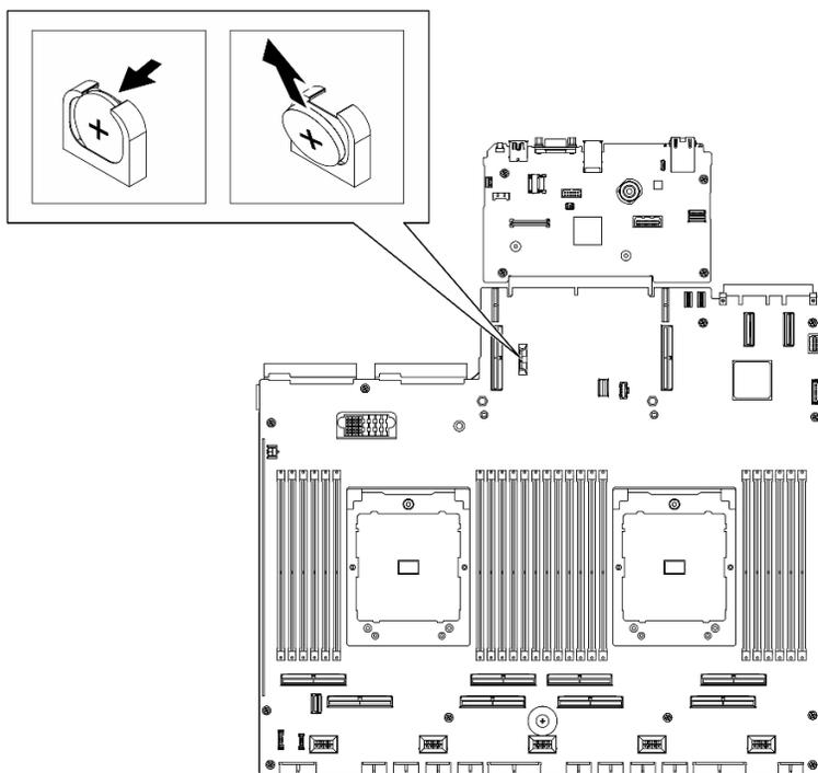
圖例 32. 卸下 CMOS 電池
