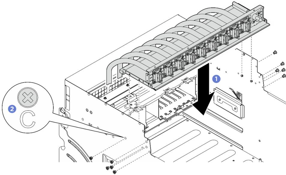
圖例 155. 安裝前方 PCIe 交換器纜線載具
