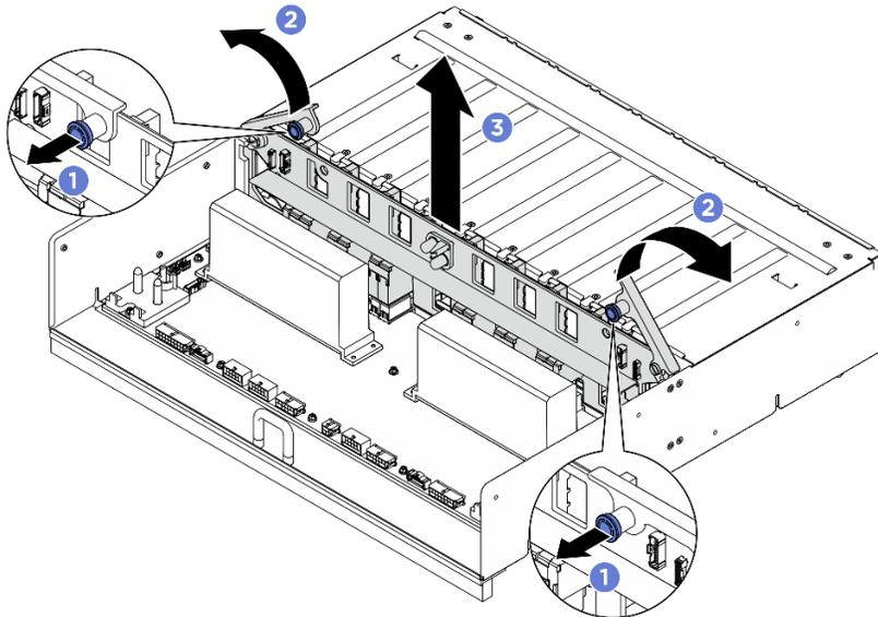
圖例 195. 卸下 PSU 轉插卡
