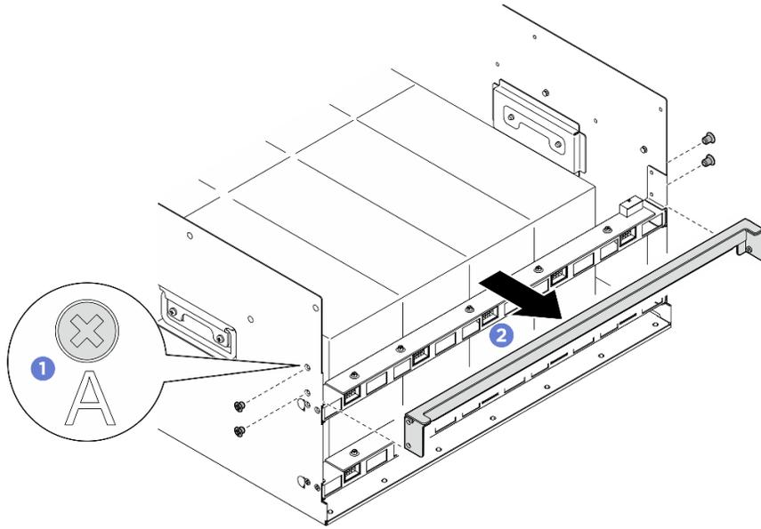
圖例 88. 卸下後支撐托架
