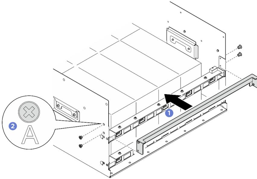
圖例 95. 安裝後支撐托架
