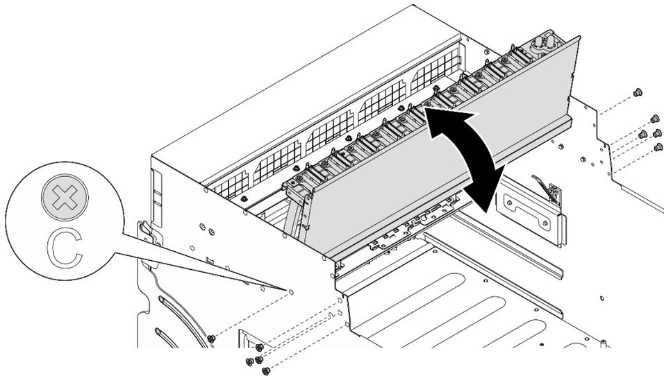
圖例 65. 翻轉前方 PCIe 交換器纜線載具
