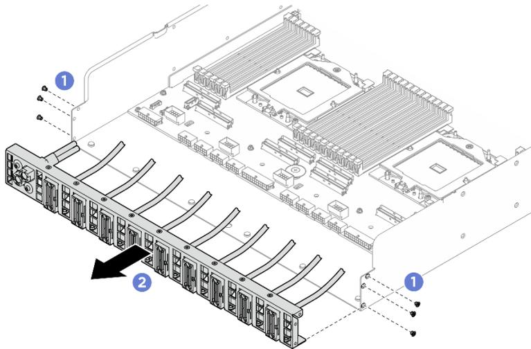
圖例 158. 卸下後方 PCIe 交換器纜線載具
