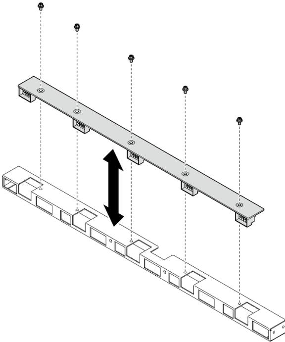
圖例 46. 卸下後方風扇控制板
