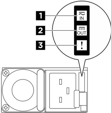
圖例 251. CFFv4 電源供應器 LED
