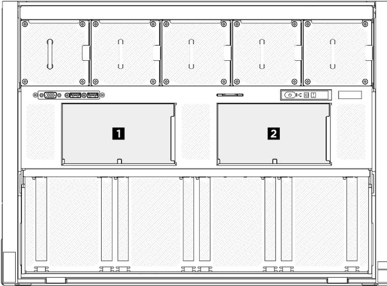
圖例 23. 2.5 吋硬碟背板編號
