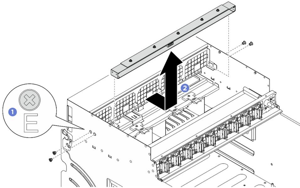
圖例 40. 卸下前方風扇控制板組件
