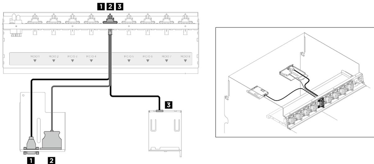
圖例 238. 正面 I/O 模組和整合式診斷面板纜線佈線
