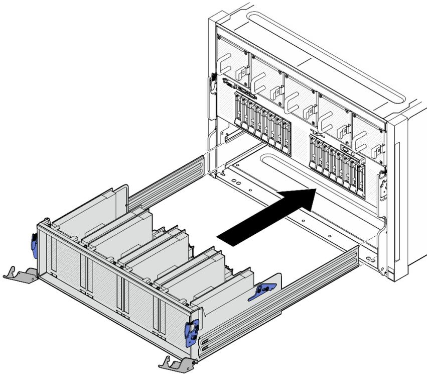
圖例 166. 將 PCIe 交換器滑動箱安裝到停止位置
