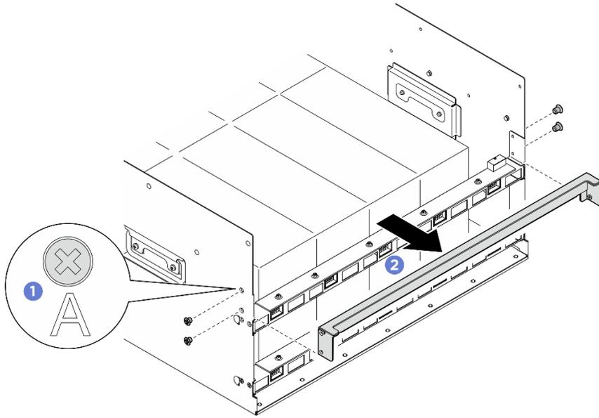
圖例 57. 卸下後支撐托架
