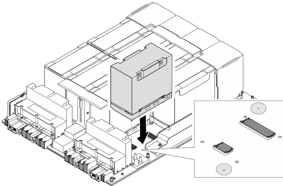
圖例 98. 安裝 GPU 和散熱槽模組
