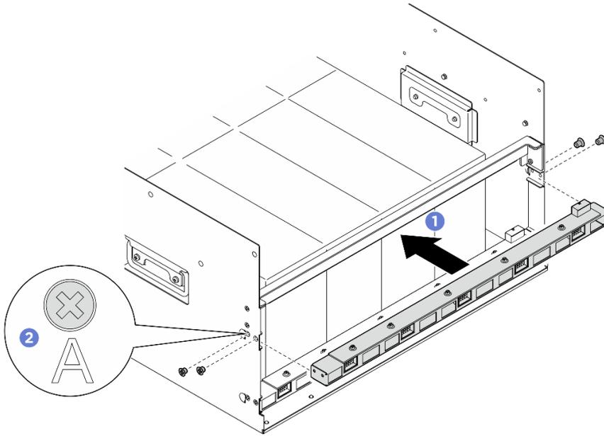
圖例 48. 安裝後方風扇控制板組件
