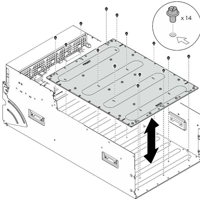
圖例 91. 卸下 GPU 複合體配接器板
