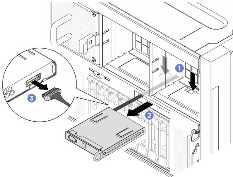
圖例 105. 卸下整合式診斷面板
