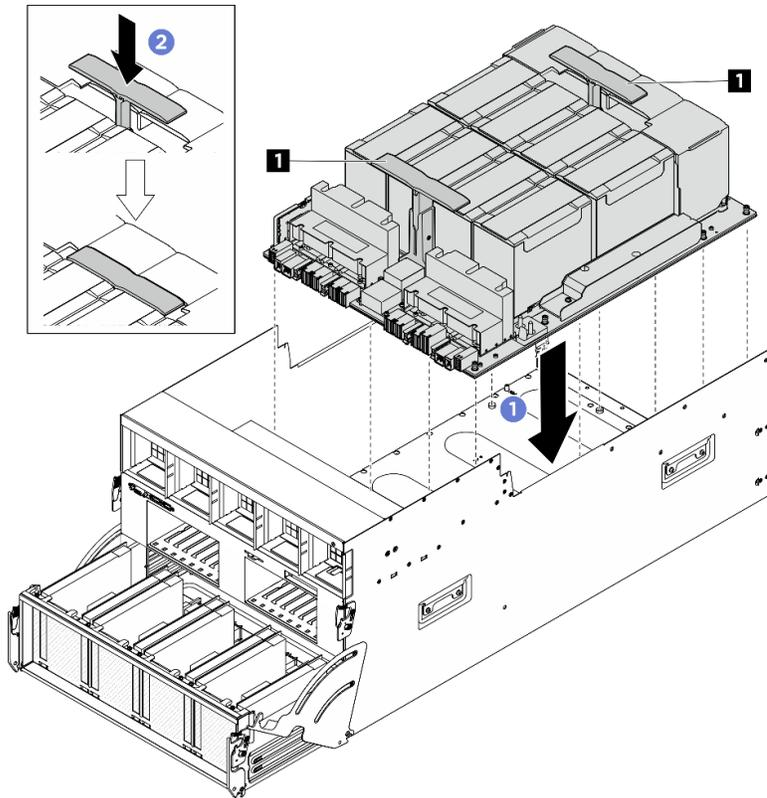
圖例 74. 安裝 GPU 複合體
