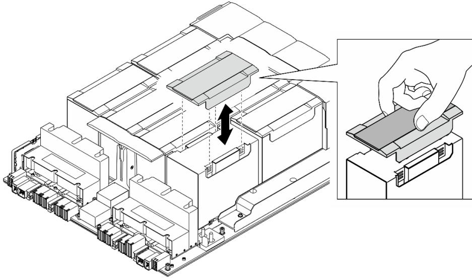
步驟 2. 用雙手抓住 GPU 和散熱槽模組；然後，將 GPU 和散熱槽模組對齊 GPU 基板上的兩個導孔，並輕輕地將其放在 GPU 基板上。
