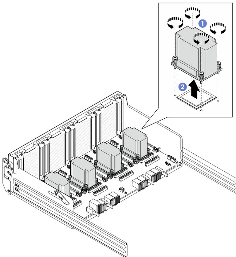
圖例 142. 卸下 PCIe 交換器板散熱槽
