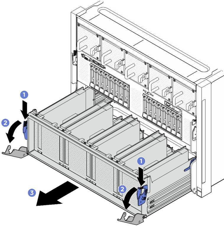
圖例 80. 將 PCIe 交換器滑動箱拉動到停止位置
