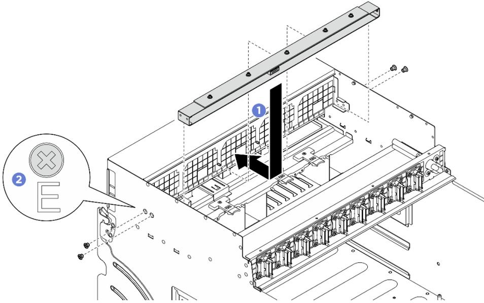
圖例 43. 安裝前方風扇控制板組件
