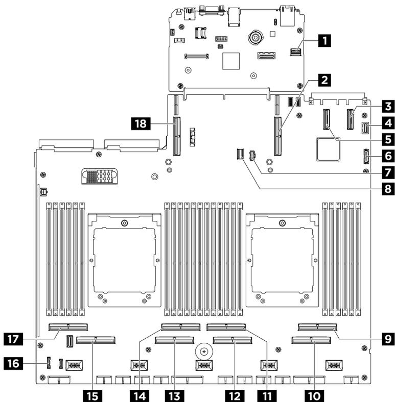
圖例 228. 用於纜線佈線的主機板組件接頭
