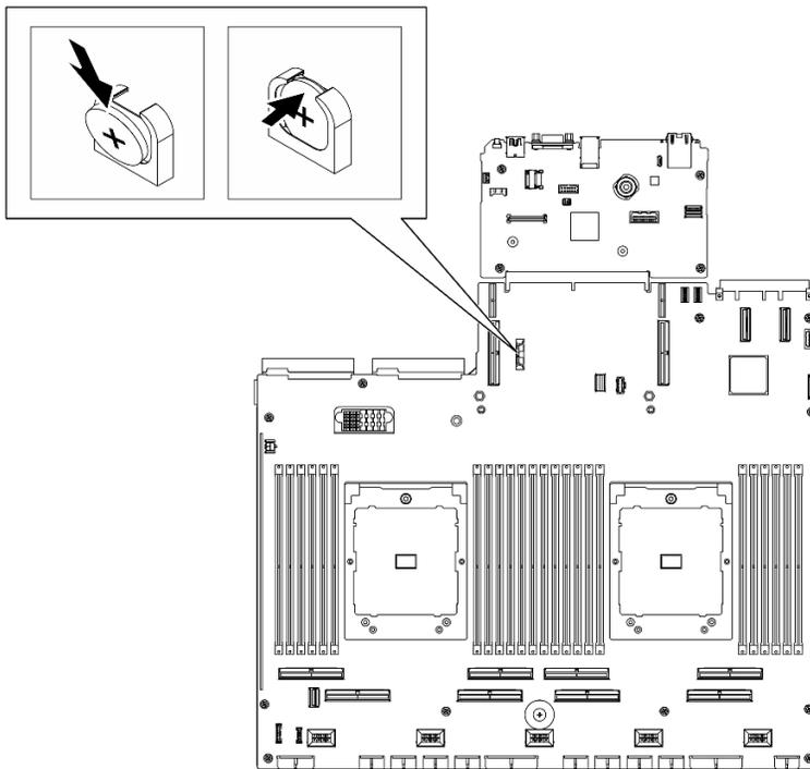
圖例 33. CMOS 電池安裝
