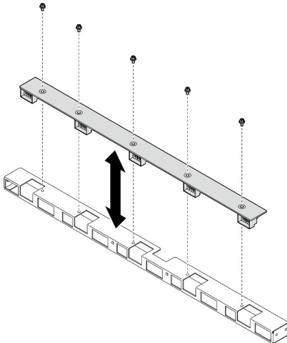
圖例 47. 安裝後方風扇控制板
