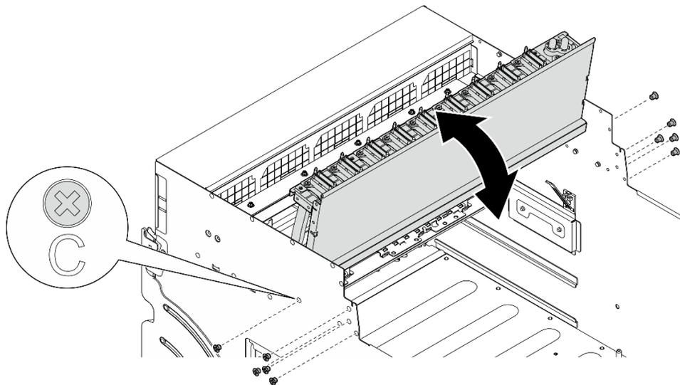
圖例 86. 翻轉前方 PCIe 交換器纜線載具
