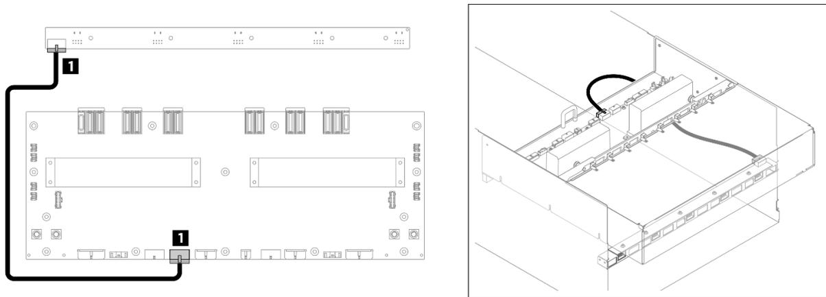
圖例 234. 後方風扇控制板 (上) 纜線佈線
