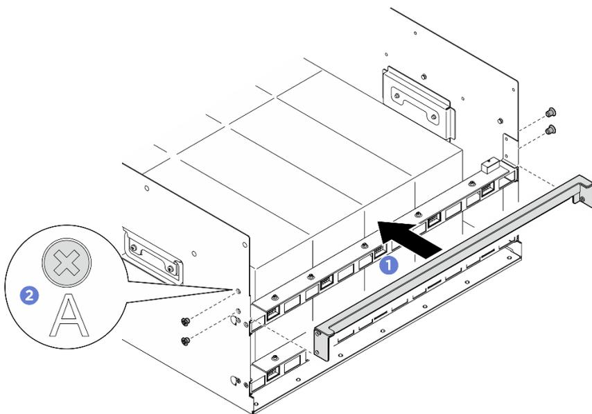
圖例 87. 安裝後支撐托架
