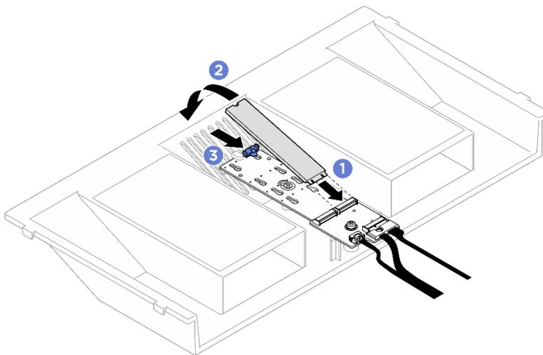
圖例 117. M.2 硬碟安裝
