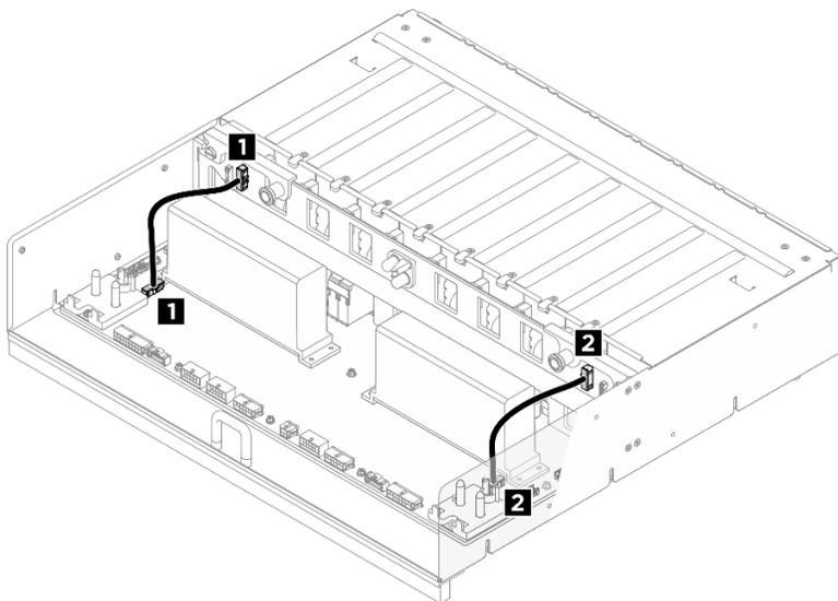
圖例 246. PSU 轉插卡纜線佈線
