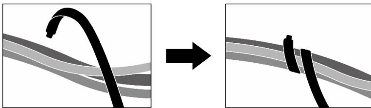
圖例 231. 使用纜線束帶固定纜線
