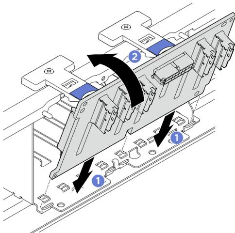
圖例 24. 2.5 吋硬碟背板安裝
