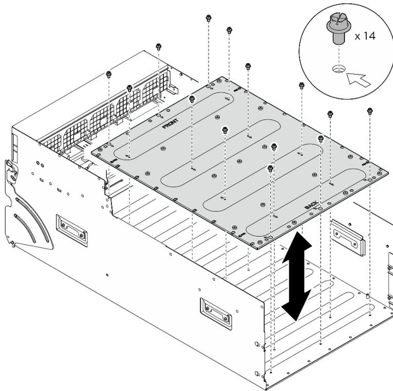
圖例 92. 安裝 GPU 複合體配接器板
