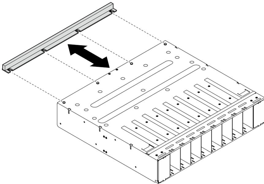
圖例 51. 卸下 GPU 空氣擋板
