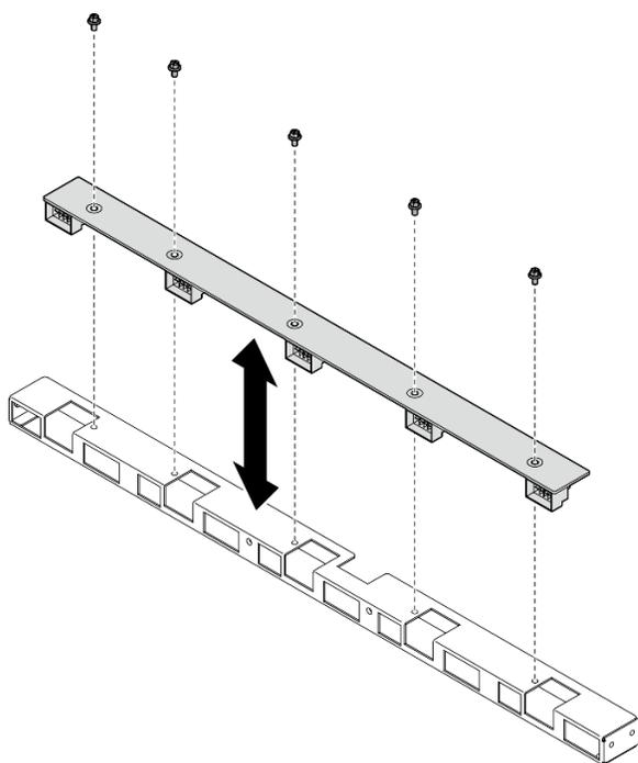
圖例 42. 安裝前方風扇控制板
