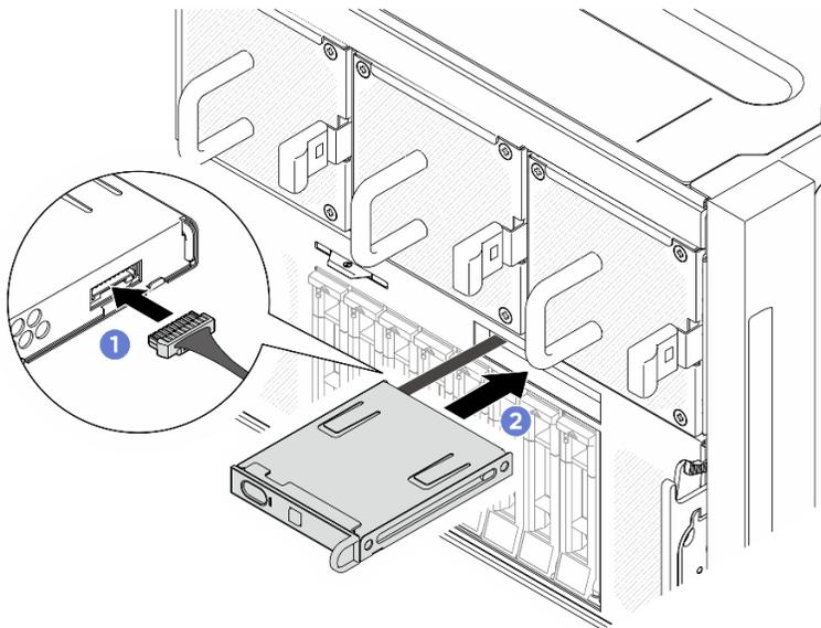
圖例 106. 安裝整合式診斷面板
