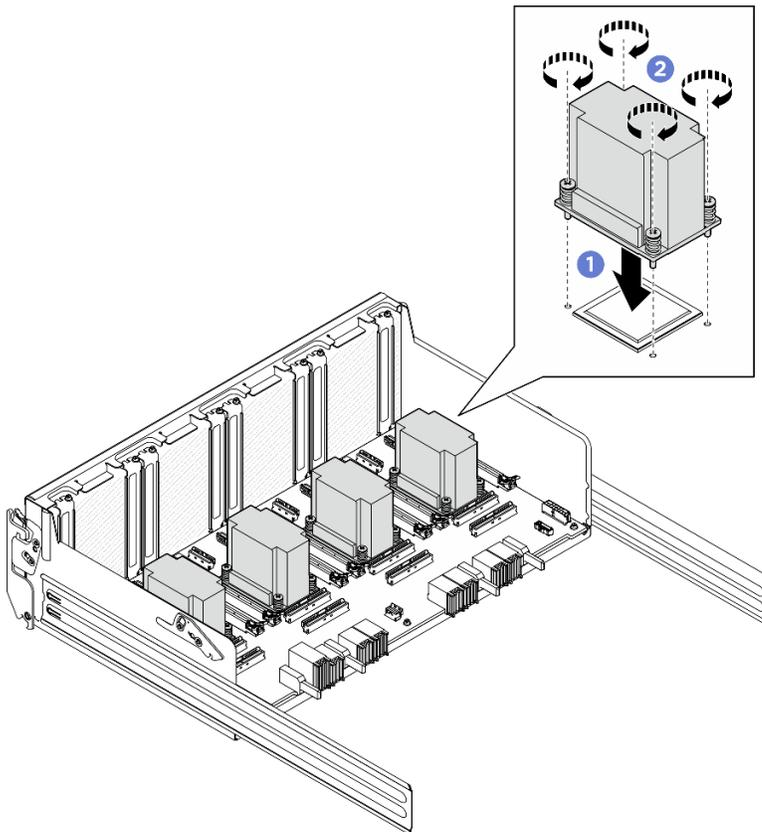
圖例 146. 安裝 PCIe 交換器板散熱槽
