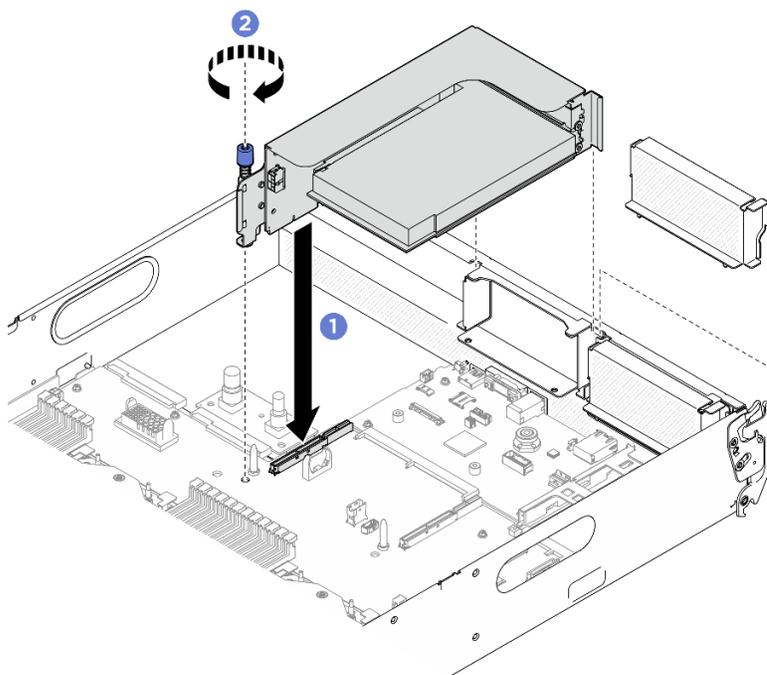
圖例 141. 安裝 PCIe 擴充卡組件
