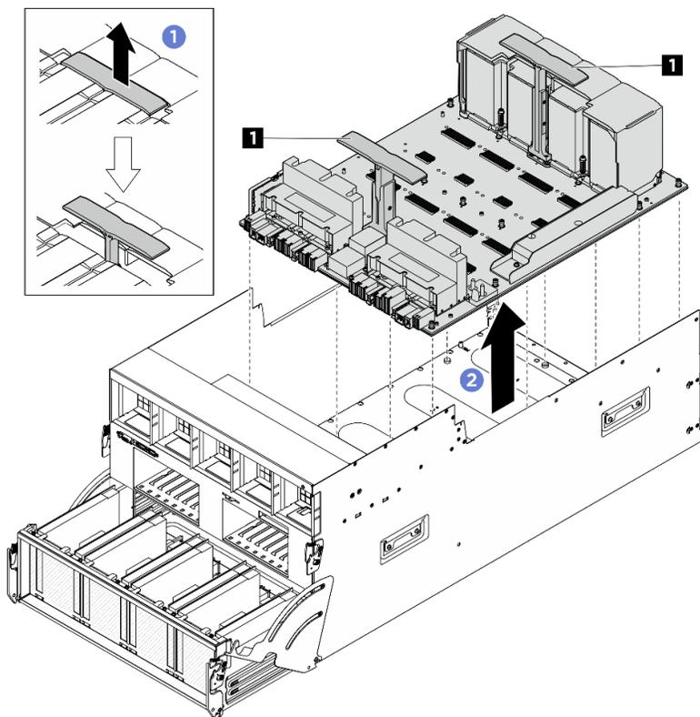
圖例 61. 卸下 GPU 基板
