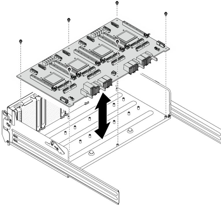
圖例 143. 卸下 PCIe 交換器板
