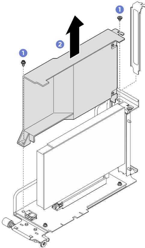
圖例 136. 卸下 PCIe 擴充卡空氣擋板
