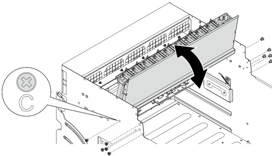
圖例 76. 翻轉前方 PCIe 交換器纜線載具
