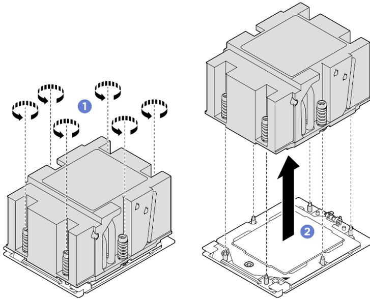
圖例 184. 卸下散熱槽
