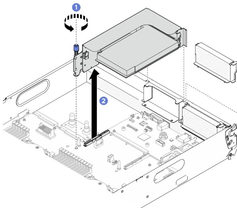
圖例 135. 卸下 PCIe 擴充卡組件
