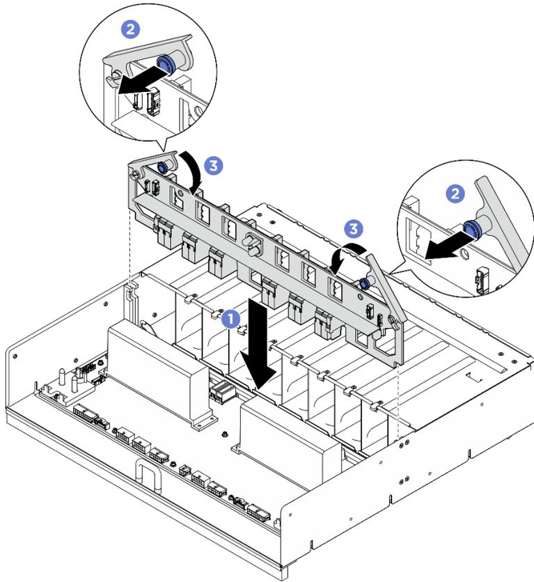
圖例 196. 安裝 PSU 轉插卡
