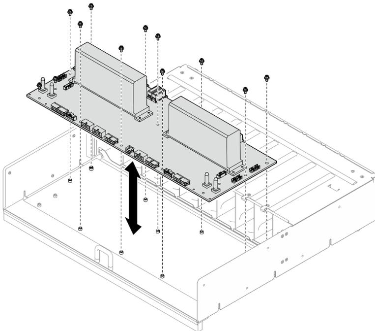
圖例 191. 卸下電源配送板
