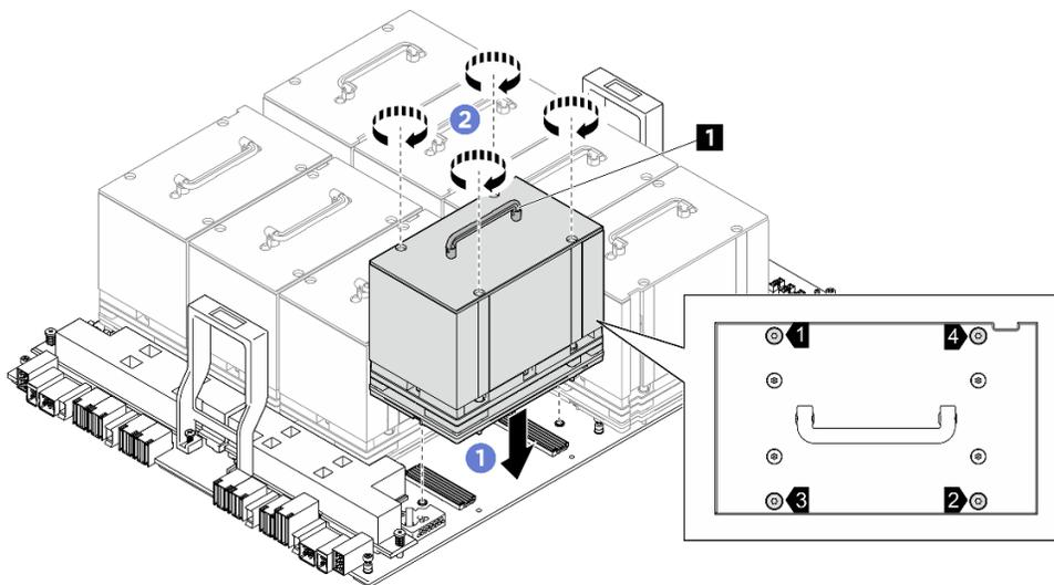
圖例 102. 安裝 GPU 和散熱槽模組
