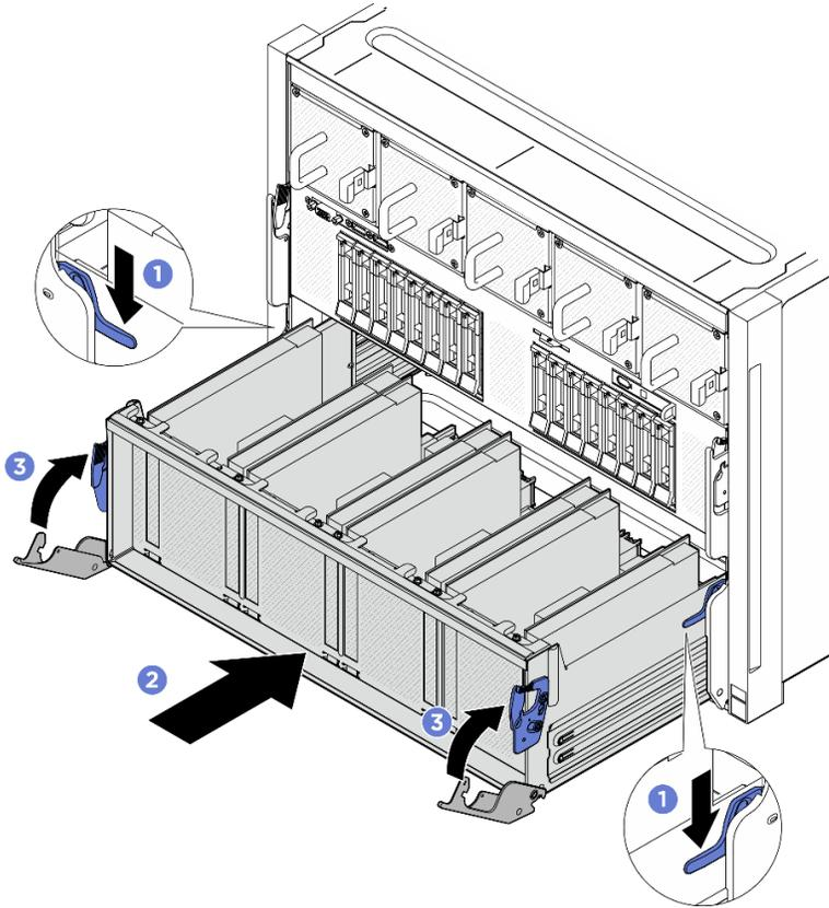
圖例 66. 將 PCIe 交換器滑動箱安裝到 8U GPU 滑動箱中
