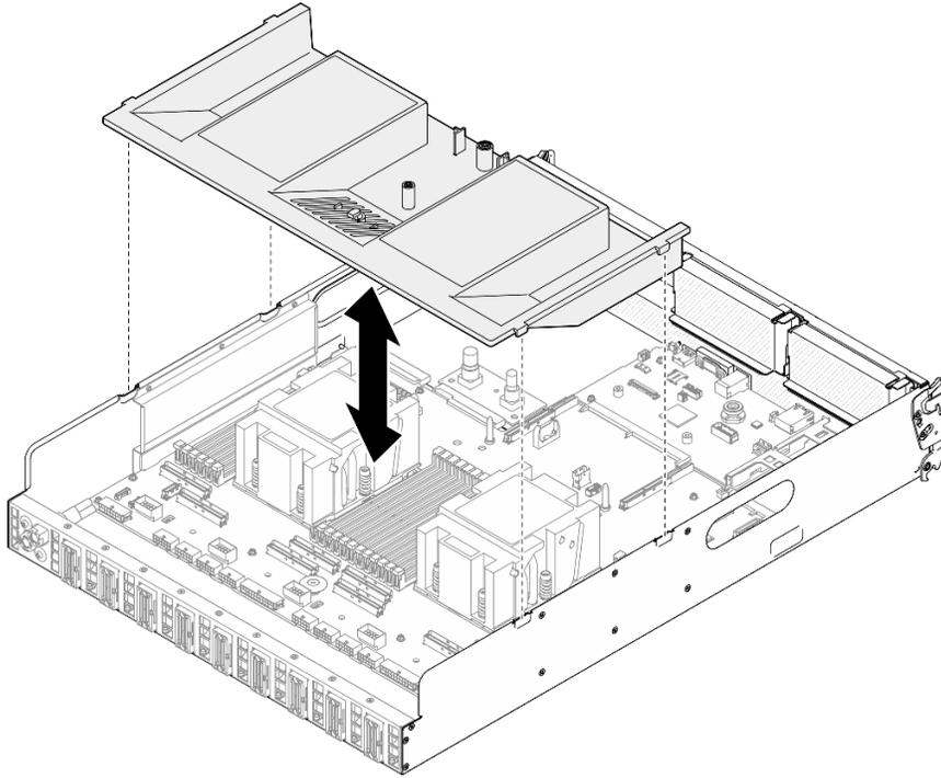
圖例 180. 卸下處理器空氣擋板
