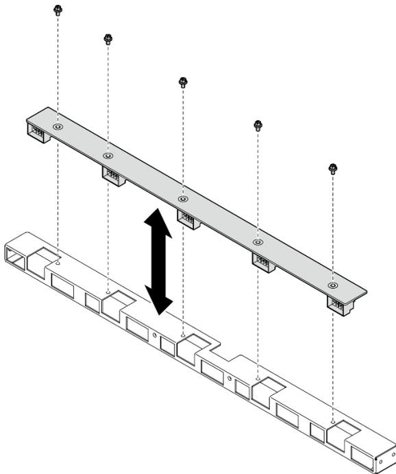
圖例 41. 卸下前方風扇控制板
