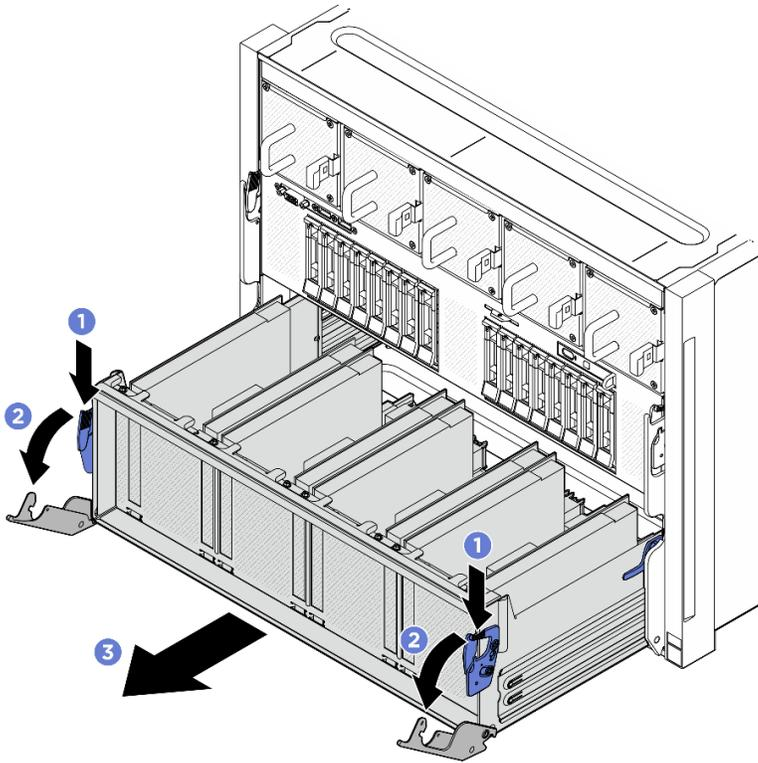
圖例 164. 將 PCIe 交換器滑動箱拉動到停止位置
