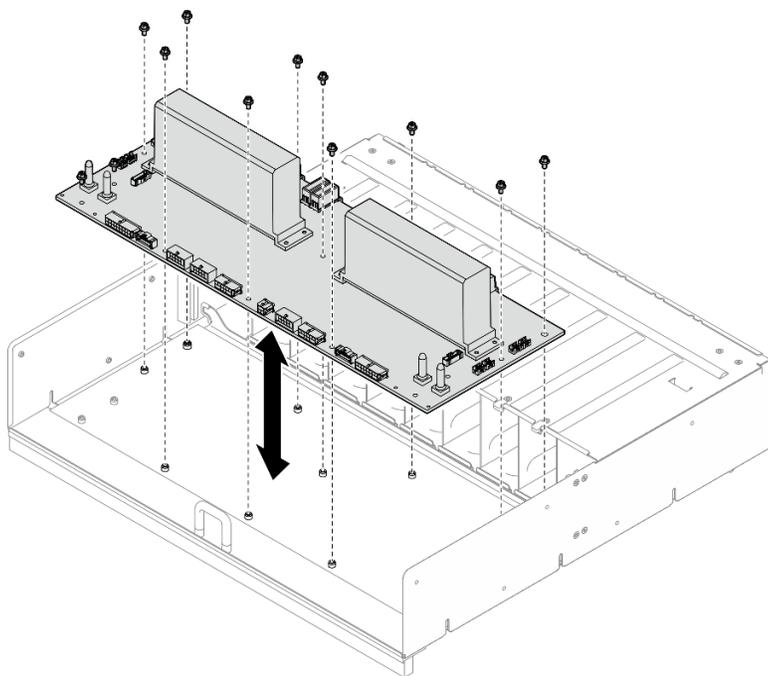
圖例 192. 安裝電源配送板
