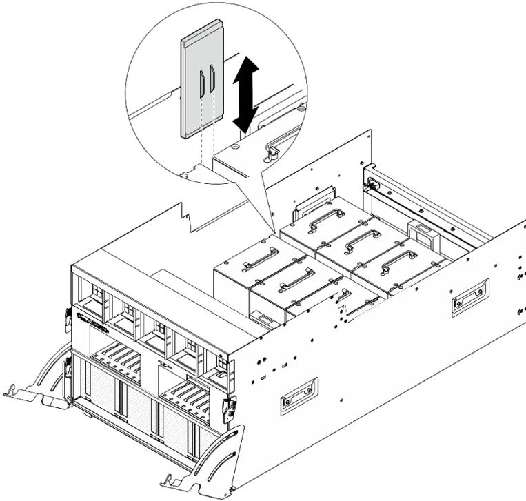
圖例 56. 安裝 GPU 空氣導管
