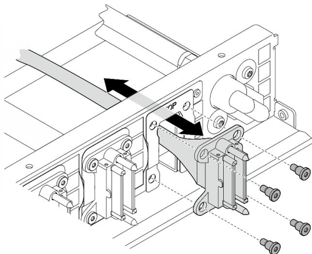
圖例 153. 安裝正面 I/O 模組、整合式診斷面板、GPU 管理或信號線
