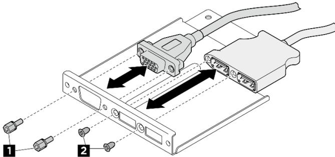
圖例 156. 安裝正面 I/O 模組纜線
