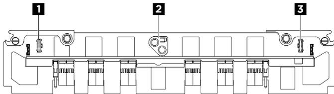
圖例 227. PSU 轉插卡接頭
