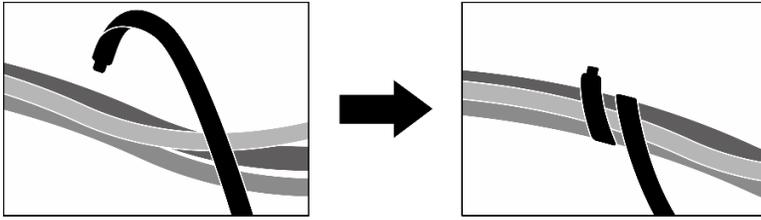
圖例 241. 使用纜線束帶固定纜線
