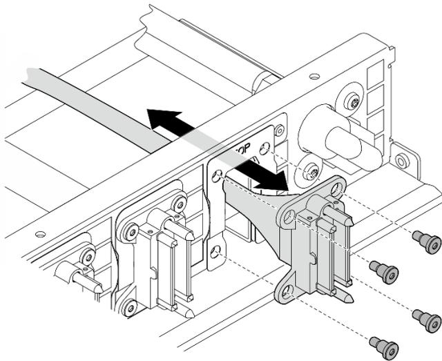
圖例 150. 卸下正面 I/O 模組、整合式診斷面板、GPU 管理或信號線
