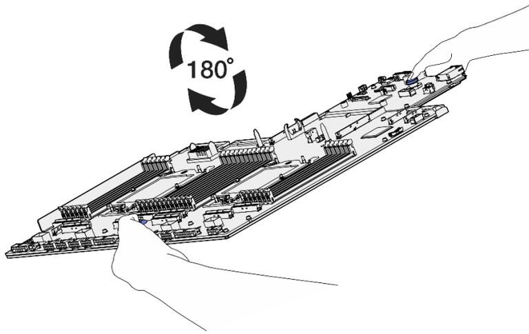
圖例 212. 將主機板組件上下倒置
