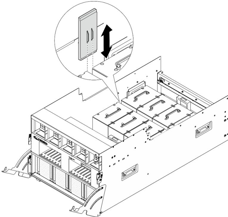
圖例 55. 卸下 GPU 空氣導管
