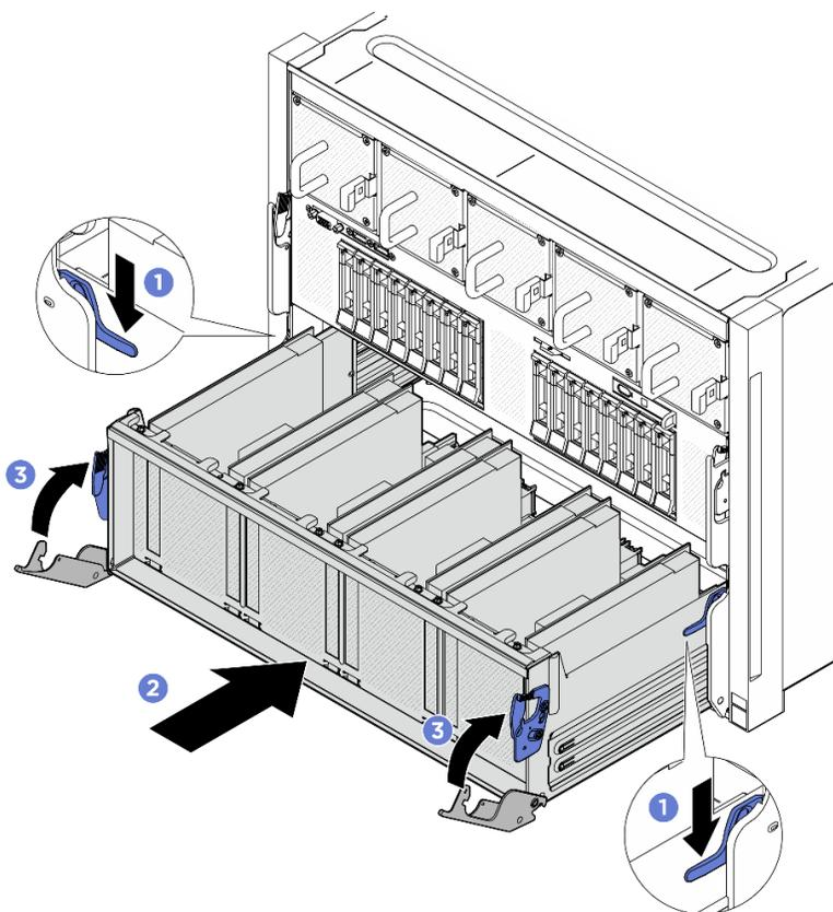
圖例 129. 將 PCIe 交換器滑動箱安裝到 8U GPU 滑動箱中
