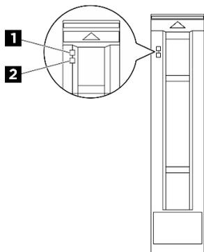
圖例 250. 硬碟 LED
