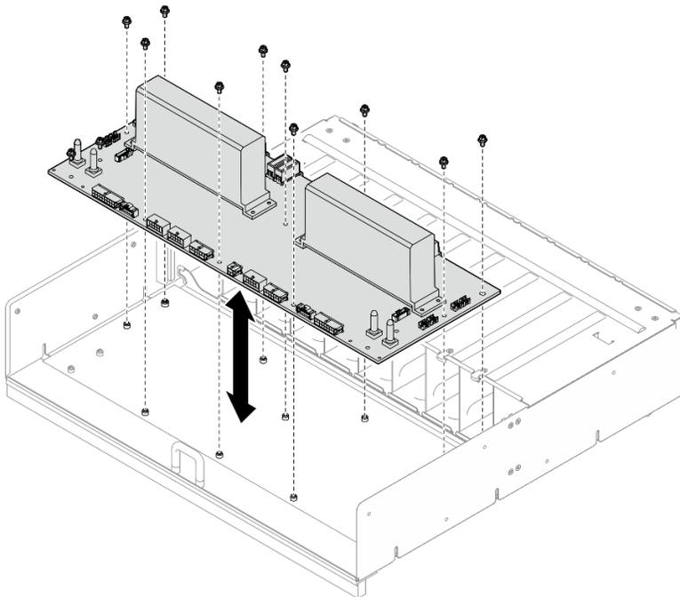
圖例 172. 安裝電源配送板
