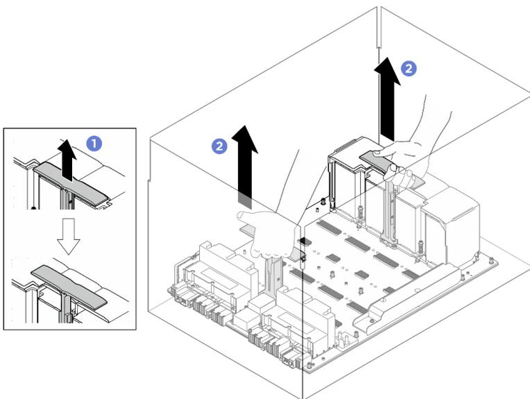
圖例 62. 從包裝盒中取出 GPU 基板
