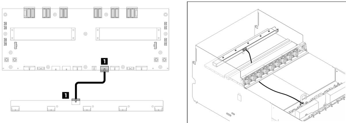
圖例 233. 前方風扇控制板纜線佈線
