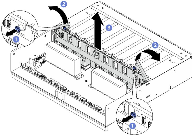
圖例 189. 卸下 PSU 轉插卡
