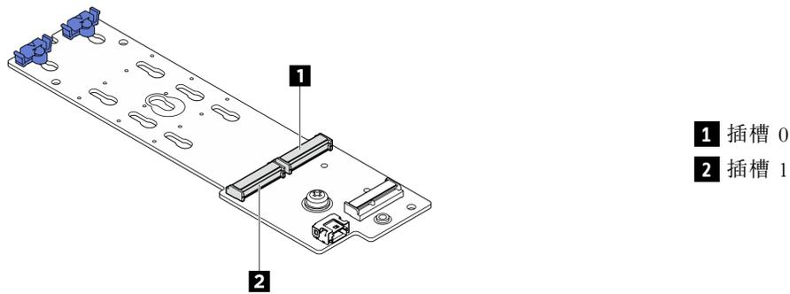
圖例 116. M.2 硬碟插槽
