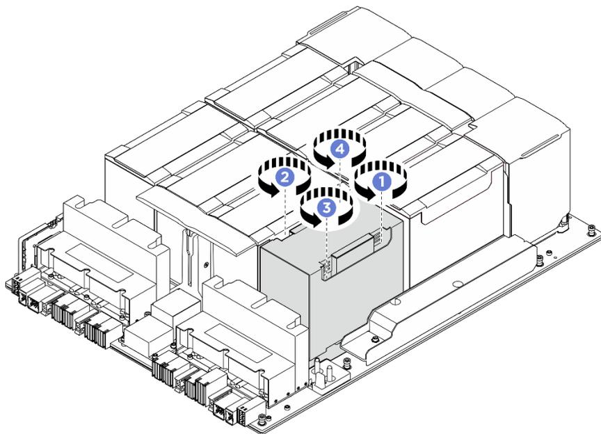
圖例 99. 螺絲鎖緊順序
