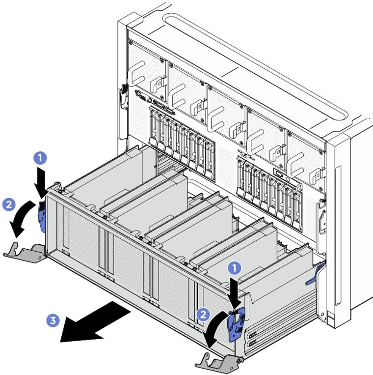
圖例 58. 將 PCIe 交換器滑動箱拉動到停止位置
