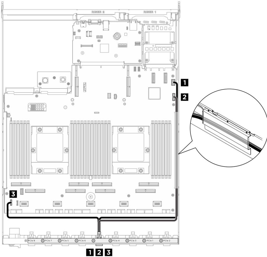
圖例 237. 正面 I/O 模組和整合式診斷面板纜線佈線
