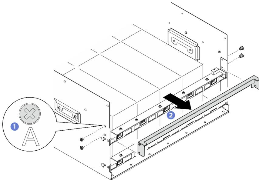
圖例 79. 卸下後支撐托架
