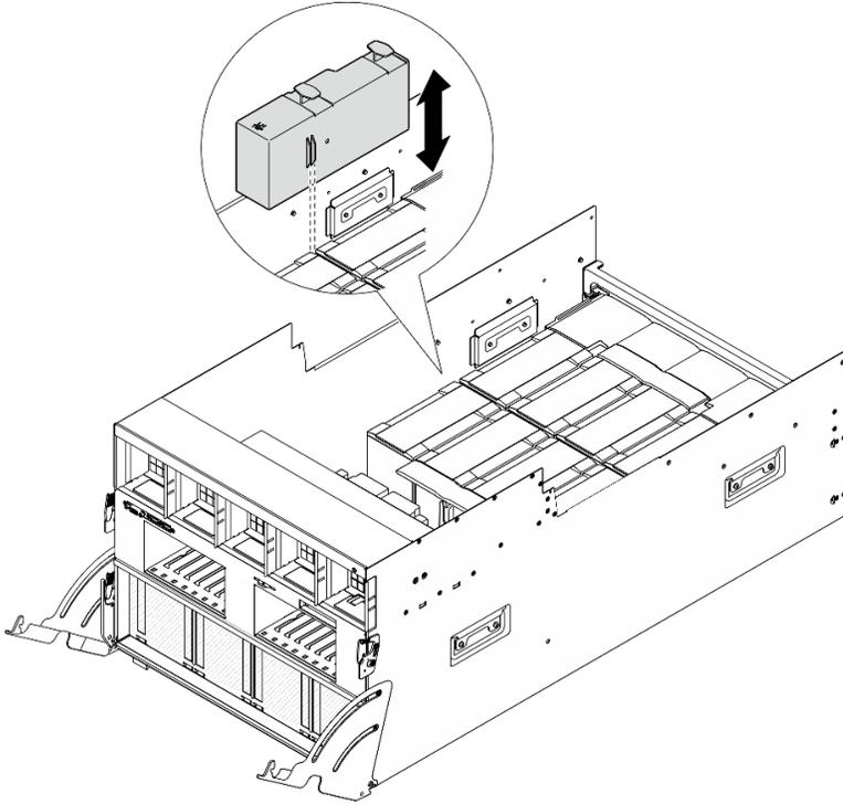
圖例 54. 安裝 GPU 空氣導管
