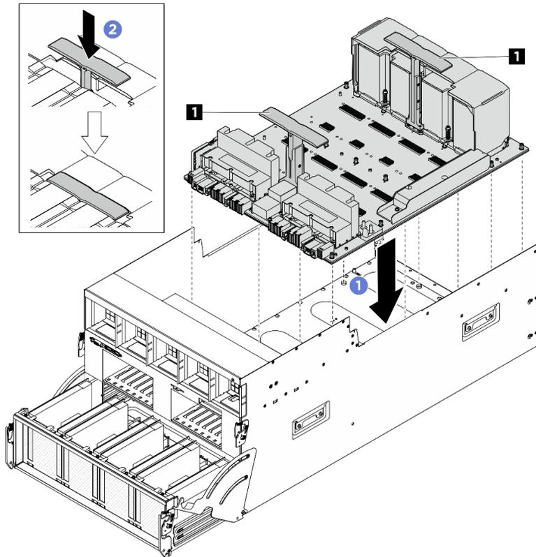
圖例 63. 安裝 GPU 基板
