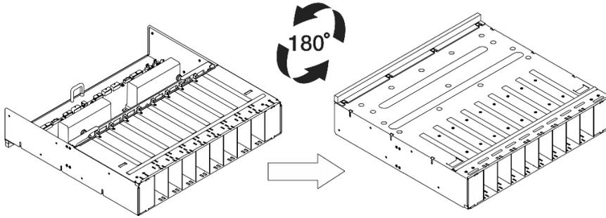
圖例 50. 將電源複合體上下倒置
