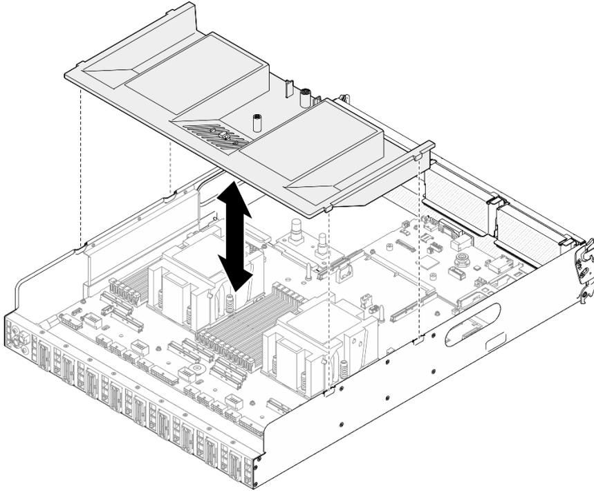
圖例 181. 安裝處理器空氣擋板
