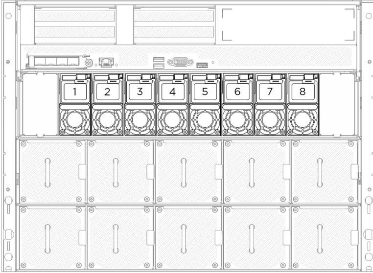
圖例 176. 電源供應器機槽編號
