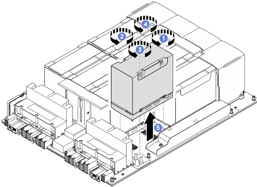
圖例 97. 卸下 GPU 和散熱槽模組
