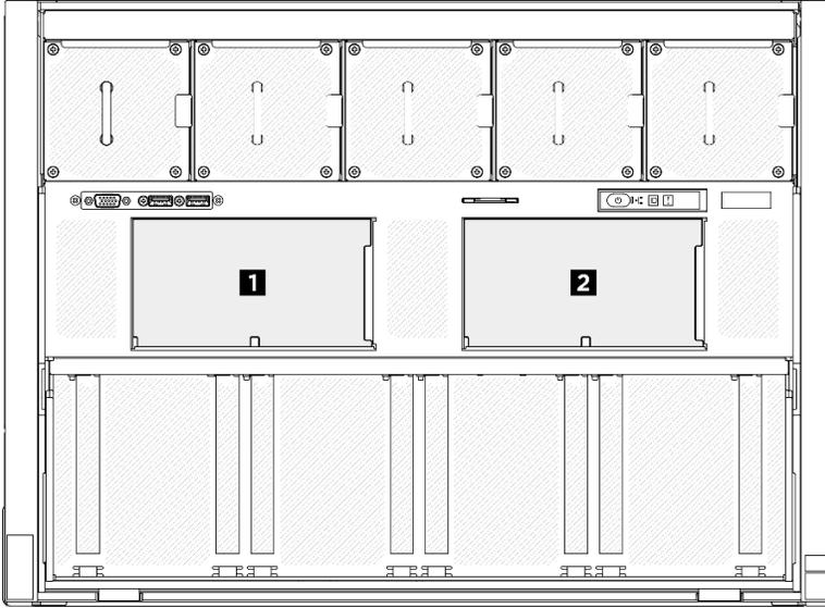
圖例21. 2.5 吋硬碟背板編號
