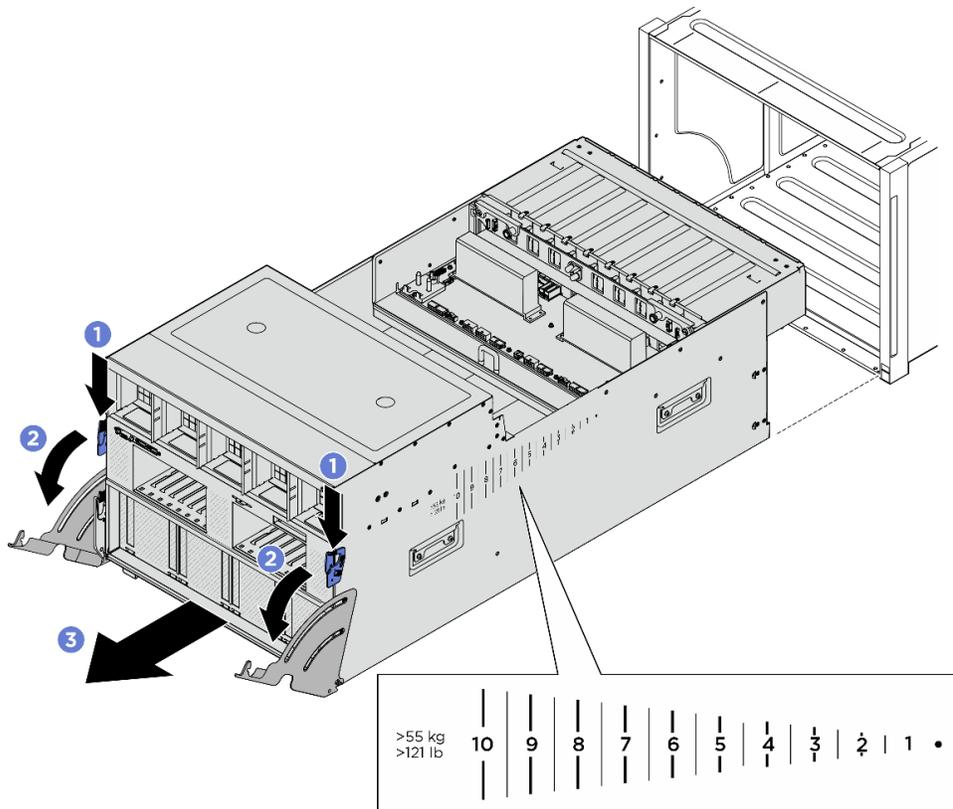
圖例 28. 卸下 8U GPU 滑動箱
