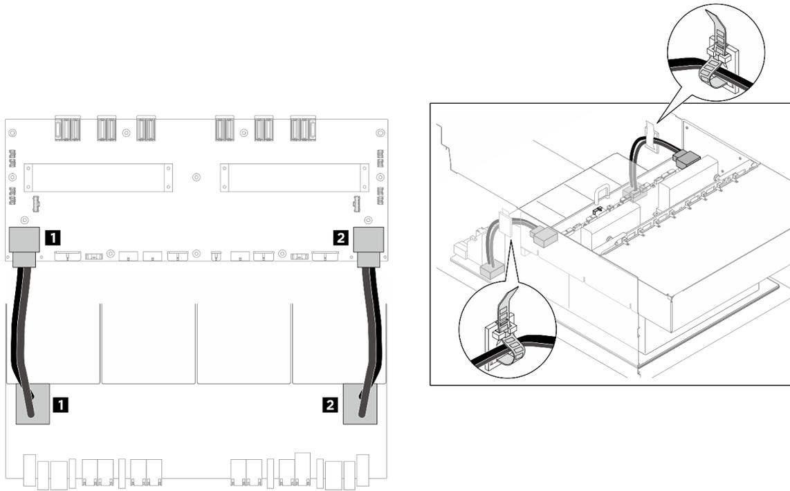
圖例 236. GPU 基板纜線佈線
