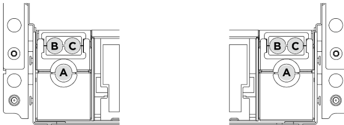
Abbildung 137. Position der Schlauchhalterung
