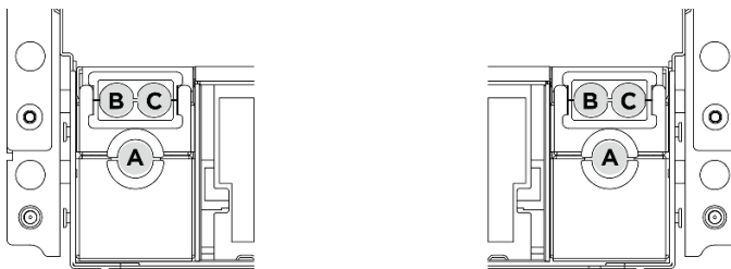
Abbildung 129. Position der Schlauchhalterung
