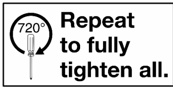
Figura 157. Repetición para apretar completamente todos los tornillos
