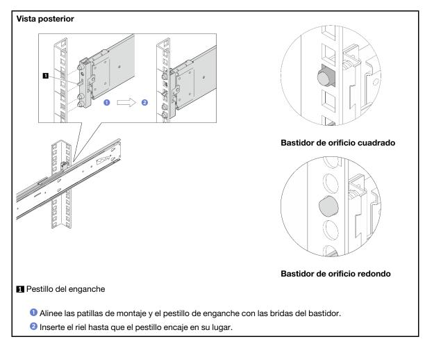
Paso 2. Instale las patillas de montaje frontales en el bastidor.
