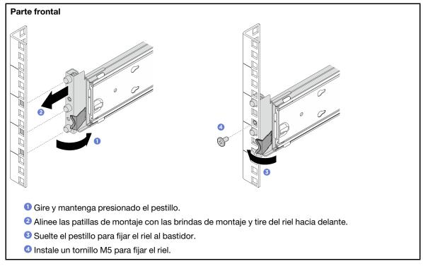
Paso 3. Instale un tornillo M5 en el orificio situado encima del pestillo de enganche en la parte posterior del riel
