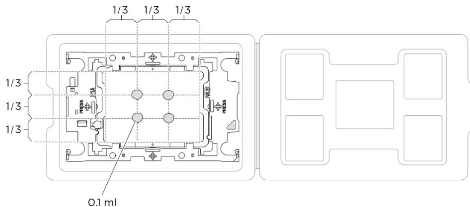
Figure 262. Application de pâte thermoconductrice avec processeur dans le plateau d'expédition
