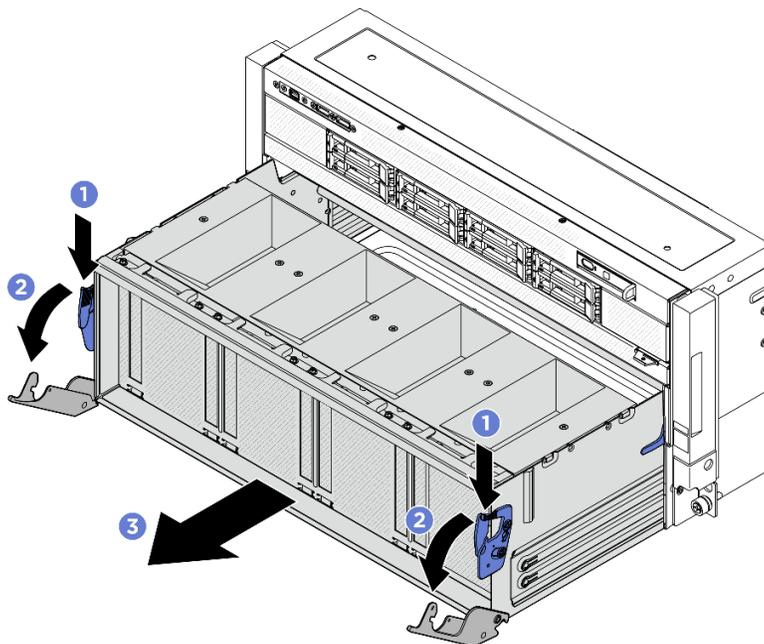
Figure 289. Retrait de la navette de commutation PCIe de la position d'arrêt
