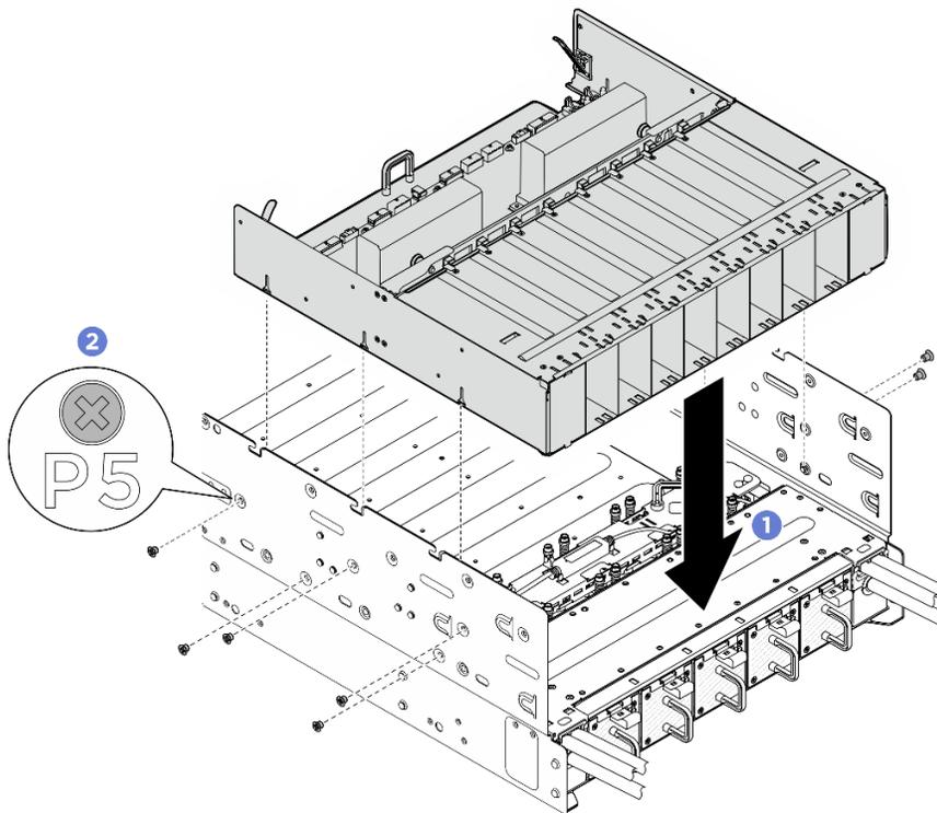
Figure 321. Installation du complexe d'alimentation
