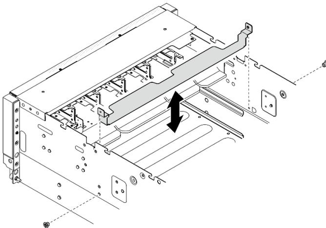
Figure 78. Retrait du support de protection du connecteur GPU
