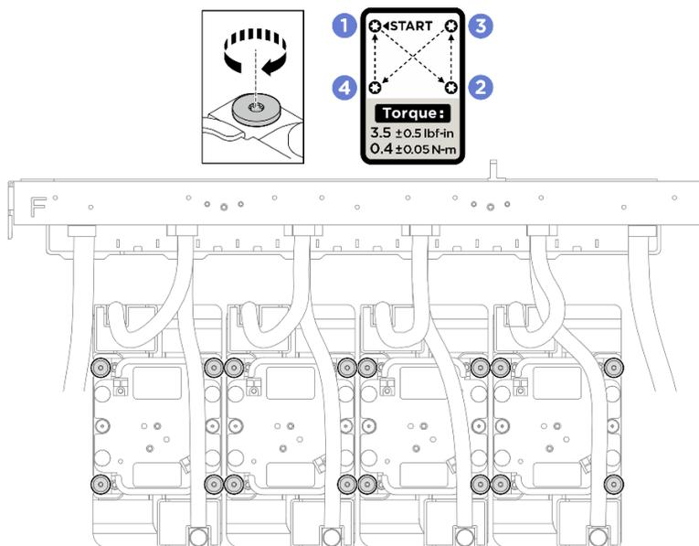
Figure 158. Installation des plaques froides GPU
