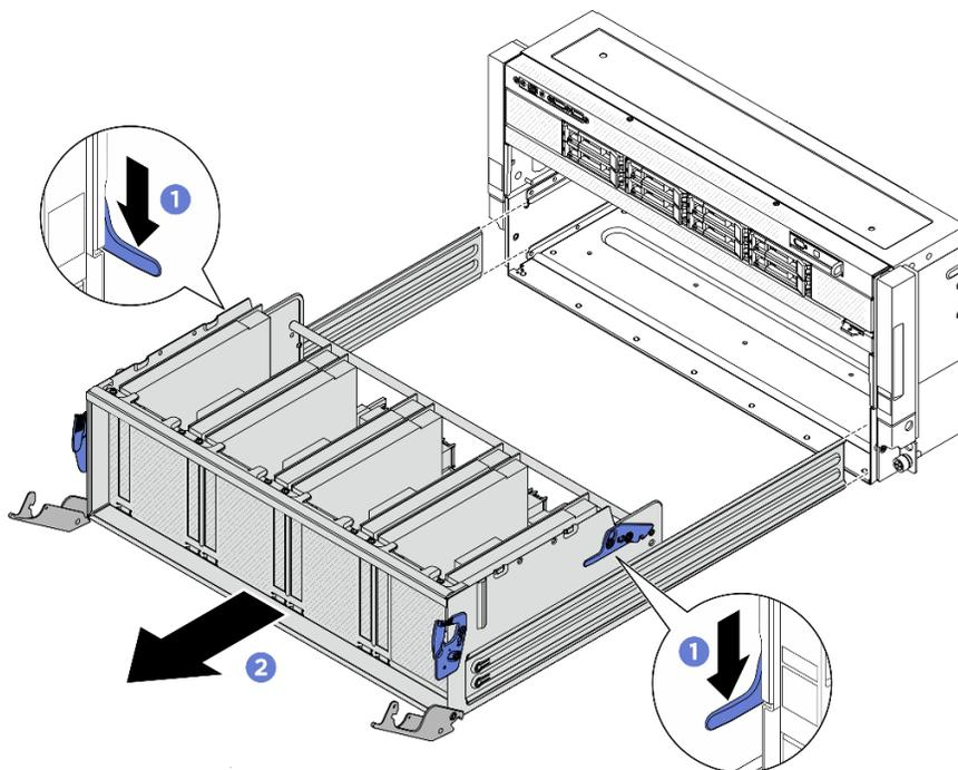
Figure 315. Retrait de la navette de commutation PCIe
