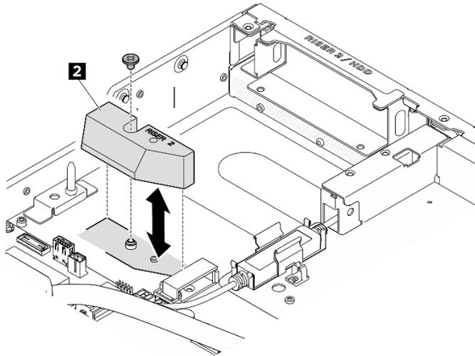
Figure 46. Installation de la grille d'aération DPU sur le châssis
