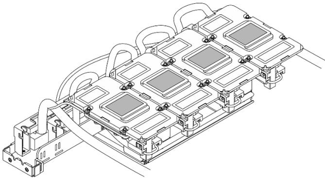
Figure 175. Essuyage du PCM et des tampons de mastic des plaques froides
