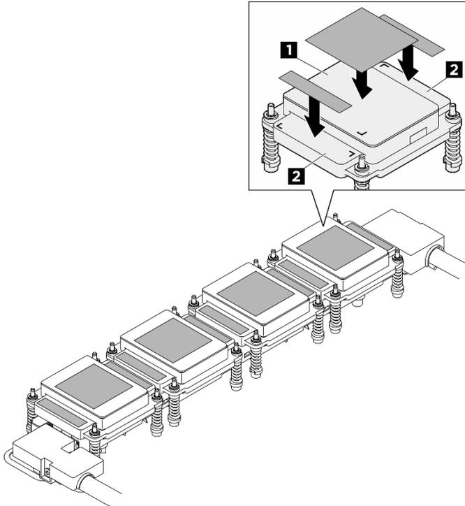
Figure 125. Application du PCM et des tampons de mastic
