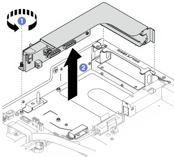
Figure 299. Retrait de l'assemblage de cartes mezzanines PCIe dans l'emplacement 2
