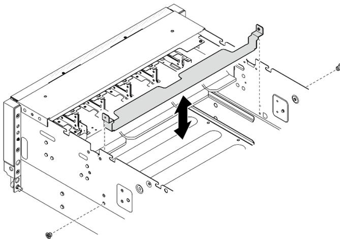
Figure 95. Retrait du support de protection du connecteur GPU
