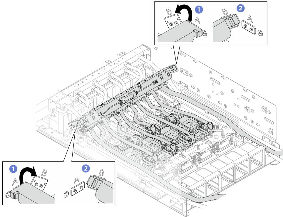
Figure 162. Réinstallation du collecteur du module de plaque froide GPU H100/H200 arrière
