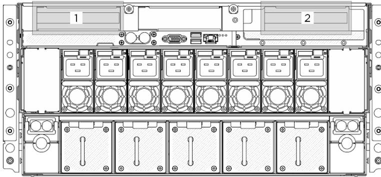
Figure 303. Emplacements des cartes mezzanines PCIe
