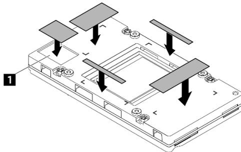
Figure 208. Remplacement des tampons de mastic du GPU
