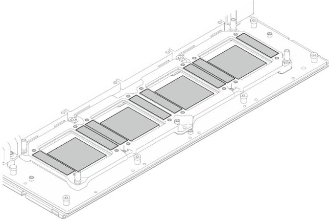
Figure 122. Nettoyage du PCM et des tampons de mastic des NVSwitches
