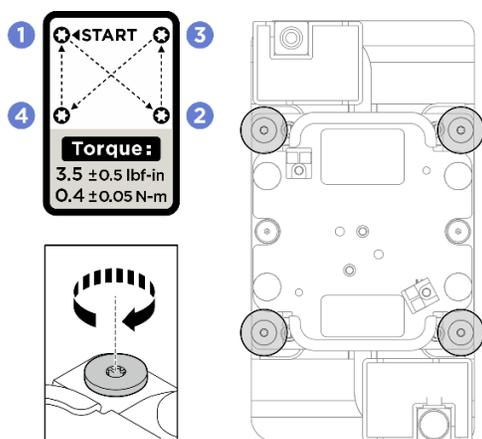
Figure 237. Installation de la plaque froide GPU
