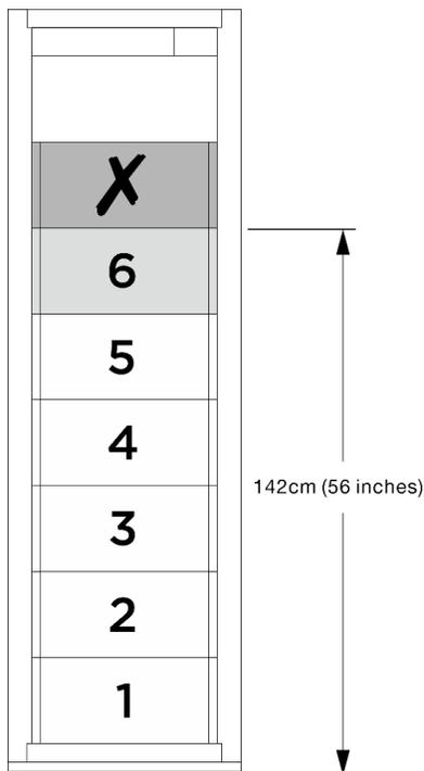
Figure 2. Hauteur d'installation maximale recommandée
