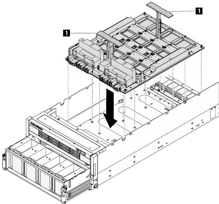
Figure 88. Installation du complexe GPU
