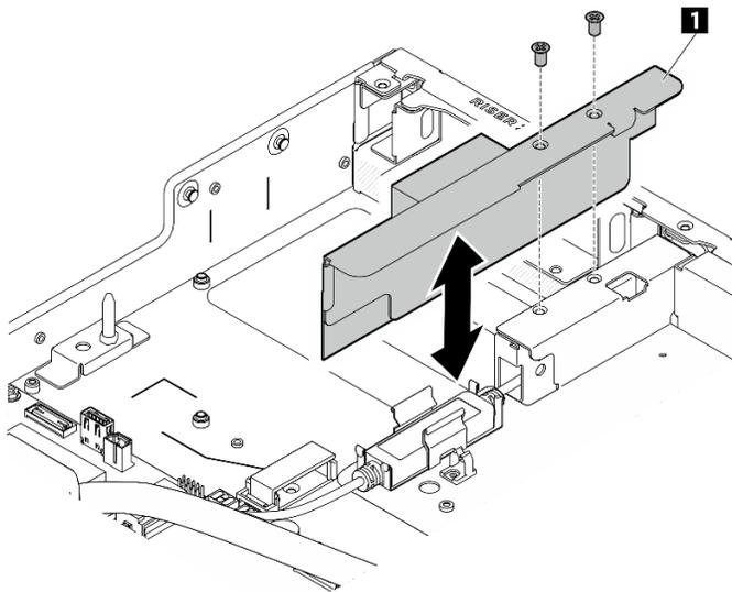
Figure 34. Retrait de l'assemblage de la grille d'aération DPU et du support
