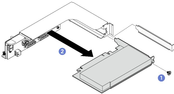
Figure 295. Retrait d'un adaptateur PCIe arrière
