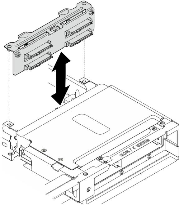
Figure 350. Retrait d'un support de fond de panier d'unité 2,5 pouces arrière
