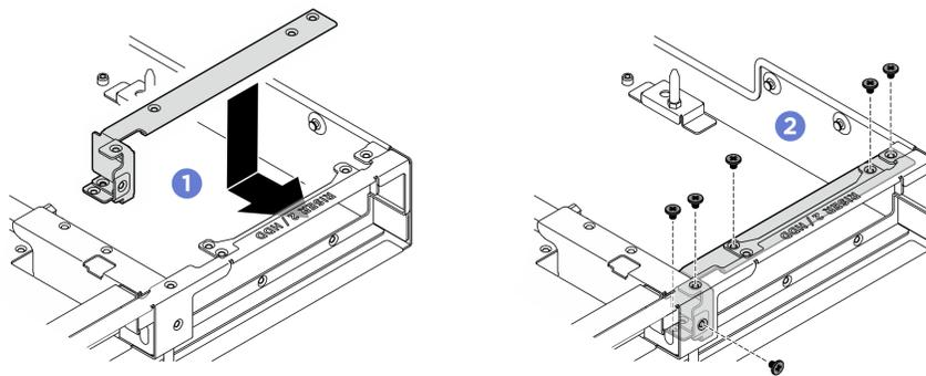
Figure 356. Installation du support de boîtier d'unités de disque dur arrière
