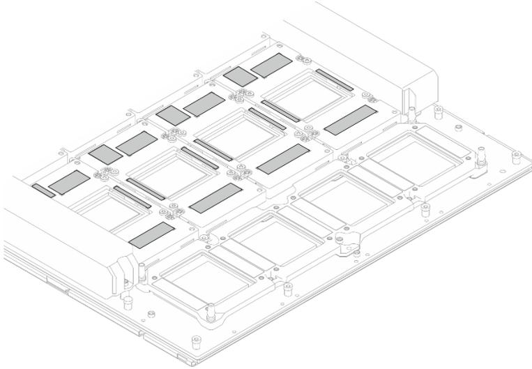
Figure 174. Nettoyage du PCM et des tampons de mastic des GPU
