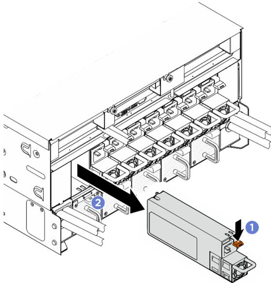
Figure 331. Retrait d'un bloc d'alimentation
