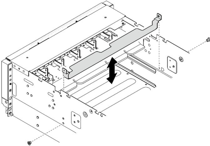
Figure 105. Installation du support de protection du connecteur GPU
