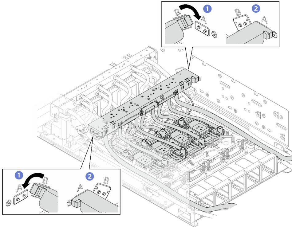
Figure 140. Repositionnement du collecteur du module de plaque froide GPU H100/H200 arrière
