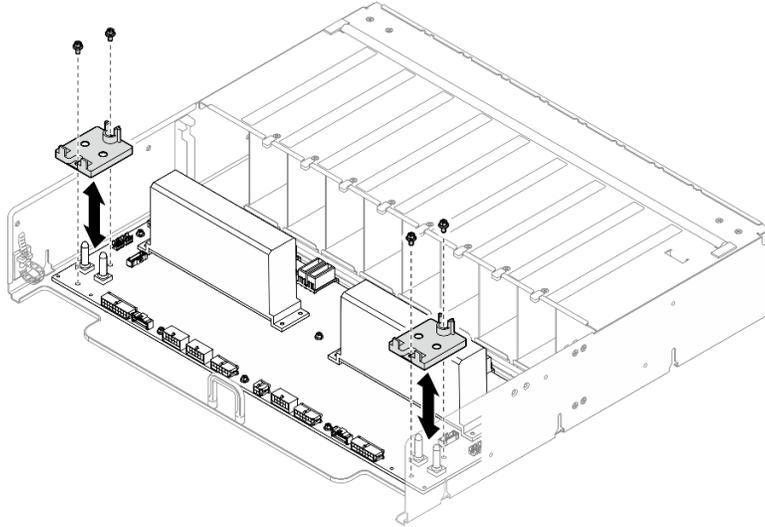
Figure 327. Installation du dispositif de retenue des câbles
