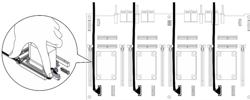
Enfoncez les câbles de signal du fond de panier d'unité 2,5 pouces sur le tableau pour les tenir à l'écart des dissipateurs thermiques.
