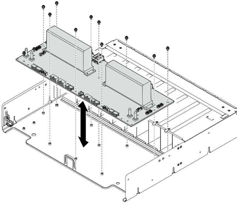
Figure 340. Installation du tableau de distribution
