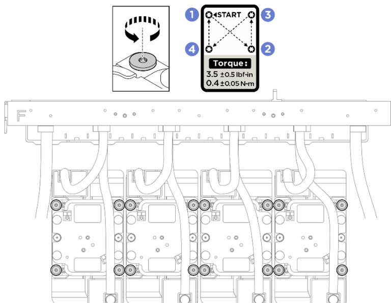
Figure 141. Retrait des plaques froides GPU
