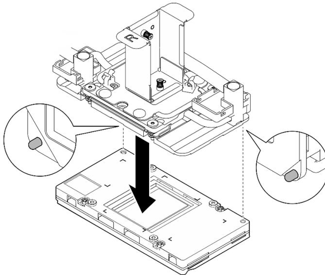
Figure 234. Ajustement de la plaque froide
