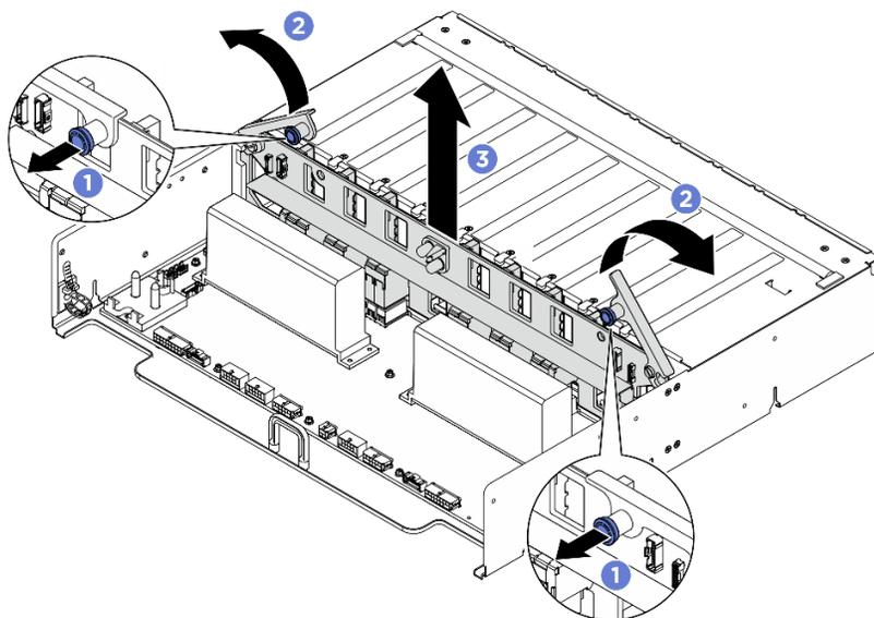
Figure 344. Retrait de l'interposeur du bloc d'alimentation
