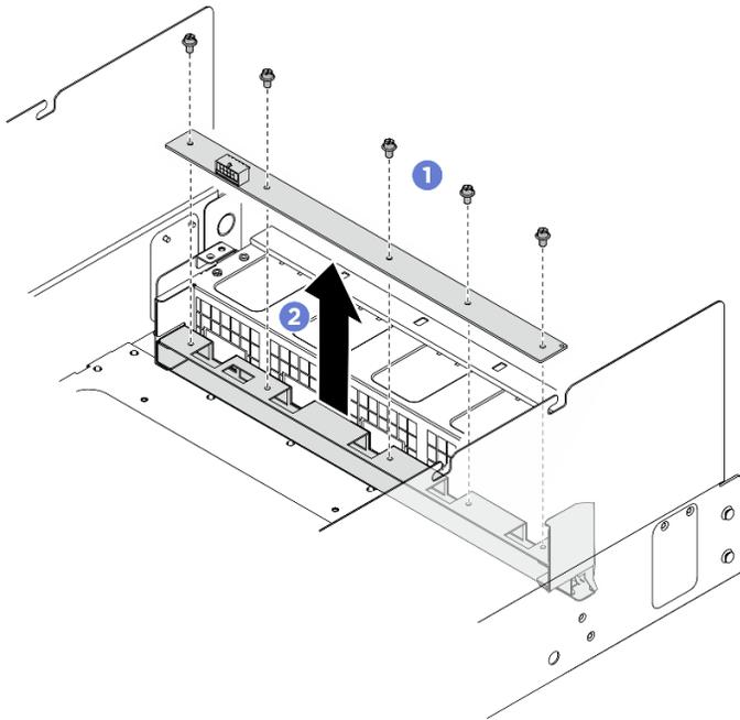
Figure 67. Retrait de la carte de contrôleur de ventilation arrière
