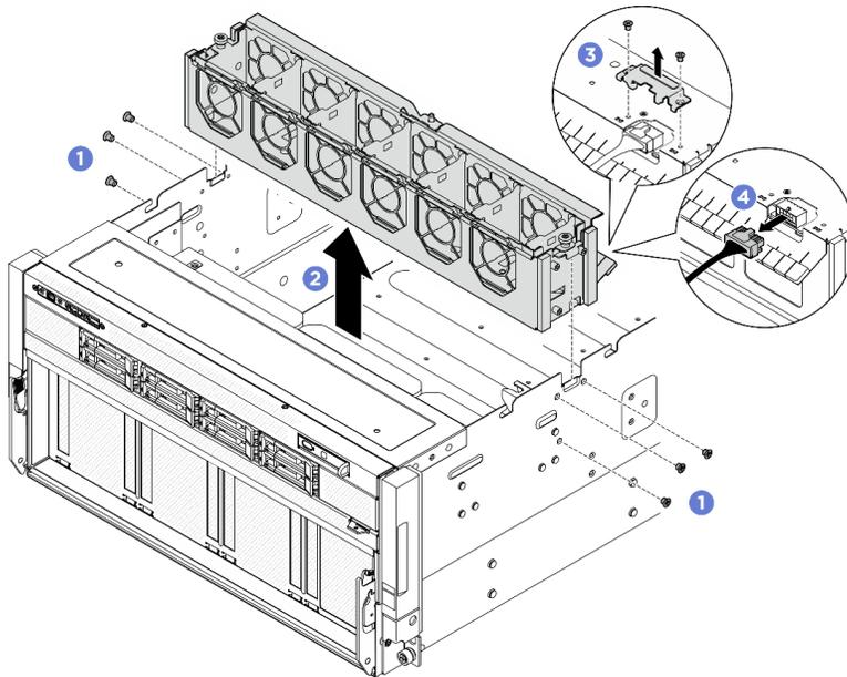
Figure 51. Retrait du boîtier de ventilation
