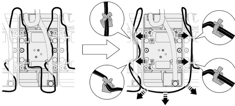
Figure 220. Retrait des câbles du module de détecteur de fuite
