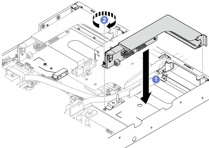
Figure 304. Installation de l'assemblage de cartes mezzanines PCIe dans l'emplacement 1
