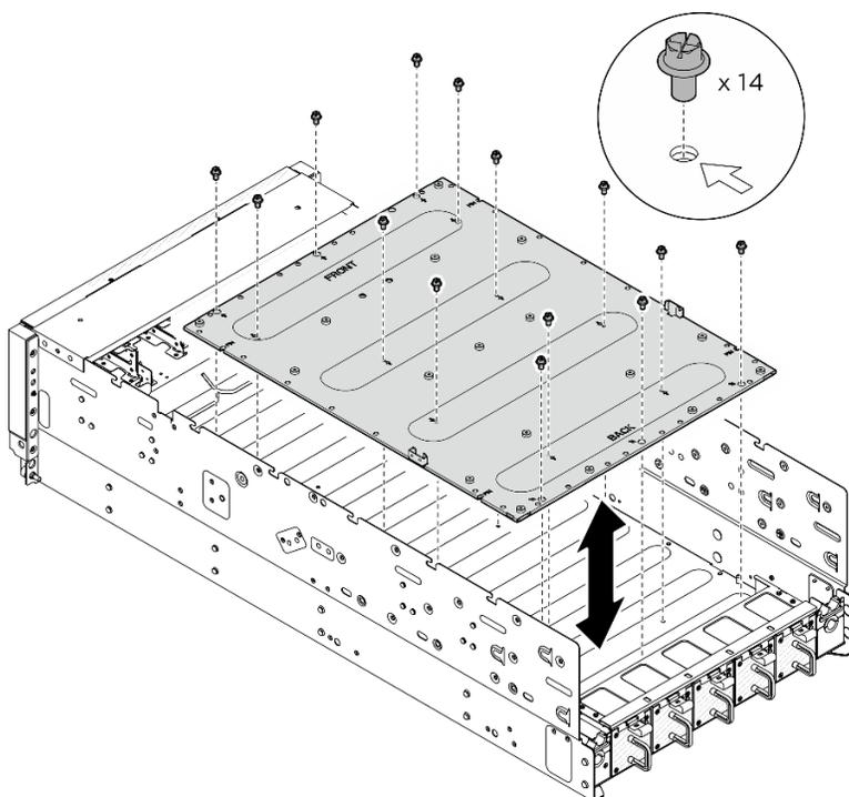
Figure 108. Retrait de la plaque d'adaptateur du complexe GPU
