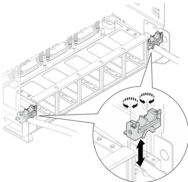
Figure 131. Installation du support de tuyaux B/C
