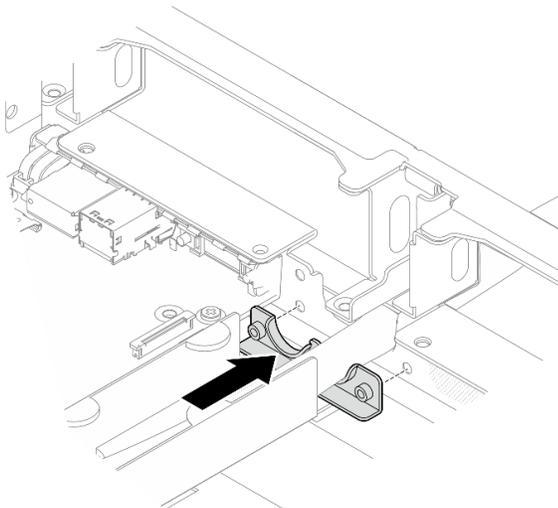
Figure 270. Installation du support de tuyaux
