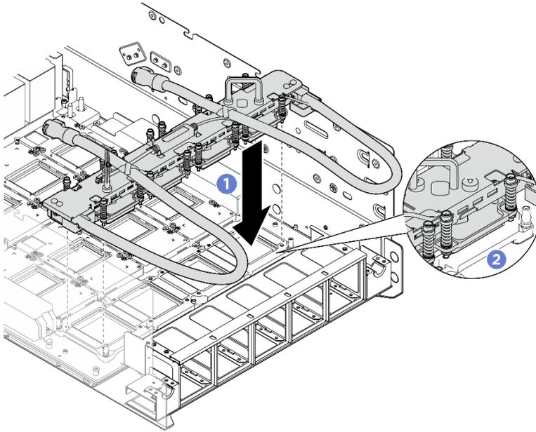
Figure 126. Installation du module de plaque froide NVSwitch
