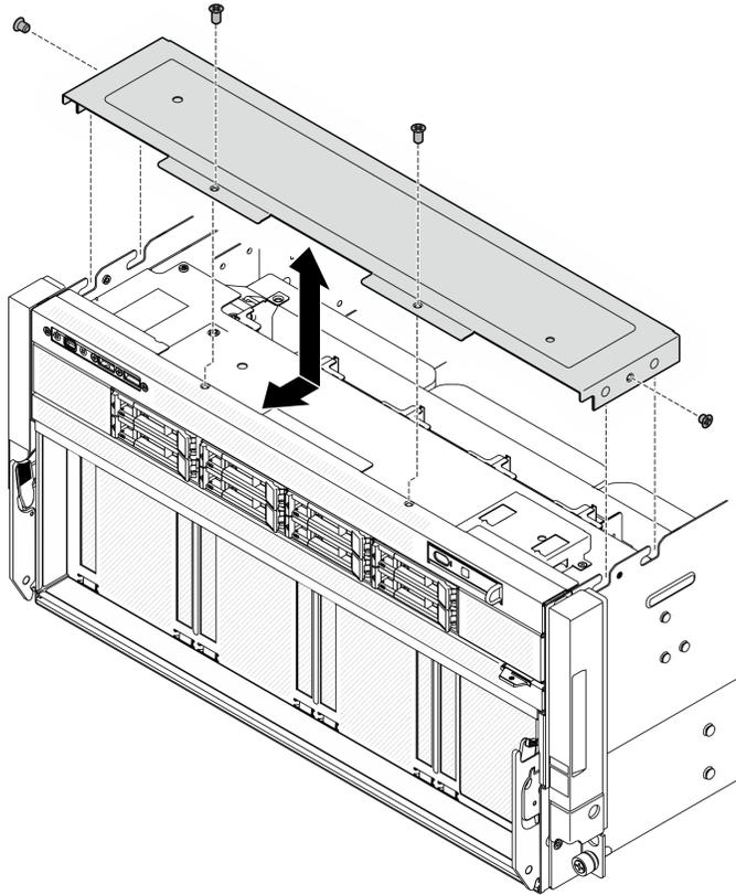
Figure 245. Installation du cache d'E/S
