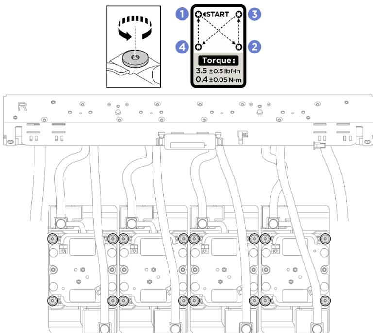
Figure 169. Retrait des plaques froides GPU
