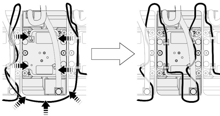
Figure 214. Installation du câble du module de détecteur de fuite
