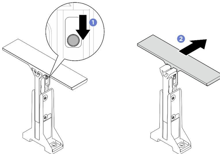
Figure 89. Ajustement de la poignée
