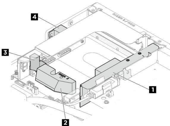
Figure 43. Emplacement de la grille d'aération DPU dans l'emplacement de carte mezzanine 2
