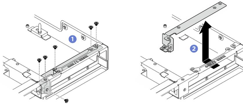
Figure 348. Retrait du support du boîtier d'unités de disque dur arrière
