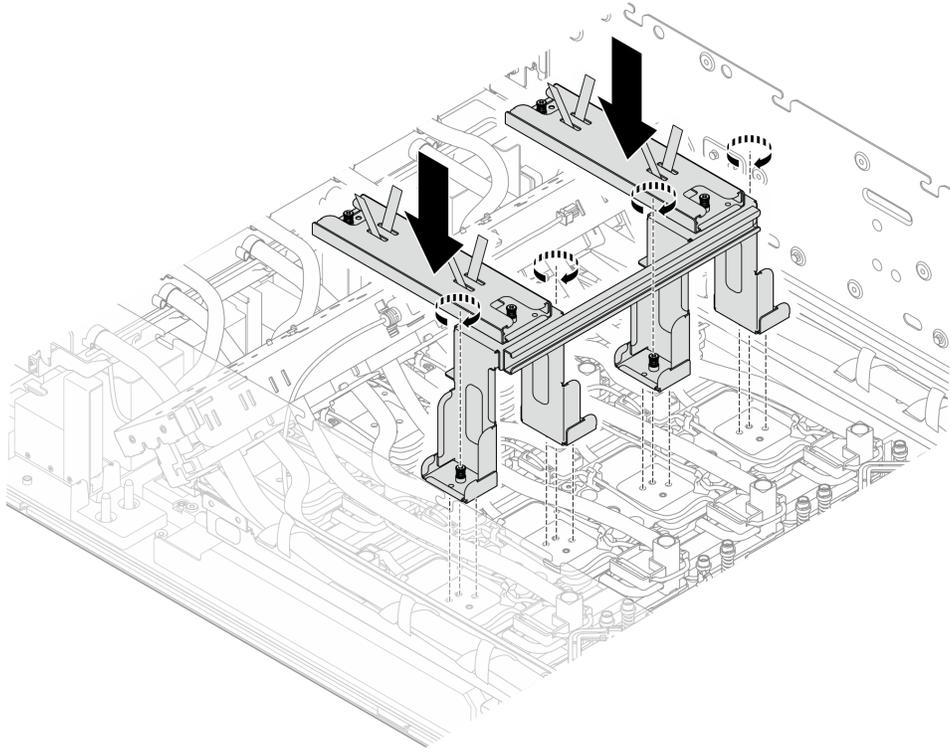
Figure 192. Installation des supports de transport sur les plaques froides GPU arrière
