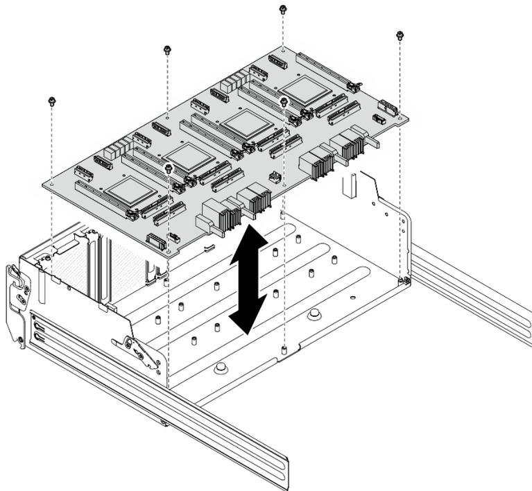
Figure 309. Retrait du tableau de commutation PCIe
