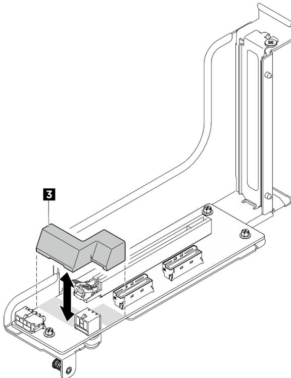
Figure 36. Retrait de la grille d'aération DPU de la carte mezzanine PCIe
