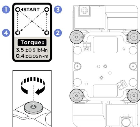
Figure 213. Installation de la plaque froide GPU
