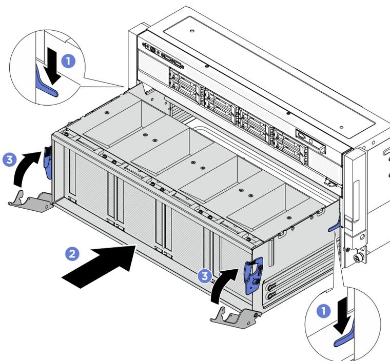
Figure 319. Installation de la navette de commutation PCIe
