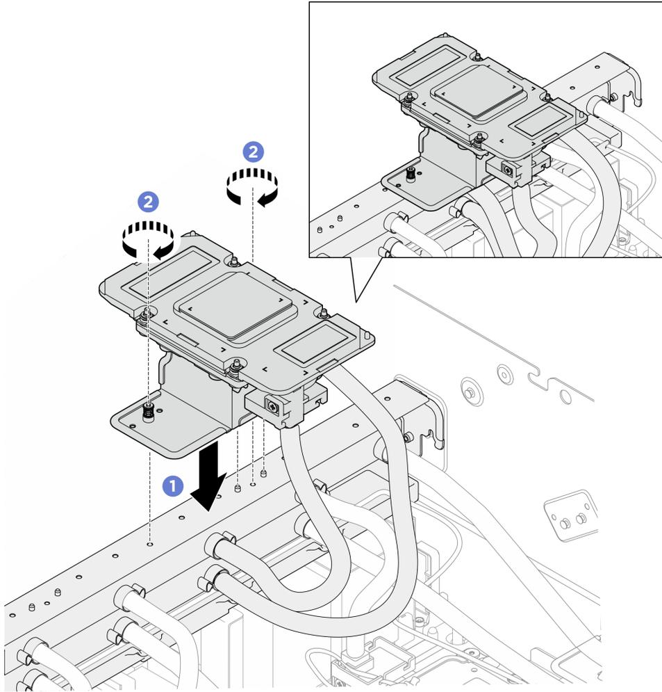
Figure 199. Installation du support de maintenance et de l'assemblage de plaque froide GPU
