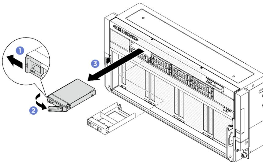
Figure 10. Retrait d'une unité remplaçable à chaud 2,5 pouces avant
