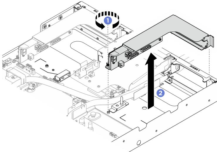
Figure 298. Retrait de l'assemblage de cartes mezzanines PCIe dans l'emplacement 1
