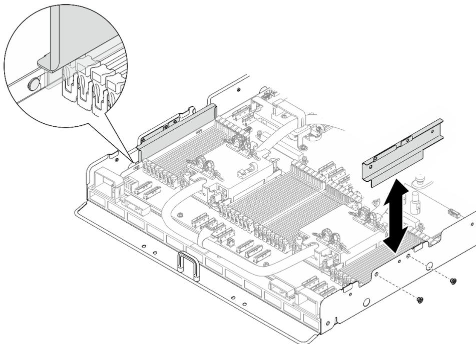
Figure 366. Installation du guide de câble
