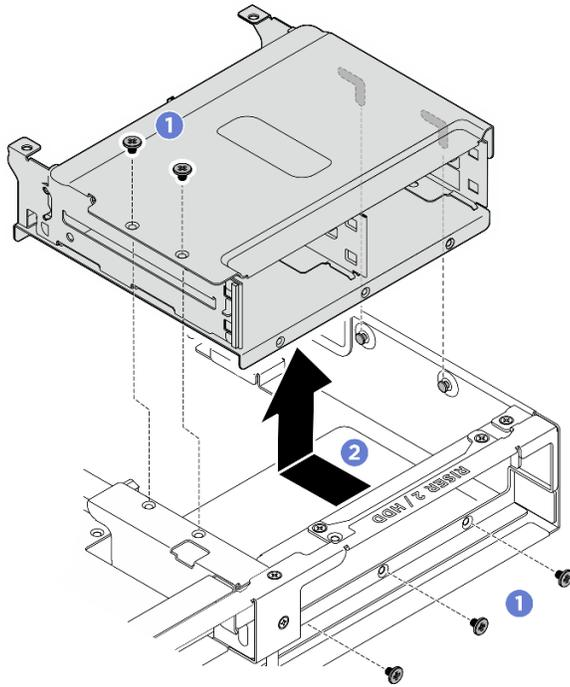
Figure 346. Retrait du boîtier d'unités de disque dur arrière
