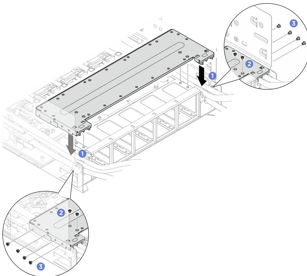
Figure 134. Installation du support du boîtier de ventilation arrière
