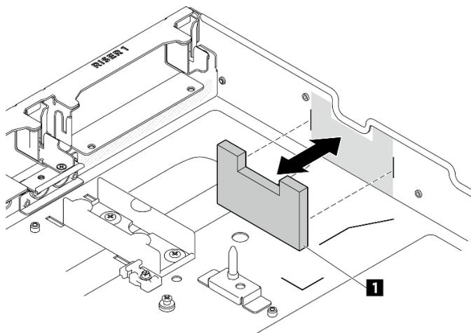
Figure 40. Installation de la grille d'aération DPU de l'emplacement de carte mezzanine 1 sur le châssis
