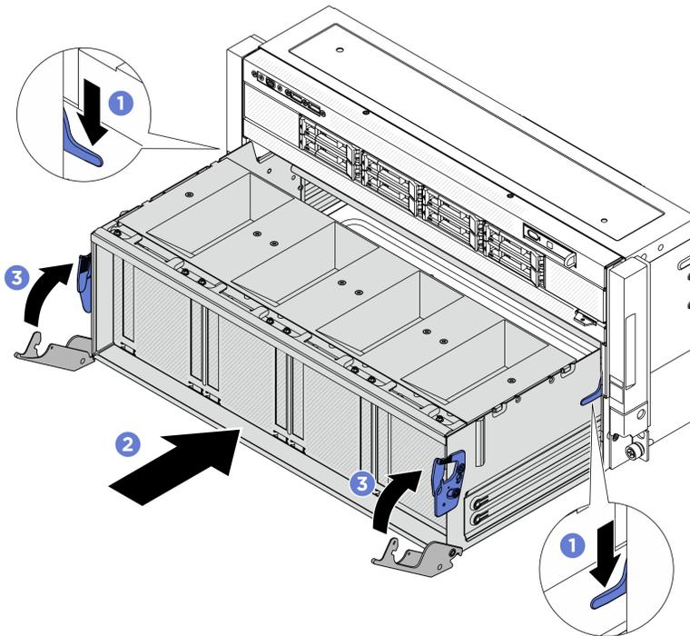
Figure 111. Installation de la navette de commutation PCIe
