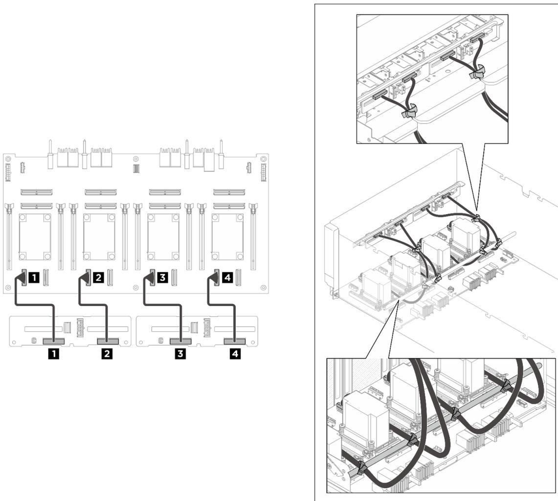
Figure 379. Cheminement des câbles de signal du fond de panier d'unité 2,5 pouces avant
