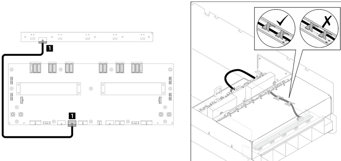
Figure 384. Cheminement des câbles de la carte de contrôleur de ventilation arrière
