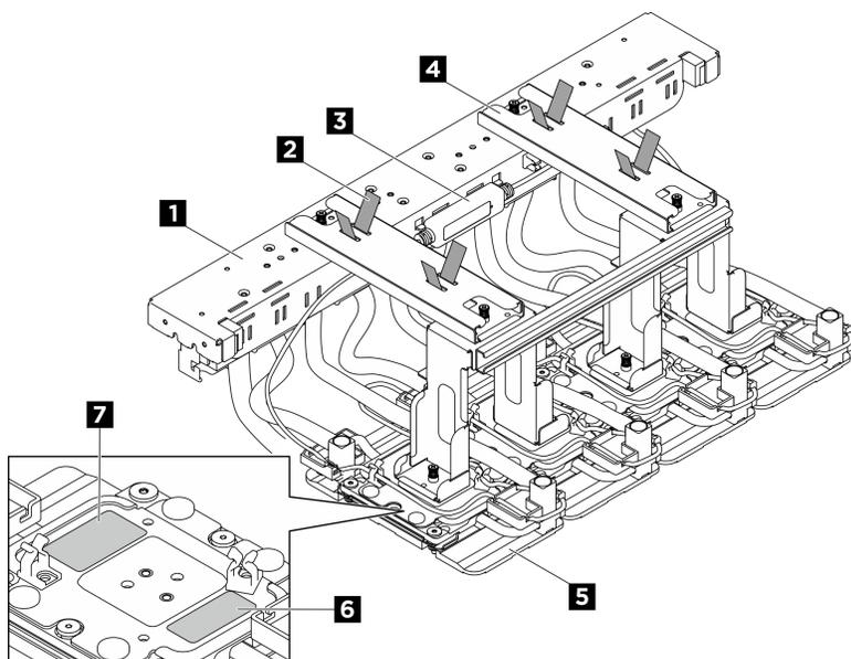
Figure 177. Identification des composants du module de plaque froide GPU H100/H200 arrière
