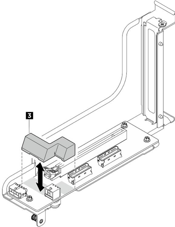
Figure 42. Installation de la grille d'aération DPU sur la carte mezzanine PCIe
