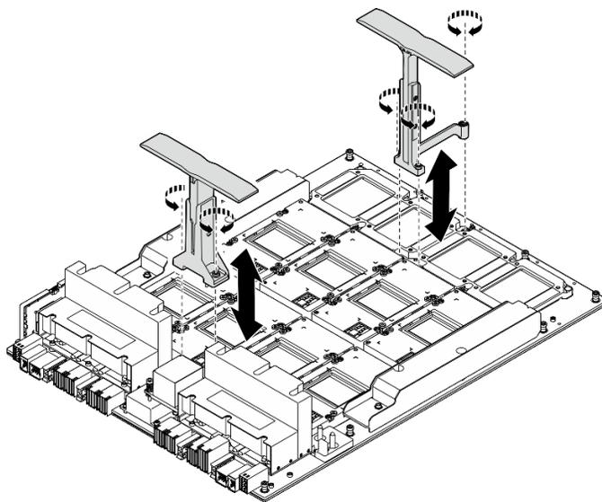
Figure 81. Installation des poignées
