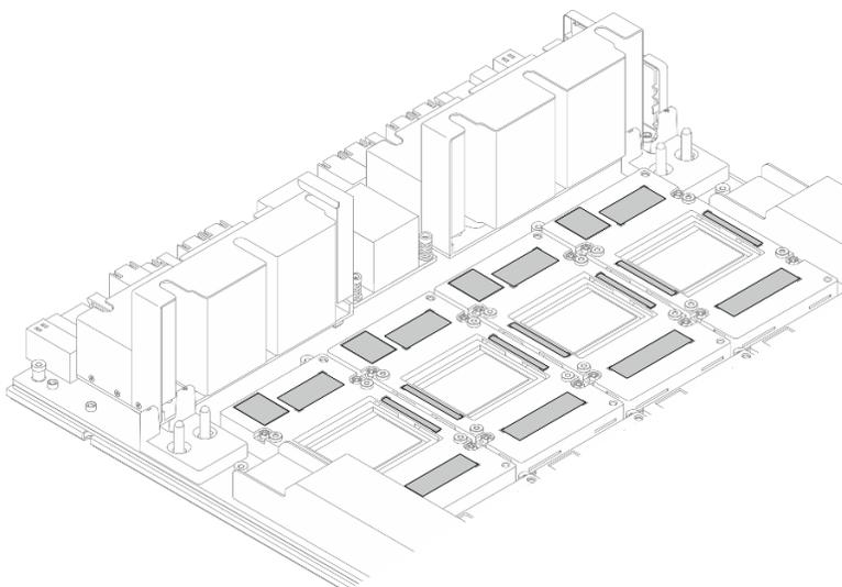
Figure 145. Nettoyage du PCM et des tampons de mastic des GPU
