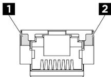
Figure 409. Voyants du Port de gestion du système XCC (RJ-45 10/100/1 000 Mb/s)
