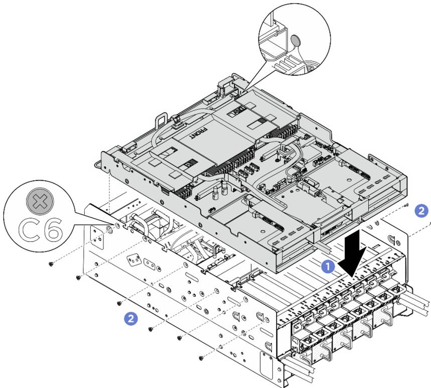
Figure 24. Installation du complexe UC
