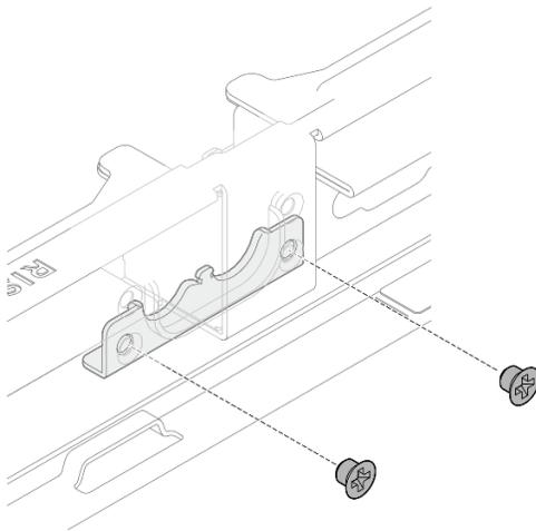
Figure 272. Fixation du support de tuyaux
