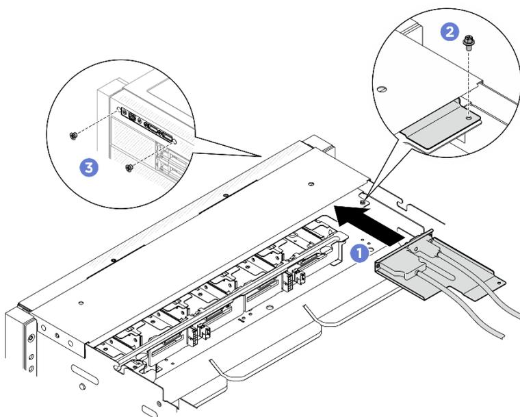
Figure 74. Installation du module d'E-S avant
