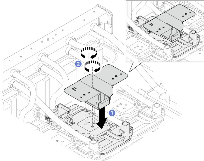
Figure 198. Installation du support de maintenance sur la plaque froide GPU
