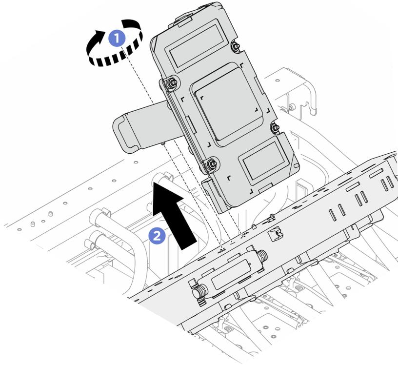
Figure 233. Retrait du support de maintenance et de l'assemblage de plaque froide GPU
