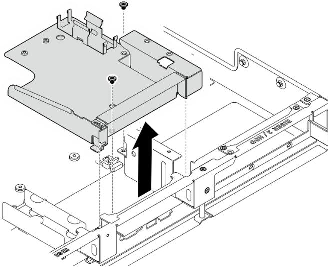
Figure 247. Retrait du support du module de détecteur de fuite
