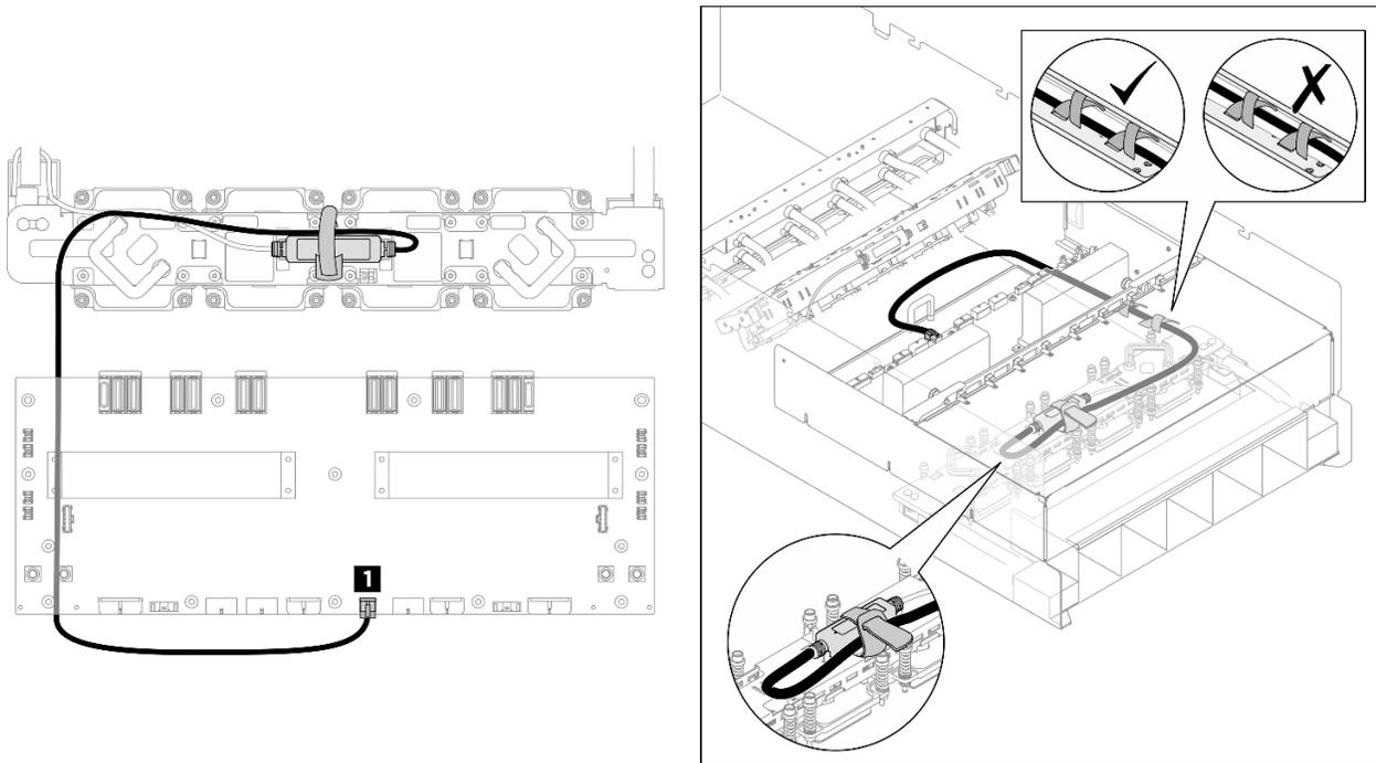
Figure 397. Cheminement des câbles du module de détecteur de fuite NVSwitch
