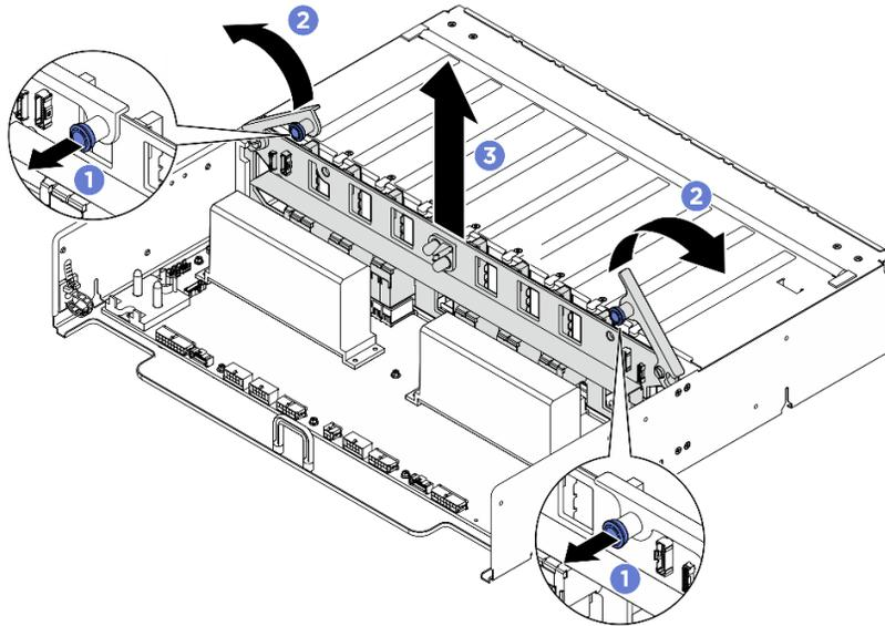
Figure 337. Retrait de l'interposeur du bloc d'alimentation
