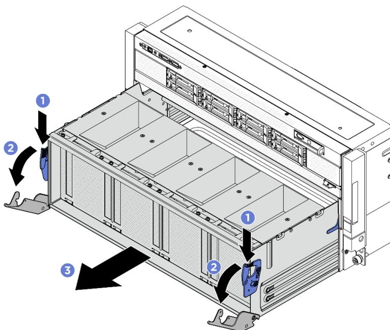
Figure 107. Retrait de la navette de commutation PCIe de la position d'arrêt
