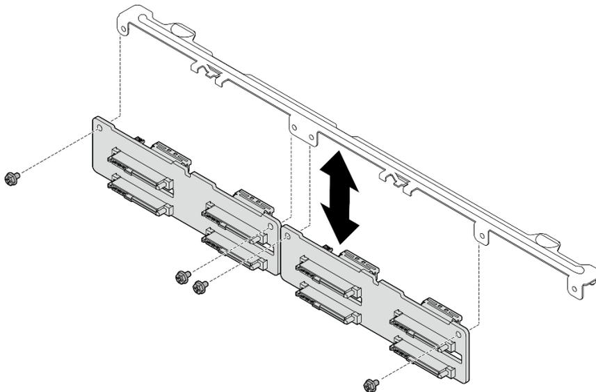
Figure 20. Installation d'un fond de panier d'unité 2,5 pouces avant
