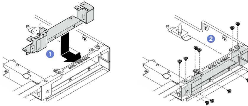
Figure 305. Installation du support de carte mezzanine arrière
