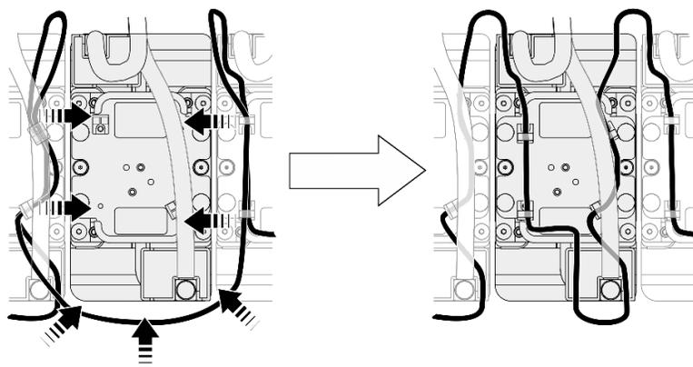
Figure 238. Installation du câble du module de détecteur de fuite
