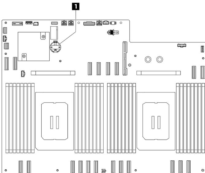
Figure 25. Emplacement de la pile CMOS
