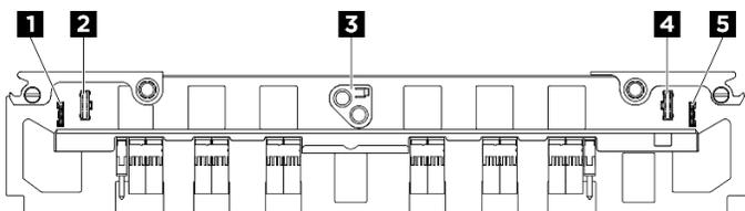
Figure 377. Connecteurs de l'interposeur du PSU
