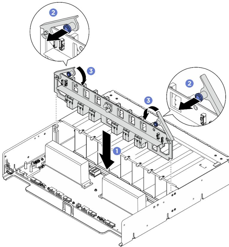
Figure 328. Installation de l'interposeur du bloc d'alimentation
