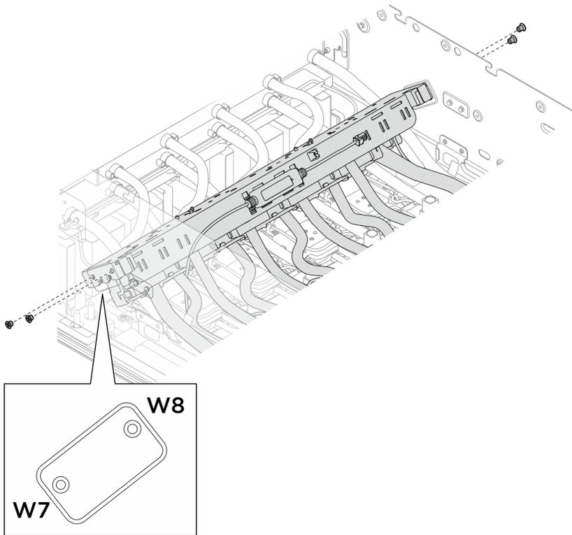
Figure 170. Retrait du collecteur du module de plaque froide GPU H100/H200 arrière
