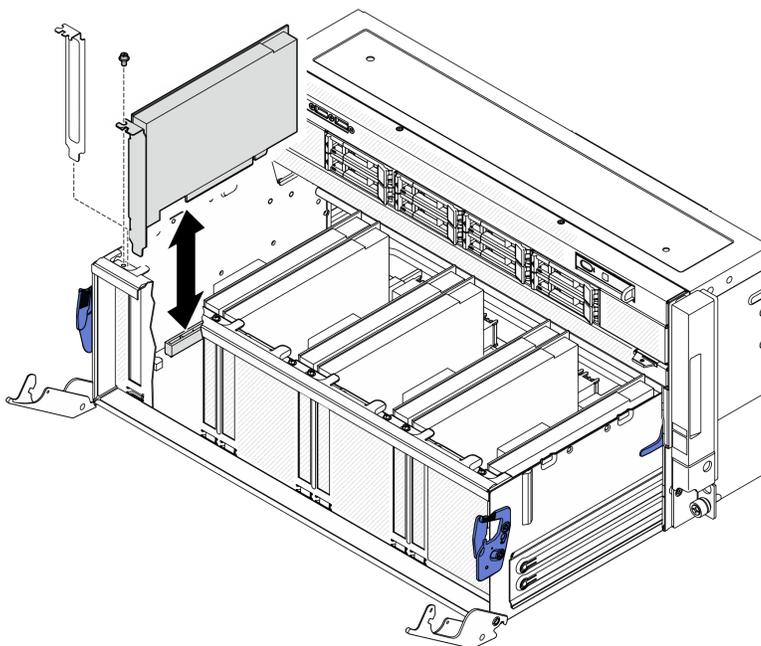
Figure 291. Retrait d'un adaptateur PCIe avant
