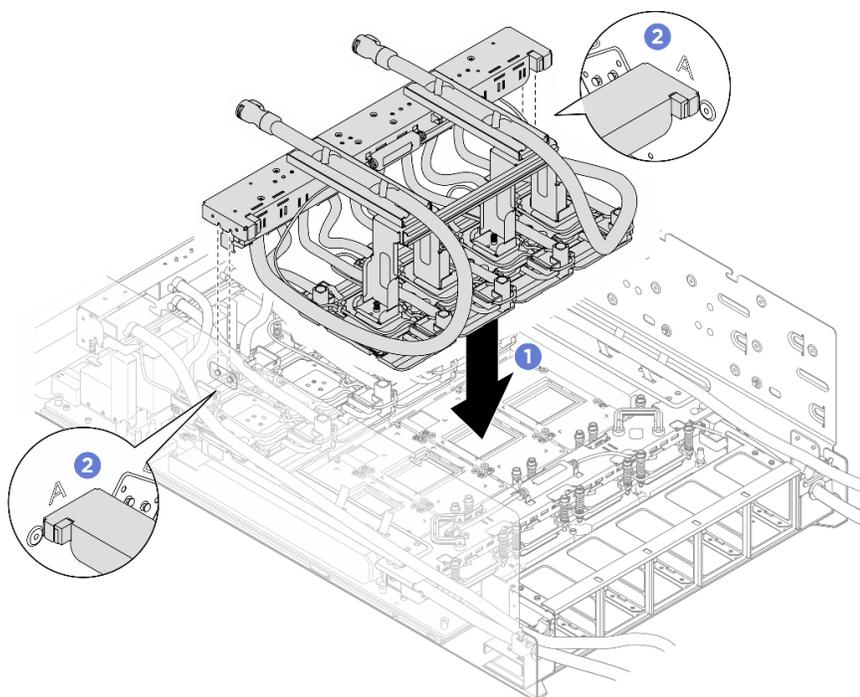
Figure 180. Installation du module de plaque froide GPU H100/H200 arrière
