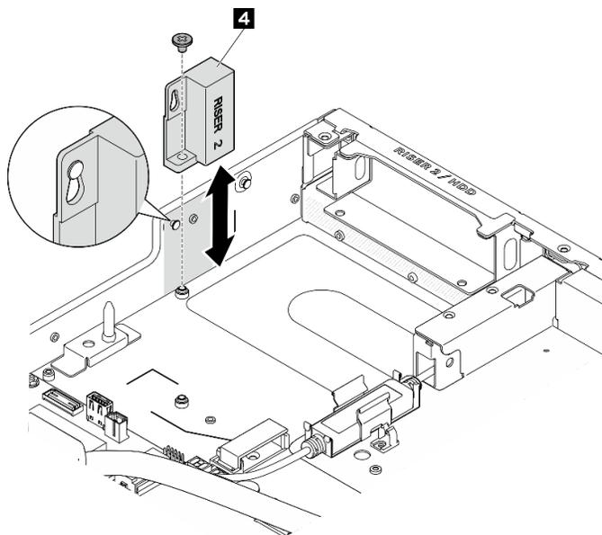
Figure 48. Installation de la grille d'aération DPU sur le châssis
