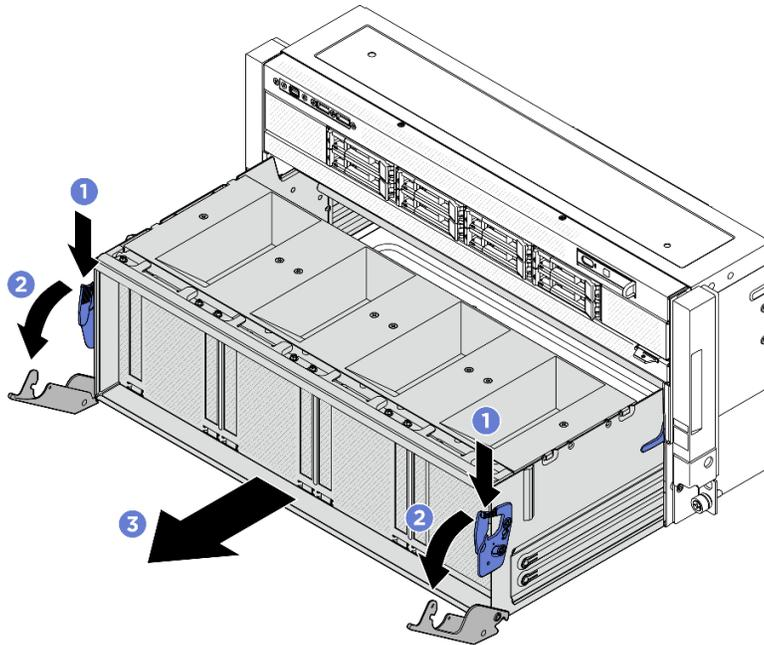
Figure 77. Retrait de la navette de commutation PCIe de la position d'arrêt
