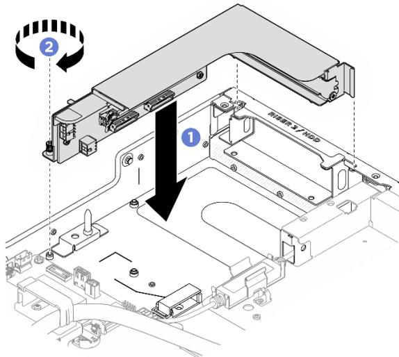
Figure 306. Installation de l'assemblage de cartes mezzanines PCIe dans l'emplacement 2
