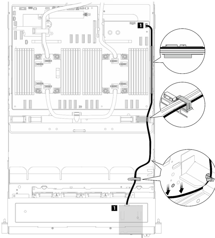
Figure 387. Cheminement des câbles du panneau de diagnostics intégré
