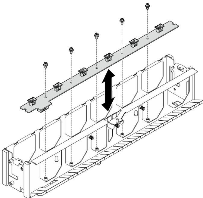
Figure 62. Retrait de la carte de contrôleur de ventilation avant
