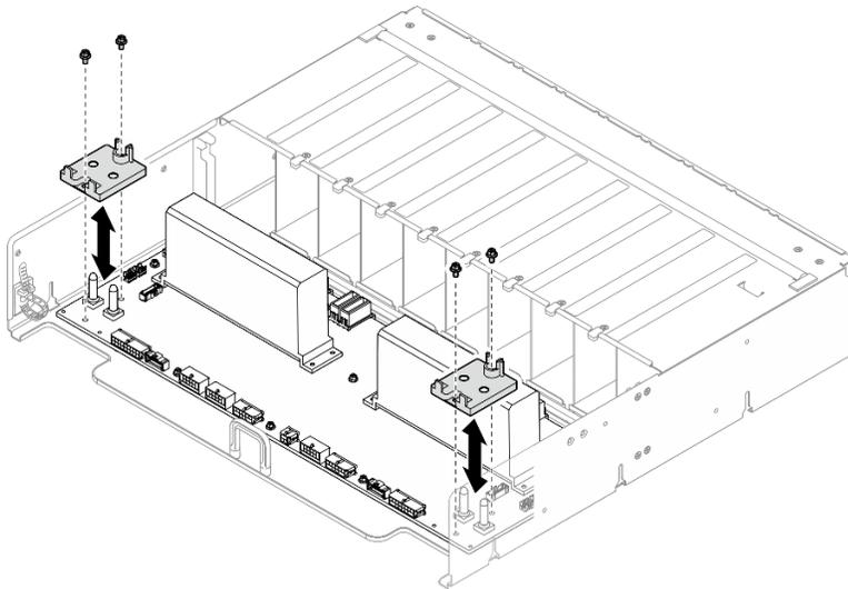
Figure 341. Installation du dispositif de retenue des câbles
