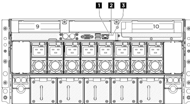
Figure 407. Voyants système au niveau de la vue arrière
