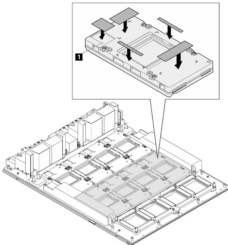
Figure 179. Remplacement des tampons de mastic du GPU
