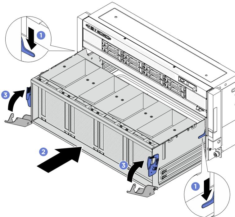
Figure 93. Installation de la navette de commutation PCIe
