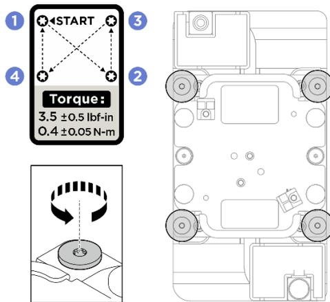
Figure 221. Retrait de la plaque froide GPU
