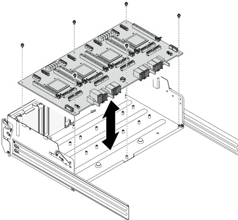
Figure 310. Installation du tableau de commutation PCIe
