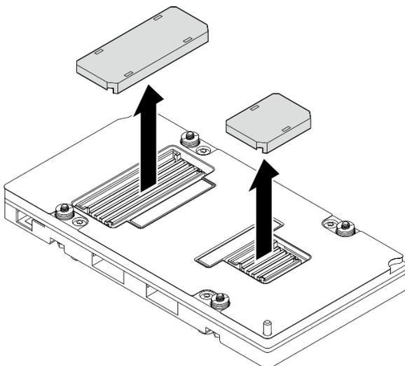
Figure 205. Retrait des caches des connecteurs
