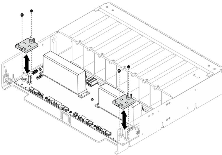
Figure 338. Retrait du dispositif de retenue des câbles
