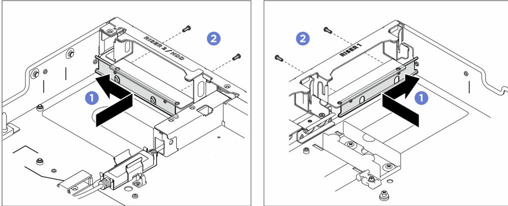
Figure 368. Installation du bloc de ventilation
