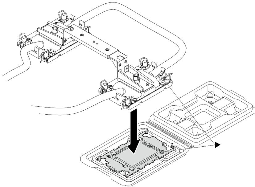
Figure 263. Assemblage du processeur avec la plaque froide
