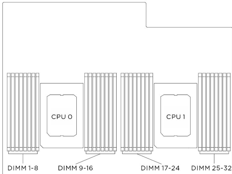
Figure 283. Disposition des modules de mémoire et des processeurs
