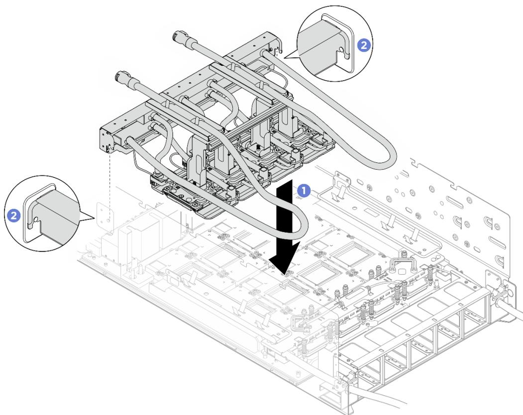
Figure 153. Installation du module de plaque froide GPU H100/H200 avant
