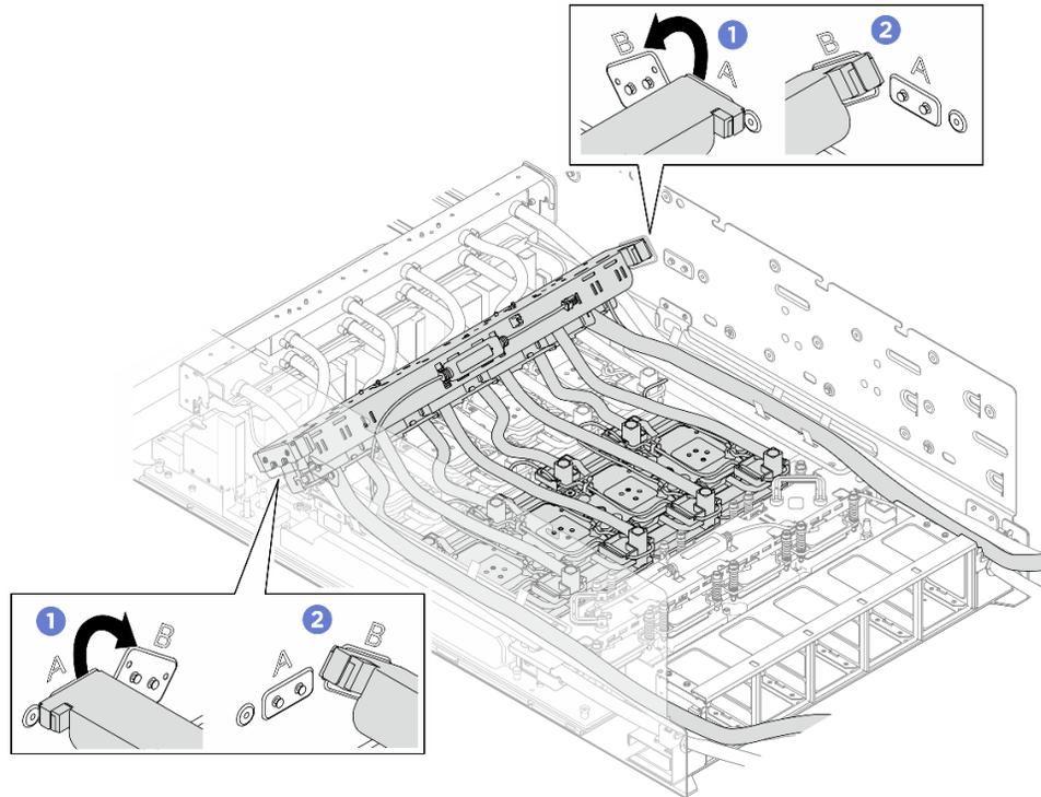
Figure 188. Repositionnement du collecteur du module de plaque froide GPU H100/H200 arrière
