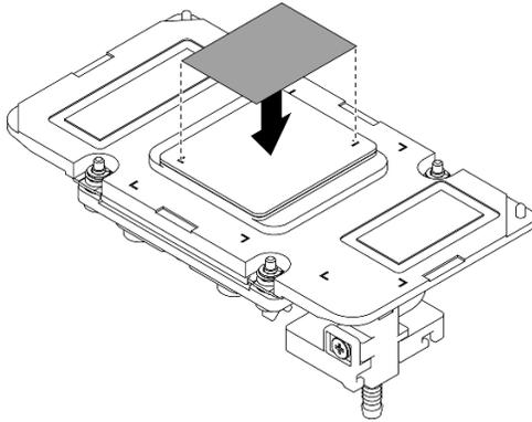
Etape 5. Remplacez les tampons de mastic (5) du GPU.
