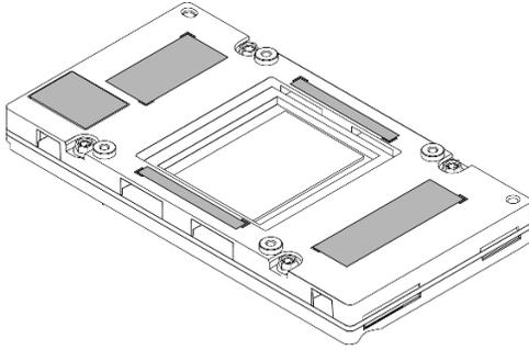
Figure 225. Nettoyage du PCM et des tampons de mastic du GPU
