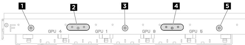
Figure 200. Emplacement d'installation du support de maintenance et de l'assemblage de plaque froide GPU
