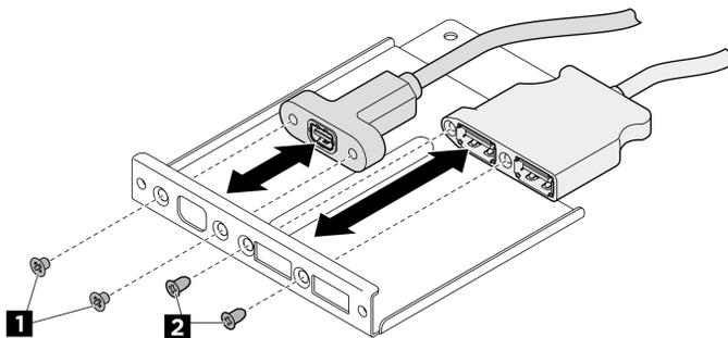
Figure 73. Installation des câbles du module d'E-S avant
