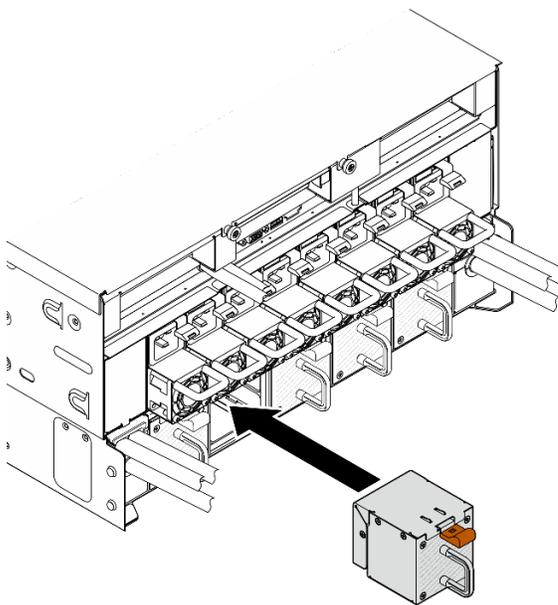
Figure 59. Installation du ventilateur arrière
