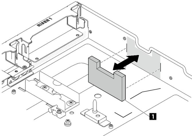
Figure 30. Retrait de la grille d'aération DPU du châssis
