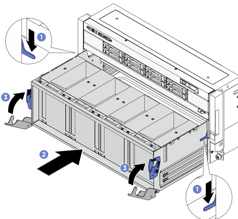
Figure 294. Installation de la navette de commutation PCIe
