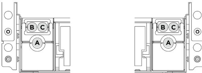
Figure 129. Emplacement du support de tuyaux
