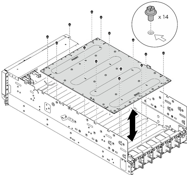
Figure 110. Installation de la plaque d'adaptateur du complexe GPU
