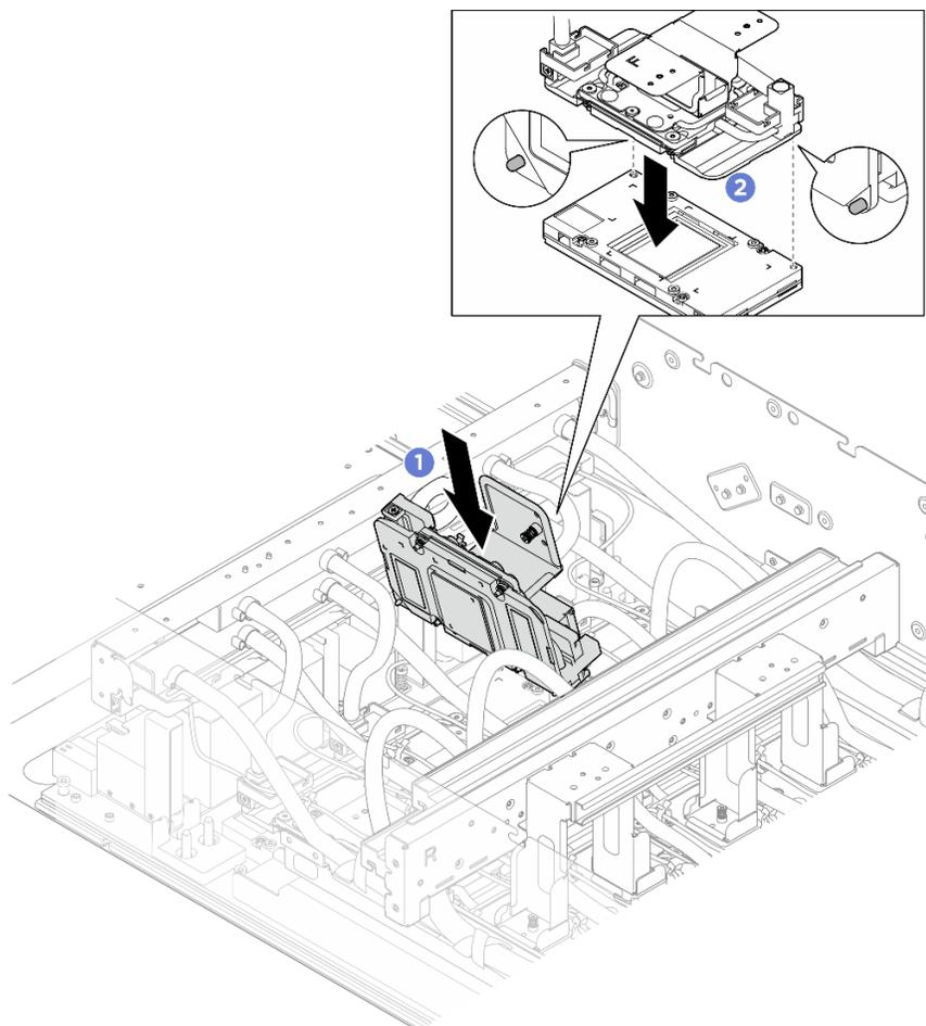
Figure 210. Mise en place de la plaque froide GPU
