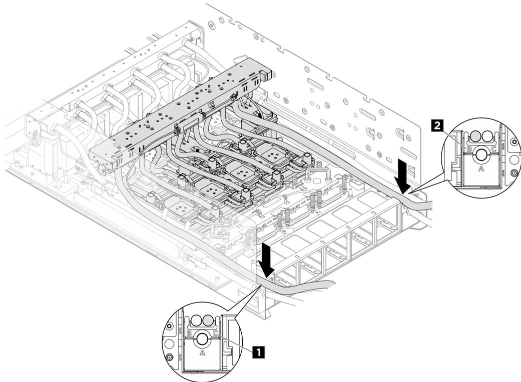
Figure 187. Mise en place des tuyaux sur des supports de tuyaux
