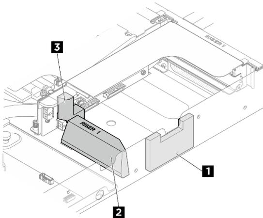
Figure 38. Emplacement de la grille d'aération DPU dans l'emplacement de carte mezzanine 1
