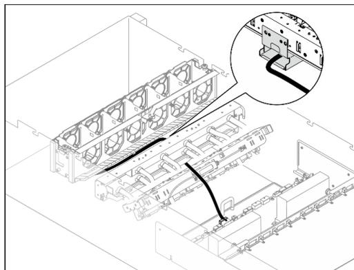
Figure 383. Cheminement des câbles de la carte de contrôleur de ventilation avant
