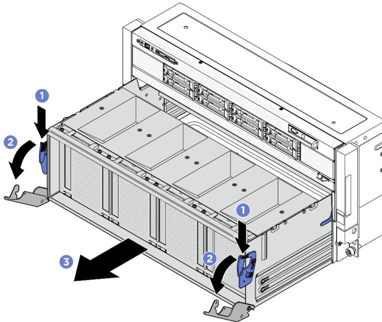
Figure 94. Retrait de la navette de commutation PCIe de la position d'arrêt
