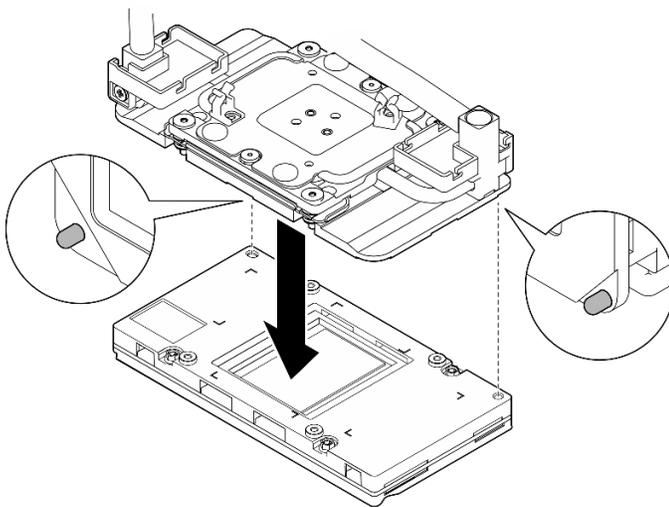
Figure 156. Réglage des plaques froides GPU
