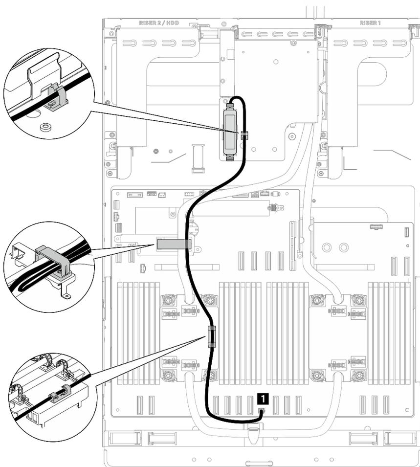
Figure 400. Cheminement des câbles du module de détecteur de fuite DWCM
