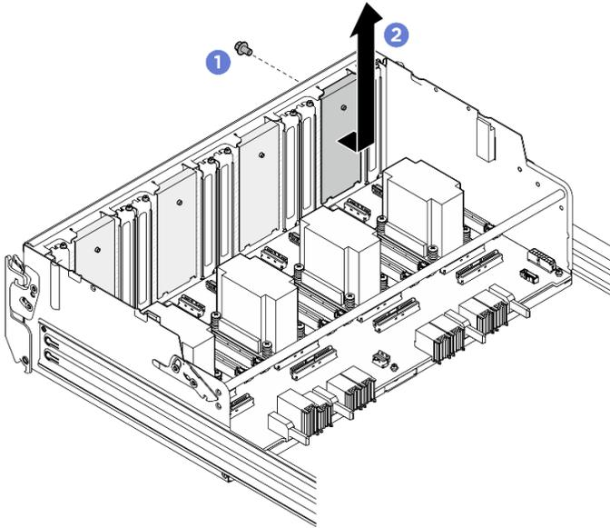
Figure 369. Retrait du bloc de ventilation
