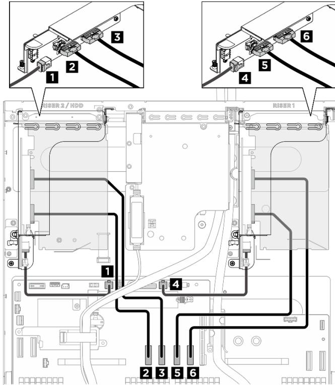
Figure 395. Cheminement des câbles de la carte mezzanine PCIe
