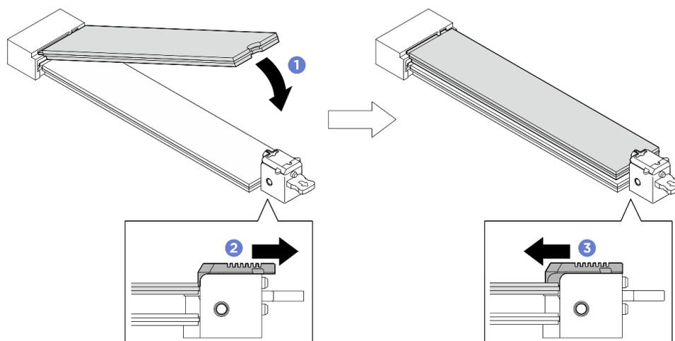
Figure 282. Installation de l'unité M.2 supérieure
