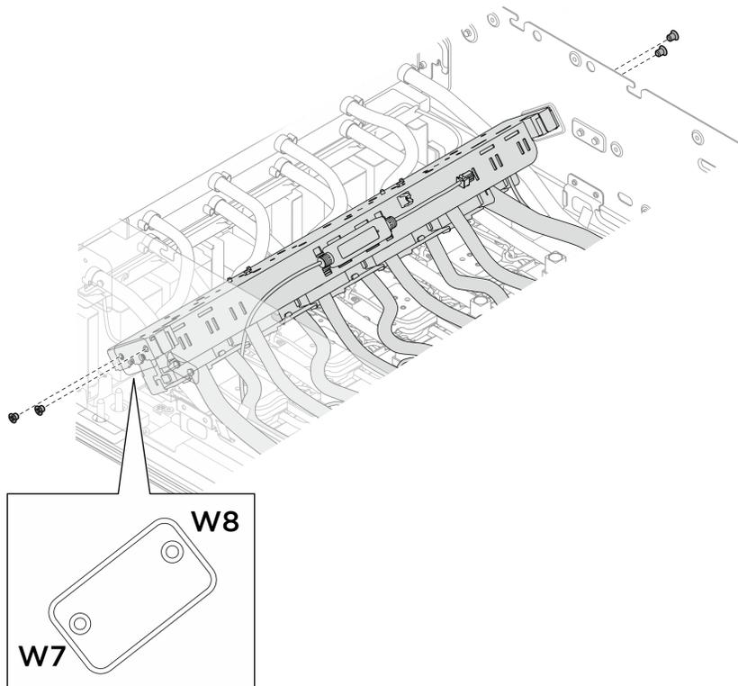
Figure 194. Retrait du collecteur du module de plaque froide GPU H100/H200 arrière
