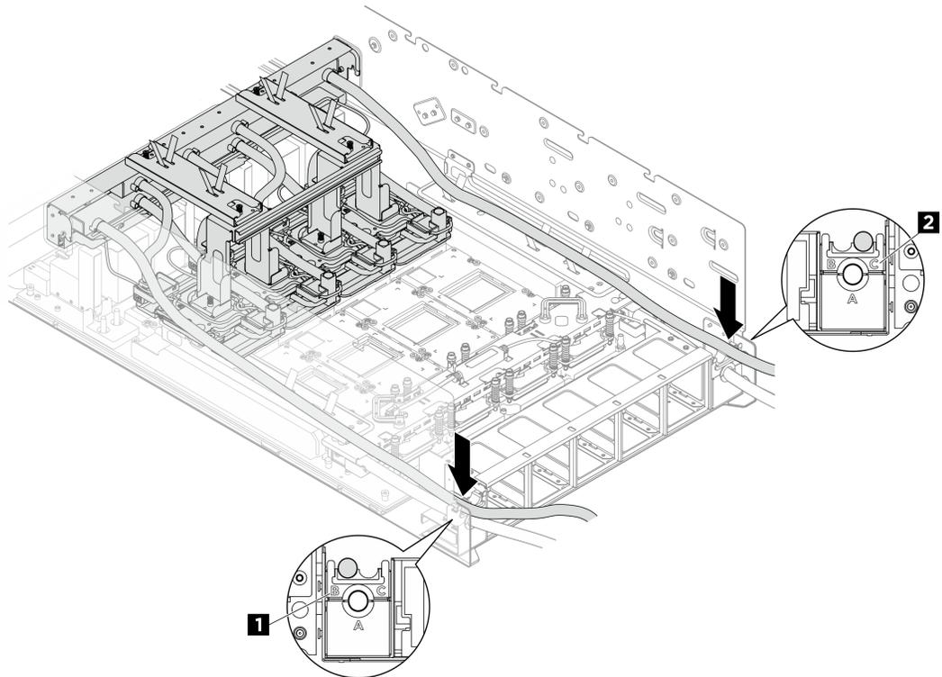
Figure 161. Mise en place des tuyaux sur des supports de tuyaux
