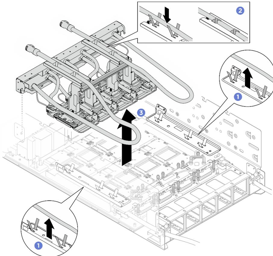
Figure 144. Retrait du module de plaque froide GPU H100/H200 avant
