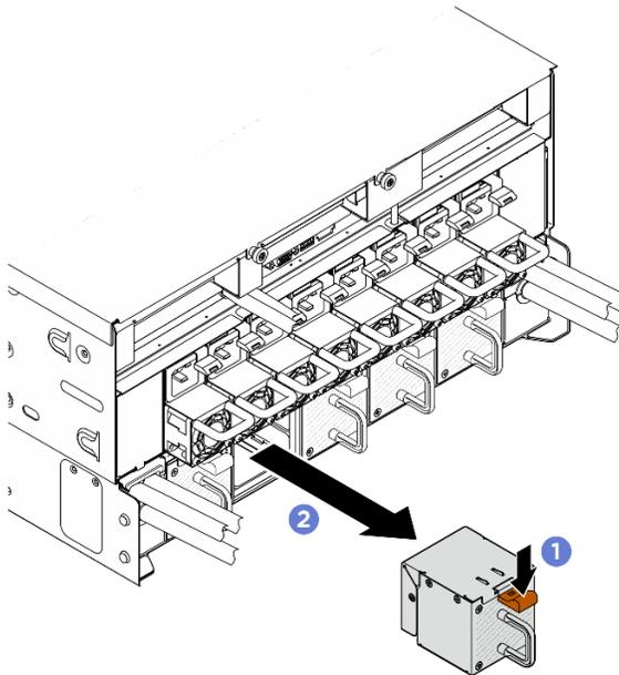
Figure 57. Retrait du ventilateur arrière
