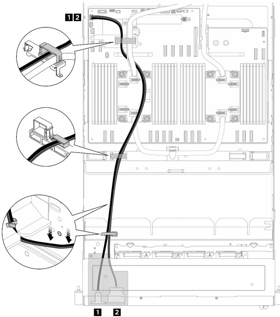
Figure 386. Cheminement des câbles du module d'E-S avant
