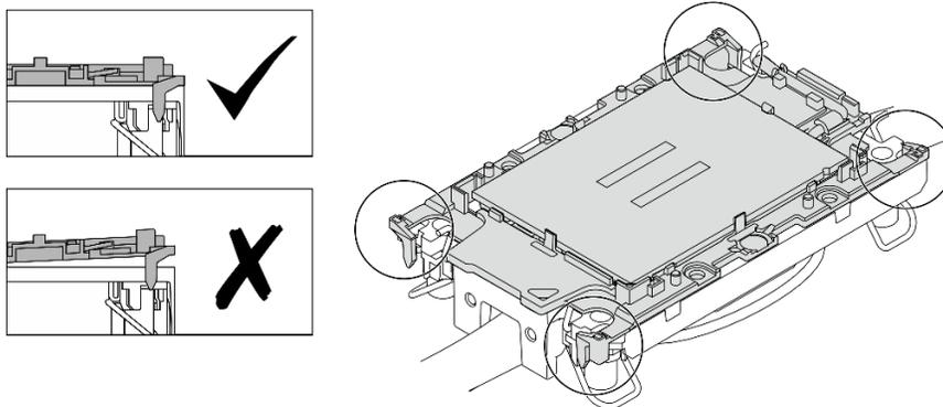
Figure 264. Inspection du processeur avec la plaque froide
