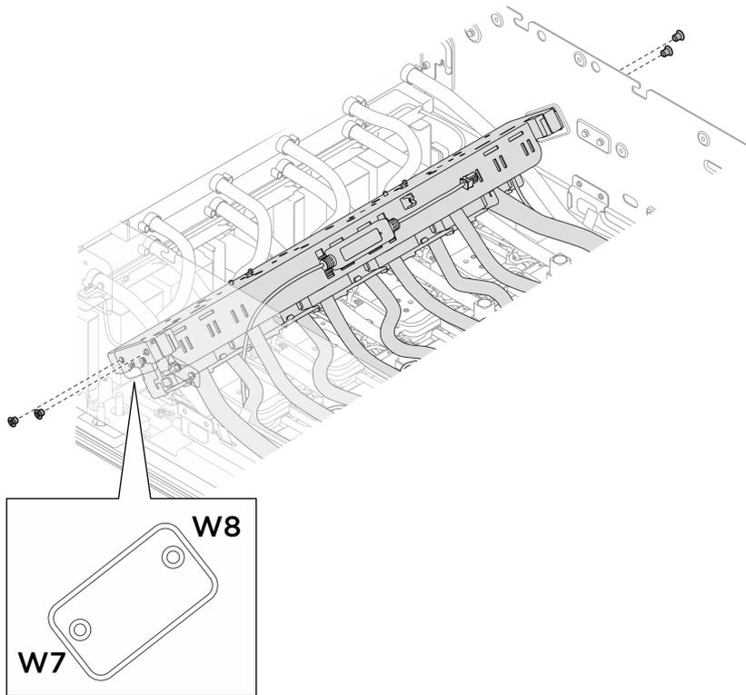
Figure 216. Installation du collecteur du module de plaque froide GPU H100/H200 arrière
