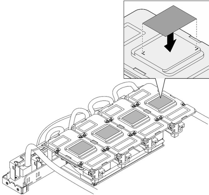
Figure 178. Application d'un PCM
