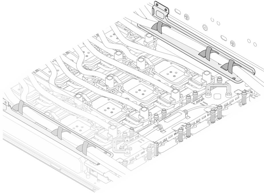
Figure 186. Fixation des tuyaux et des câbles à l'aide de colliers de serrage
