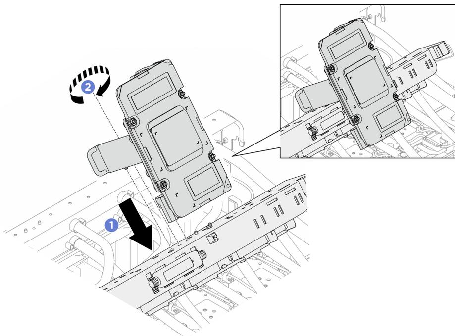
Figure 223. Installation du support de maintenance et de l'assemblage de plaque froide GPU
