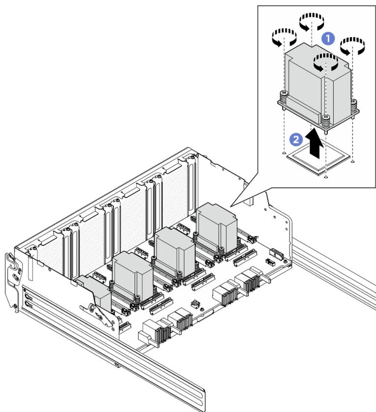
Figure 308. Retrait du dissipateur thermique du tableau de commutation PCIe
