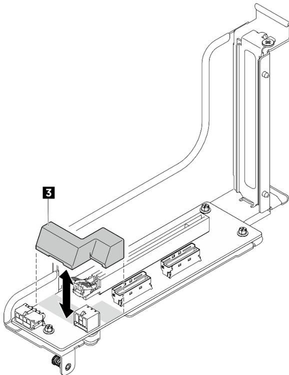
Figure 47. Installation de la grille d'aération DPU sur la carte mezzanine PCIe
