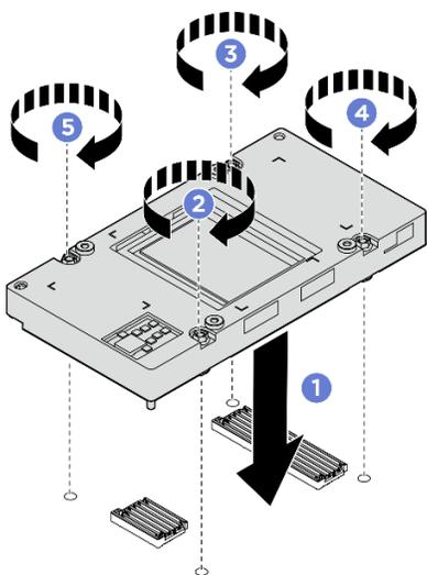
Figure 206. Installation du GPU
