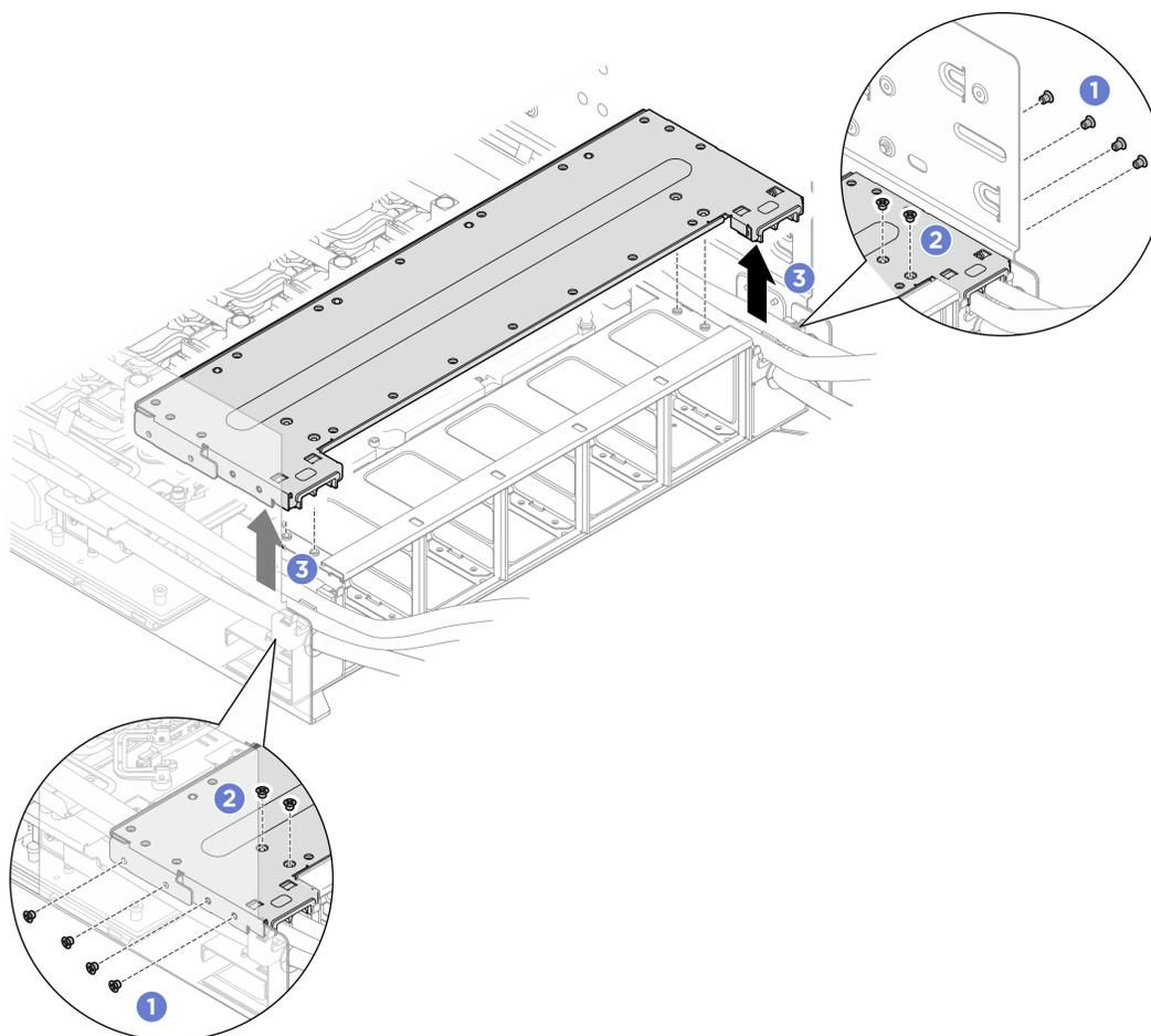
Figure 168. Retrait du support du boîtier de ventilation arrière
