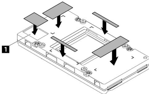
Figure 232. Remplacement des tampons de mastic du GPU
