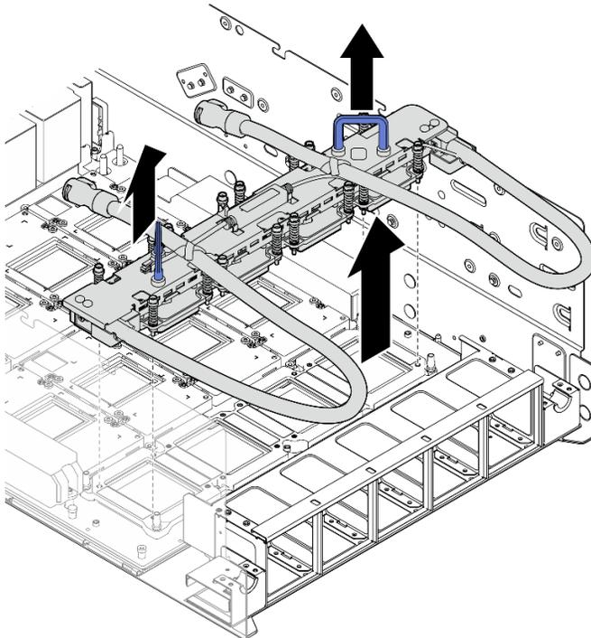
Figure 121. Retrait du module de plaque froide NVswitch
