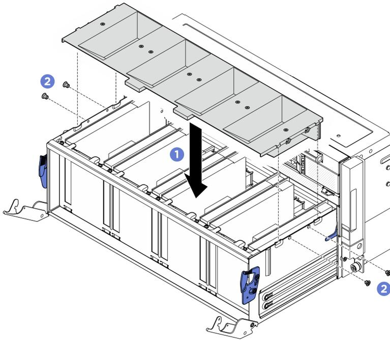
Figure 318. Installation de la grille d'aération
