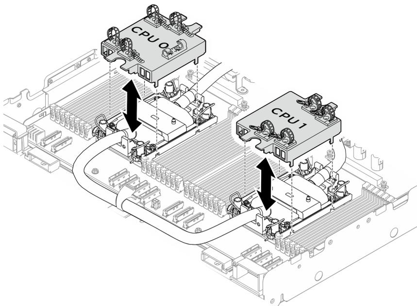
Figure 267. Installation des couvercles de la plaque froide
