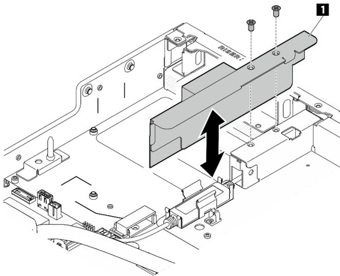
Figure 45. Installation de l'assemblage de grille d'aération DPU et de support
