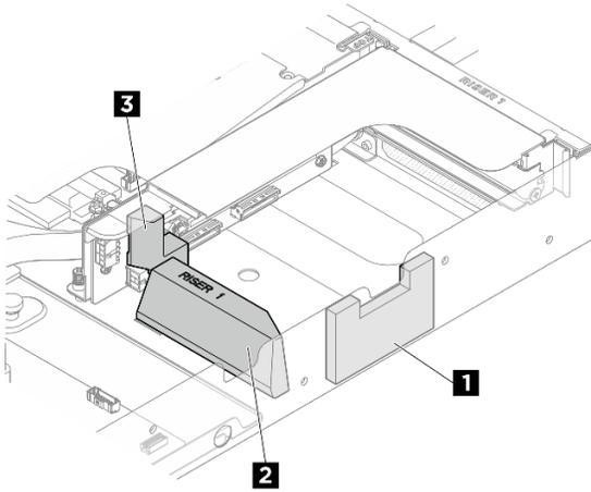
Figure 29. Emplacement de la grille d'aération DPU dans l'emplacement de carte mezzanine 1
