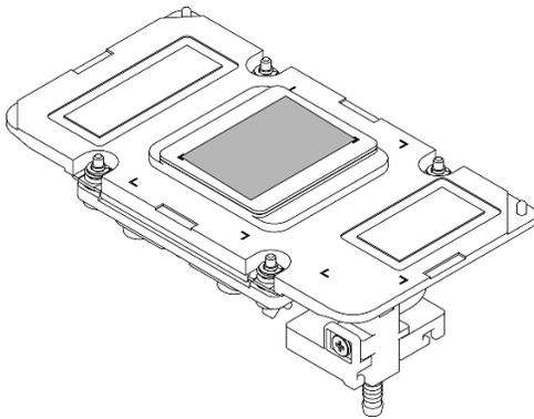
Figure 226. Essuyage du PCM et des tampons de mastic de la plaque froide
