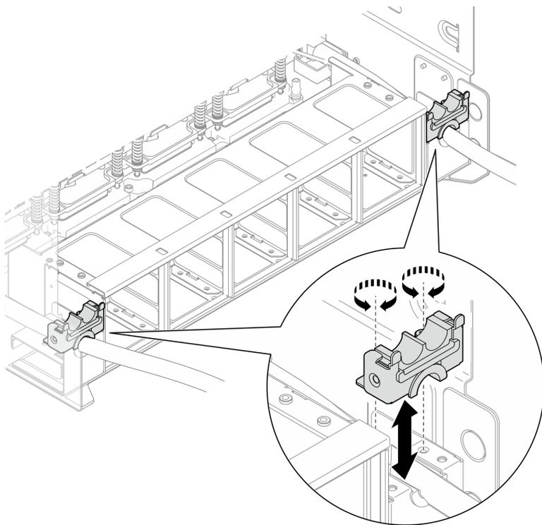
Figure 116. Retrait du support de tuyaux B/C
