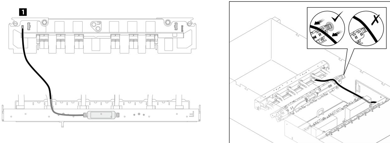
Figure 398. Cheminement des câbles du module de détecteur de fuite GPU avant
