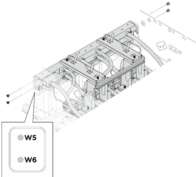
Figure 154. Installation du collecteur du module de plaque froide GPU H100/H200 avant
