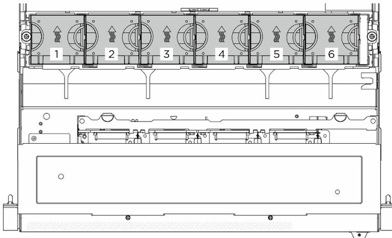
Figure 54. Numéros des ventilateurs avant
