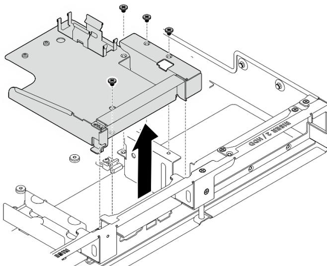
Figure 246. Retrait du support du module de détecteur de fuite
