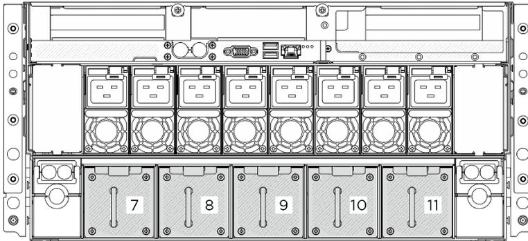
Figure 58. Numéros des ventilateurs arrière
