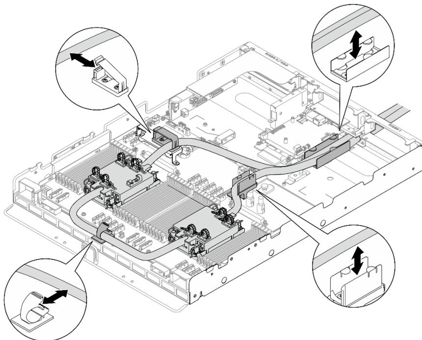
Figure 268. Installation des tuyaux et du module
