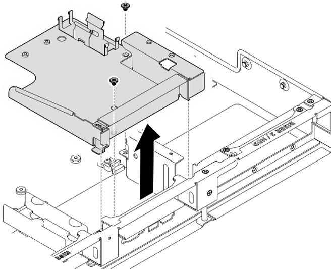
Figure 347. Retrait du support du module de détecteur de fuite
