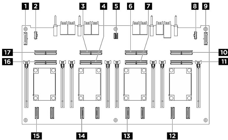
Figure 375. Connecteurs du tableau de commutation PCIe
