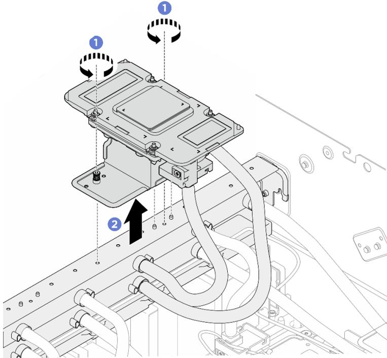
Figure 209. Retrait du support de maintenance et de l'assemblage de plaque froide GPU
