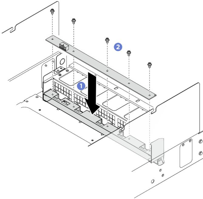
Figure 68. Installation de la carte de contrôleur de ventilation arrière
