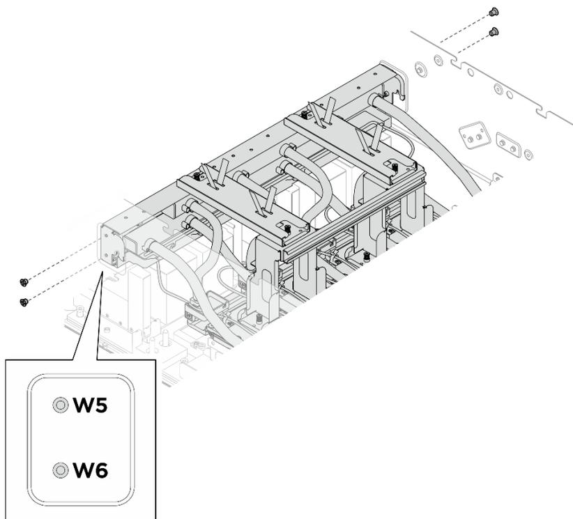
Figure 143. Retrait du collecteur du module de plaque froide GPU H100/H200 avant
