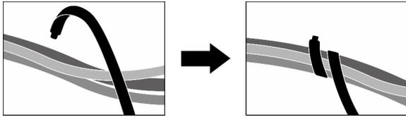
Figure 382. Fixation des câbles à l'aide d'attaches de câbles
