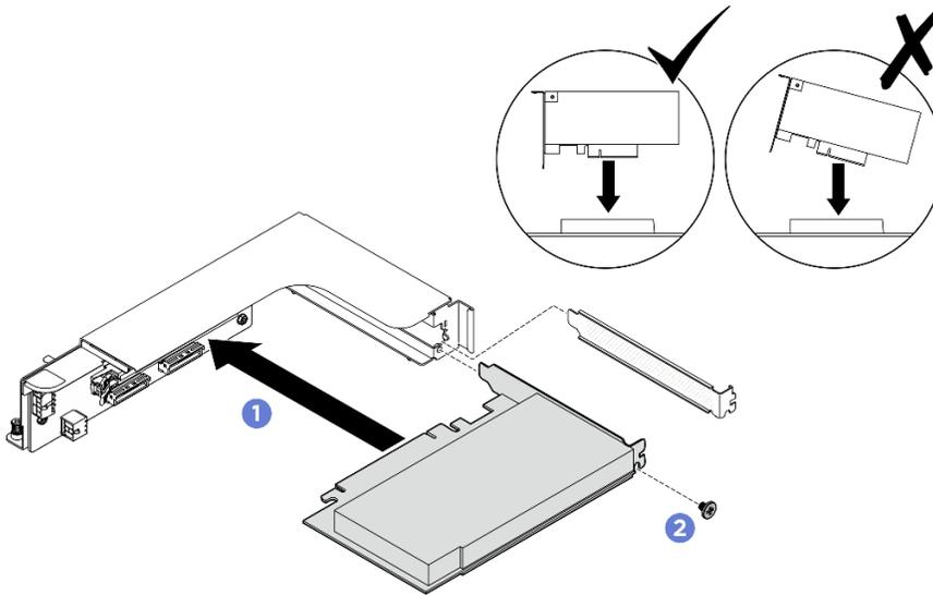
Figure 296. Installation d'un adaptateur PCIe arrière
