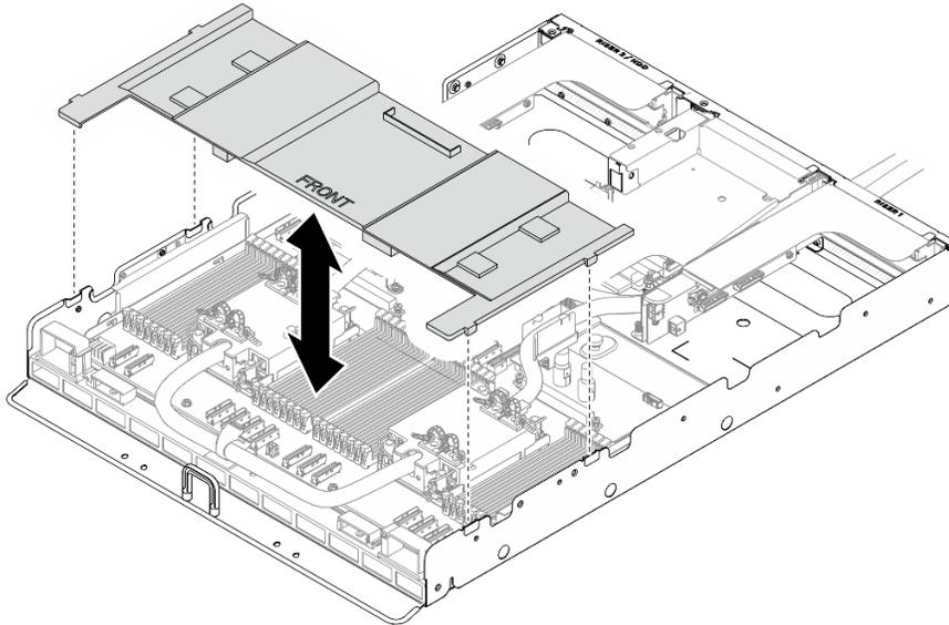
Figure 335. Installation de la grille d'aération du processeur
