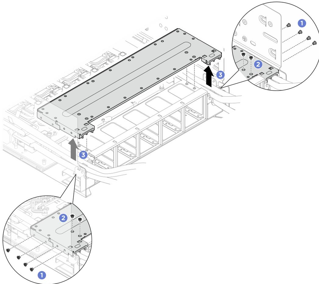
Figure 115. Retrait du support du boîtier de ventilation arrière
