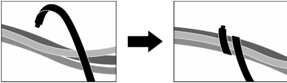
Figure 388. Fixation des câbles à l'aide d'attaches de câbles
