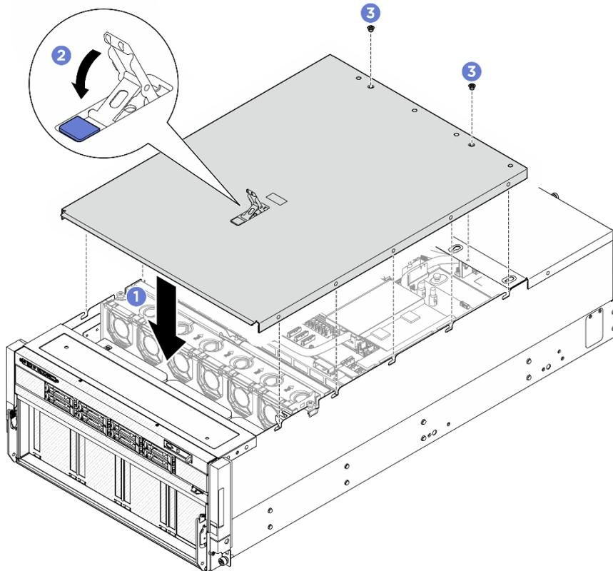
Figure 5. Installation du carter supérieur avant
