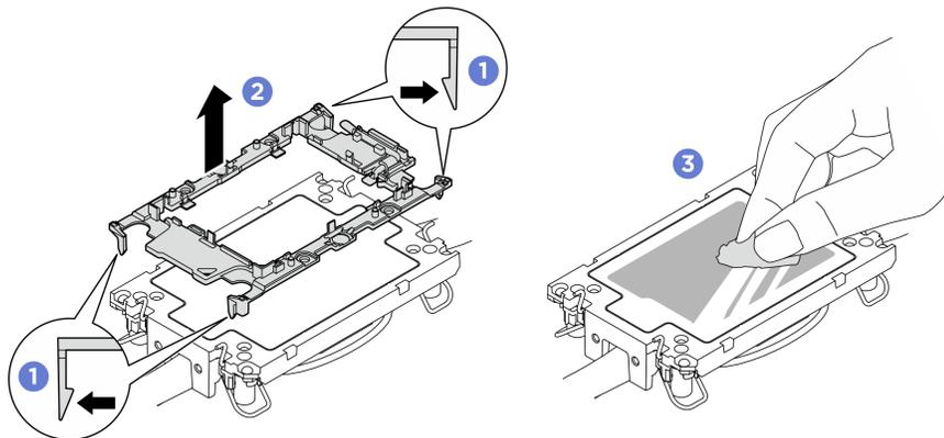
Figure 260. Séparation d'un support de processeur de la plaque froide
