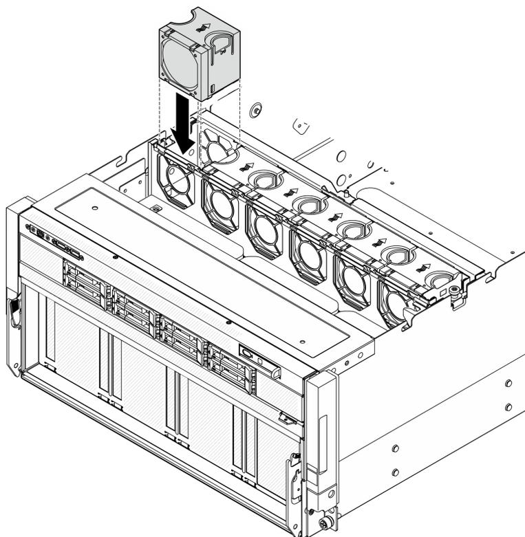
Figure 55. Installation de ventilateur avant
