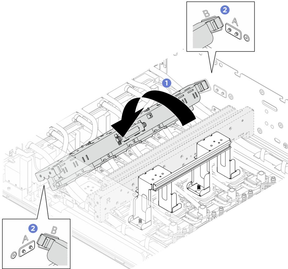
Figure 215. Repositionnement du collecteur du module de plaque froide GPU H100/H200 arrière
