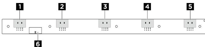
Figure 373. Connecteur de la carte de contrôleur de ventilation arrière
