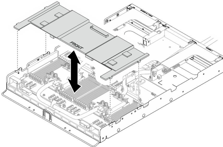
Figure 334. Retrait de la grille d'aération du processeur
