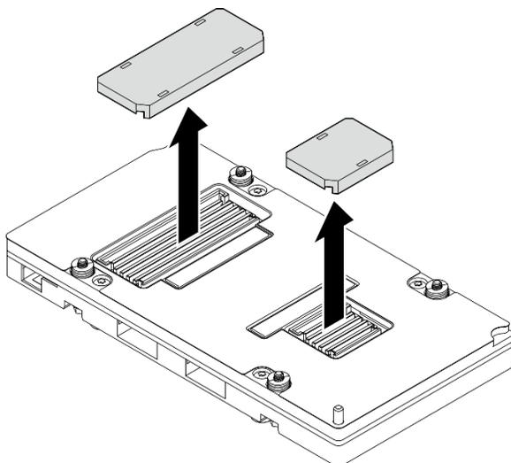
Figure 229. Retrait des caches des connecteurs
