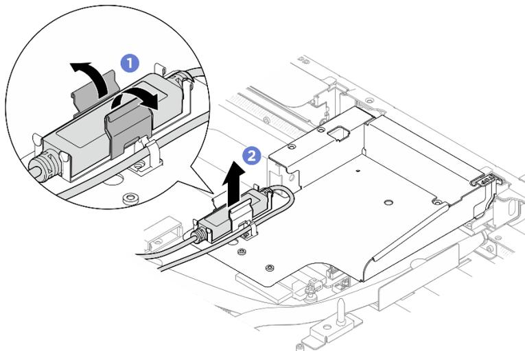
Figure 250. Dégagement du module de détecteur de fuite
