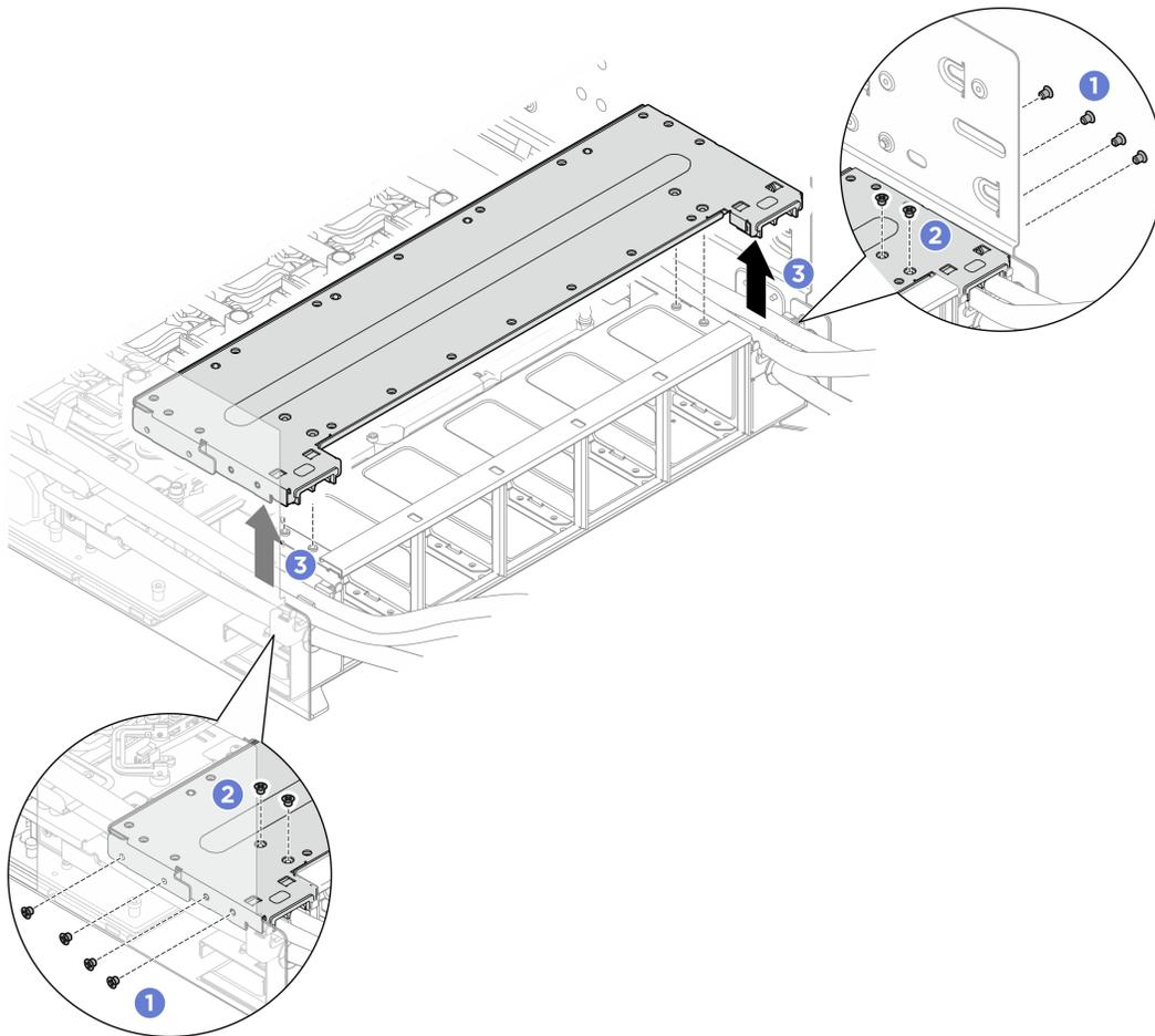
Figure 66. Retrait du support du boîtier de ventilation arrière
