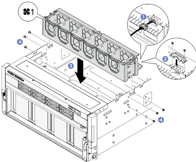
Figure 52. Installation du boîtier de ventilation
