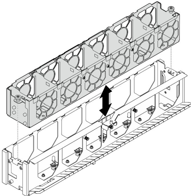
Figure 64. Installation du boîtier de ventilation interne
