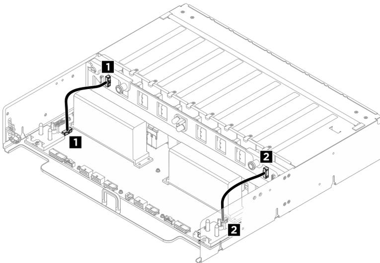
Figure 393. Cheminement des câbles de l'interposeur du PSU vers le tableau de distribution
