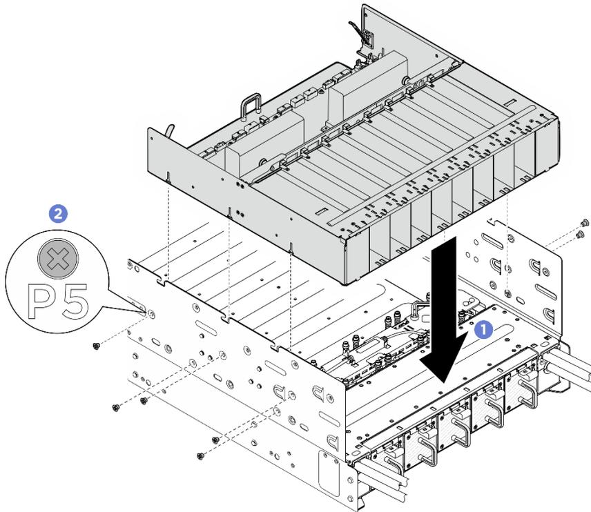
Figure 343. Installation du complexe d'alimentation
