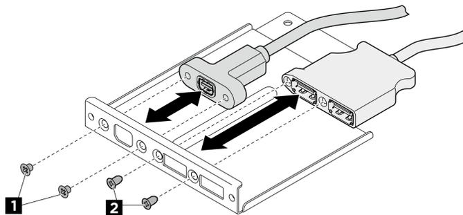
Figure 72. Retrait des câbles du module d'E-S avant
