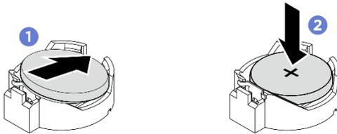
Figure 28. Installation de la pile CMOS
