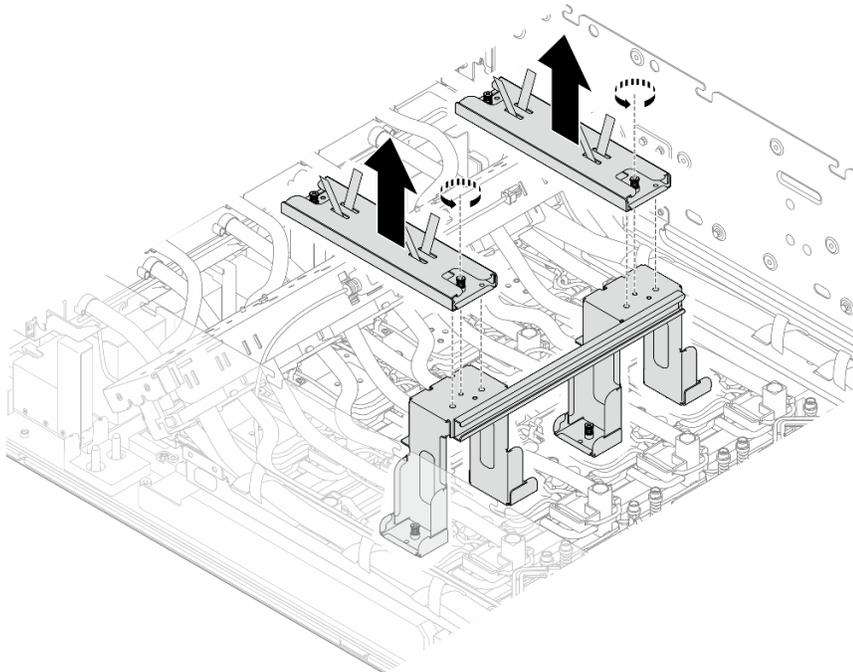
Figure 193. Retrait des poignées des supports de transport
