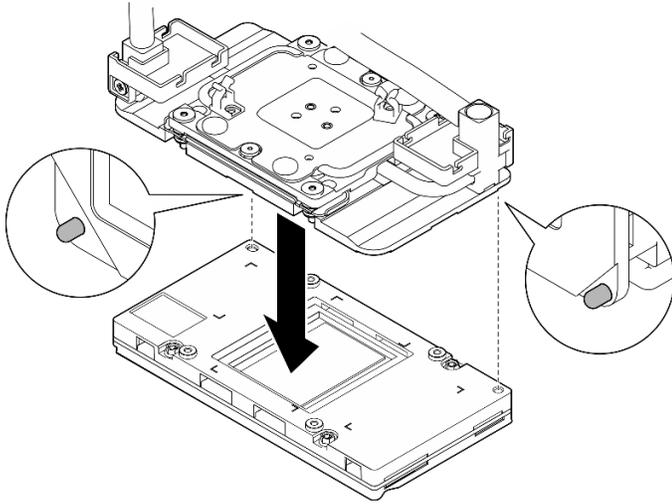
Figure 182. Réglage des plaques froides GPU
