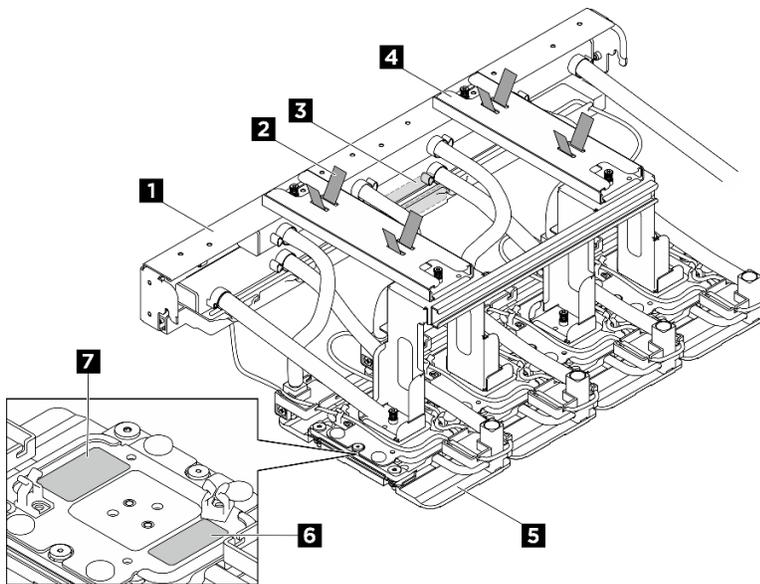
Figure 136. Identification des composants du module de plaque froide GPU H100/H200 avant
