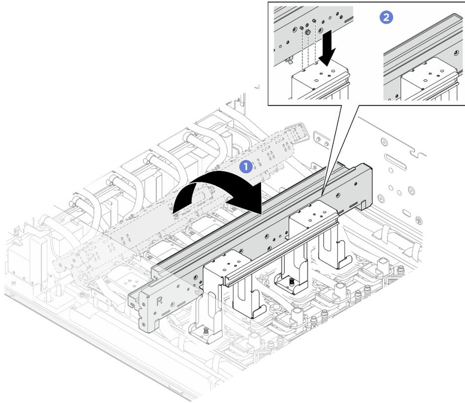
Figure 195. Repositionnement du collecteur du module de plaque froide GPU arrière
