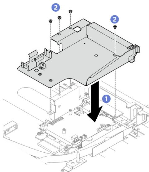
Figure 274. Installation du support du module de détecteur de fuite
