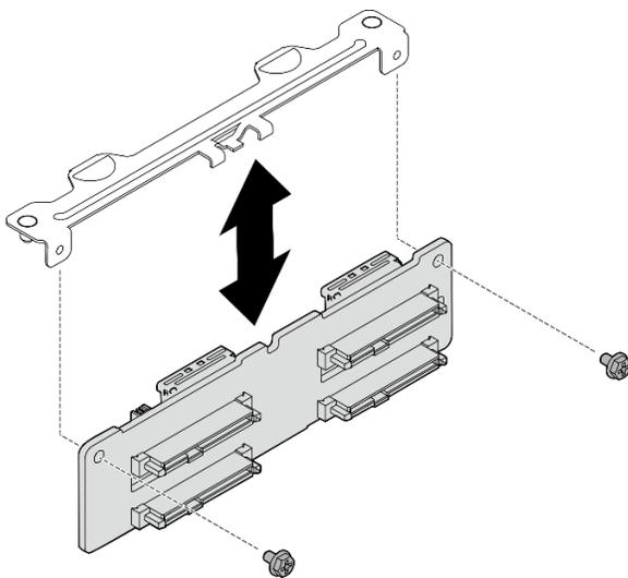
Figure 353. Installation du fond de panier d'unité 2,5 pouces arrière
