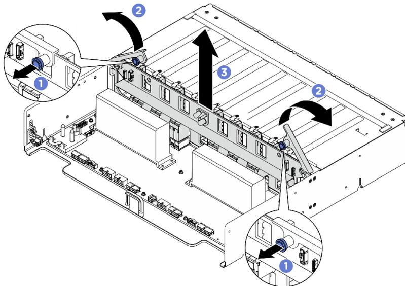
Figure 323. Retrait de l'interposeur du bloc d'alimentation
