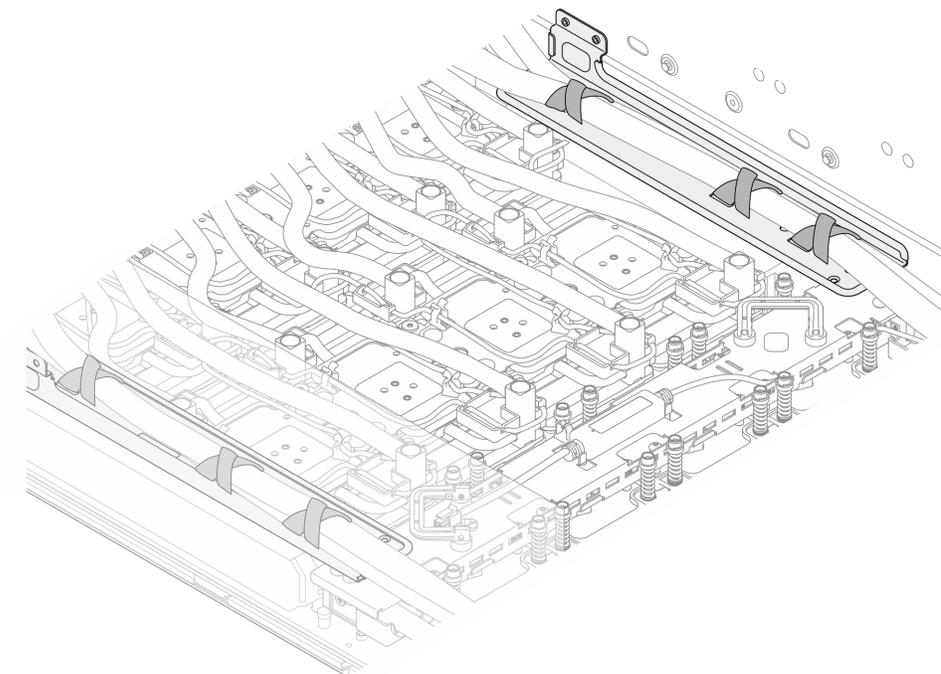
Etape 6. Desserrez les trois vis M3 qui fixent le guide-tuyau au châssis et au collecteur ; retirez ensuite le guide-tuyau. Répétez l'opération pour retirer le guide-tuyau de l'autre côté.
