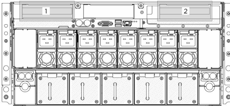
Figure 297. Emplacements des cartes mezzanines PCIe
