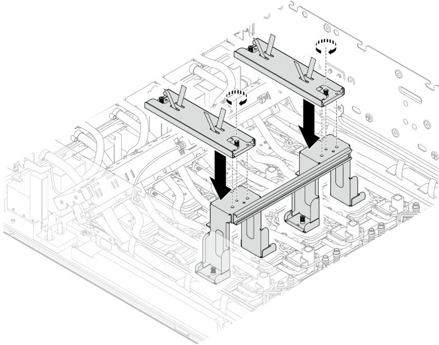
Figure 217. Installation des poignées
