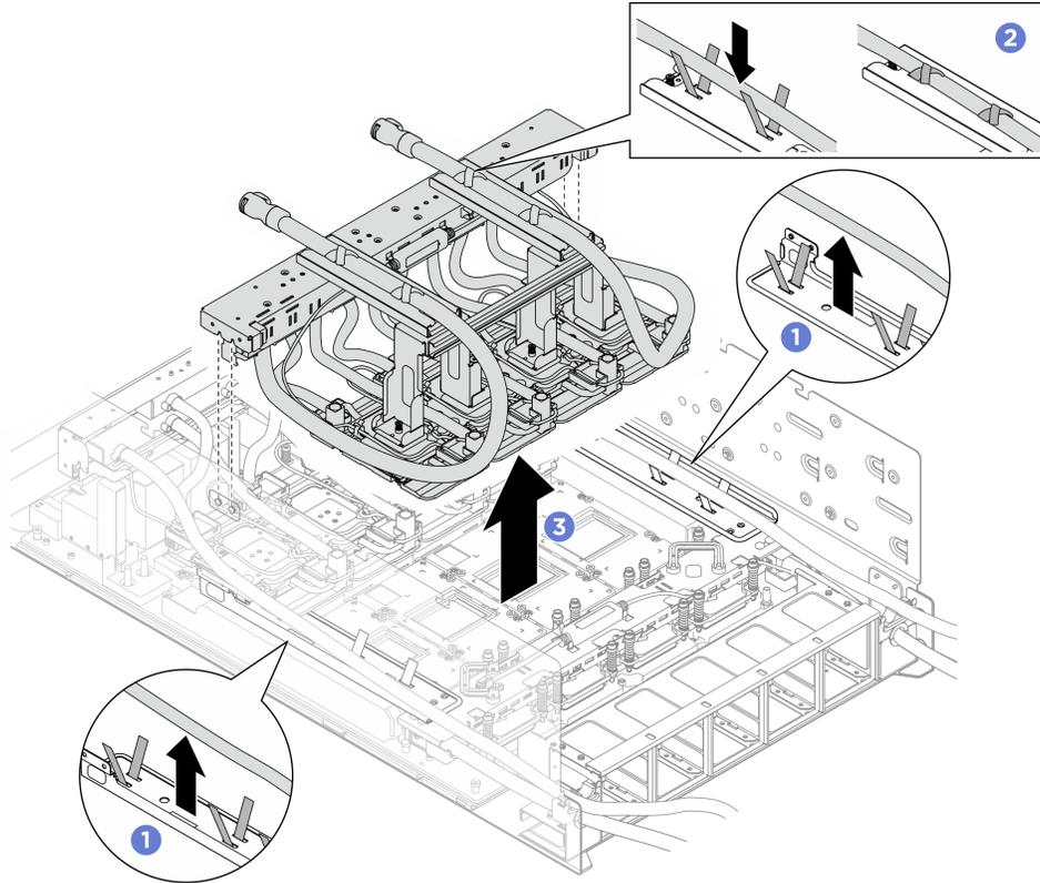
Figure 173. Retrait du module de plaque froide GPU H100/H200 arrière
