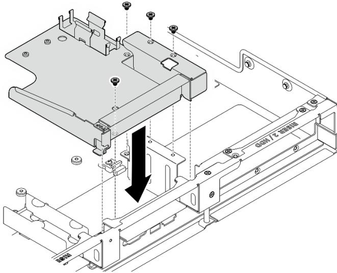
Figure 248. Installation du support du module de détecteur de fuite
