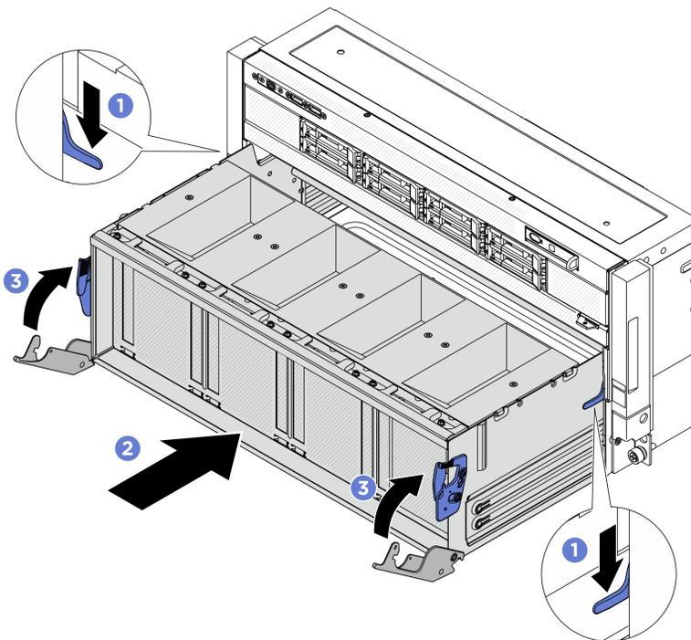
Figure 106. Installation de la navette de commutation PCIe
