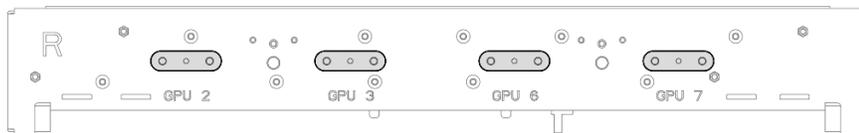
Figure 224. Emplacement d'installation du support de maintenance et de l'assemblage de plaque froide GPU
