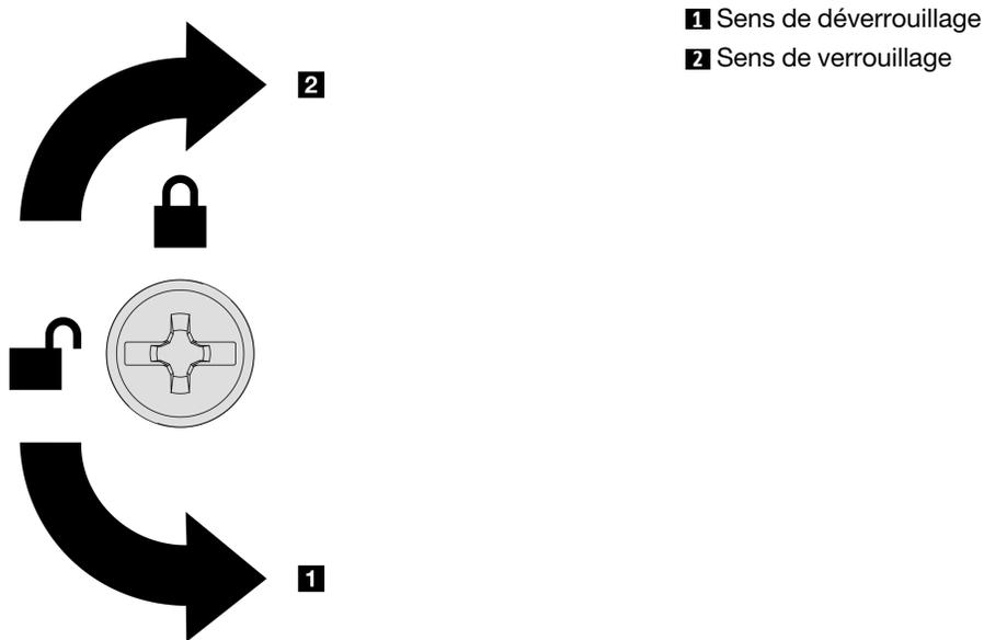
Figure 3. Sens de verrouillage/déverrouillage du carter supérieur avant
