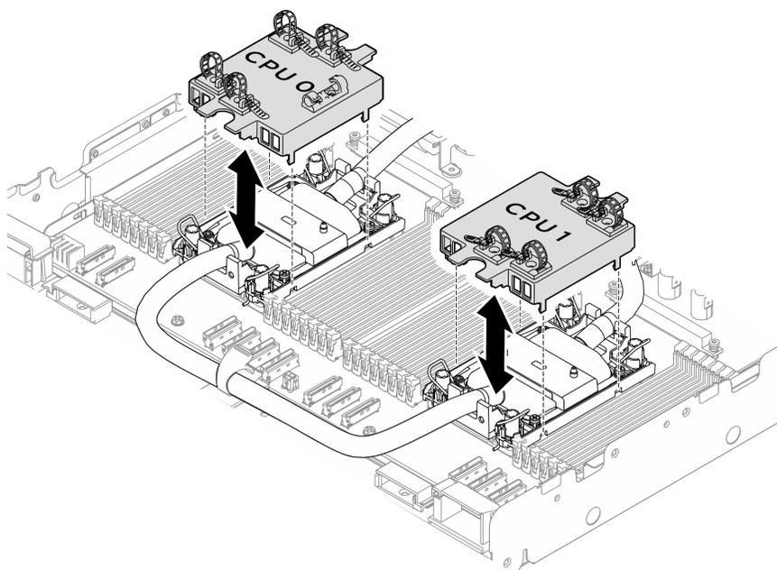
Figure 257. Retrait des couvercles supérieurs de la plaque froide
