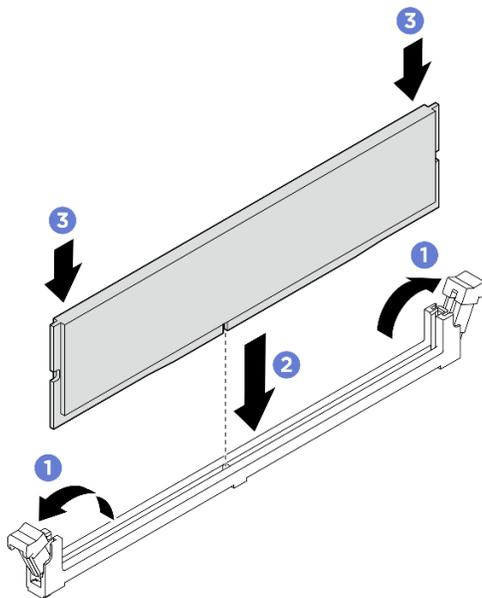
Figure 286. Installation du module de mémoire
