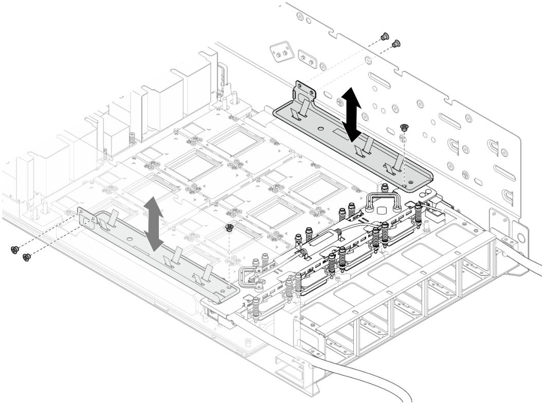
Figure 118. Retrait des guide-tuyaux
