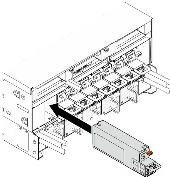
Figure 333. Installation du bloc d'alimentation
