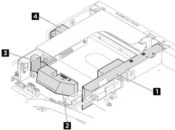
Figure 33. Emplacement de la grille d'aération DPU dans l'emplacement de carte mezzanine 2
