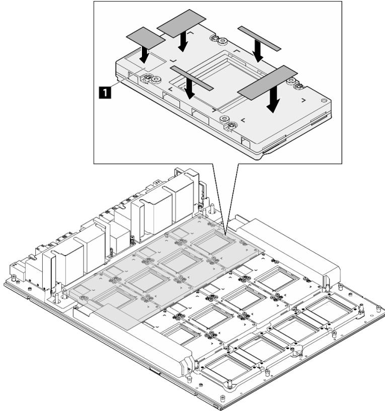
Figure 152. Remplacement des tampons de mastic du GPU
