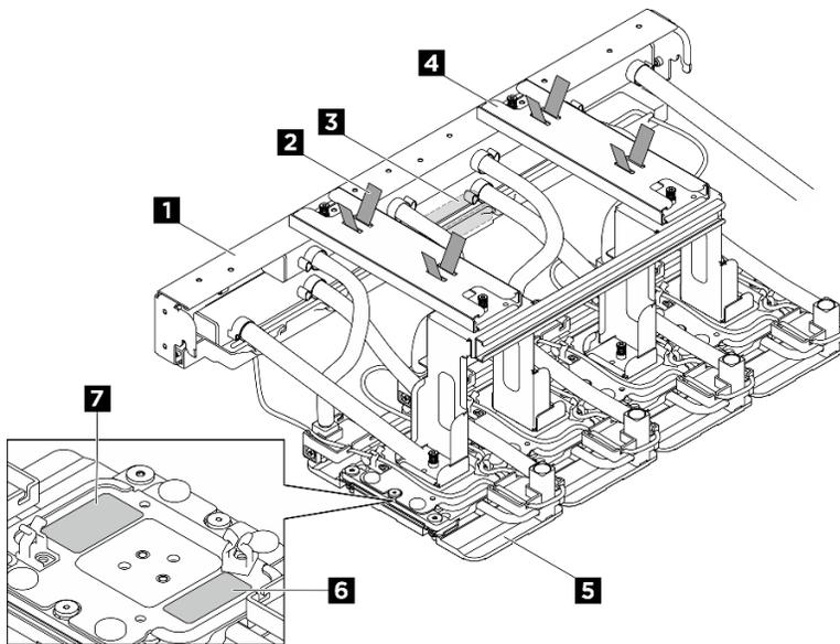
Figure 149. Identification des composants du module de plaque froide GPU H100/H200 avant
