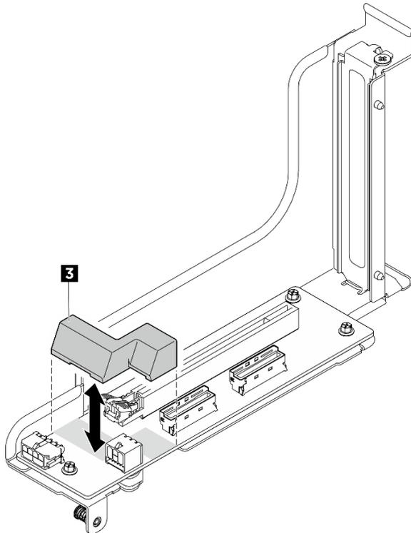
Figure 32. Retrait de la grille d'aération DPU de la carte mezzanine PCIe
