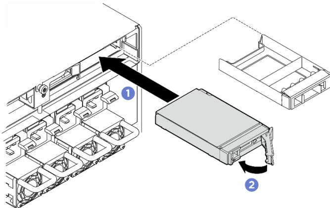
Figure 15. Installation d'une unité remplaçable à chaud 2,5 pouces arrière
