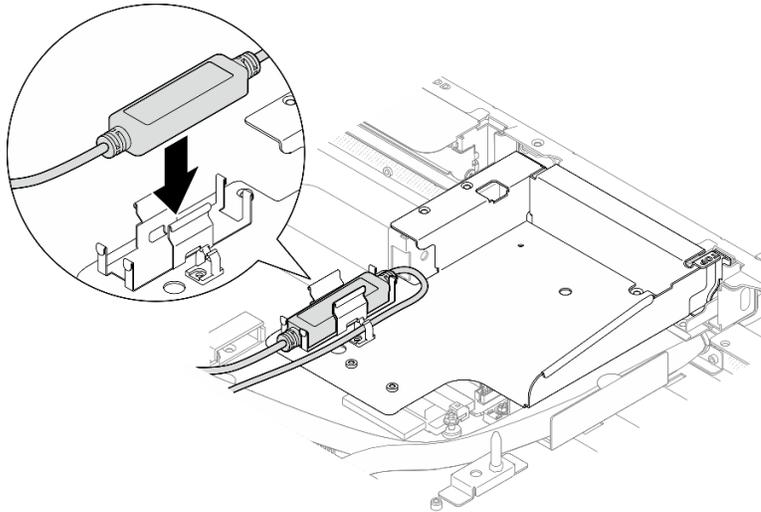
Figure 275. Installation du module de détecteur de fuite
