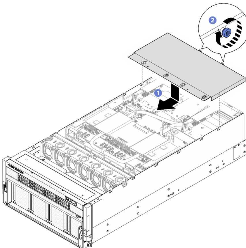
Figure 7. Installation du carter supérieur arrière
