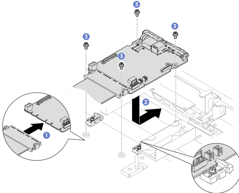
Figure 360. Installation de la carte d'E-S système
