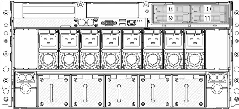
Figure 349. Numérotation des fonds de panier d'unité 2,5 pouces arrière
