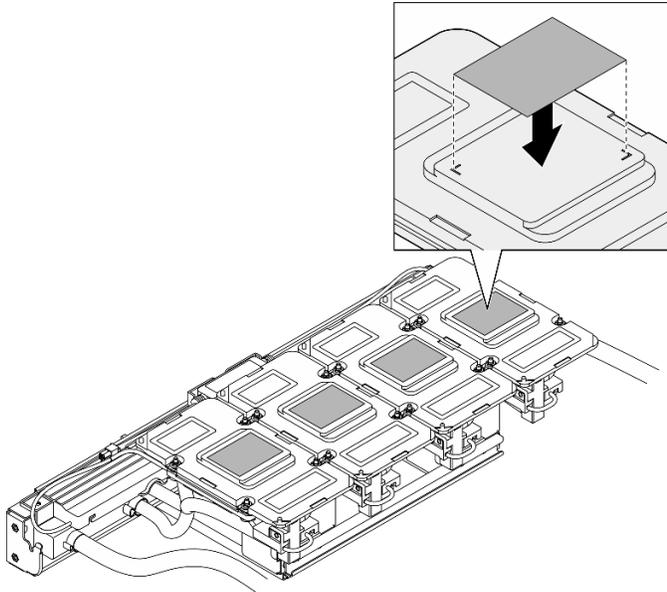
Figure 151. Application d'un PCM
