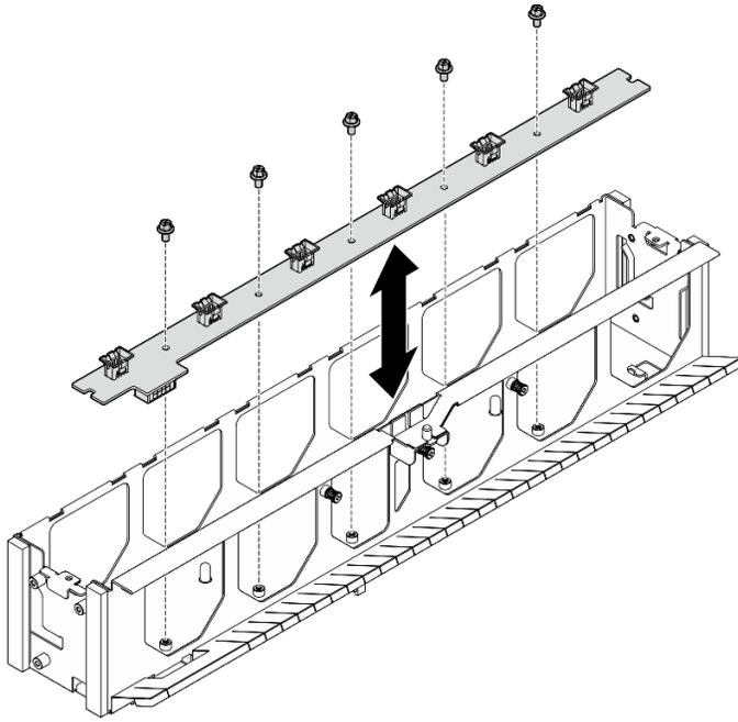
Figure 63. Installation de la carte de contrôleur de ventilation avant
