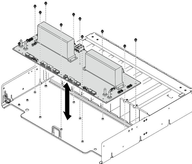
Figure 326. Installation du tableau de distribution
