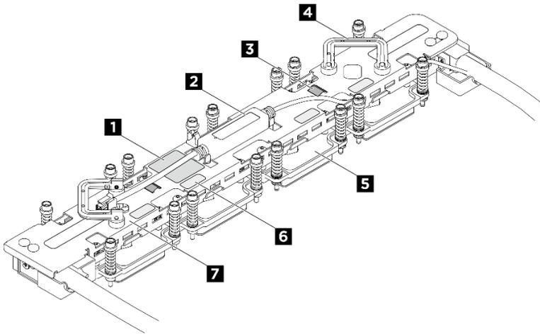
Figure 113. Identification des composants du module de plaque froide NVSwitch
