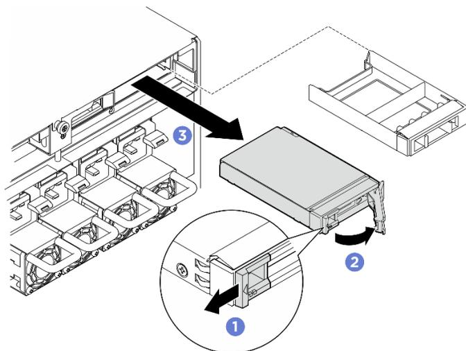
Figure 11. Retrait d'une unité remplaçable à chaud 2,5 pouces arrière
