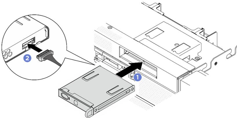
Figure 242. Installation du panneau de diagnostics intégré
