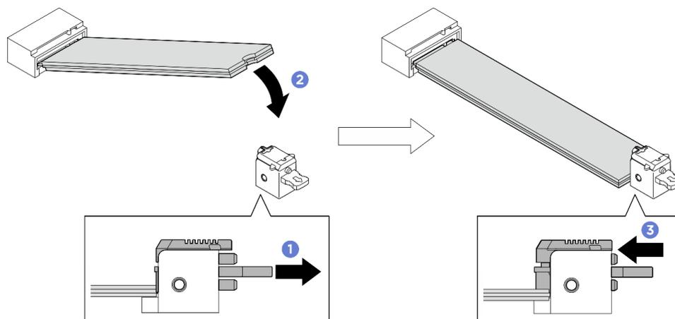
Figure 281. Installation de l'unité M.2 inférieure
