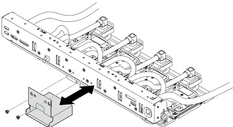
Figure 147. Retrait du support de câble GPU
