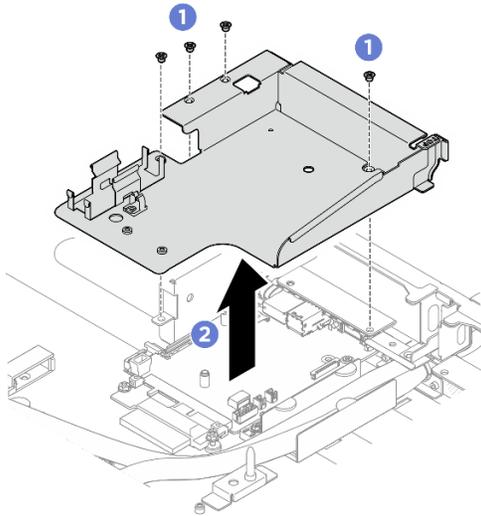
Figure 251. Retrait du support du module de détecteur de fuite
