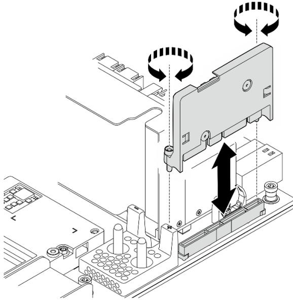
Figure 240. Installation de la carte HMC
