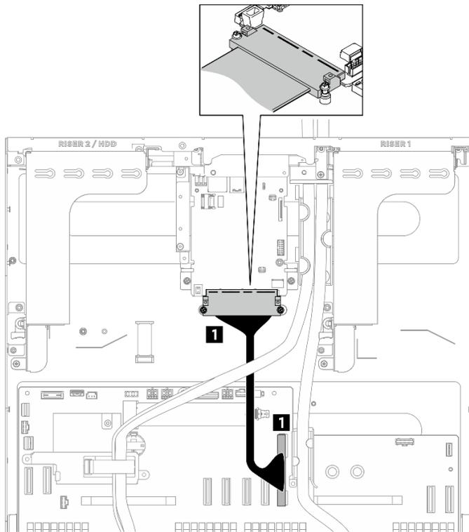
Figure 389. Cheminement des câbles de la carte d'E-S système
