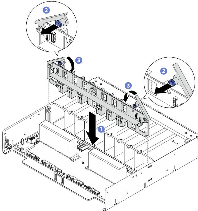
Figure 342. Installation de l'interposeur du bloc d'alimentation
