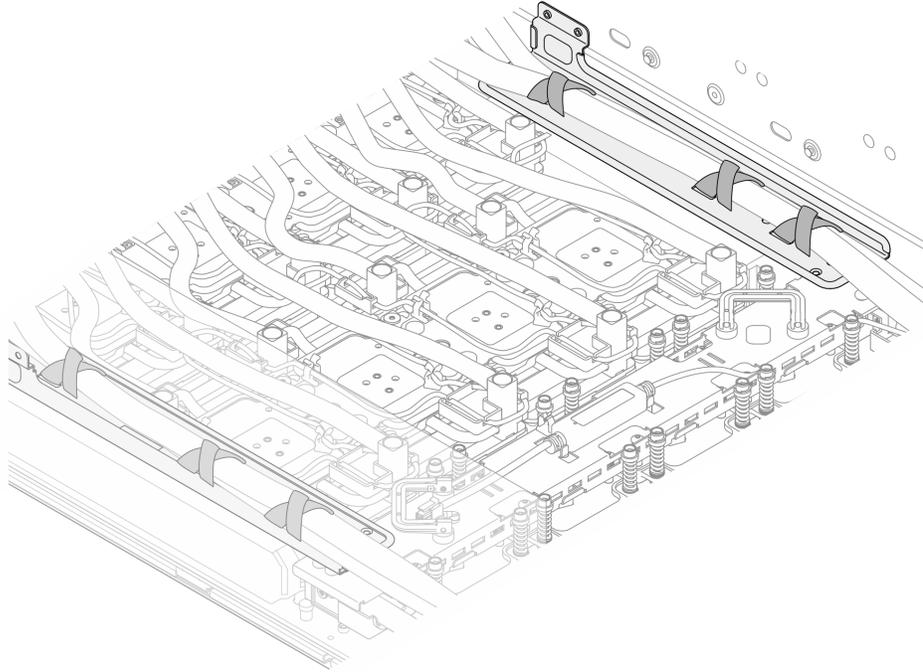
Figure 133. Mise en place des tuyaux et des câbles sur les guide-tuyaux
