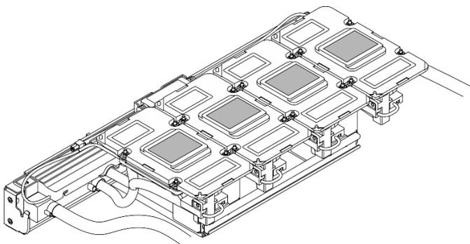
Figure 146. Essuyage du PCM et des tampons de mastic des plaques froides
