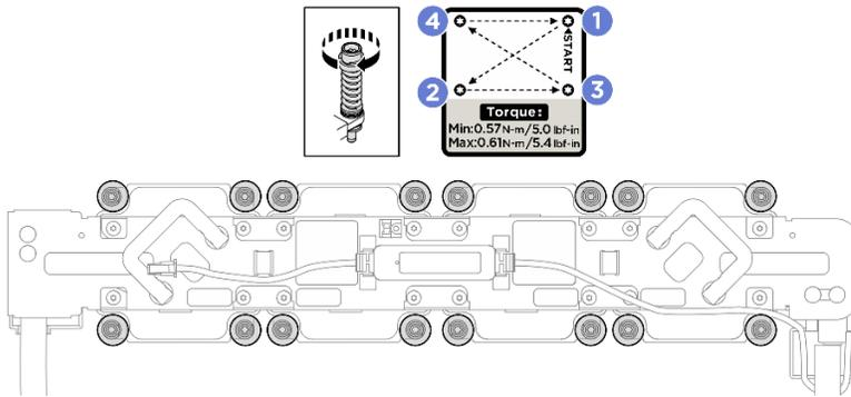
Figure 128. Installation des plaques froides NVSwitch
