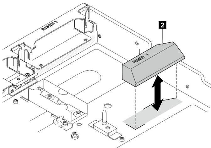
Figure 41. Installation de la grille d'aération DPU sur le châssis
