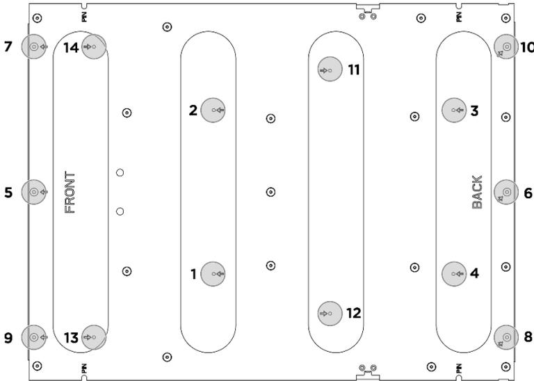
Figure 109. Ordre des vis de la plaque d'adaptateur du complexe GPU
