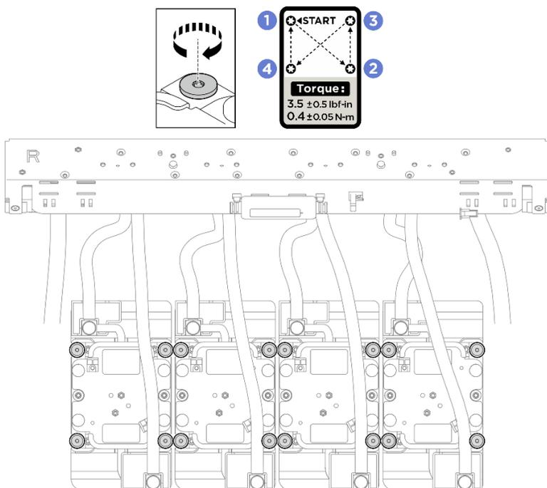
Figure 184. Installation des plaques froides GPU
