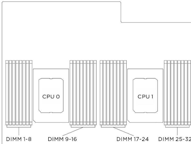
Figure 285. Disposition des modules de mémoire et des processeurs
