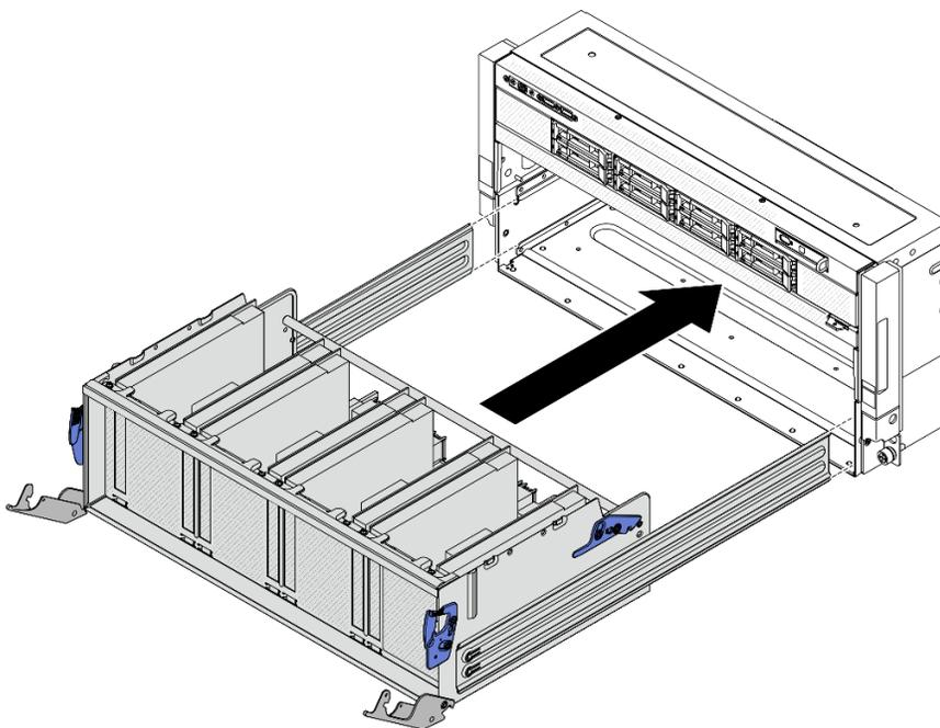
Figure 316. Installation de la navette de commutation PCIe en position d'arrêt
