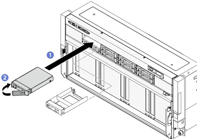
Figure 14. Installation d'une unité remplaçable à chaud 2,5 pouces avant
