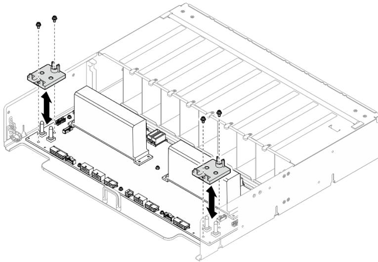
Figure 324. Retrait du dispositif de retenue des câbles
