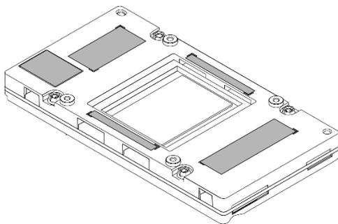
Figure 201. Nettoyage du PCM et des tampons de mastic du GPU
