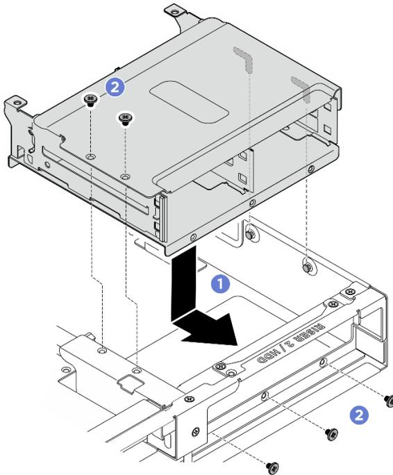
Figure 358. Installation du boîtier d'unités de disque dur arrière
