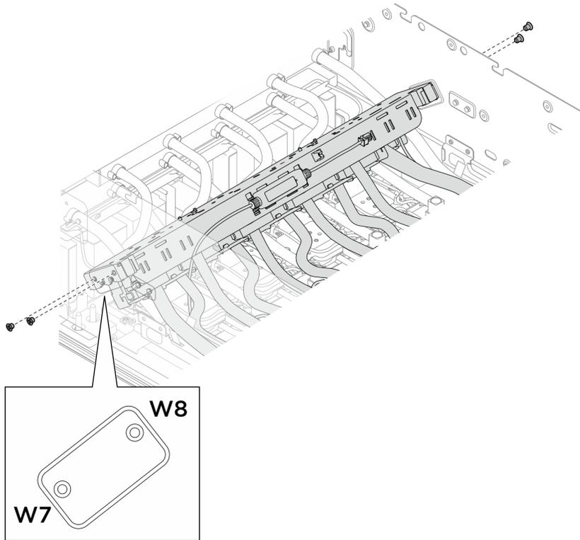
Figure 163. Installation du collecteur du module de plaque froide GPU H100/H200 arrière
