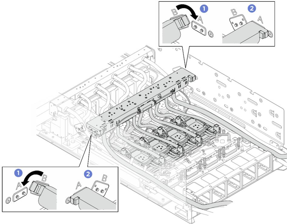
Figure 171. Repositionnement du collecteur du module de plaque froide GPU H100/H200 arrière
