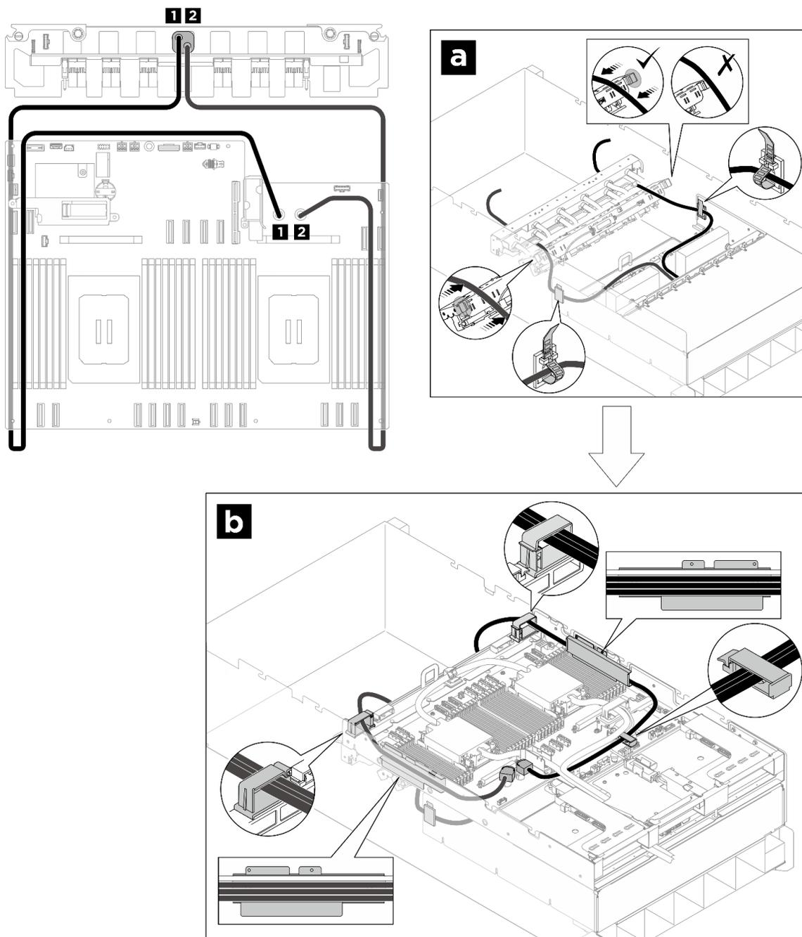
Figure 394. Cheminement des câbles de l'interposeur du PSU vers la carte mère
