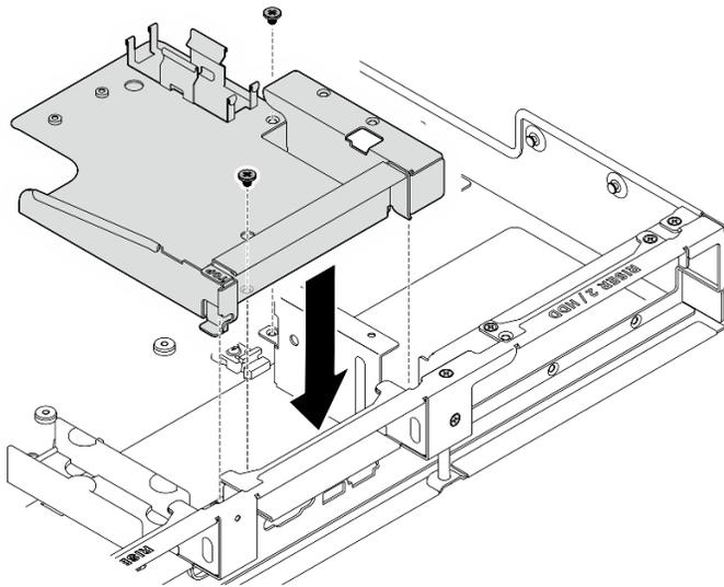
Figure 249. Installation du support du module de détecteur de fuite
