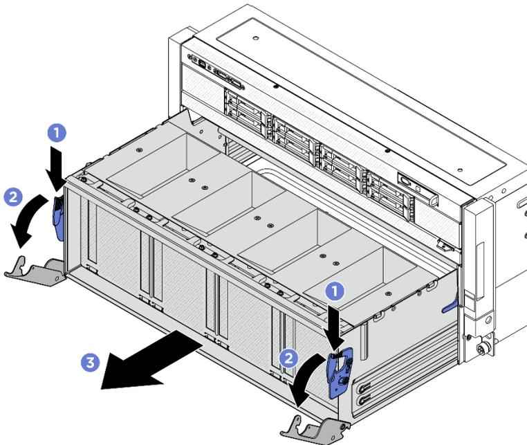
Figure 313. Retrait de la navette de commutation PCIe de la position d'arrêt
