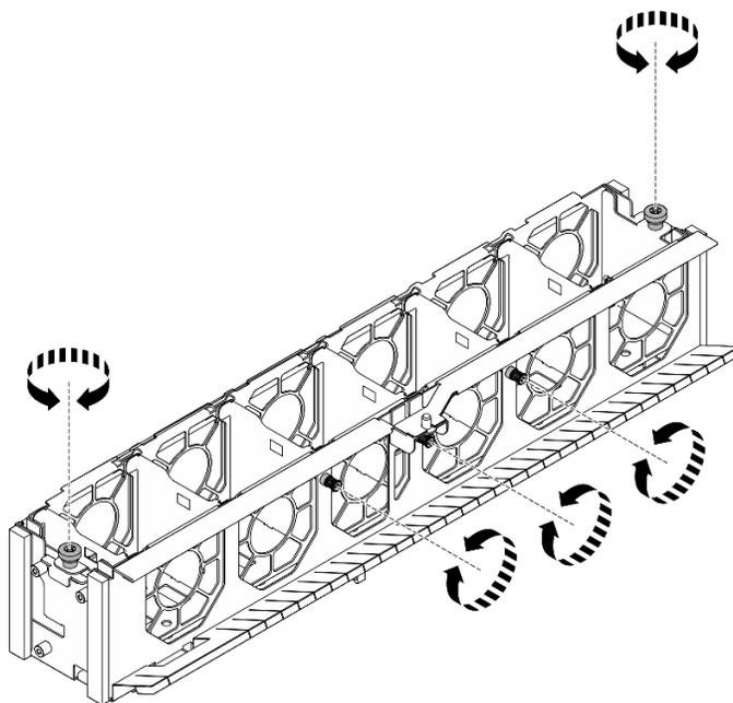
Figure 65. Fixation du boîtier de ventilation interne
