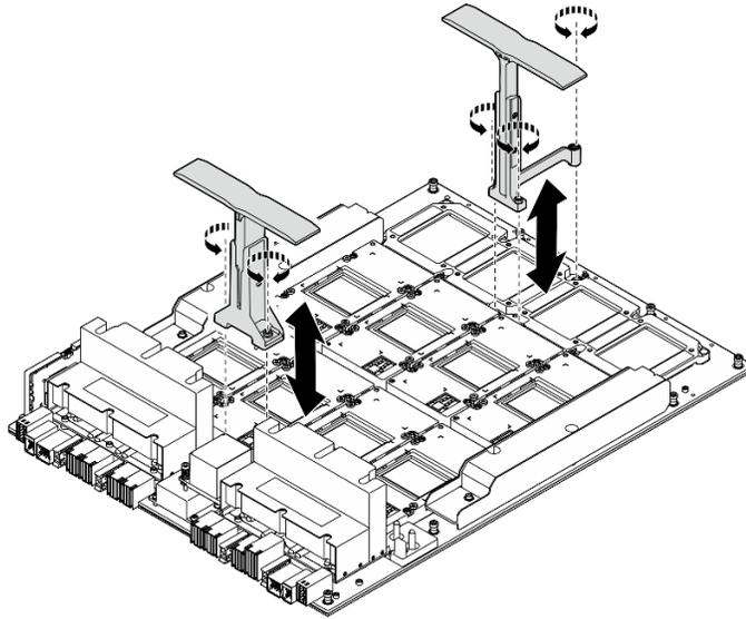
Figure 98. Installation des poignées
