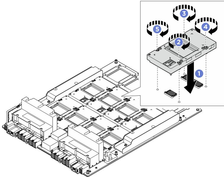
Figure 87. Installation du GPU
