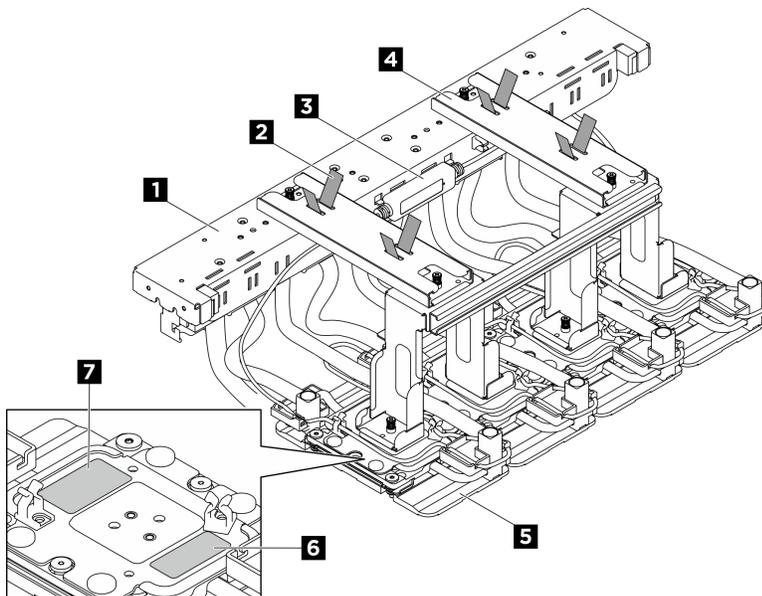
Figure 166. Identification des composants du module de plaque froide GPU H100/H200 arrière
