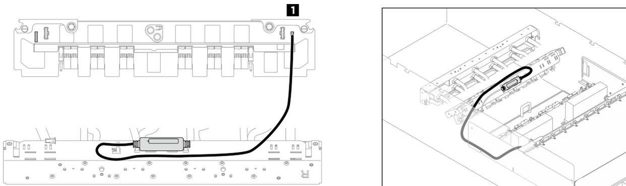
Figure 399. Cheminement des câbles du module de détecteur de fuite GPU arrière
