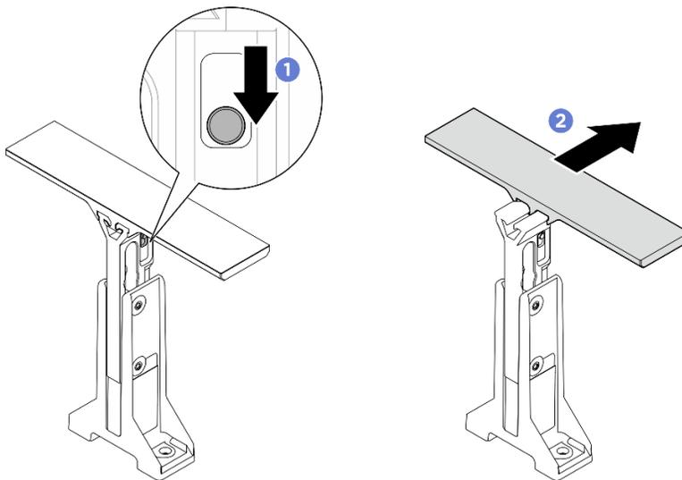
Figure 80. Ajustement de la poignée
