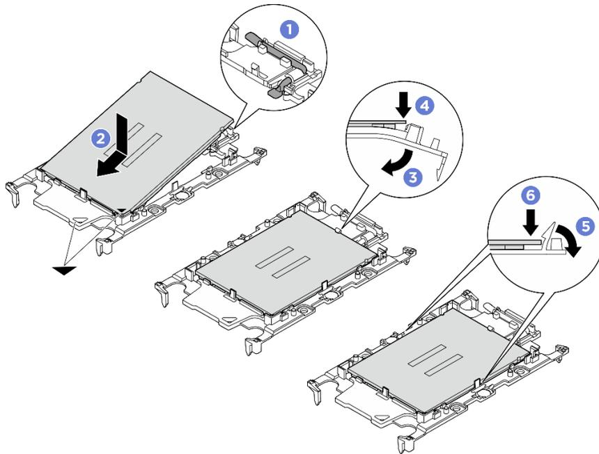
Figure 261. Installation d'un support de processeur
