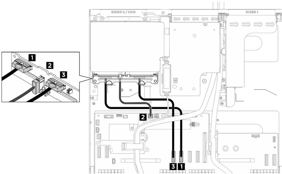
Figure 381. Cheminement des câbles du fond de panier d'unité 2,5 pouces arrière
