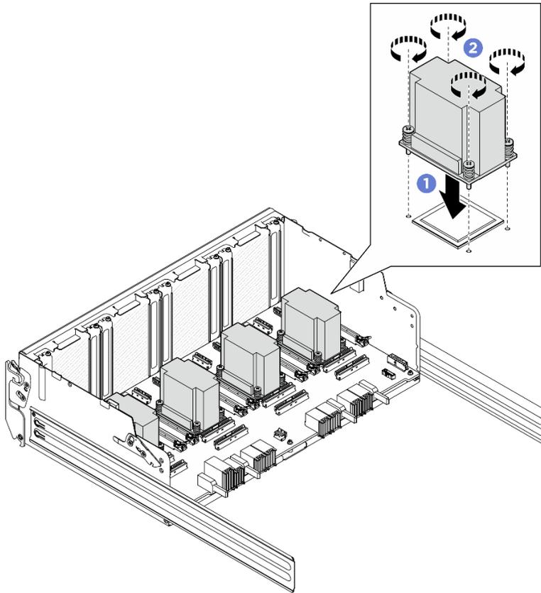
Figure 312. Installation du dissipateur thermique du tableau de commutation PCIe
