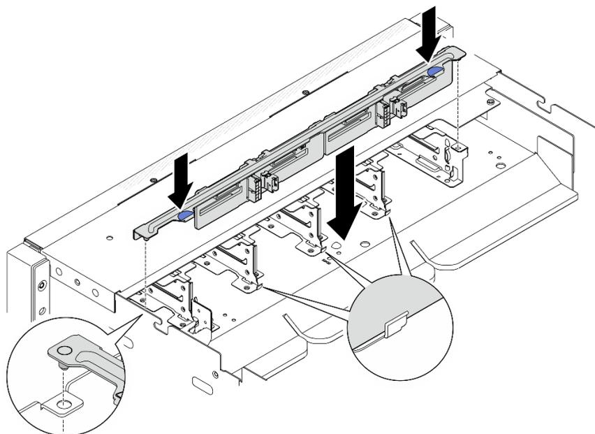
Figure 21. Installation d'un support de fond de panier d'unité 2,5 pouces avant
