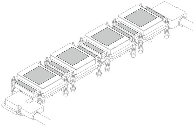
Figure 123. Essuyage du PCM et des tampons de mastic des plaques froides
