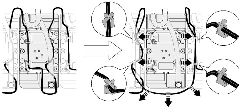
Figure 196. Retrait des câbles du module de détecteur de fuite
