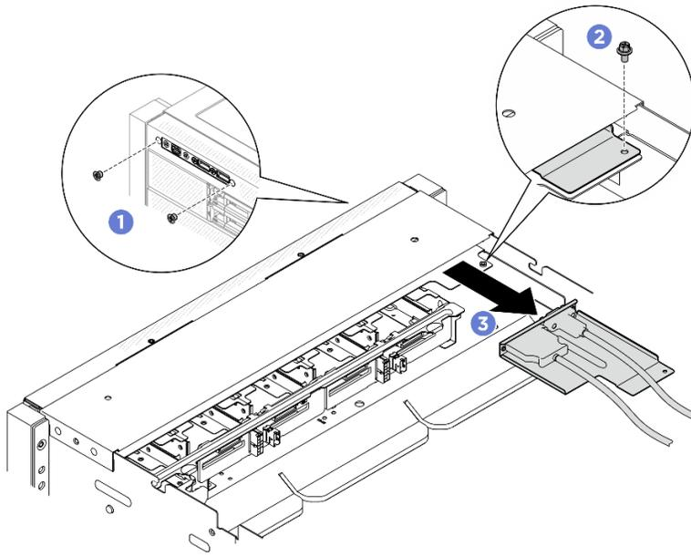
Figure 71. Retrait du module d'E-S avant
