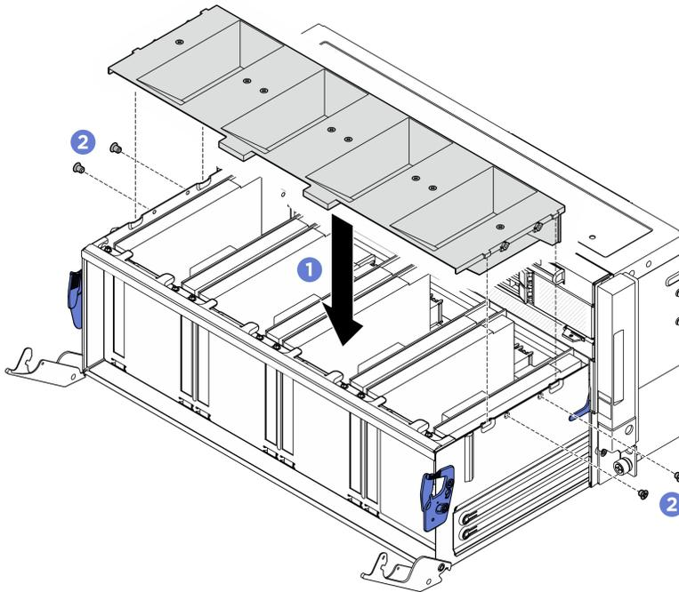
Figure 293. Installation de la grille d'aération
