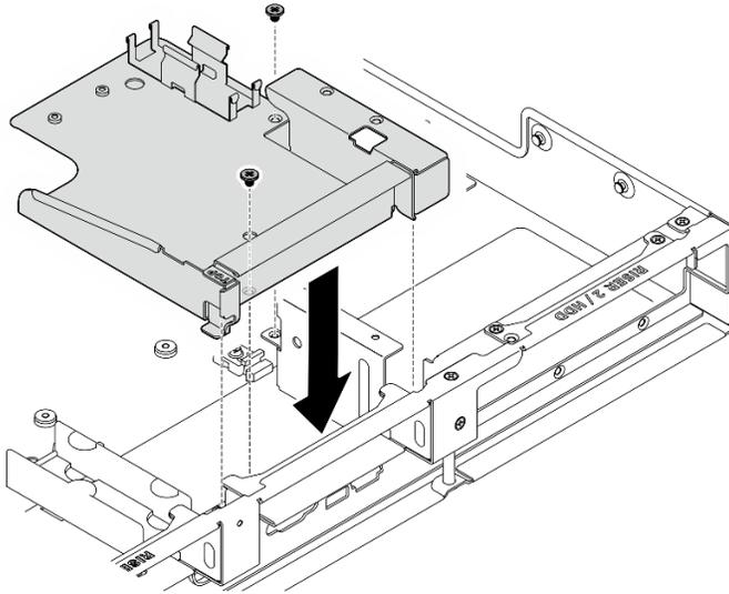
Figure 357. Installation du support du module de détecteur de fuite
