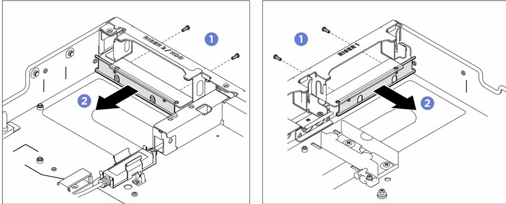
Figure 367. Retrait du bloc de ventilation
