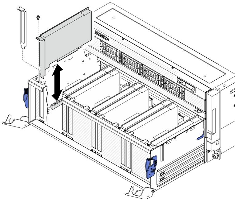
Figure 292. Installation de l'adaptateur PCIe avant
