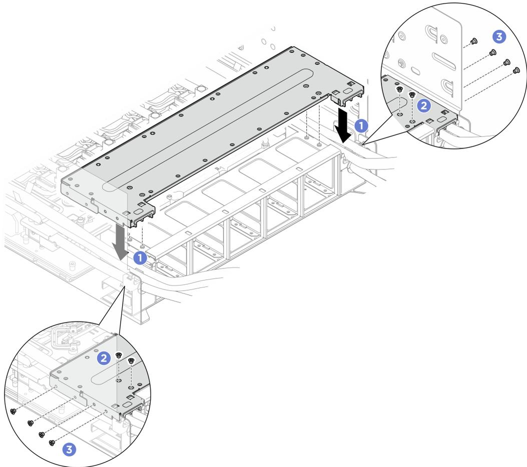
Figure 70. Installation du support du boîtier de ventilation arrière
