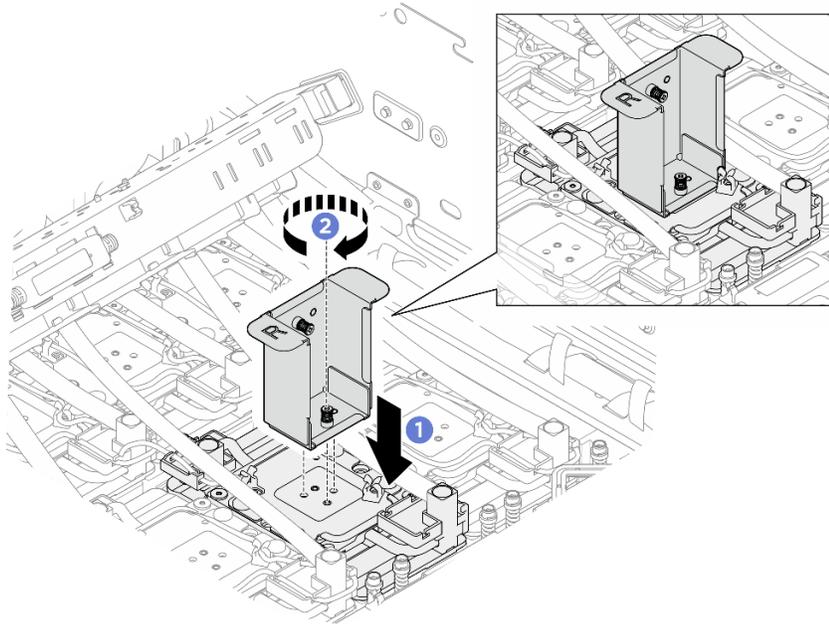
Figure 222. Installation du support de maintenance sur la plaque froide GPU
