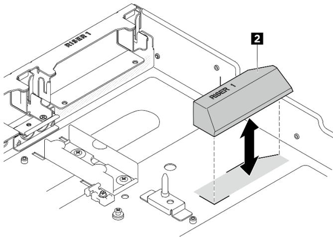
Figure 31. Retrait de la grille d'aération DPU du châssis
