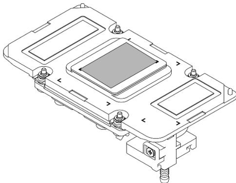
Figure 202. Essuyage du PCM et des tampons de mastic de la plaque froide
