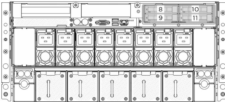
Figure 352. Numérotation des fonds de panier d'unité 2,5 pouces arrière
