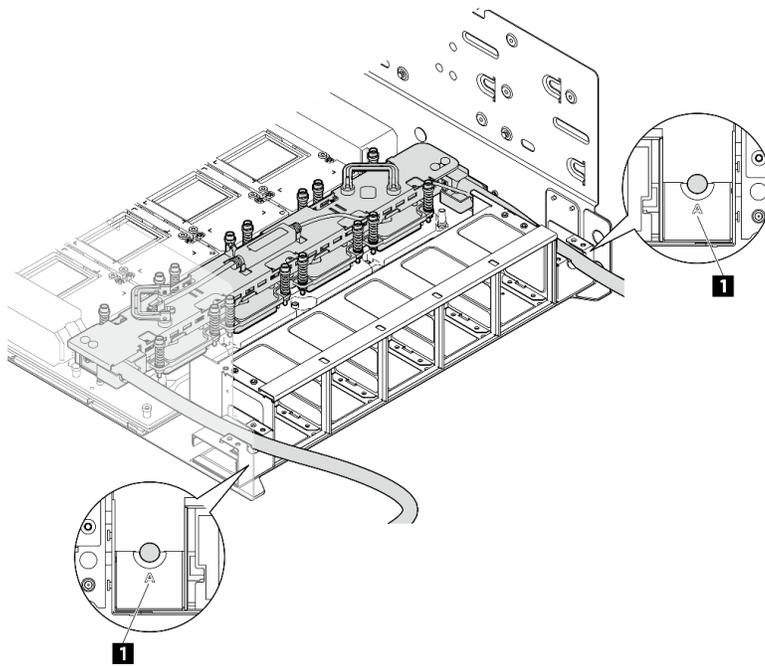
Figure 130. Mise en place des tuyaux
