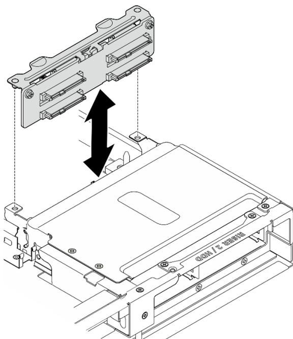
Figure 354. Installation du support de fond de panier d'unité 2,5 pouces arrière
