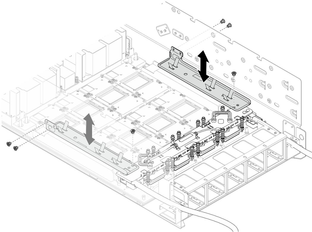
Figure 132. Installation des guide-tuyaux
