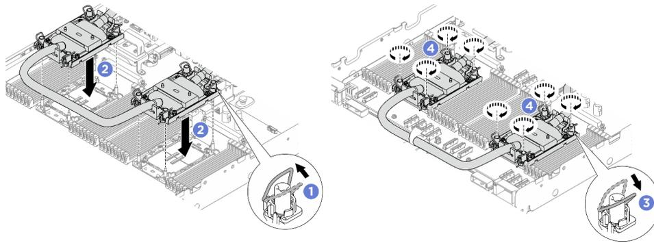
Figure 265. Installation du processeur-DWCM
