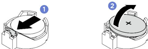
Figure 47. Retrait de la pile CMOS
