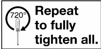
3. Suivez l'ordre de vis indiqué sur l'étiquette de la plaque froide, puis répétez l'opération pour serrer à fond seize vis Torx T15 à l'aide d'un tournevis dynamométrique réglé au couple approprié.
