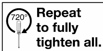
Figura 148. Ripetizione dell'operazione per serrare completamente tutte le viti
