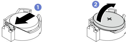
図 26. CMOS バッテリーの取り外し
