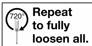
図 140. 繰り返してすべてのねじを完全に緩める
