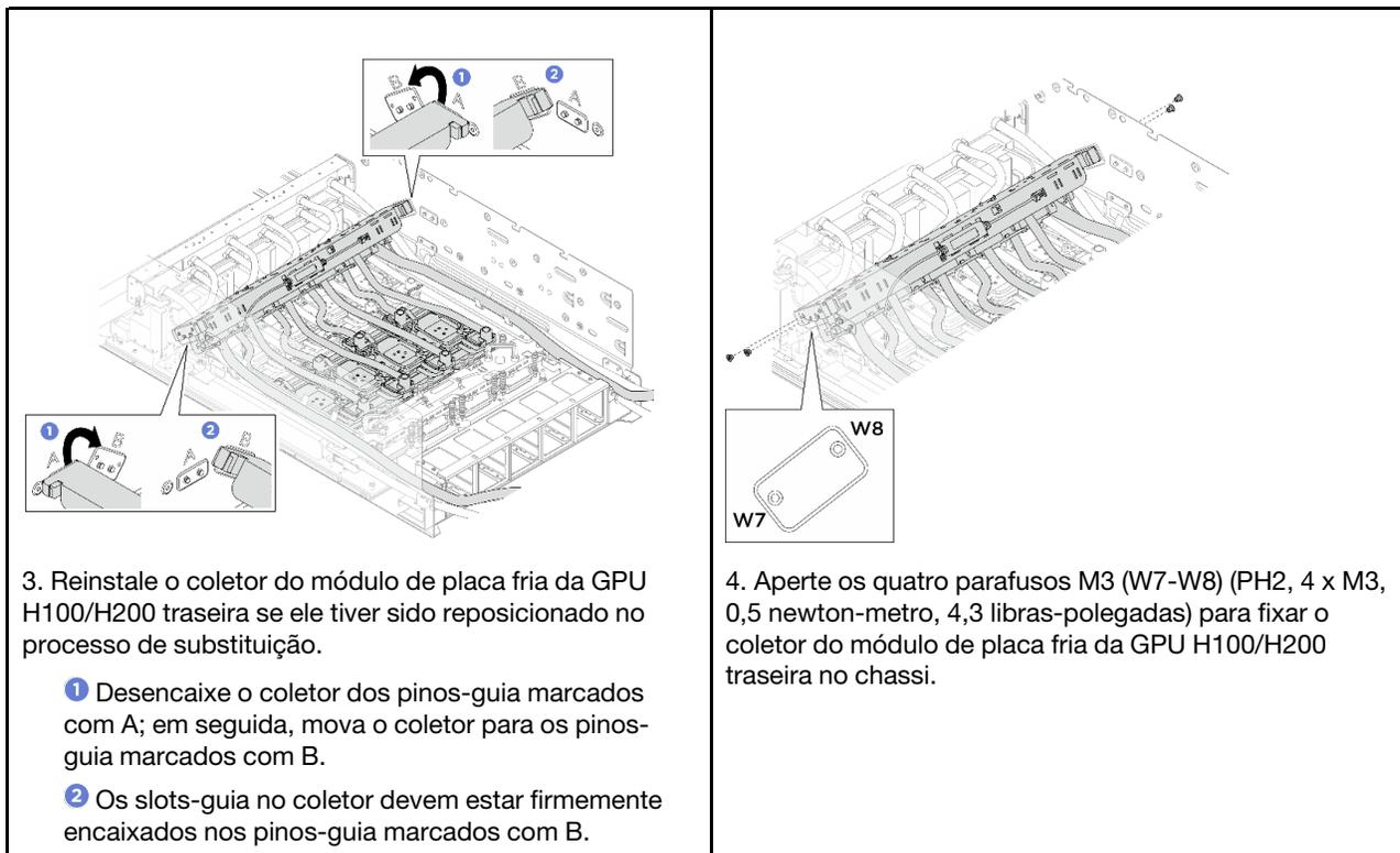
3. Reinstale o coletor do módulo de placa fria da GPU H100/H200 traseira se ele tiver sido reposicionado no processo de substituição.
