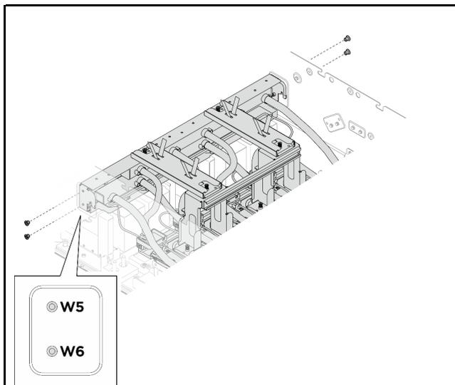
6. Aperte os quatro parafusos M3 (W5-W6) (PH2, 4 x M3, 0,5 newton-metro, 4,3 libras-polegadas) para fixar o coletor do módulo de placa fria da GPU H100/H200 no chassi.
