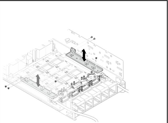
2. Solte os três parafusos M3 que prendem a guia da mangueira no chassi e no coletor; em seguida, remova a guia da mangueira. Repita para remover a guia da mangueira do outro lado.
