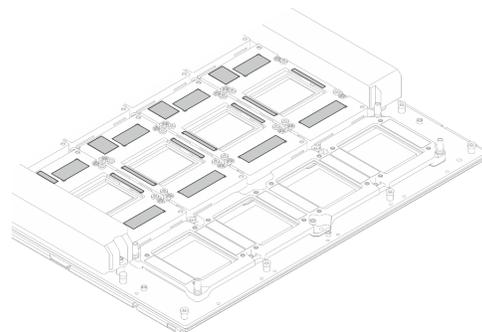
8. **Limpe imediatamente** o PCM, os protetores putty da GPU e o módulo de placa fria com panos de limpeza com álcool. **Limpe com cuidado** o PCM e os protetores putty para evitar danos à GPU.
