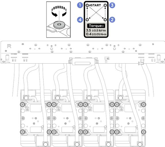
3. Siga a sequência de parafusos 1 2 3 4 especificada na etiqueta da placa fria e solte totalmente os 16 parafusos Torx T10 com uma chave de fenda de torque ajustada para o torque adequado ( $0,4 \pm 0,05$  Newtonmetro,  $3,5 \pm 0,5$  libras-polegadas). Os parafusos prisioneiros devem estar completamente soltos antes de remover o módulo de placa fria.
