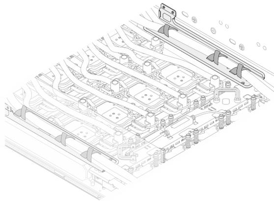
7. Coloque as mangueiras, o cabo de alimentação do ventilador traseiro e o cabo do módulo do sensor de vazamento da GPU nas guias da mangueira e prenda-os com as braçadeiras da mangueira. Não sobreponha os cabos e as mangueiras. Consulte o roteamento de cabos para obter mais detalhes.
