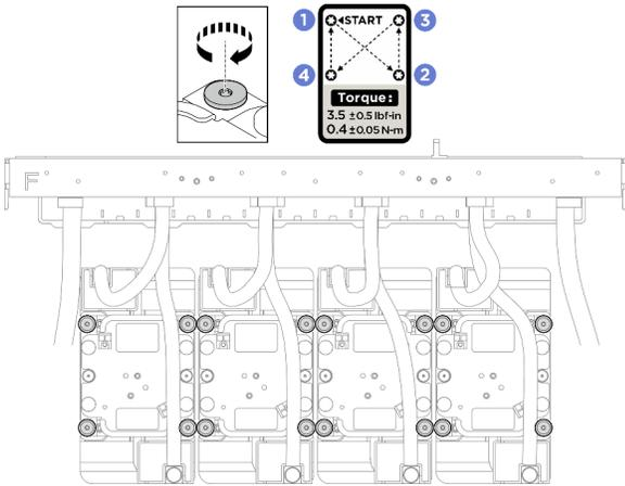
9. Siga a sequência de parafusos especificada na etiqueta da placa fria e repita para apertar totalmente os 16 parafusos Torx T10 com uma chave de fenda de torque ajustada para o torque adequado.
