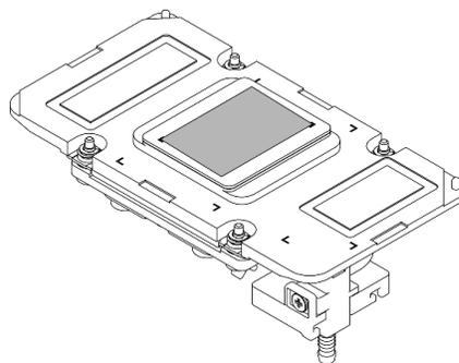
6. Com panos de limpeza com álcool, limpe o protetor putty e os PCMs restantes do módulo de placa fria da GPU.
