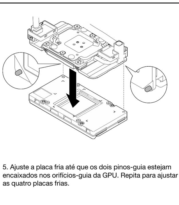
5. Ajuste a placa fria até que os dois pinos-guia estejam encaixados nos orifícios-guia da GPU. Repita para ajustar as quatro placas frias.
