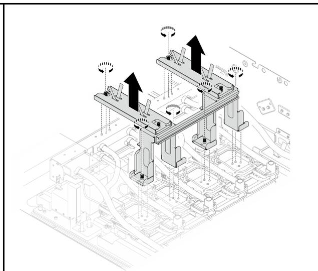
7. Solte os seis parafusos prisioneiros que prendem os suportes de remessa no módulo de placa fria da GPU H100/H200; em seguida, remova os suportes de remessa do módulo de placa fria da GPU H100/H200.
