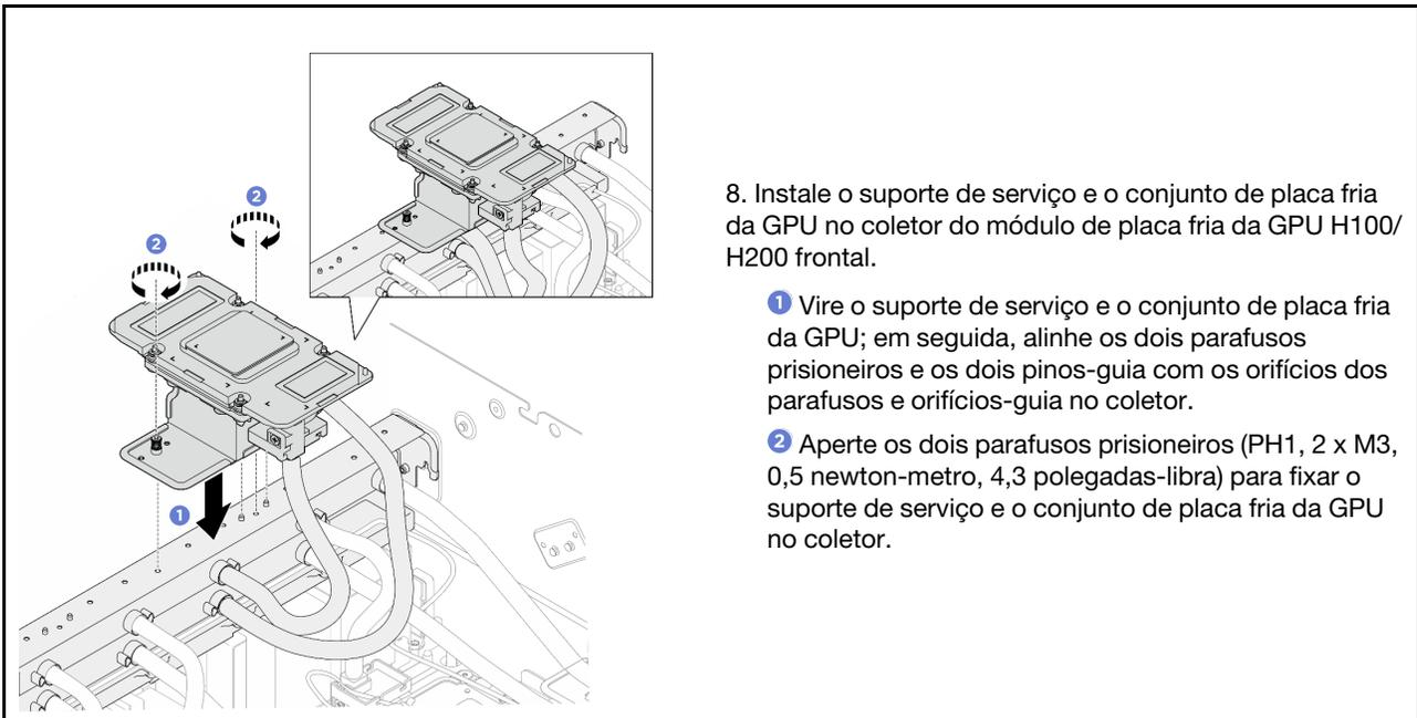
8. Instale o suporte de serviço e o conjunto de placa fria da GPU no coletor do módulo de placa fria da GPU H100/H200 frontal.
