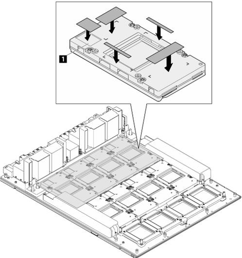
2. Substitua os protetores putty (x5) na GPU.
