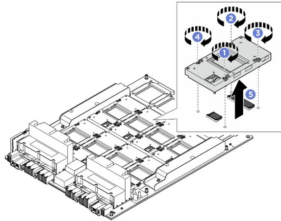
7. Remova as GPUs da placa-base da GPU.
