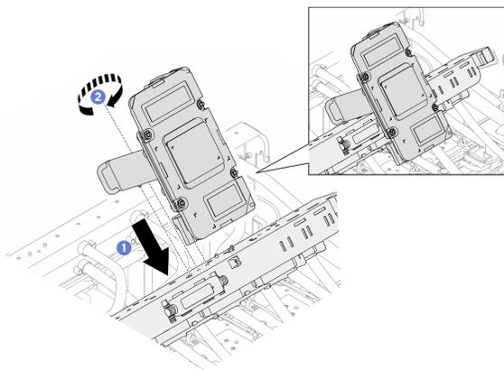
4. Instale o suporte de serviço e o conjunto de placa fria da GPU no coletor do módulo de placa fria da GPU H100/H200 traseira.
