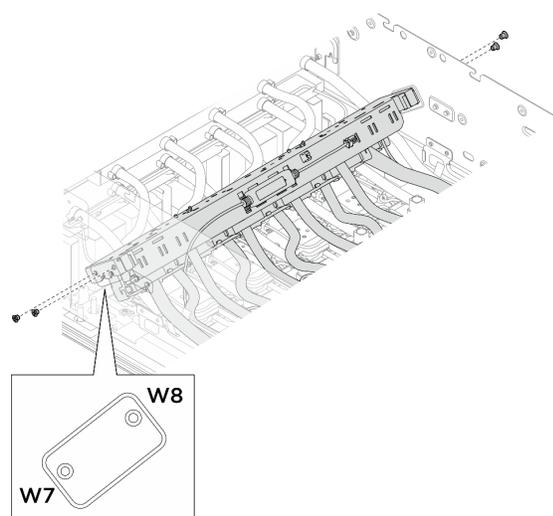
8. Aperte os quatro parafusos M3 (W7-W8) (PH2, 4 x M3, 0,5 newton-metro, 4,3 libras-polegadas) para fixar o coletor do módulo de placa fria da GPU H100/H200 traseira no chassi.
