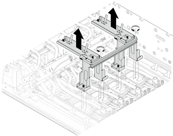
13. Solte totalmente os quatro parafusos prisioneiros que prendem os suportes de remessa nas placas frias da GPU; em seguida, afaste os suportes de remessa das placas frias da GPU para removê-los.
