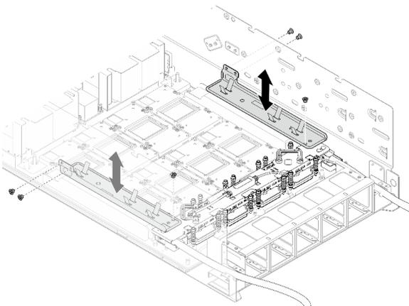
6. Alinhe a guia da mangueira com o orifício do parafuso no coletor NVSwitch e os dois orifícios do parafuso no chassi; em seguida, aperte os três parafusos M3 (PH2, 3 x M3, 0,5 newton-metro, 4,3 polegada-libras) para fixar a guia da mangueira. Repita para instalar a guia da mangueira do outro lado.
