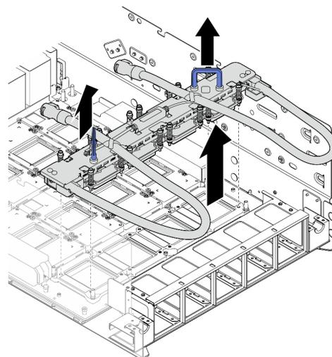
4. Prenda as mangueiras no coletor com as amarras. Segure as alças para levantar o módulo de placa fria NVSwitch para fora do chassis.
