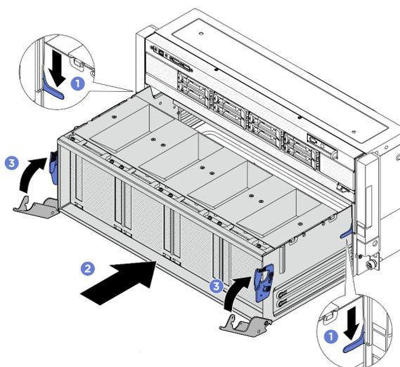
8. Instale o alternador do comutador PCIe.
