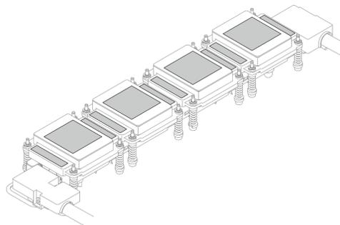
5. **Limpe imediatamente** o PCM, os protetores putty dos NVSwitches e o módulo de placa fria com panos de limpeza com álcool. **Limpe com cuidado** o PCM e os protetores putty para evitar danos aos NVSwitches.
