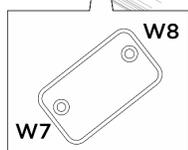
3. Solte os quatro parafusos M3 (W7-W8) que prendem o coletor do módulo de placa fria da GPU H100/H200 traseira no chassi.
