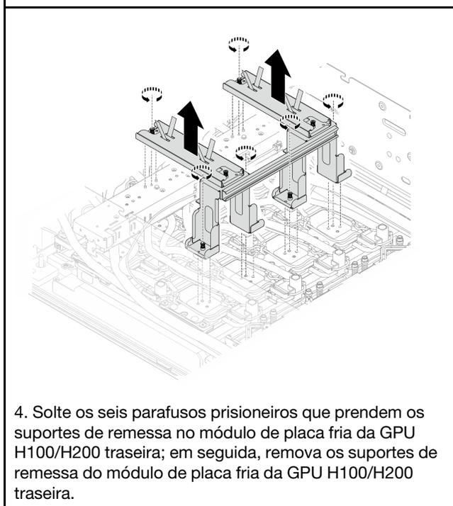
4. Solte os seis parafusos prisioneiros que prendem os suportes de remessa no módulo de placa fria da GPU H100/H200 traseira; em seguida, remova os suportes de remessa do módulo de placa fria da GPU H100/H200 traseira.
