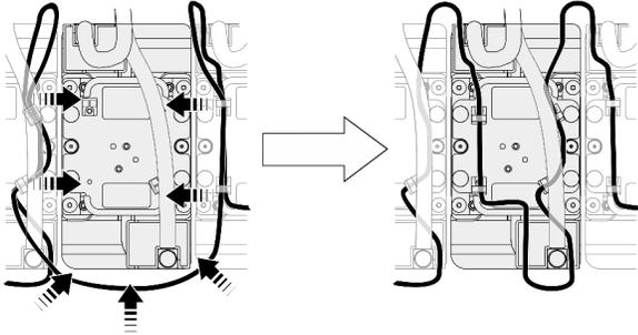
9. Reinstale o cabo do módulo do sensor de vazamento na placa fria da GPU.
