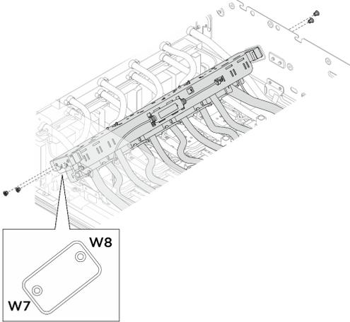
4. Solte os quatro parafusos M3 (W7-W8) que prendem o coletor do módulo de placa fria da GPU traseira no chassi.
