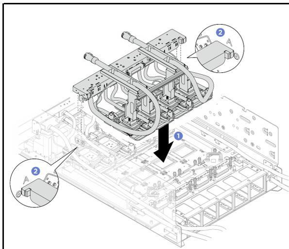
3. Instale o módulo de placa fria da GPU H100/H200 traseira.
