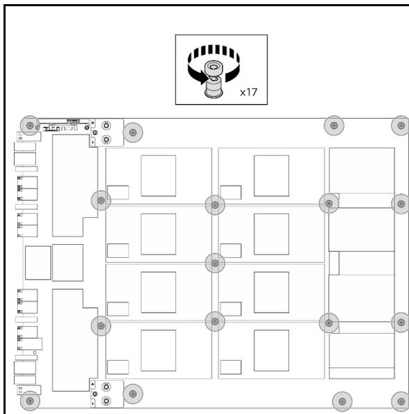
3. Solte os 17 parafusos prisioneiros Torx T15 na placa-base da GPU.
