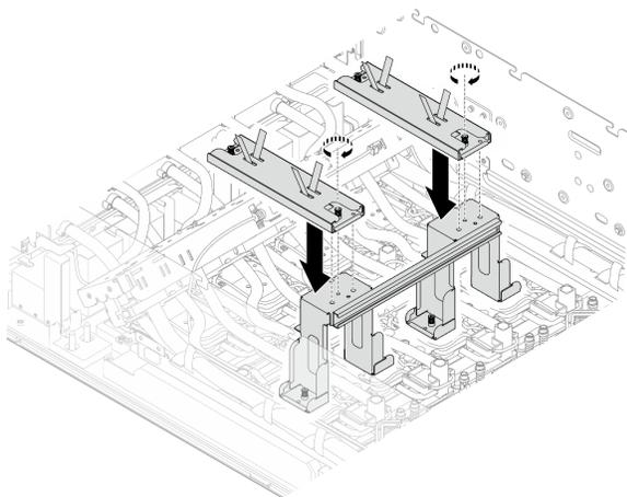
12. Reinstale as alças nos suportes de remessa. Alinhe os pinos-guia nas alças com os orifícios-guia nos suportes de remessa; em seguida, aperte os dois parafusos prisioneiros para instalar as duas alças nos suportes de remessa.
