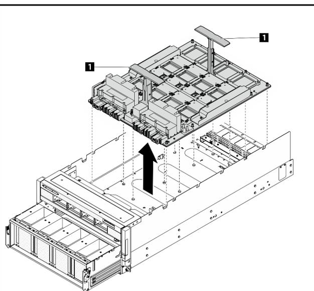
5. Segure as duas alças para levantar o complexo de GPU para fora do chassi.
