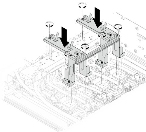
4. Alinhe os pinos-guia nos suportes de remessa com os orifícios-guia no coletor e as placas frias; em seguida, abaixe os suportes de remessa no módulo de placa fria da GPU frontal. Aperte os seis parafusos prisioneiros (PH1, 6 x M3, 0,5 newton-metro, 4,3 libras-polegadas) para prender os suportes de remessa no módulo de placa fria da GPU frontal.
