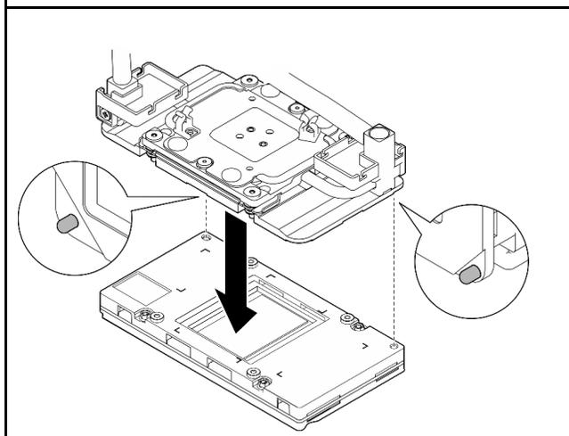
8. Ajuste a placa fria até que os dois pinos-guia estejam encaixados nos orifícios-guia da GPU. Repita para ajustar as quatro placas frias.
