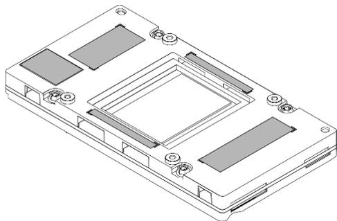
9. **Limpe imediatamente** o PCM, os protetores putty da GPU e o módulo de placa fria com panos de limpeza com álcool. **Limpe com cuidado** o PCM e os protetores putty para evitar danos à GPU.
