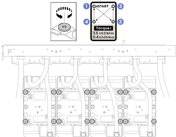
3. Siga a sequência de parafusos 1 2 3 4 especificada na etiqueta da placa fria e solte totalmente os 16 parafusos Torx T10 com uma chave de fenda de torque ajustada para o torque adequado ( $0,4 \pm 0,05$  Newton-metro,  $3,5 \pm 0,5$  libras-polegadas). Os parafusos prisioneiros devem estar completamente soltos antes de remover o módulo de placa fria.
