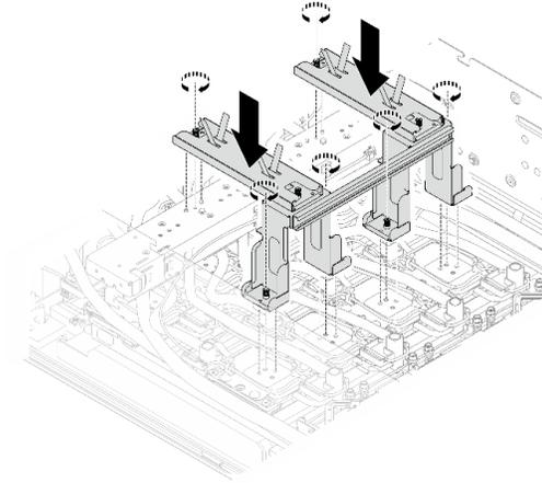
6. Alinhe os pinos-guia nos suportes de remessa com os orifícios-guia no coletor e as placas frias; em seguida, abaixe os suportes de remessa no módulo de placa fria da GPU traseira. Aperte os seis parafusos prisioneiros (PH1, M3 x 6, 0,5 newtonmetro, 4,3 libras-polegadas) para prender os suportes de remessa no módulo de placa fria da GPU traseira.
