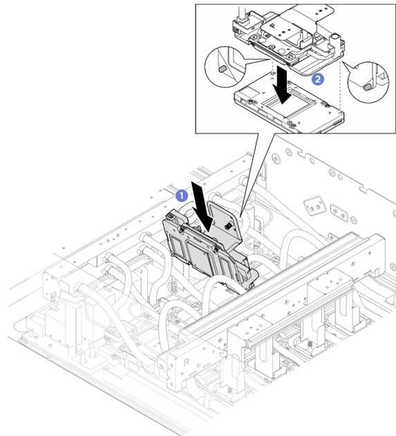
6. Coloque a placa fria da GPU na GPU.
