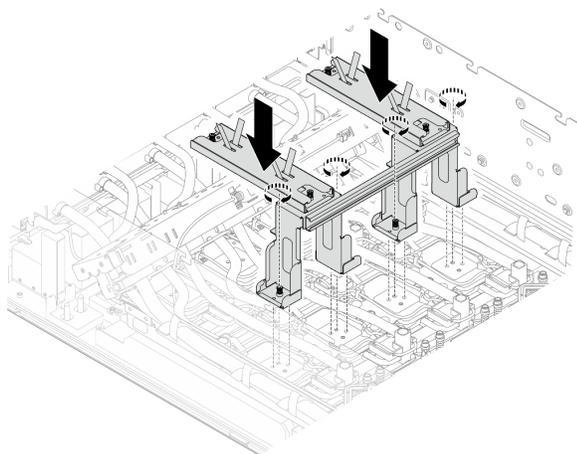
1. Alinhe os pinos-guia nos suportes de remessa com os orifícios-guia nas placas frias da GPU *traseira* e abaixe-a nas placas frias; em seguida, aperte os quatro parafusos prisioneiros (PH1, 4 x M3, 0,5 newton-metro, 4,3 libras-polegadas) para instalar os suportes de remessa nas placas frias da GPU traseira.
