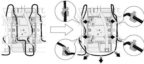
5. Remova o cabo do módulo do sensor de vazamento das presilhas de cabos, direcione-o para longe da placa fria e reinstale-o nas presilhas de cabos adjacentes à placa fria.
