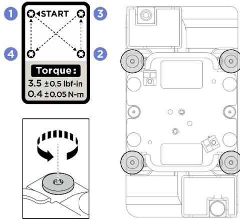
6. Siga a sequência de parafusos 1 2 3 4 especificada na etiqueta da placa fria e solte totalmente os 16 parafusos Torx T10 com uma chave de fenda de torque ajustada para  $0,4 \pm 0,05$  newton-metro,  $3,5 \pm 0,5$  libras-polegadas. Os parafusos prisioneiros devem estar completamente soltos antes de remover o módulo de placa fria.
