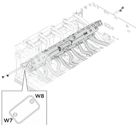
3. Solte os quatro parafusos M3 (W7-W8) que prendem o coletor do módulo de placa fria da GPU traseira no chassi.
