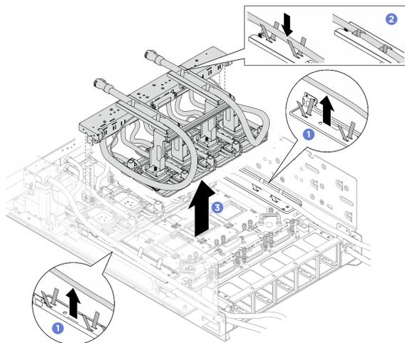
7. Segure os suportes de remessa para remover o módulo de placa fria da GPU frontal do chassis.
