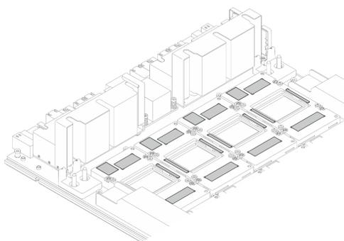
7. **Limpe imediatamente** o PCM, os protetores putty da GPU e o módulo de placa fria com panos de limpeza com álcool. **Limpe com cuidado** o PCM e os protetores putty para evitar danos à GPU.
