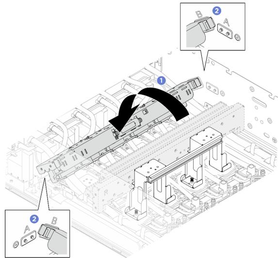
10. Reposicione o coletor do módulo de placa fria da GPU H100/H200 traseira.
