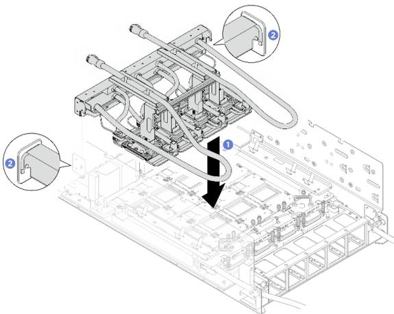
5. Instale o módulo de placa fria da GPU H100/H200 frontal.
