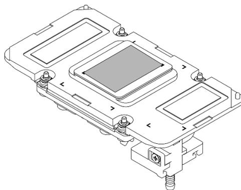
10. Com panos de limpeza com álcool, limpe o protetor putty e os PCMs restantes do módulo de placa fria da GPU.
