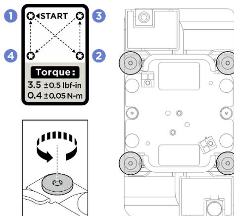
2. Siga a sequência de parafusos ①②③④ especificada na etiqueta da placa fria e solte totalmente os 16 parafusos Torx T10 com uma chave de fenda de torque ajustada para  $0,4 \pm 0,05$  newton-metro,  $3,5 \pm 0,5$  libras-polegadas. Os parafusos prisioneiros devem estar completamente soltos antes de remover a placa fria.
