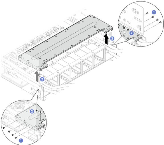
2. Remova o suporte de apoio da gaiola do ventilador traseiro.
