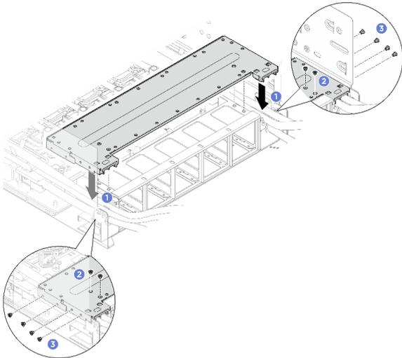
1. Instale o suporte de apoio da gaiola do ventilador traseiro.
