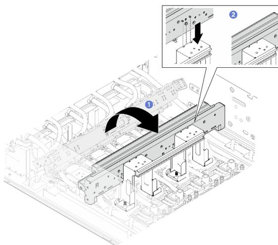
4. Reposicione o coletor do módulo de placa fria da GPU H100/H200 traseira.
