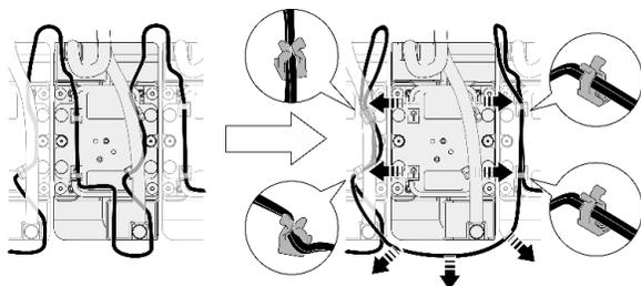
1. Remova o cabo do módulo do sensor de vazamento das presilhas de cabos, direcione-o para longe da placa fria e reinstale-o nas presilhas de cabos adjacentes à placa fria.
