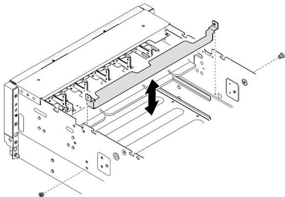
7. Alinhe o suporte de proteção do conector de GPU com os orifícios de parafuso correspondentes; em seguida, aperte os dois parafusos M3 (PH2, 2 x M3, 0,5 newtonmetro, 4,3 libras-polegadas) para prender o suporte de proteção do conector de GPU no chassi.
