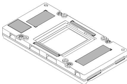
5. **Limpe imediatamente** o PCM, os protetores putty da GPU e o módulo de placa fria com panos de limpeza com álcool. **Limpe com cuidado** o PCM e os protetores putty para evitar danos à GPU.
