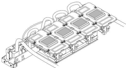
9. Com panos de limpeza com álcool, limpe o protetor putty e os PCMs restantes do módulo de placa fria da GPU.
