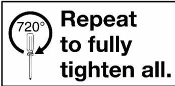
6. Siga a sequência de parafusos especificada na etiqueta da placa fria e repita para apertar totalmente os 16 parafusos Torx T10 com uma chave de fenda de torque ajustada para o torque adequado.
