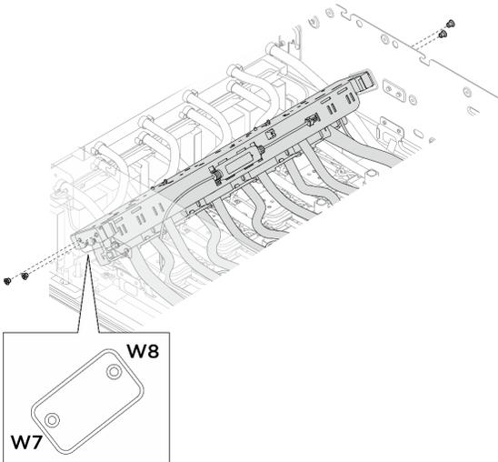
11. Aperte os quatro parafusos M3 (W7-W8) (PH2, 2 x M3, 0,5 newton-metro, 4,3 libras-polegadas) para fixar o coletor do módulo de placa fria da GPU H100/H200 traseira no chassi.
