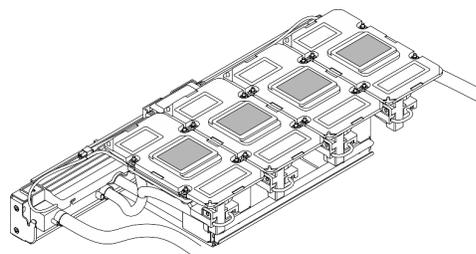
8. Com panos de limpeza com álcool, limpe o protetor putty e os PCMs restantes do módulo de placa fria da GPU.
