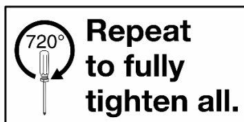
รูปภาพ 127. ทำซ้ำเพื่อขันสกรูทั้งหมดให้แน่น
