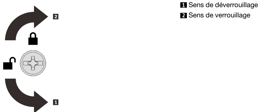
Figure 51. Sens de verrouillage/déverrouillage du carter supérieur
