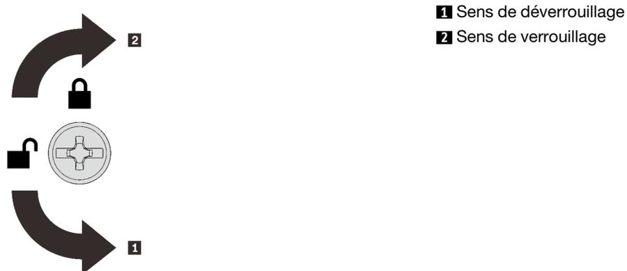
Figure 51. Sens de verrouillage/déverrouillage du carter supérieur
