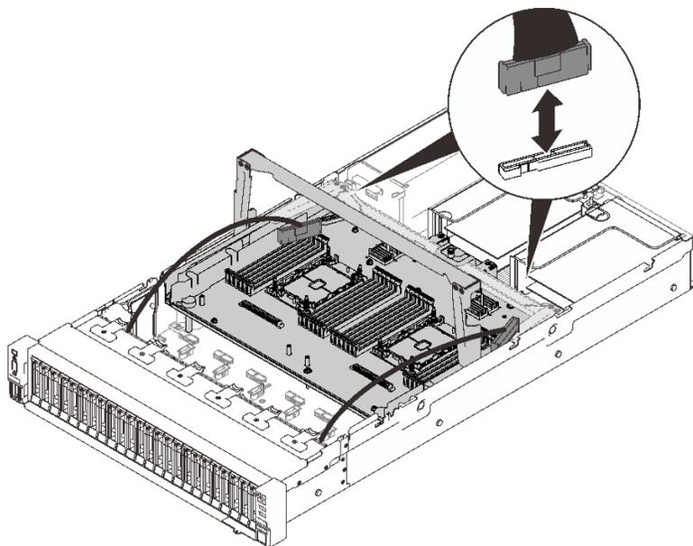
図 85. 拡張トレイへのケーブルの接続
