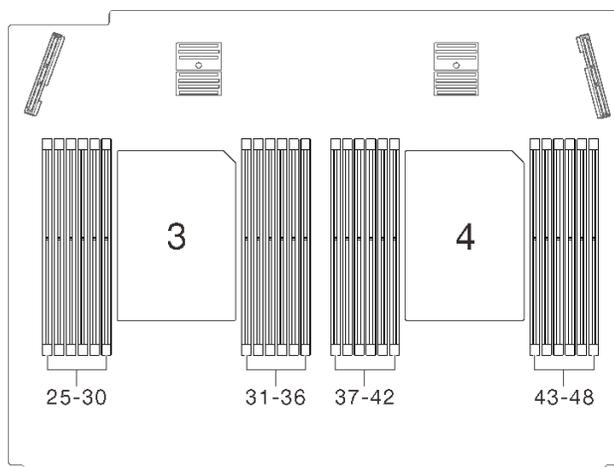
図 77. プロセッサおよびメモリー拡張トレイ上のプロセッサ 3 および 4 の位置
