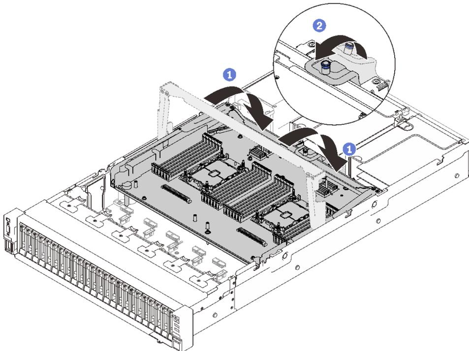
図24. プロセッサおよびメモリ拡張トレイを固定します。
