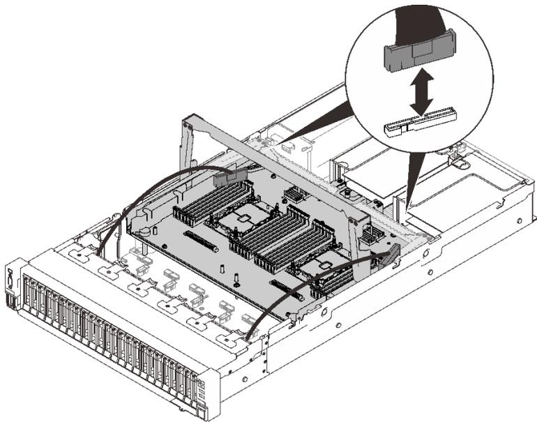
図23. 拡張トレイへのケーブルの接続
