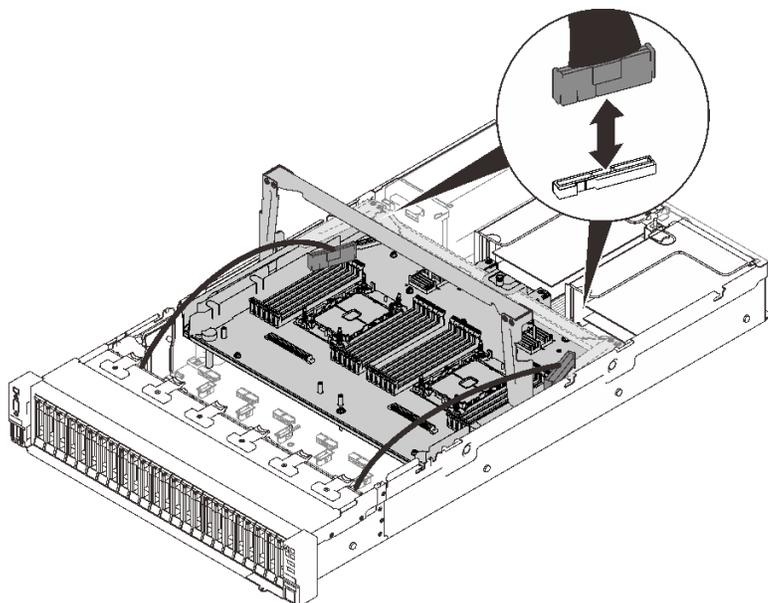
図73. PCIe ケーブルの取り外し
