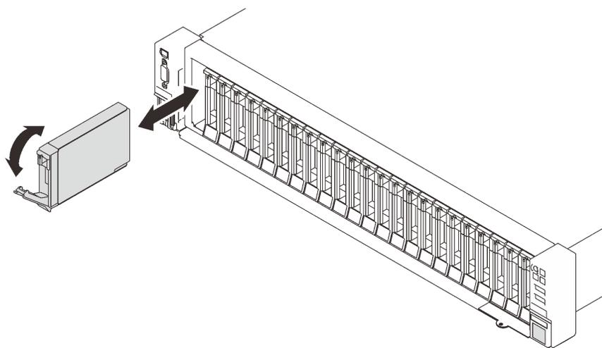
図48. 2.5 型ドライブの取り付け
