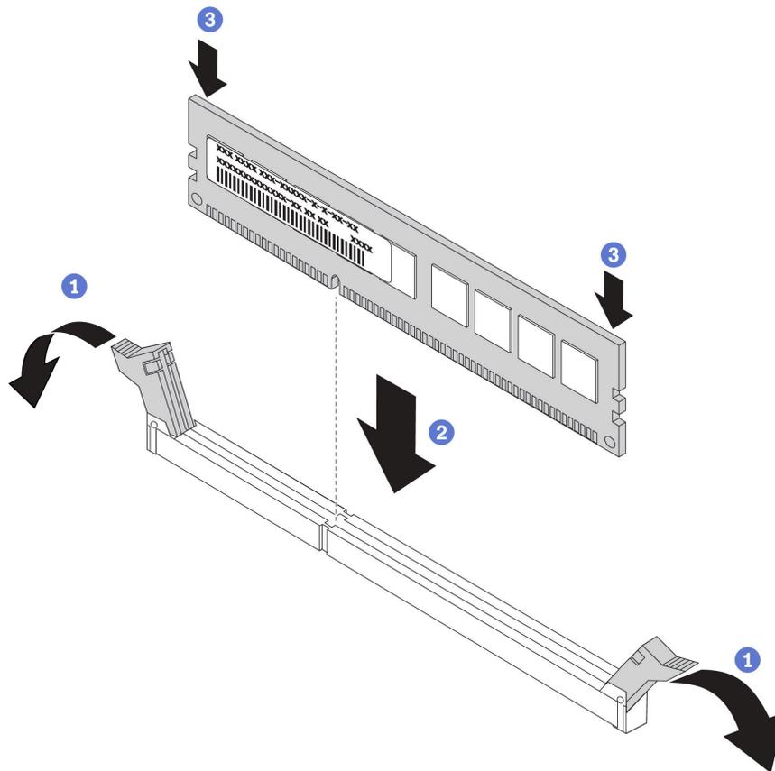
図 80. メモリー・モジュールの取り付け
