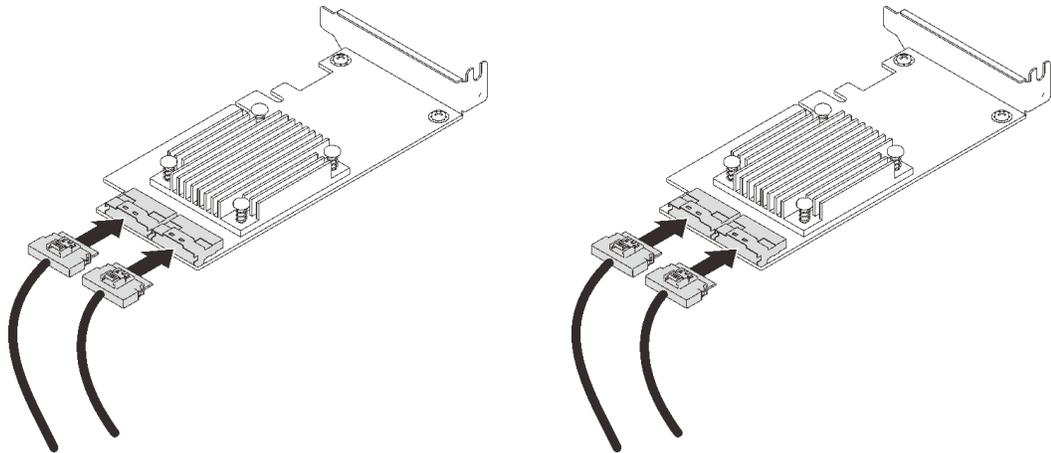
注：次のように、ドライブ・バックプレーンおよび NVMe スイッチ・カード・コネクタが一致していることを確認します。
