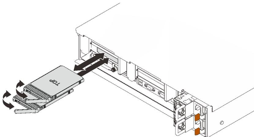
図 53. 7 mm ドライブの取り外し
