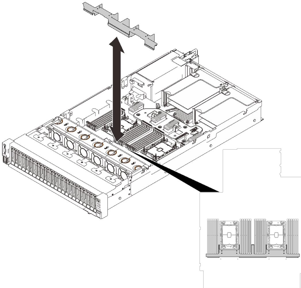
**그림 83. 확장 트레이 공기 조절 장치 설치**
