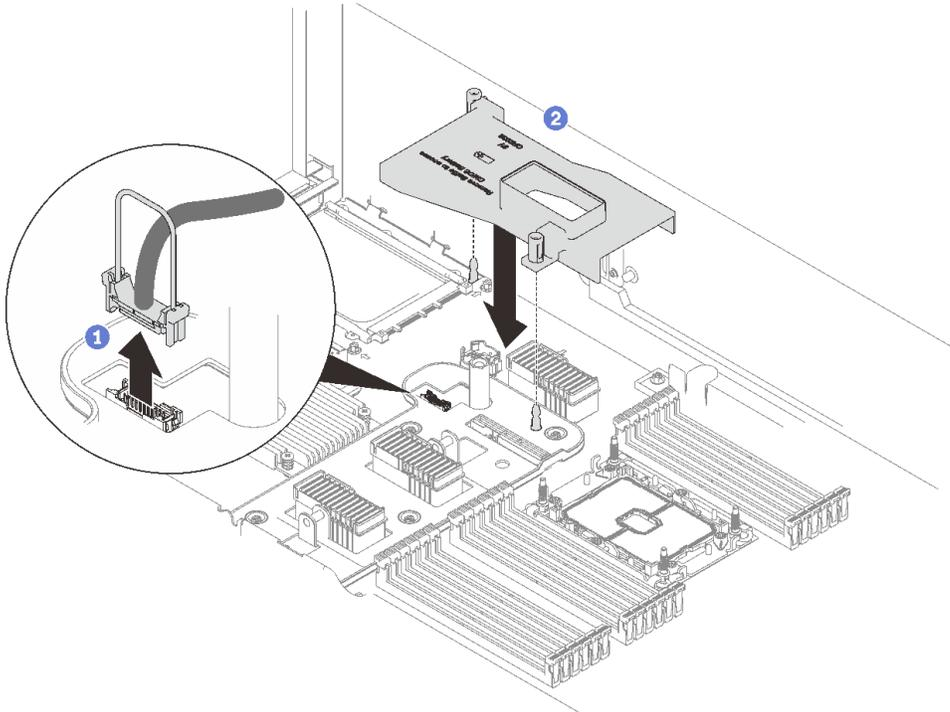
**그림 66. OCP 어댑터 공기 조절 장치 설치 중**
