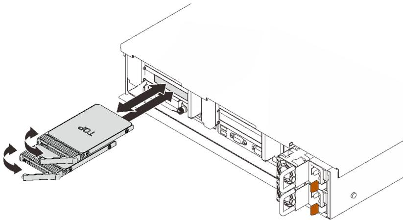
**그림 46. 7mm 드라이브 설치**
