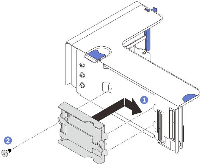
그림 62. 수직 홀더 설치 중
