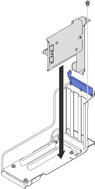
그림 64. 라이저에 플래시 전원 모듈 브래킷 설치 중
