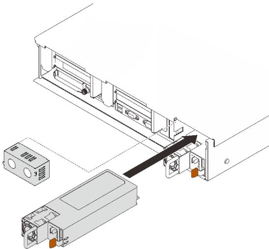
**그림 50. 전원 공급 장치 설치**
