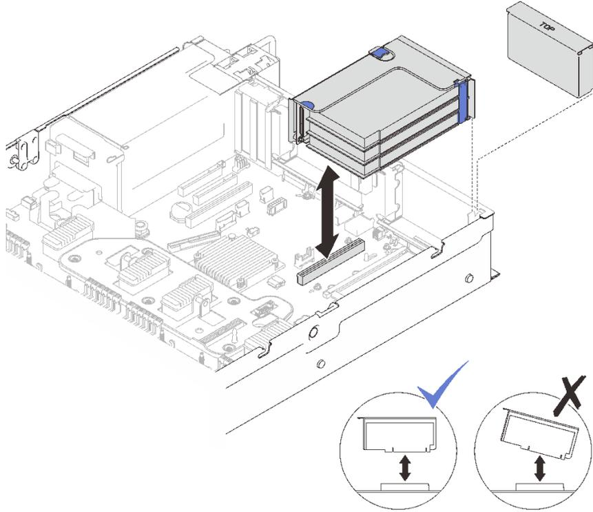
그림 57. 영역 1에서 PCIe 라이저 어셈블리 제거
