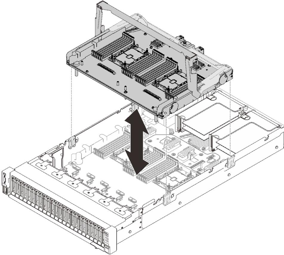
**그림 22. 프로세서 및 메모리 확장 트레이 설치**
