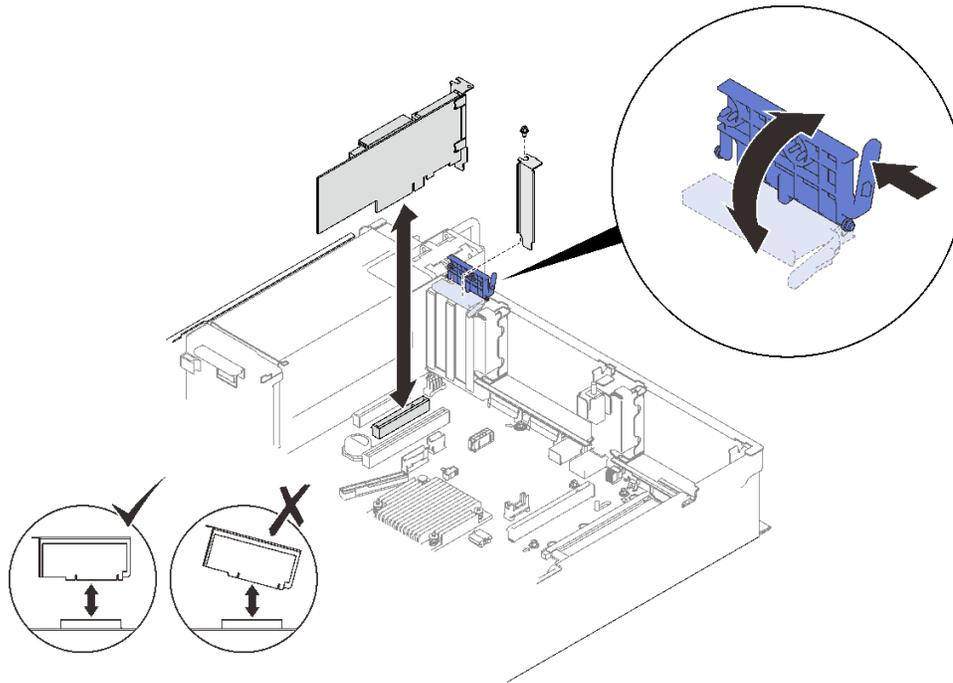
그림 59. 시스템 보드에 어댑터 설치
