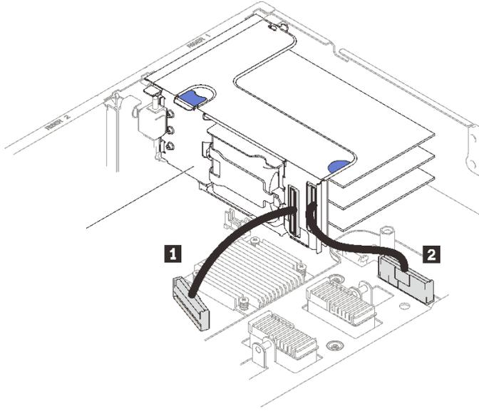
그림 69. x16/x16/x16 라이저의 PCIe 케이블을 시스템 보드에 연결
