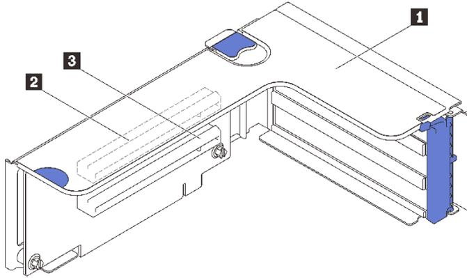
그림 14. x16/x16(x8 레인) PCIe 라이저 카드 커넥터
