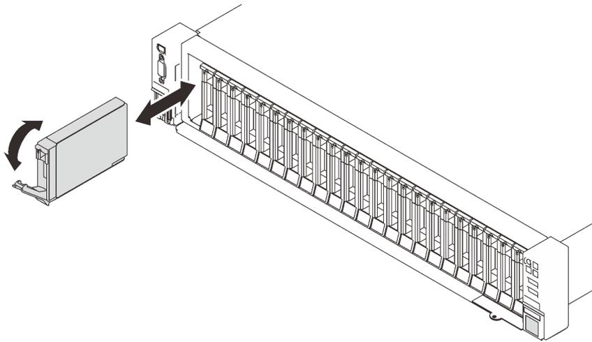
그림 48. 2.5인치 드라이브 설치
