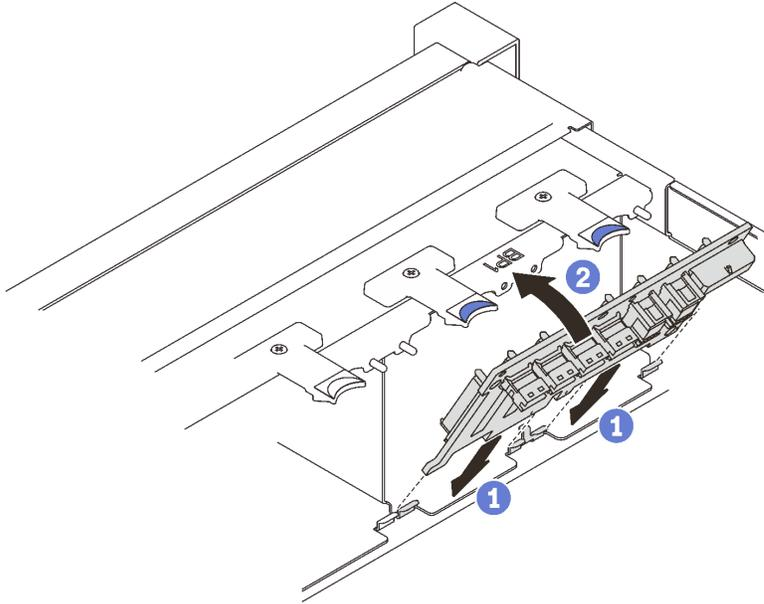
**그림 55. 드라이브 백플레인 설치**
