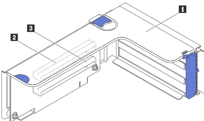
그림 36. x16/x16(x8 레인) PCIe 라이저 카드 커넥터
