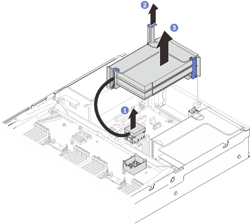
그림 58. 영역 2에서 PCIe 라이저 어셈블리 제거
