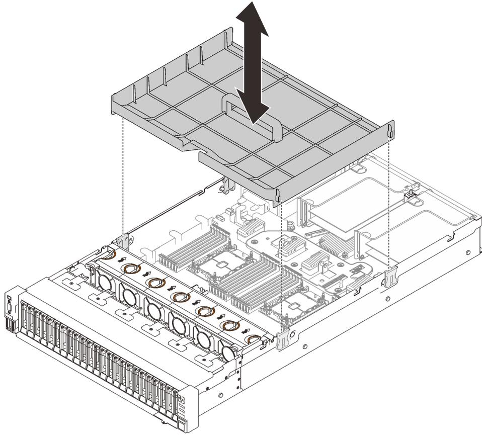
그림 71. 시스템 공기 조절 장치 제거
