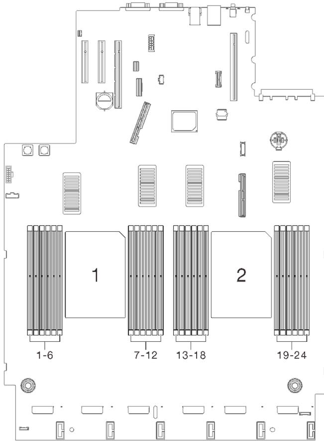
**그림 76. 시스템 보드의 프로세서 1 및 2 위치**
