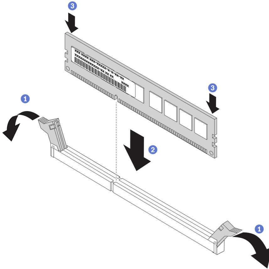
**그림 80. 메모리 모듈 설치**
