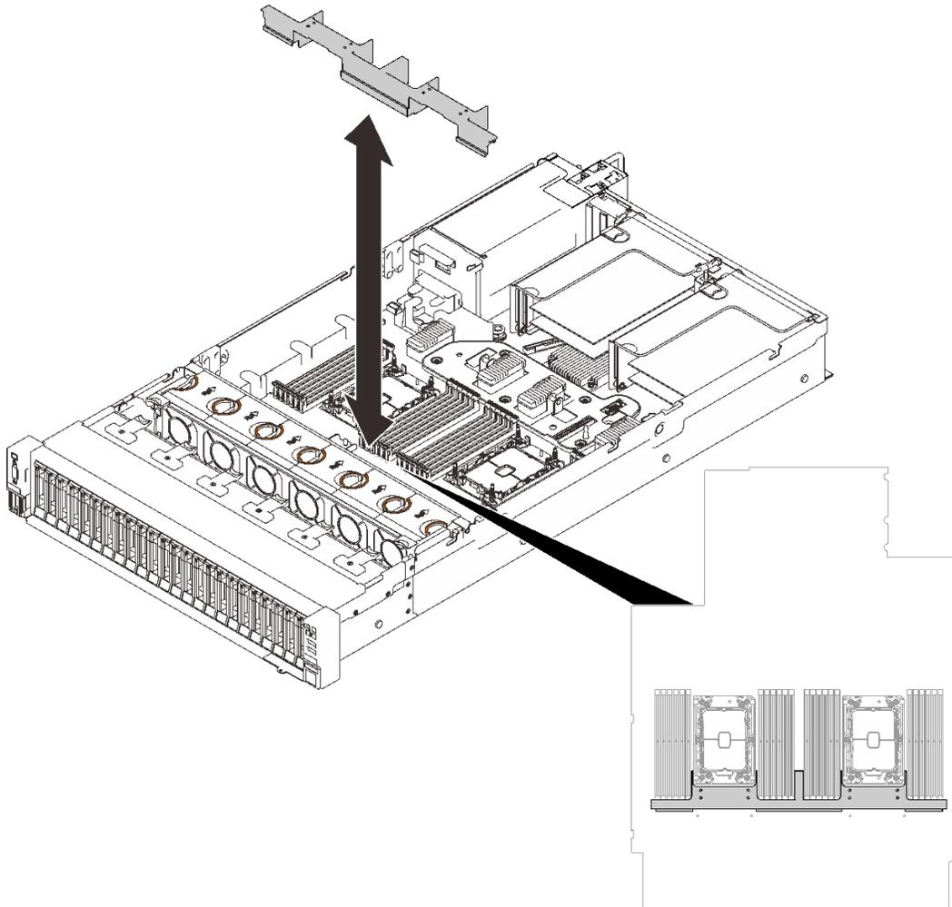
**그림 21. 확장 트레이 공기 조절 장치 설치**
