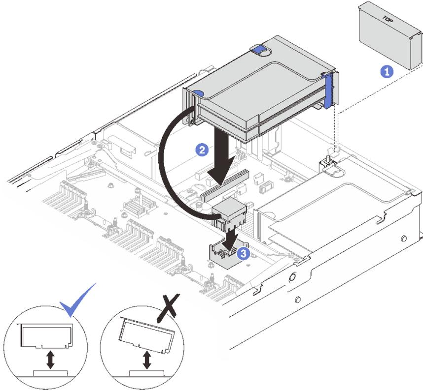
그림 70. 영역 2에 PCIe 라이저 어셈블리 설치
