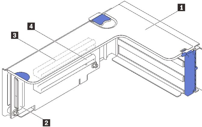
그림 16. x16/x16 PCIe 라이저 카드 커넥터
