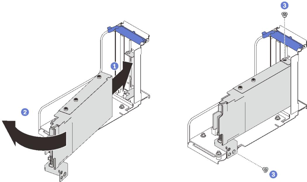
**그림 82. 라이저에 7mm 드라이브 케이스를 설치하십시오.**
