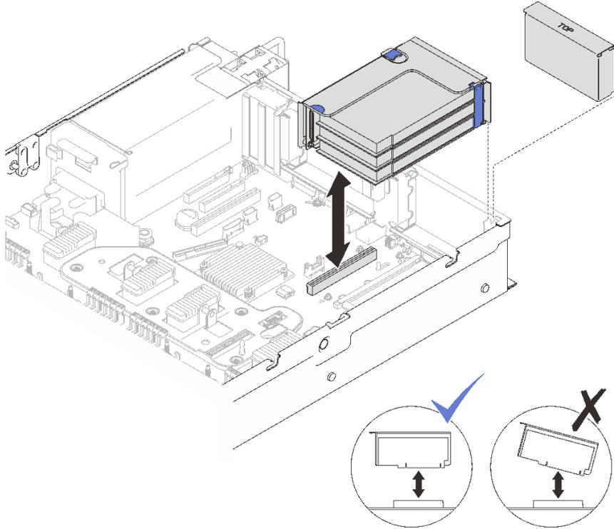
그림 68. 영역 1에 PCIe 라이저 어셈블리 설치
