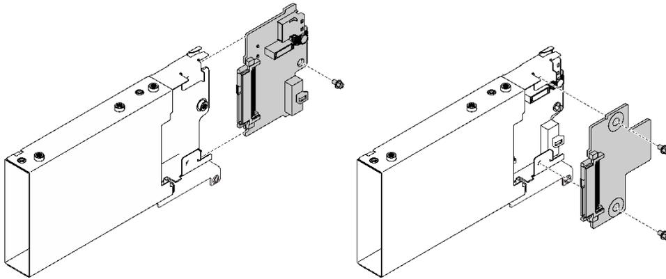
**그림 81. 7mm 드라이브 백플레인 설치**
