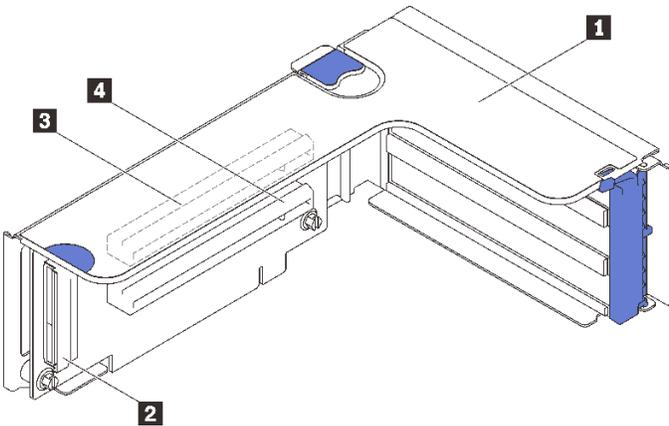
**그림 38. x16/x16 PCIe 라이저 카드 커넥터**
