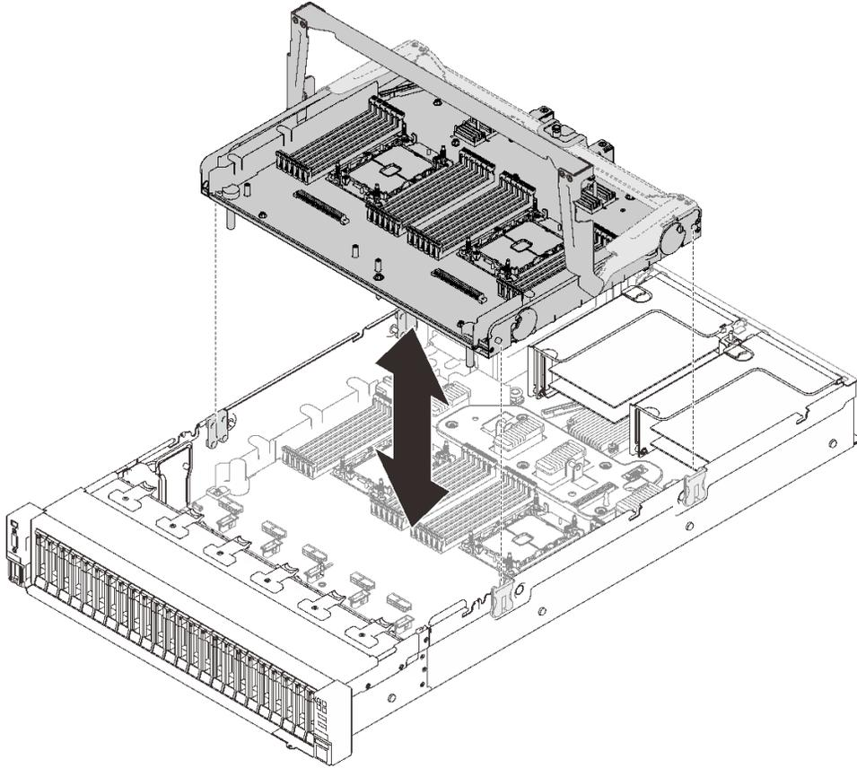
**그림 84. 프로세서 및 메모리 확장 트레이 설치**
