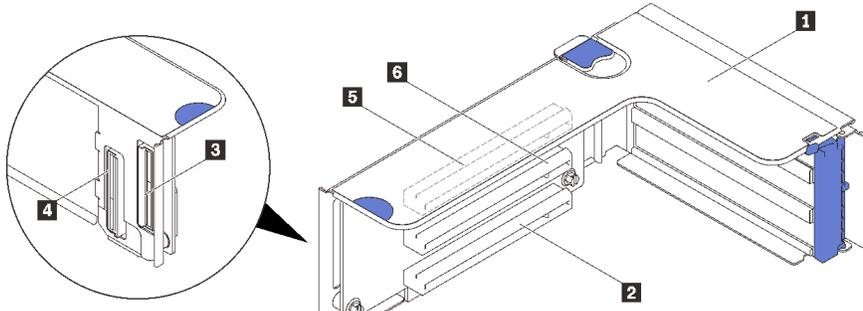
그림 15. x16/x16/x16 PCIe 라이저 카드 커넥터
