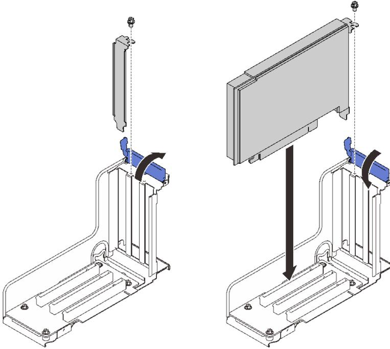
그림 60. PCIe 라이저 어셈블리에 어댑터 설치
