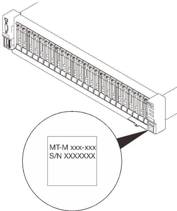
**그림 3. 시스템 유형, 모델 및 일련 번호 위치**
