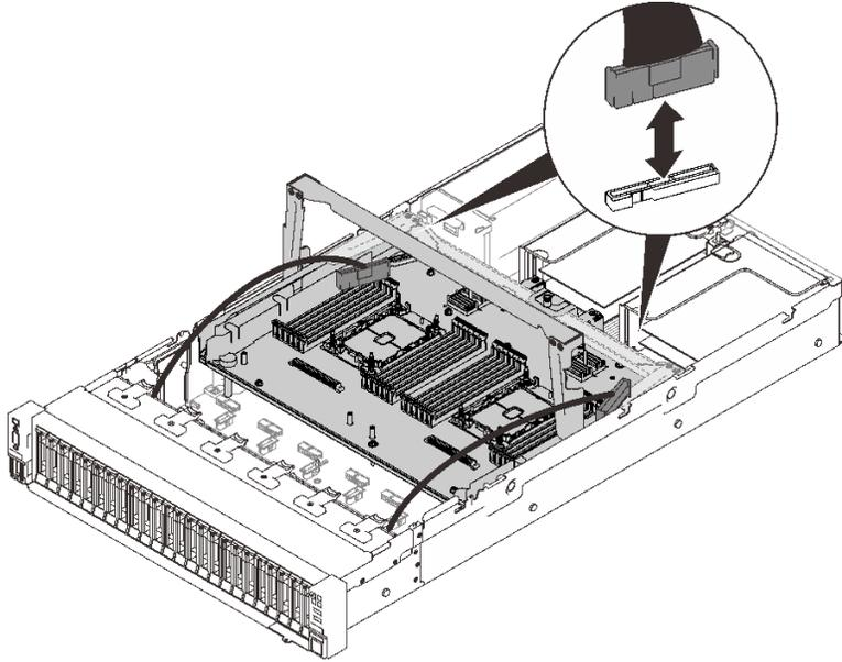
**그림 73. PCIe 케이블 분리**
