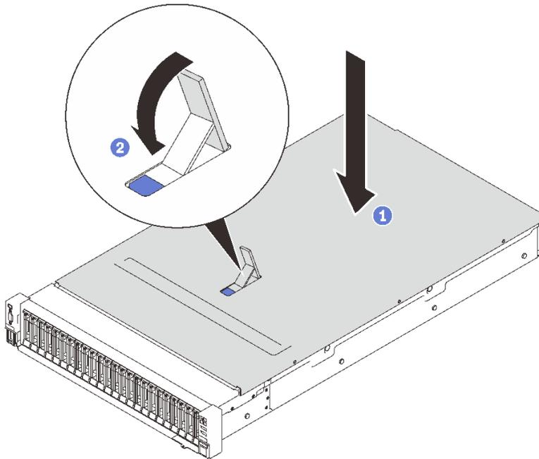
그림 88. 윗면 덮개 설치
