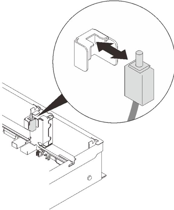
**그림 56. 침입 스위치 설치**
