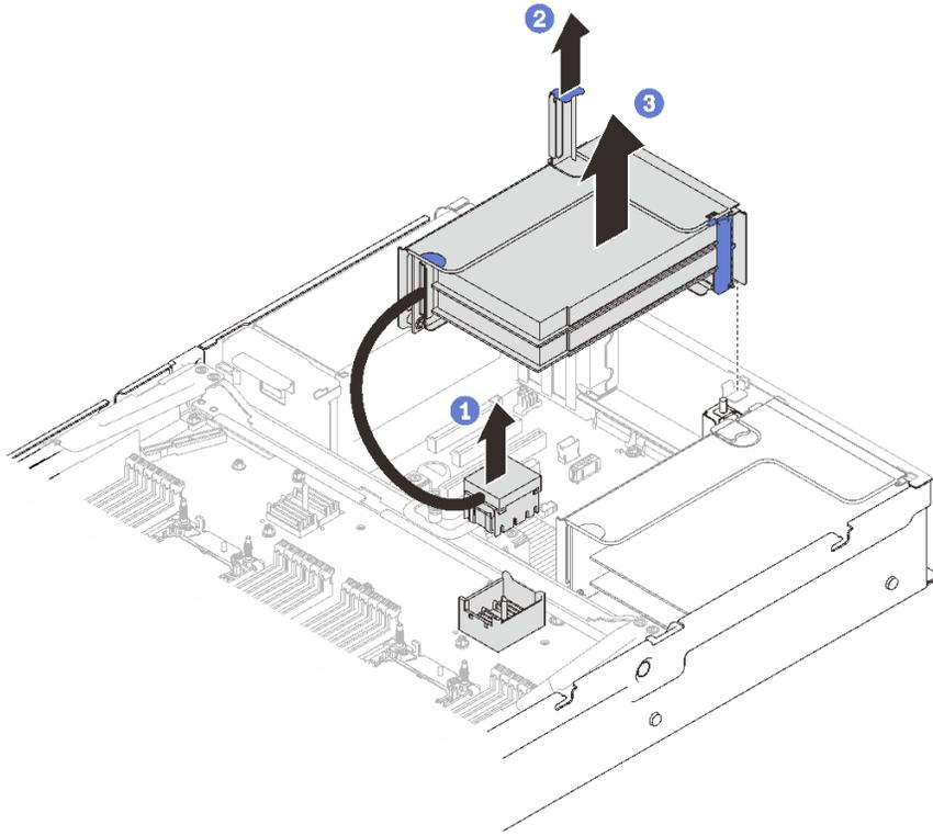
圖例 75. 從區域 2 卸下 PCIe 擴充卡組件
