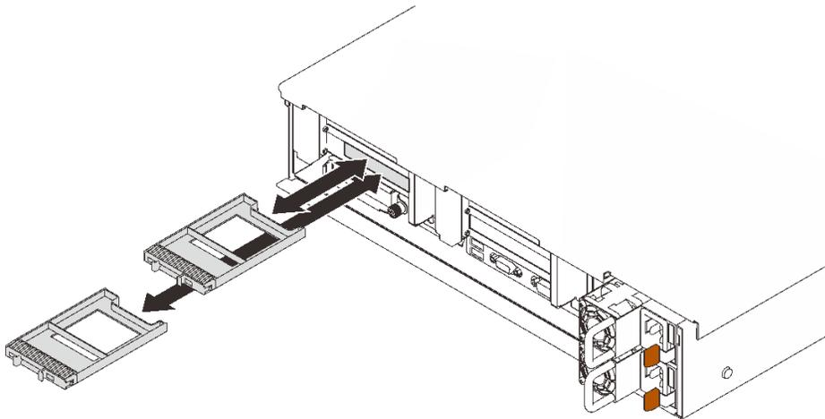
圖例 35. 安裝 7 公釐硬碟填充板
