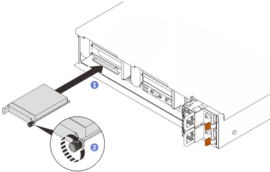
圖例 73. 安裝 OCP 乙太網路配接卡
