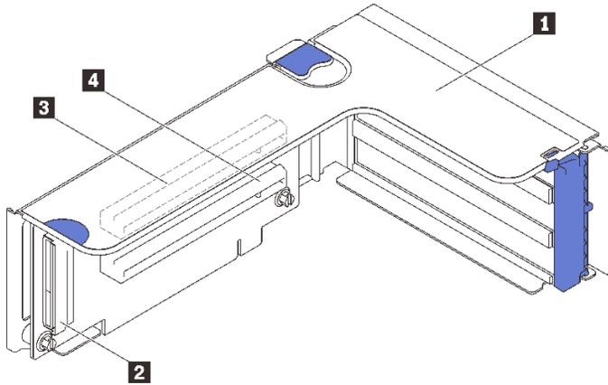
圖例 16. x16/x16 PCIe 擴充卡接頭
