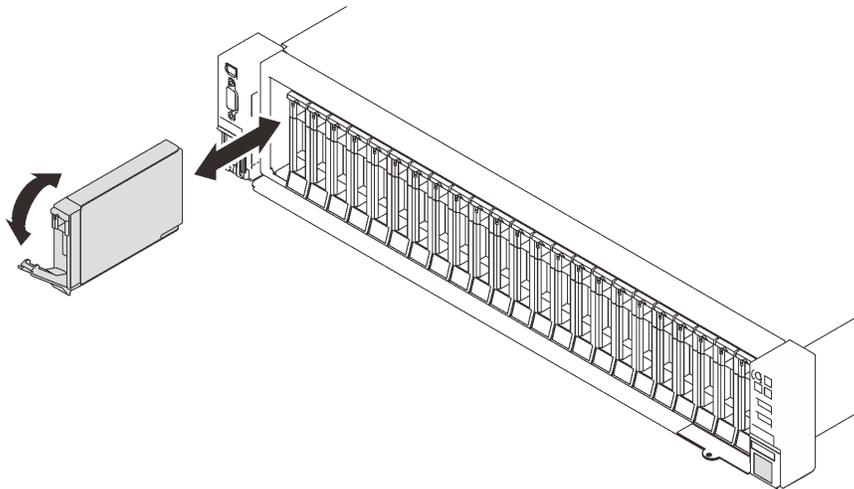
圖例 29. 卸下 2.5 吋硬碟
