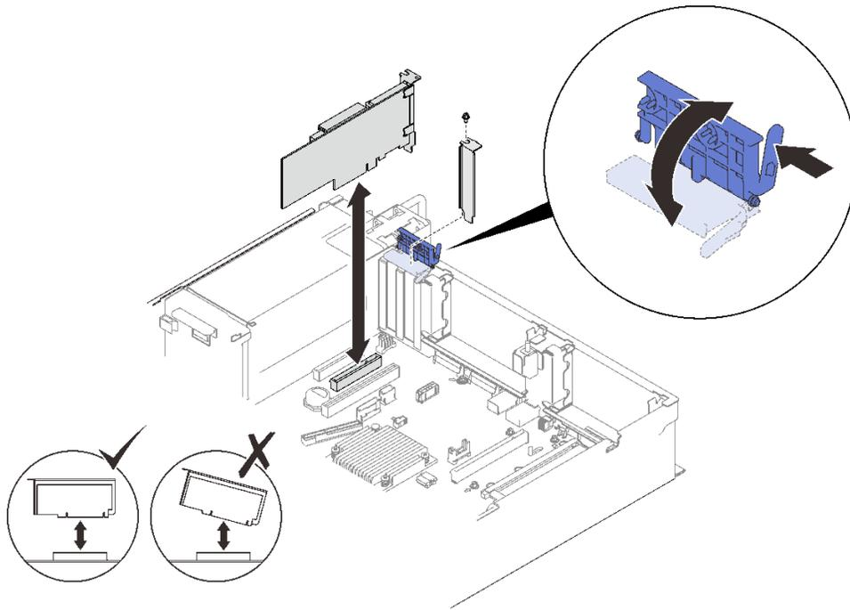
圖例 77. 從主機板卸下配接卡
