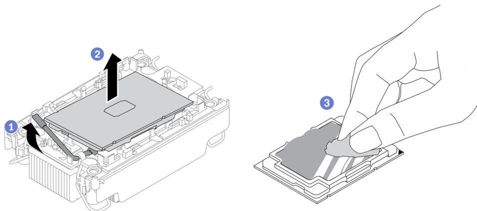
圖例 100. 將處理器與散熱槽和支架分開
