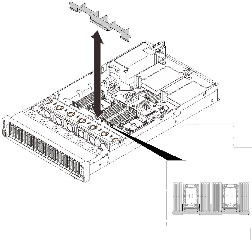
圖例 133. 將空氣擋板安裝到主機板
