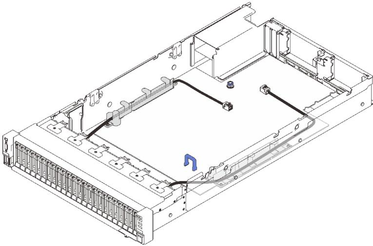
圖例 22. 主機板上的纜線導件
