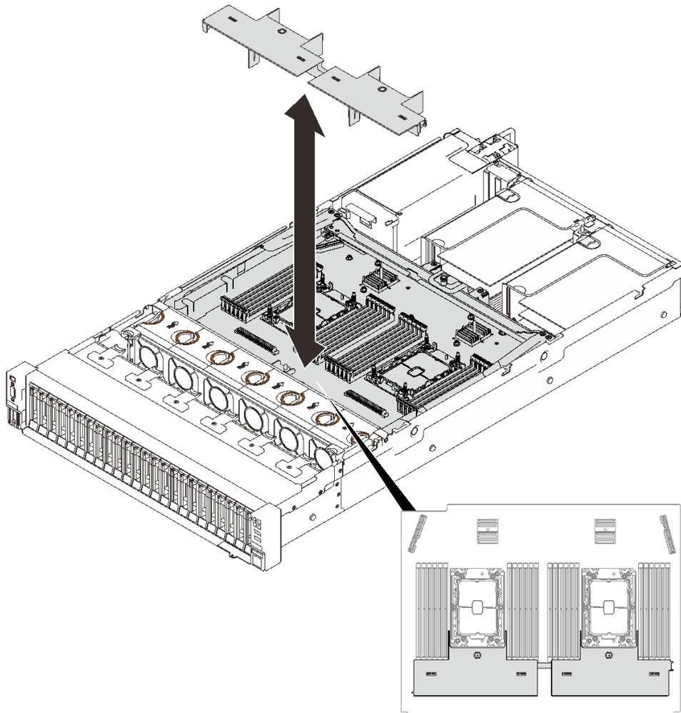
圖例 60. 從擴充匣卸下空氣擋板
