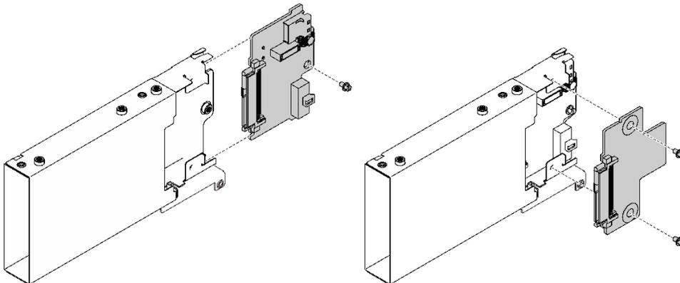
圖例 38. 安裝 7 公釐硬碟背板
