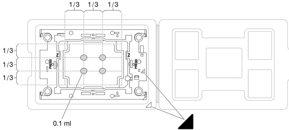
圖例 106. 運送匣中的處理器塗上散熱膏
