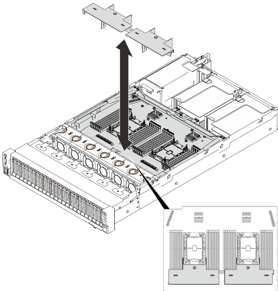
圖例 96. 從擴充匣卸下空氣擋板
