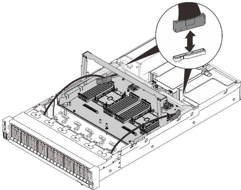
圖例 111. 拔掉 PCIe 纜線
