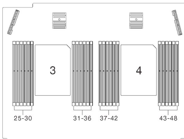
圖例 67. 擴充匣上的記憶體模組插槽 25-48
