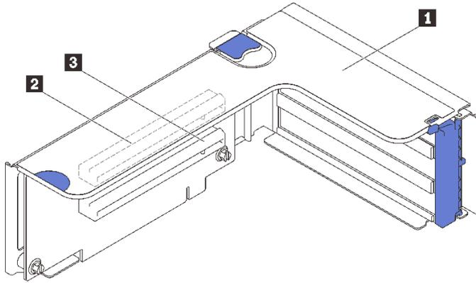
圖例 14. x16/x16 ( x8 通道 ) PCIe 擴充卡接頭
