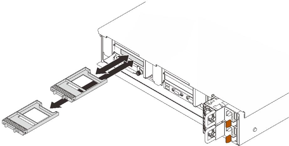
圖例 40. 卸下 7 公釐硬碟填充板
