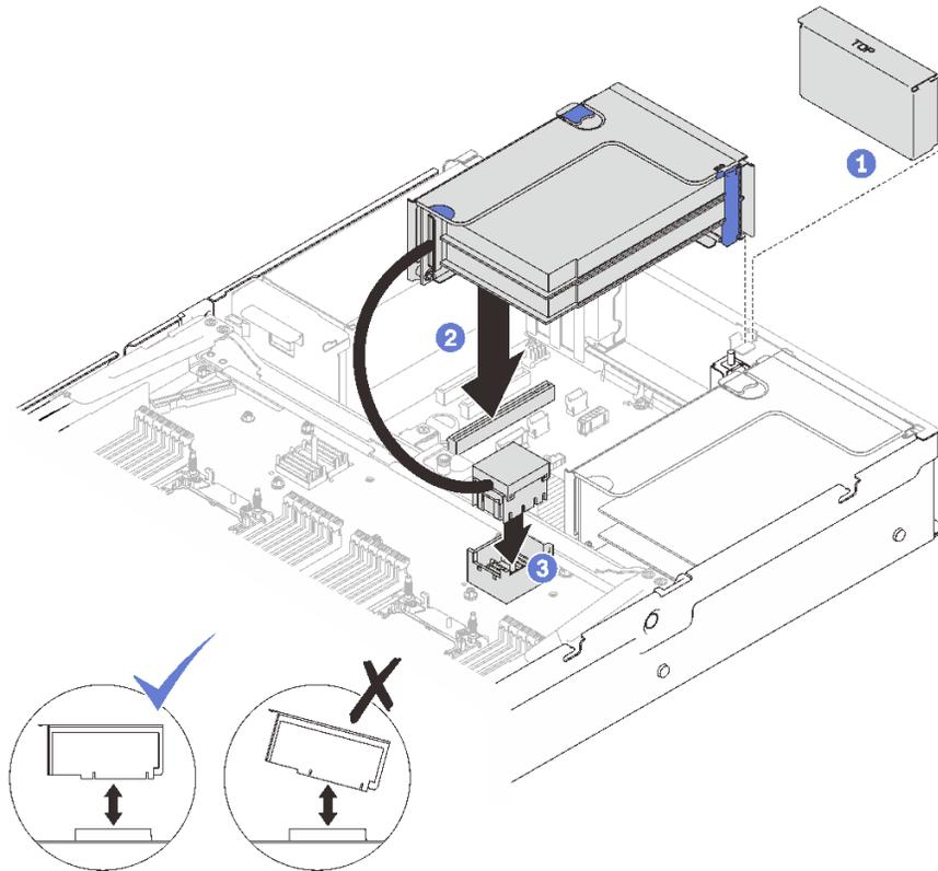
圖例 83. 將 PCIe 擴充卡組件安裝到區域 2
