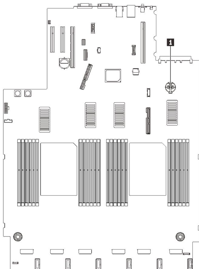
圖例 43. 主機板上的 CMOS 電池位置
