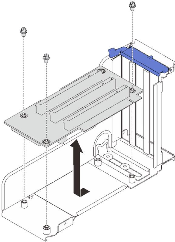
圖例 76. 拆卸 PCIe 擴充卡
