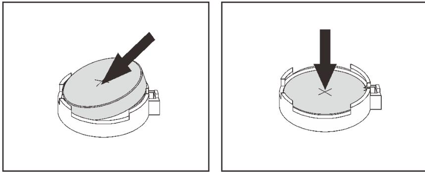
圖例 45. 安裝 CMOS 電池
