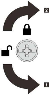
圖例 129. 上蓋鎖定/解鎖方向
