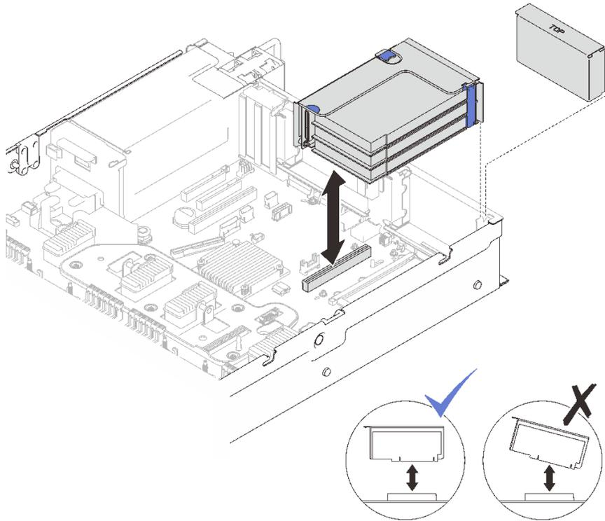
圖例 81. 將 PCIe 擴充卡組件安裝到區域 1
