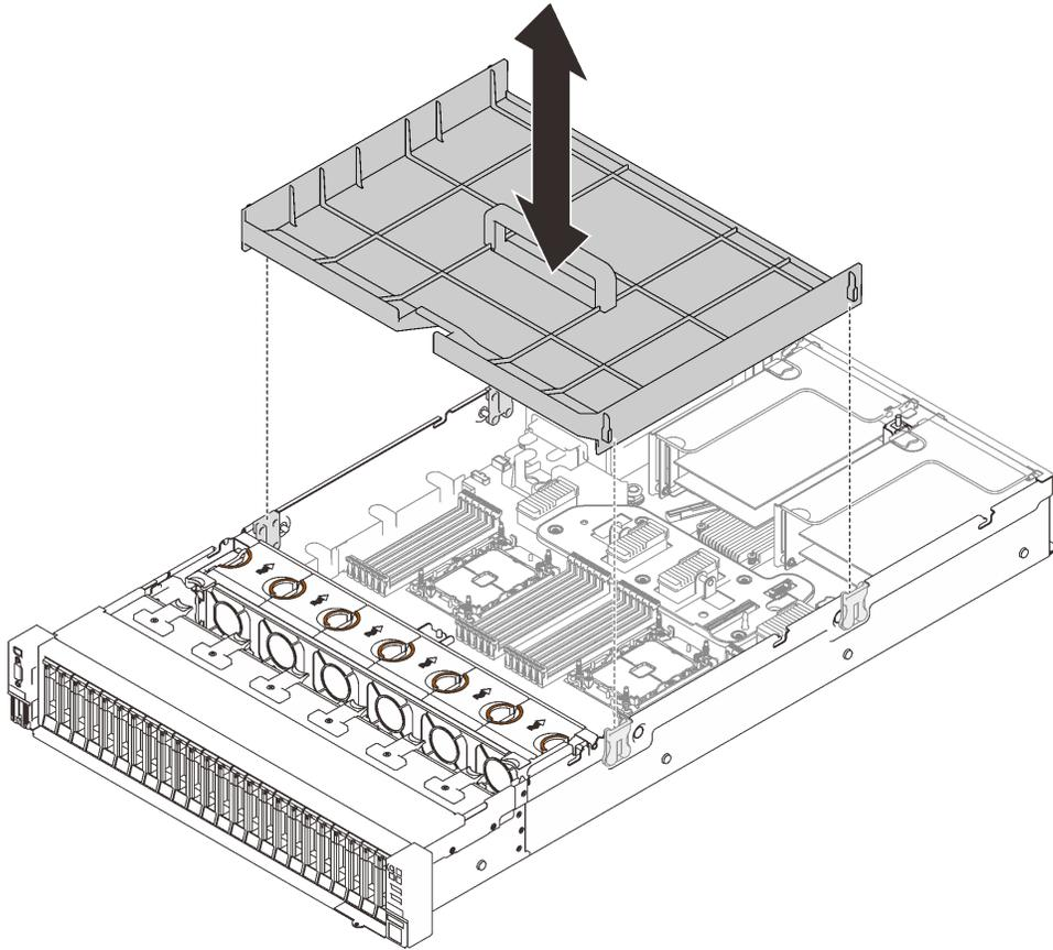
圖例 122. 卸下主機板空氣擋板
