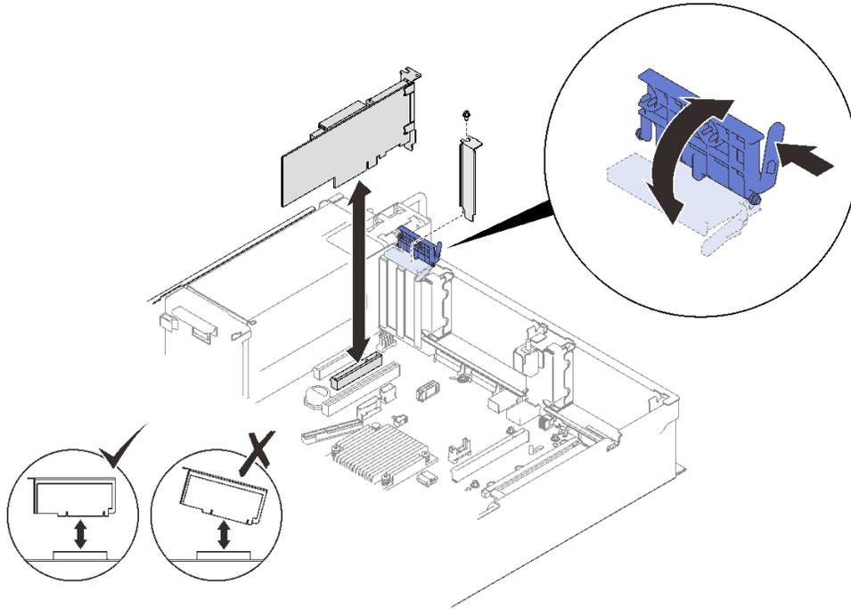
圖例 79. 將配接卡安裝到主機板
