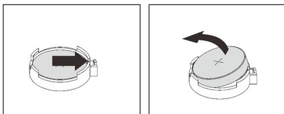
圖例 44. 取出 CMOS 電池
