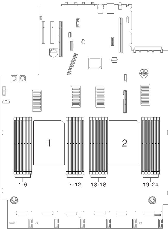
圖例 66. 主機板上的記憶體模組插槽 1-24
