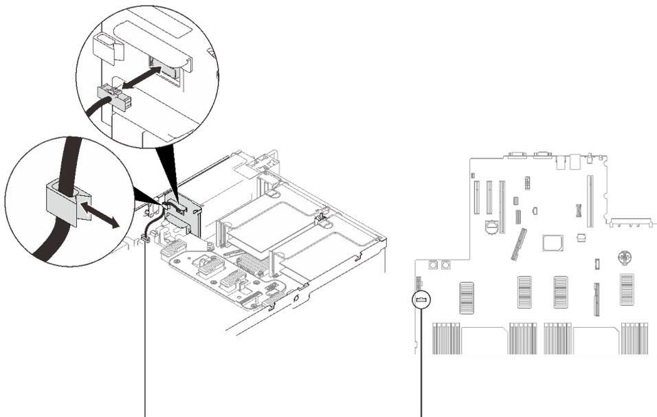
圖例 84. 拔掉電源背板纜線
