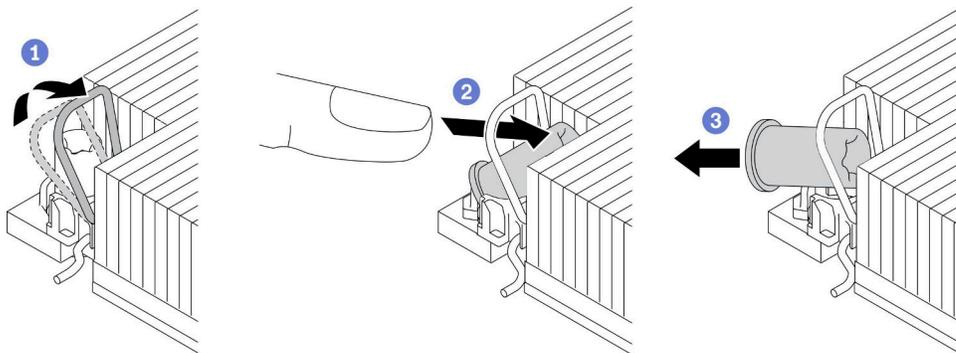
圖例 62. 從散熱槽卸下 Torx T30 螺帽
