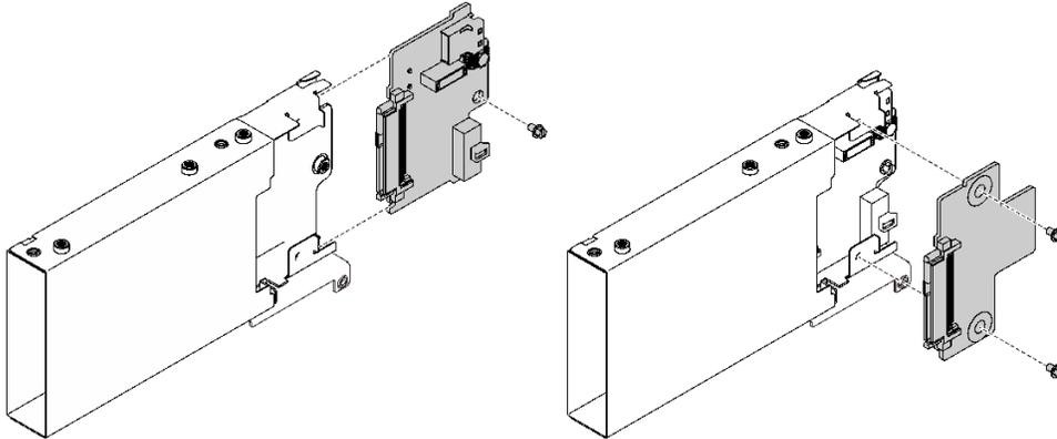
圖例 37. 拆卸 7 公釐框架
