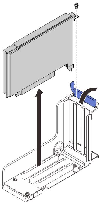
圖例 78. 從 PCIe 擴充卡組件卸下配接卡
