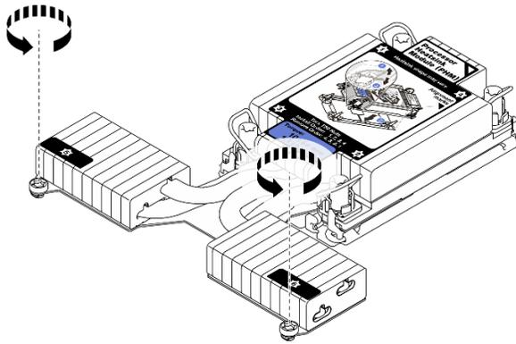
圖例 98. 鬆開 T 形散熱槽螺絲
