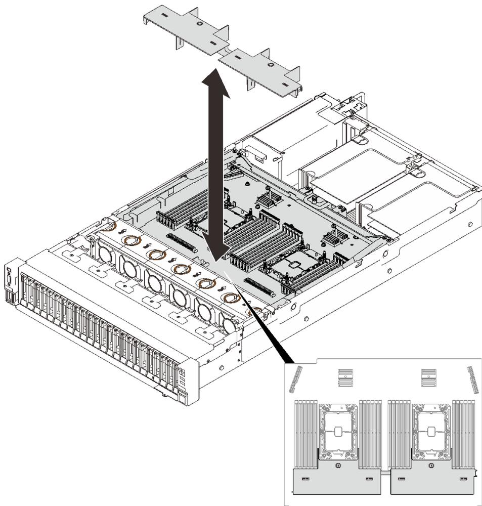
圖例 68. 從擴充匣卸下空氣擋板
