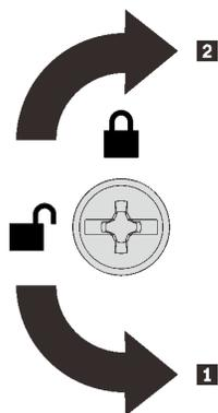
圖例 132. 上蓋鎖定/解鎖方向
