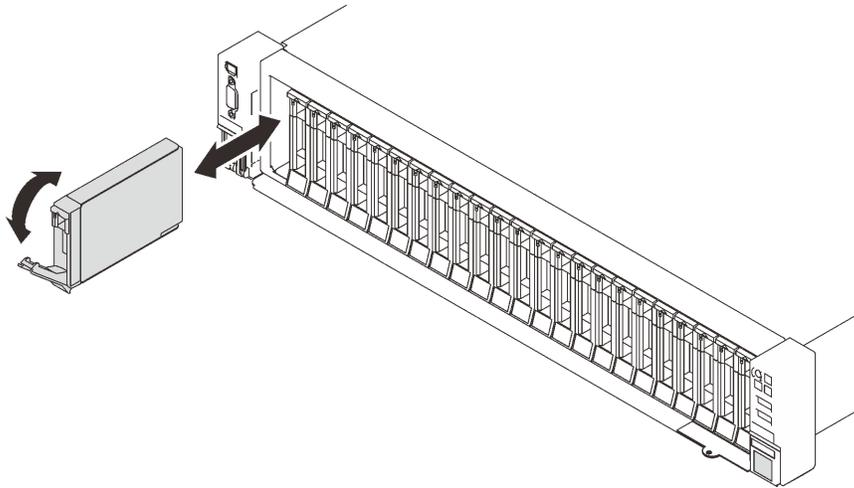
圖例 33. 安裝 2.5 吋硬碟
