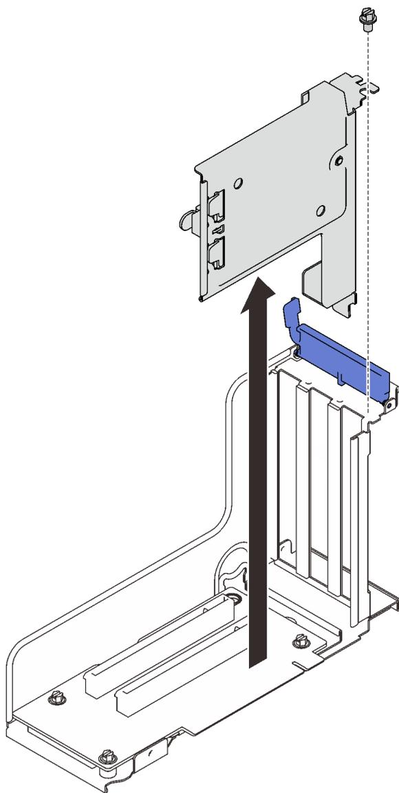
圖例 56. 從 PCIe 擴充卡卸下匣托架
