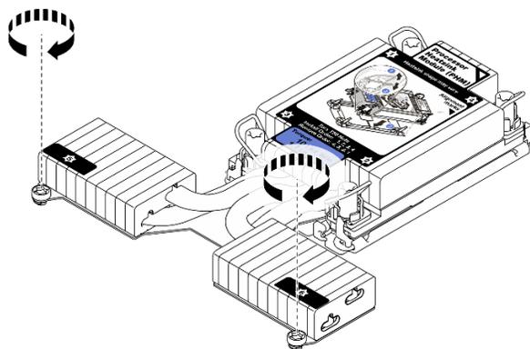
圖例 109. 鎖緊 T 形散熱槽螺絲
