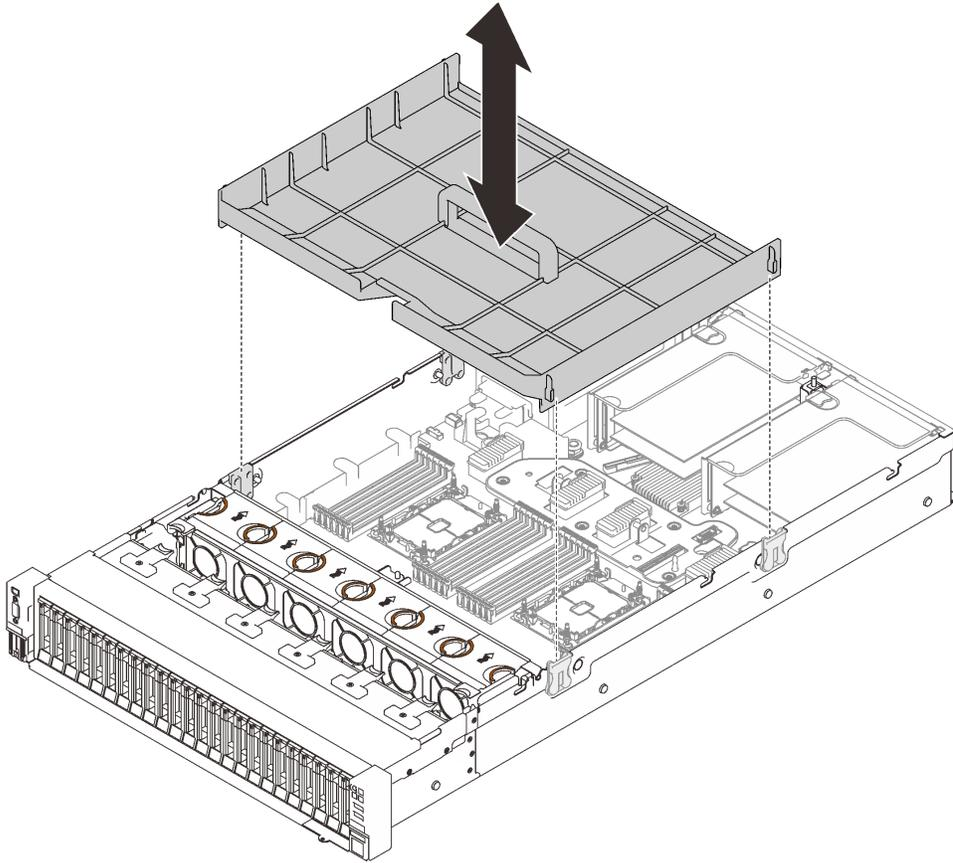
圖例 123. 安裝主機板空氣擋板
