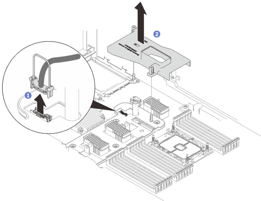
圖例 42. 卸下 OCP 配接卡空氣擋板
