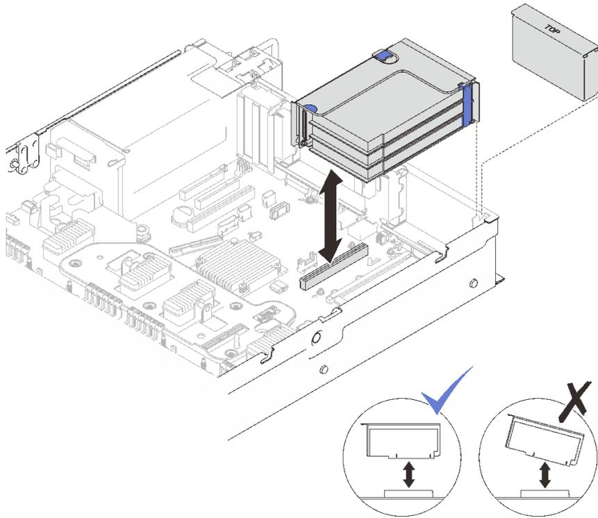
圖例 74. 從區域 1 卸下 PCIe 擴充卡組件
