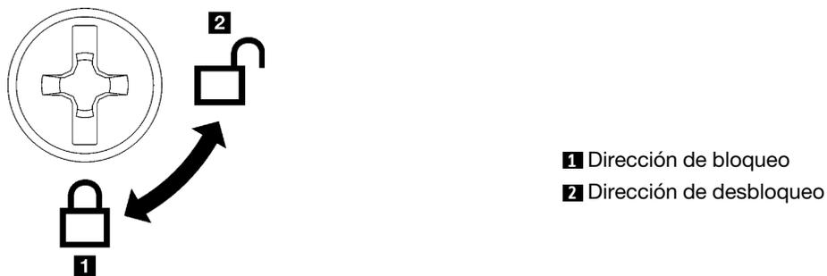
Figura 136. Dirección de bloqueo/desbloqueo de la cubierta superior frontal
